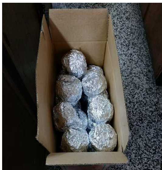
Slika 6.24: a-c) Postupak vaganja MWCNT i pakiranja istih u Al-foliju proveden je na Metalurškom fakultetu u Sisku; d) pripremljeni paketi MWCNT u kojima je m (MWCNT u Al-foliji po paketu) = 50g
