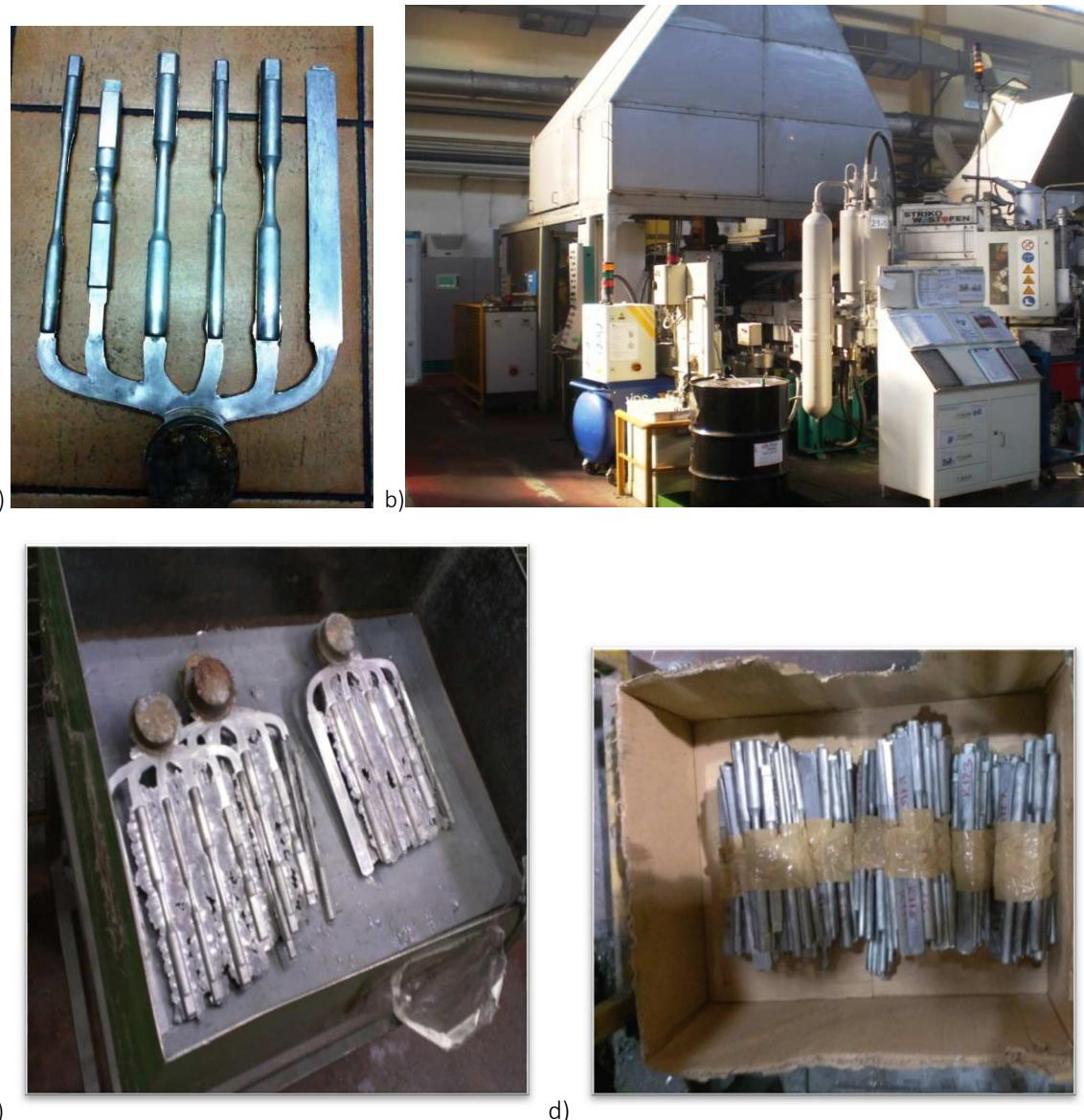
Slika 6.17: a) Lijevani grozd sa šest epruveta za mehanička ispitivanja prema normi ISO 377; b) kompletna ćelija za visokotlačno lijevanje BUHLER-42D; c) epruvete tek izvađene iz alata, d) epruvete razdvojene i pripremljene za mehanička ispitivanja
