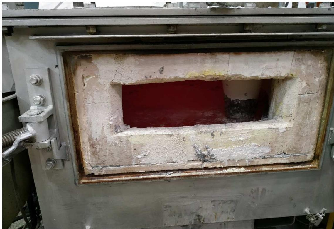
Slika 6.27: Peć s taljevinom pripravljenom od AlSi9Cu3(Fe) legure (dolegirane magnezijem) - otvor na peći za uzorkovanje za kontrolu kvalitete
