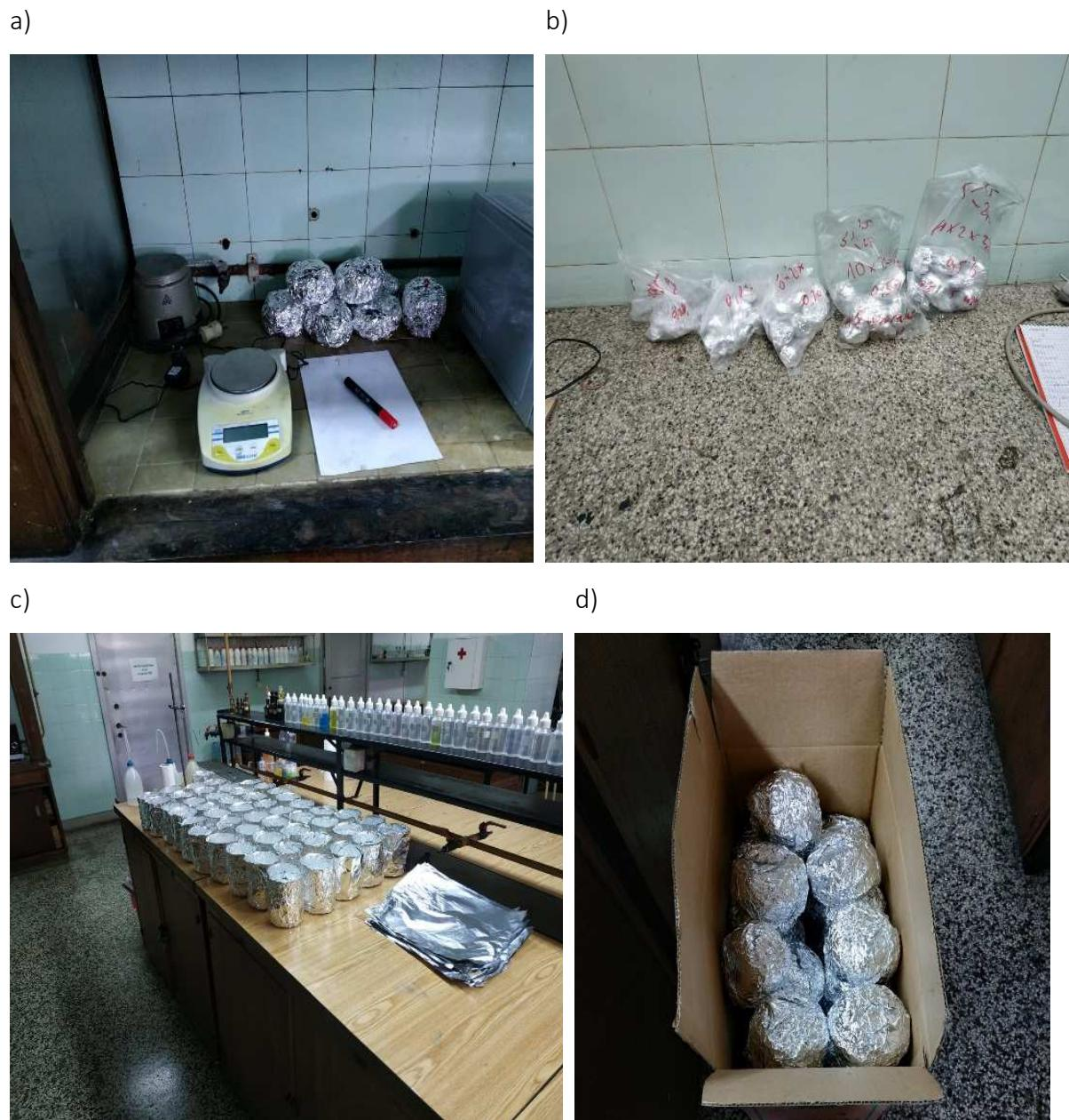
Slika 6.24: a-c) Postupak vaganja MWCNT i pakiranja istih u Al-foliju proveden je na Metalurškom fakultetu u Sisku;
