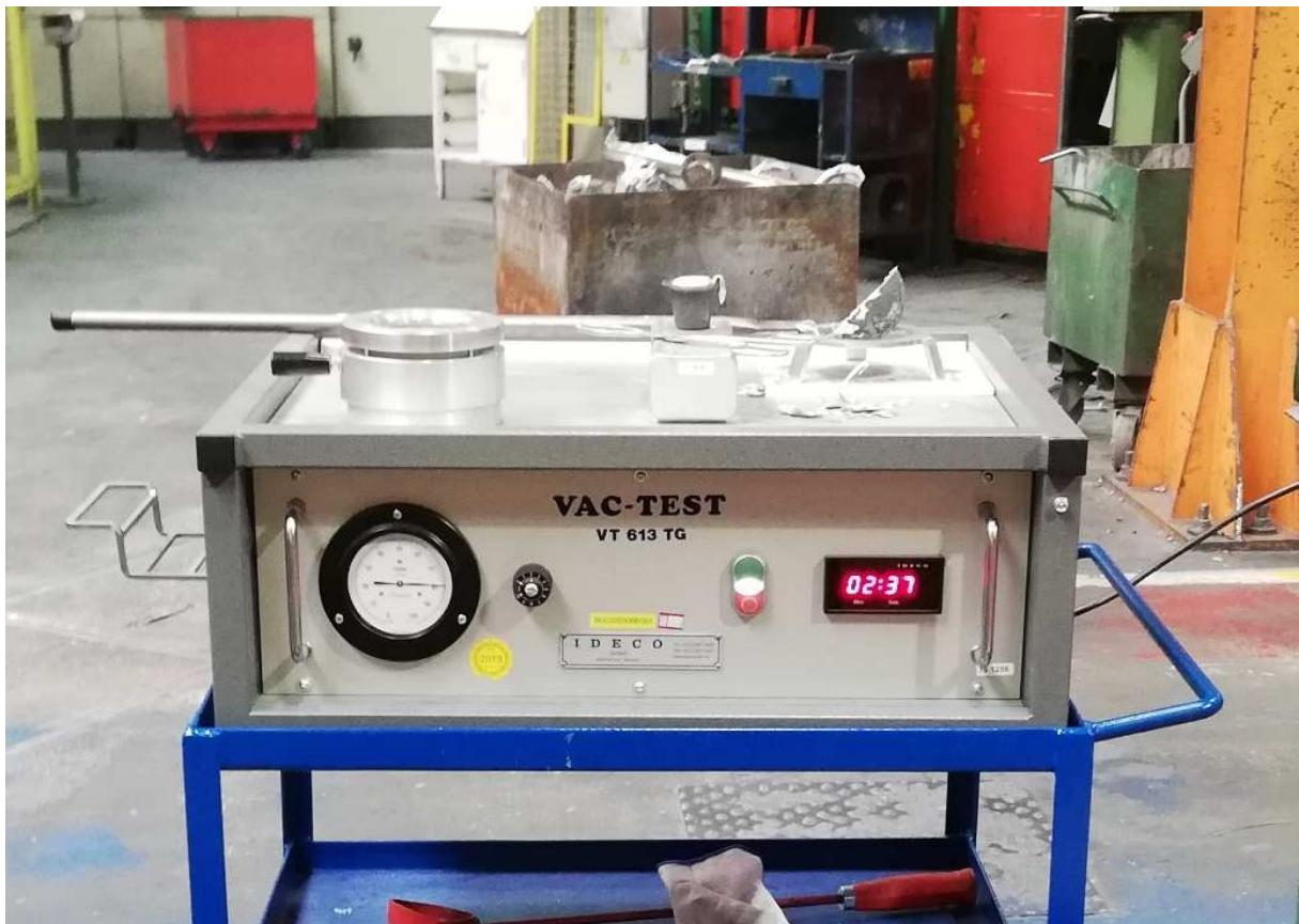
Slika 6.29: Vakuum test ispitivanja naplinjenosti magnezijem dolegirane taljevine/legure AlSi9Cu3(Fe) pri 80 mbara tijekom 4 minute
