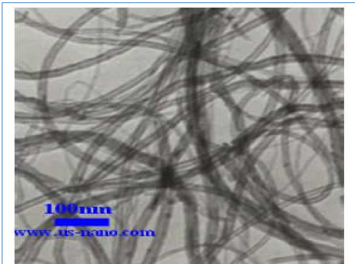
Slika 6.13: SEM slika MWCNT istaknuta na ambalaži
