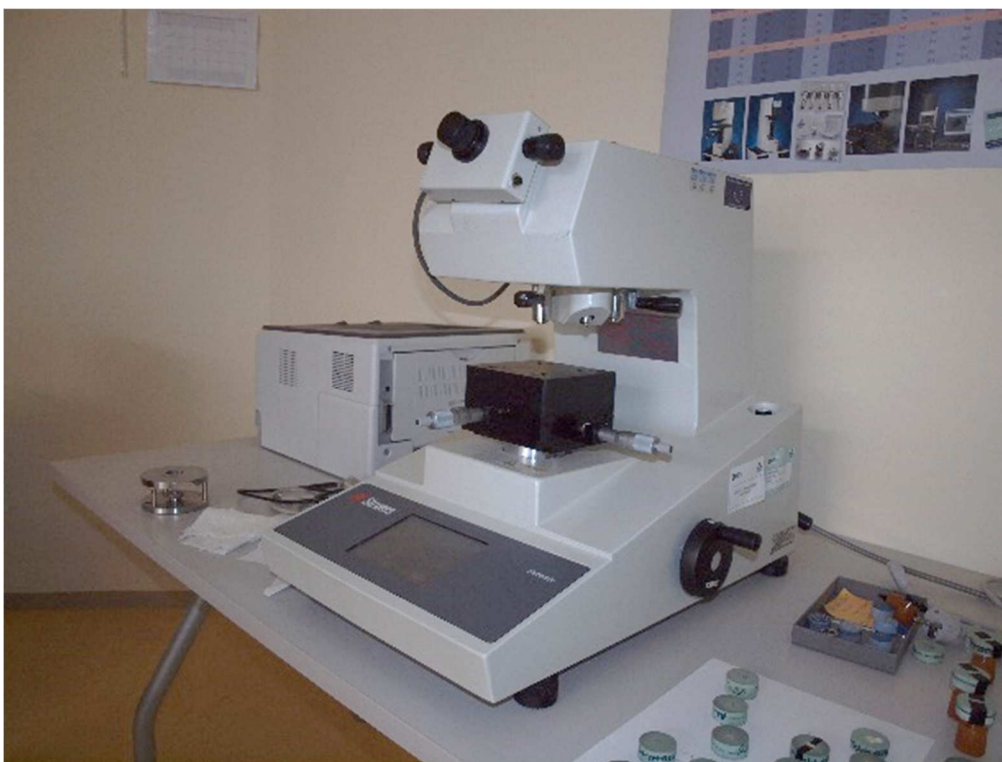
Slika 6.3: Oprema za mehanička ispitivanja u METRIS-u a) univerzalna statička kidalica Messphysik BETA250; b) uređaj za mjerenje tvrdoće prema Vickersu Struers DURAMIN2
