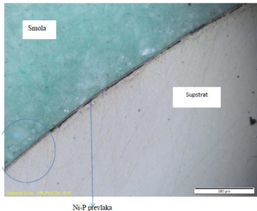
Slika 4.72. Ni-P prevlaka i supstrat toplinski obrađenog uzorka na 200 °C
