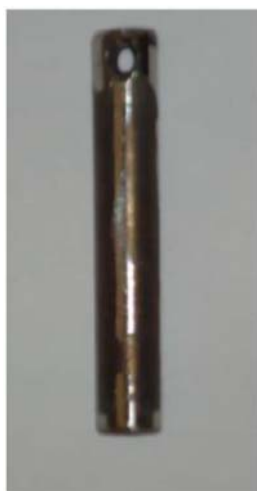
Slika 4.11. Oljuštena Ni-P prevlaka nakon toplinske obrade.
