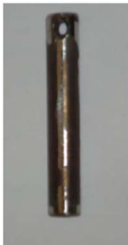
Slika 4.11. Oljuštena Ni-P prevlaka nakon toplinske obrade.
