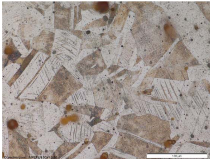
Slika 4.7. Mikrostruktura supstrata X5CrNiMo17-12-2
