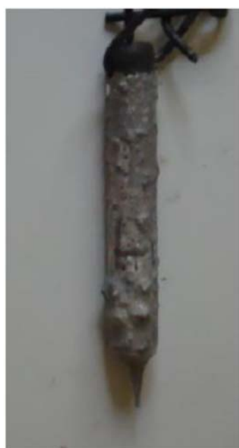
Slika 4.14. Aluminizirani uzorak X5CrNiMo17-12-2
