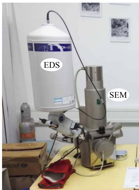
Slika 5.12. Uređaji za SEM/EDS analizu
