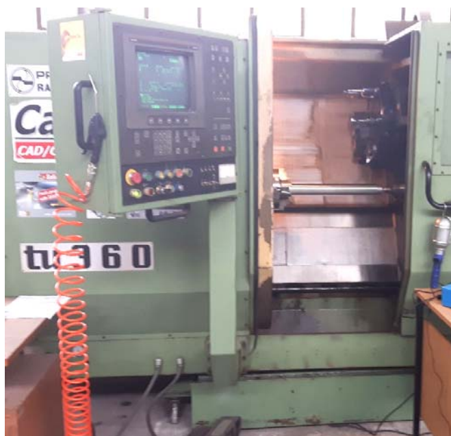
Slika 5.3. Laboratorijska CNC tokarilica TU 360 Prvomajska
