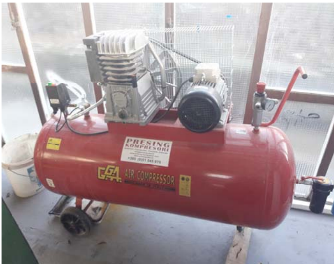
Slika 5.7. Klipni kompresor Presing B7000
