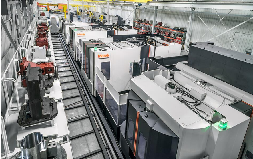
Slika 2.5 Izgled FPS za proizvodnju automobilskih dijelova malih serija [38]
