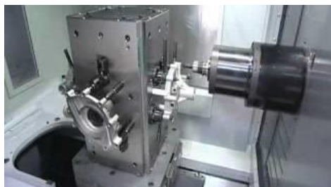
Horizontalni CNC OC s tri osi gibanja
