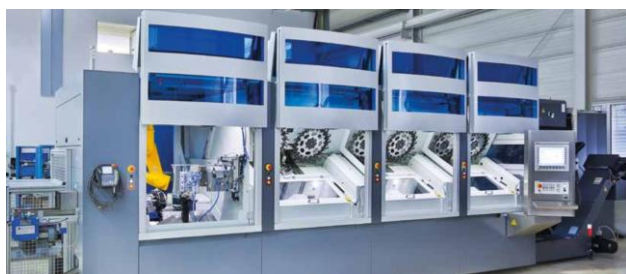
CNC horizontalni modularni OC s pet osi gibanja
