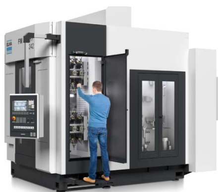
CNC visokoproduktivni OC s fiksnim alatima
