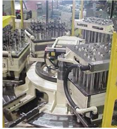
Slika 4.4 Sustav brzo izmjenjivih viševretnih obradnih jedinica proizvođača Grob [ https://www.grobgroup.com ]
