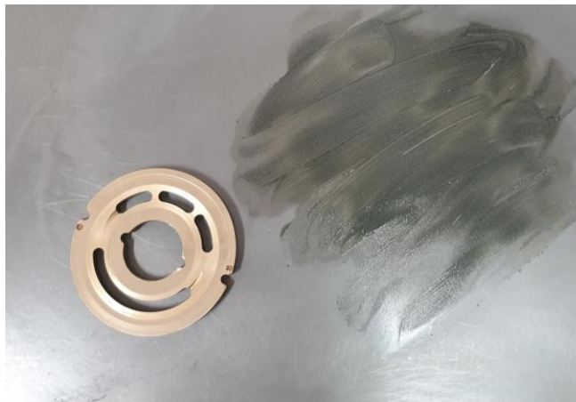
Slika 4-3 Proces poliranja razdjelne ploče
