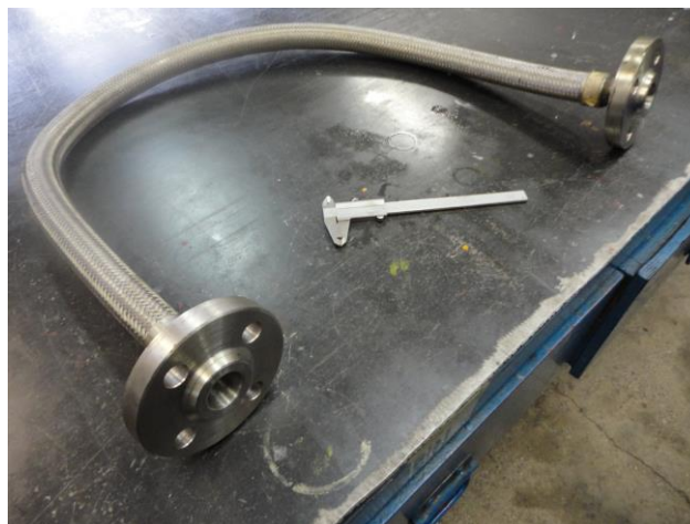
Slika 3-17 Fleksibilne hidrauličke cijevi "PFXG Ansi"
