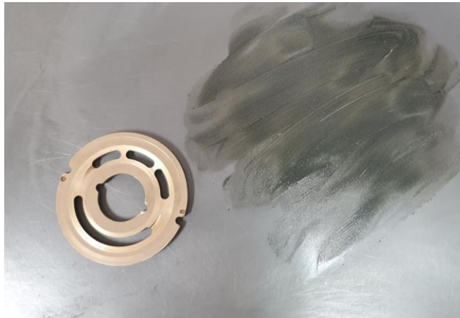
Slika 4-3 Proces poliranja razdjelne ploče
