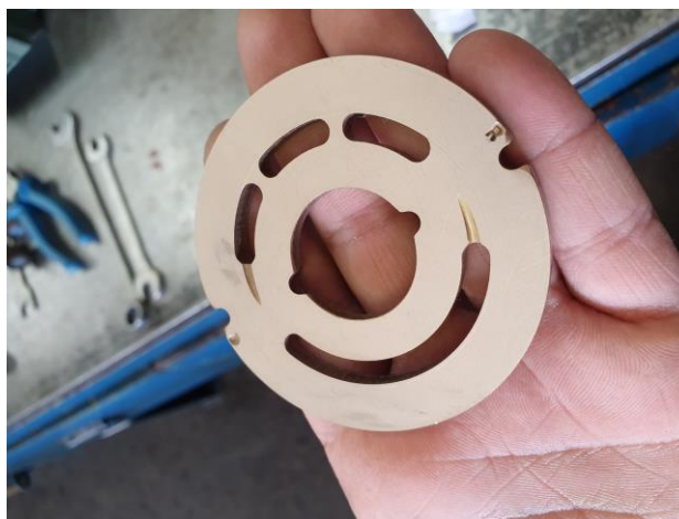
Slika 4-4 Razdjelna ploča nakon poliranja
