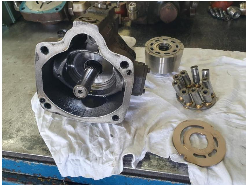
Slika 4-2 Prikaz rastavljene pumpe i njenih sastavnih dijelova
