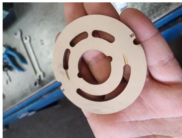
Slika 4-4 Razdjelna ploča nakon poliranja
