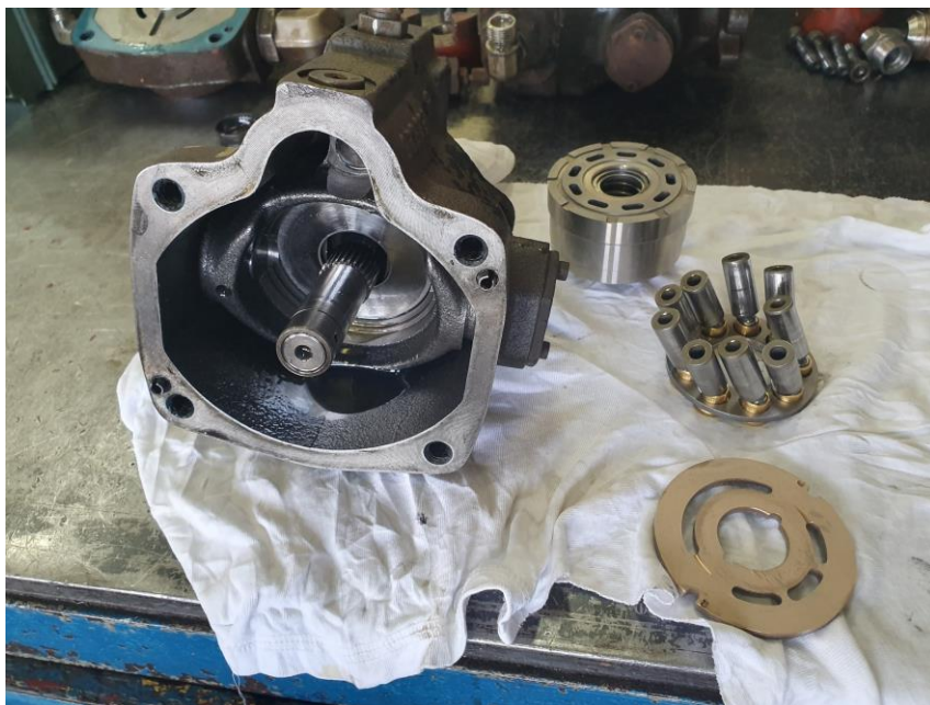
Slika 4-2 Prikaz rastavljene pumpe i njenih sastavnih dijelova
