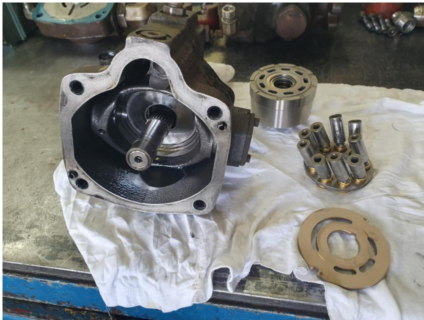
Slika 4-2 Prikaz rastavljene pumpe i njenih sastavnih dijelova
