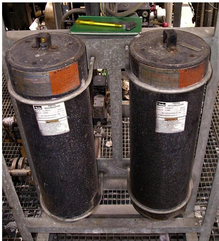
Slika 3-10 Hidraulički akumulatori unutar hidrauličkih jedinica
