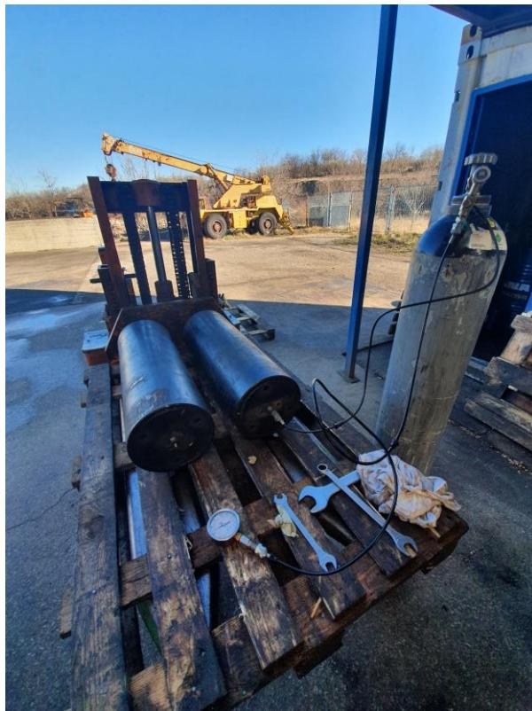
Slika 4-6 Ispitivanje hidrauličkih akumulatora
