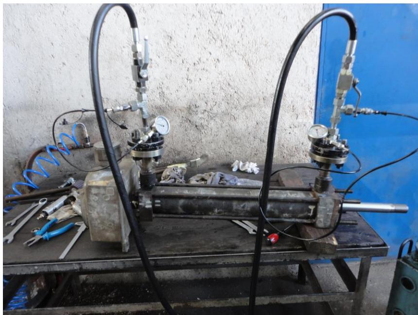
Slika 4-7 Tlačna provjera hidrauličkog cilindra
