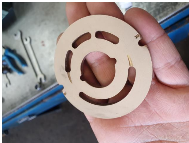
Slika 4-4 Razdjelna ploča nakon poliranja
