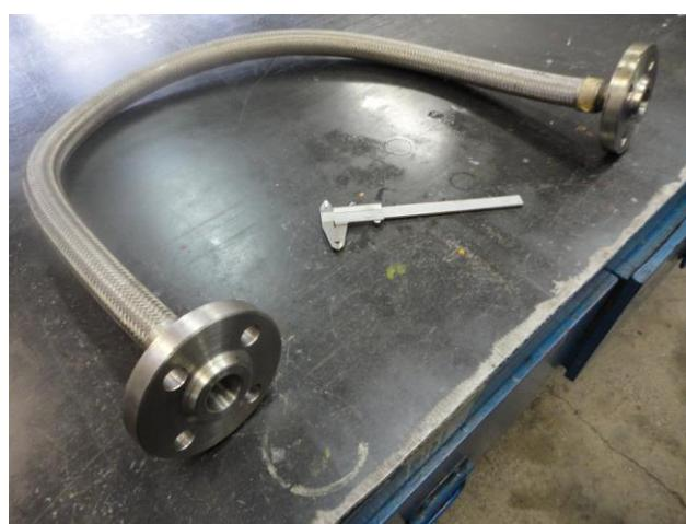
Slika 3-17 Fleksibilne hidrauličke cijevi "PFXG Ansi"
