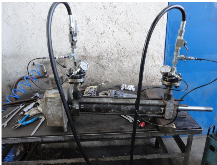
Slika 4-7 Tlačna provjera hidrauličkog cilindra
