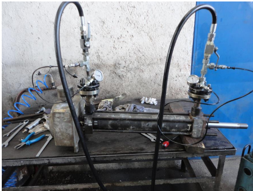
Slika 4-7 Tlačna provjera hidrauličkog cilindra
