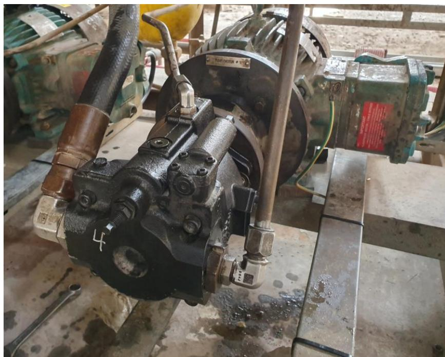
Slika 4-1 Hidraulička pumpa i elektromotor
