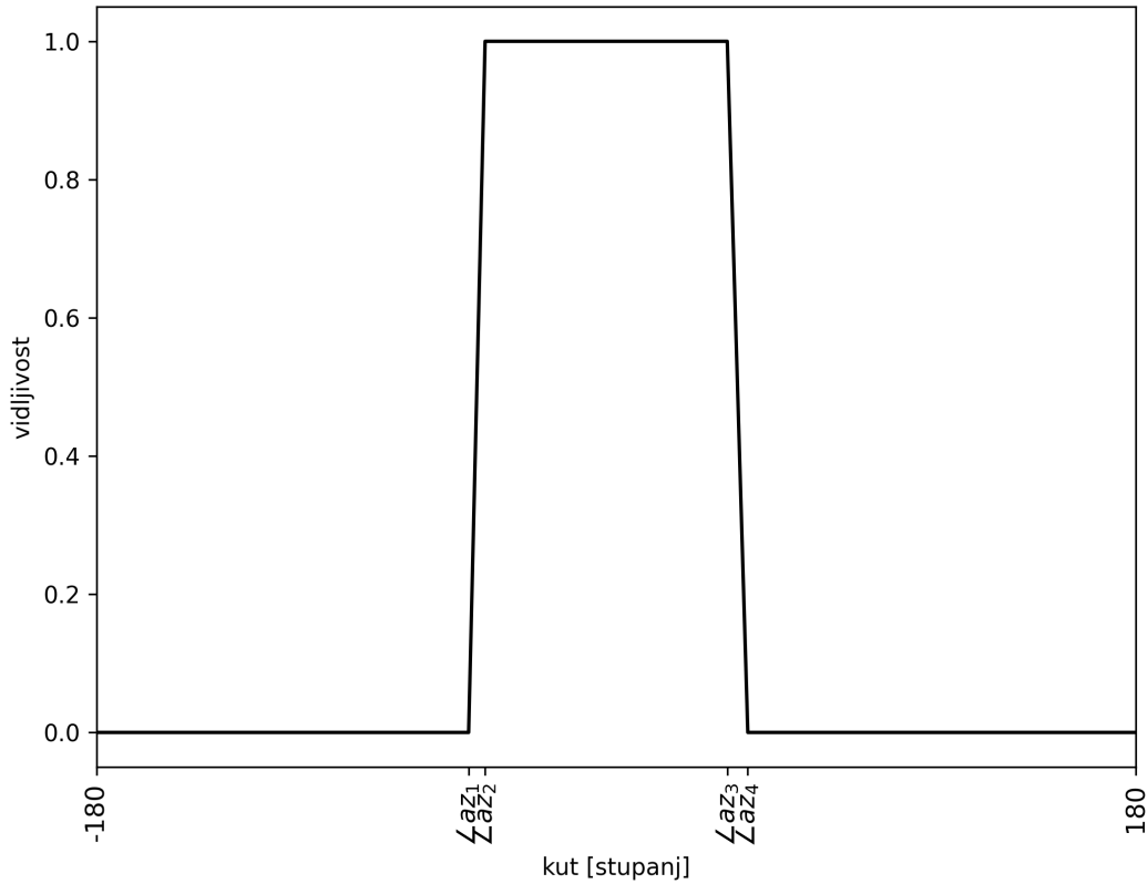
Slika 4.10: Primjer funkcije vidljivosti u ovisnosti o kutu azimuta v_\varphi(v_o) za stereo kameru
