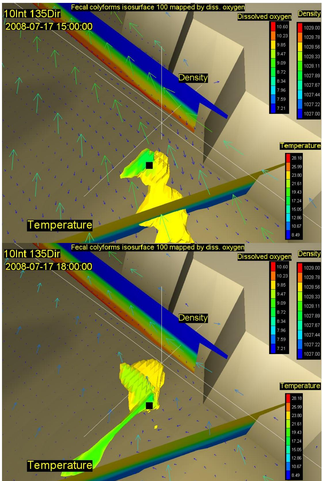
Slika 20. Vektori brzina na površini (rijetki raster) i na dubini od 30m (gusti raster) s vertikalnim profilom gustoće i temperature, te oblakom onečišćenja koncentracije 100 FC(100 ml)<sup>-1</sup> za 18. (gore) i 21. st (dolje) za vjetar intenziteta 10 ms<sup>-1</sup> iz smjera 135 stupnjeva
