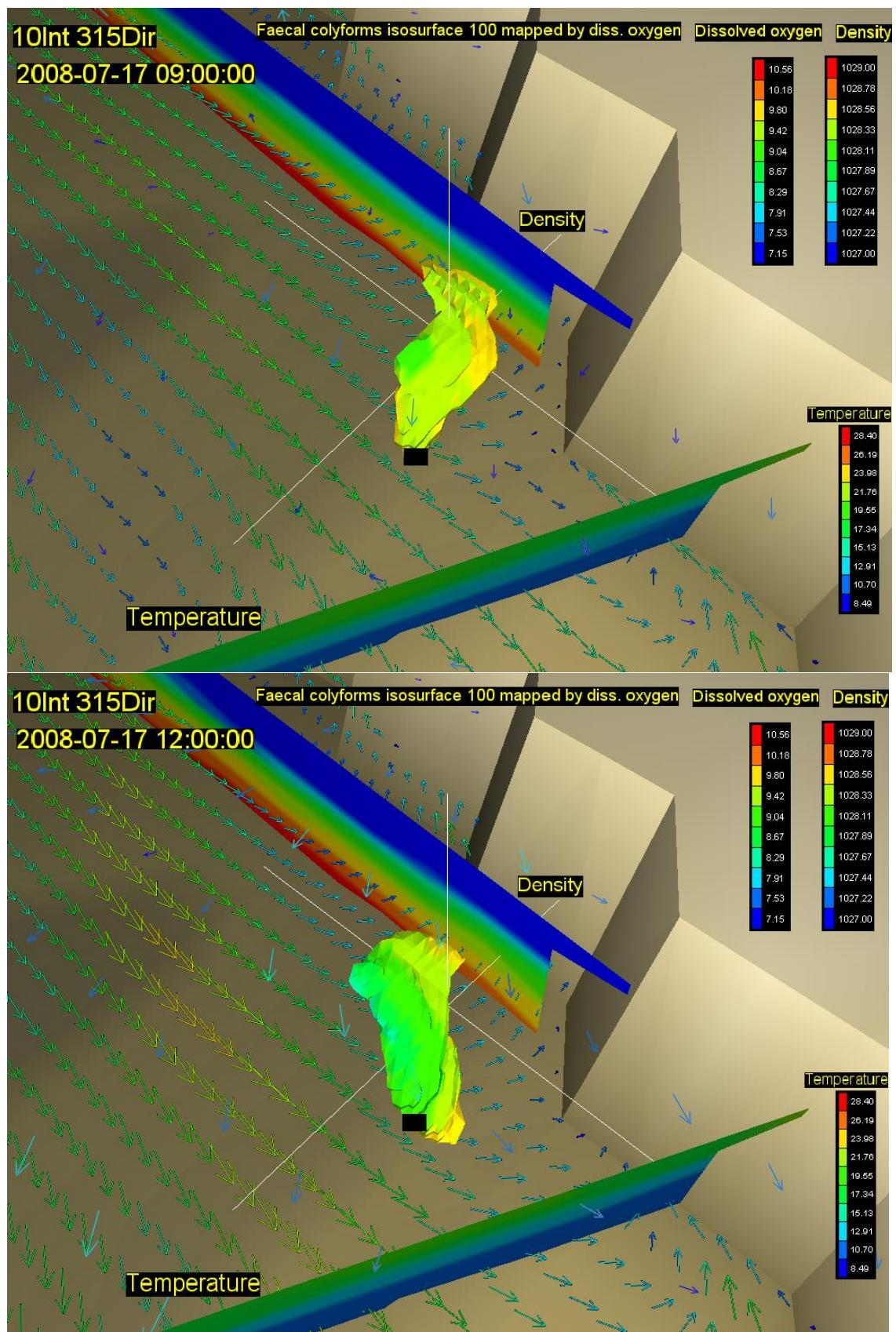
Slika 87. Vektori brzina na površini (rijetki raster) i na dubini od 20m (gusti raster) s vertikalnim profilom gustoće i temperature, te oblakom onečišćenja koncentracije 100 FC( $100 \text{ ml}^{-1}$ ) za 15. (gore) i 18. st (dolje) za vjetar intenziteta  $10 \text{ ms}^{-1}$  iz smjera 315 stupnjeva
