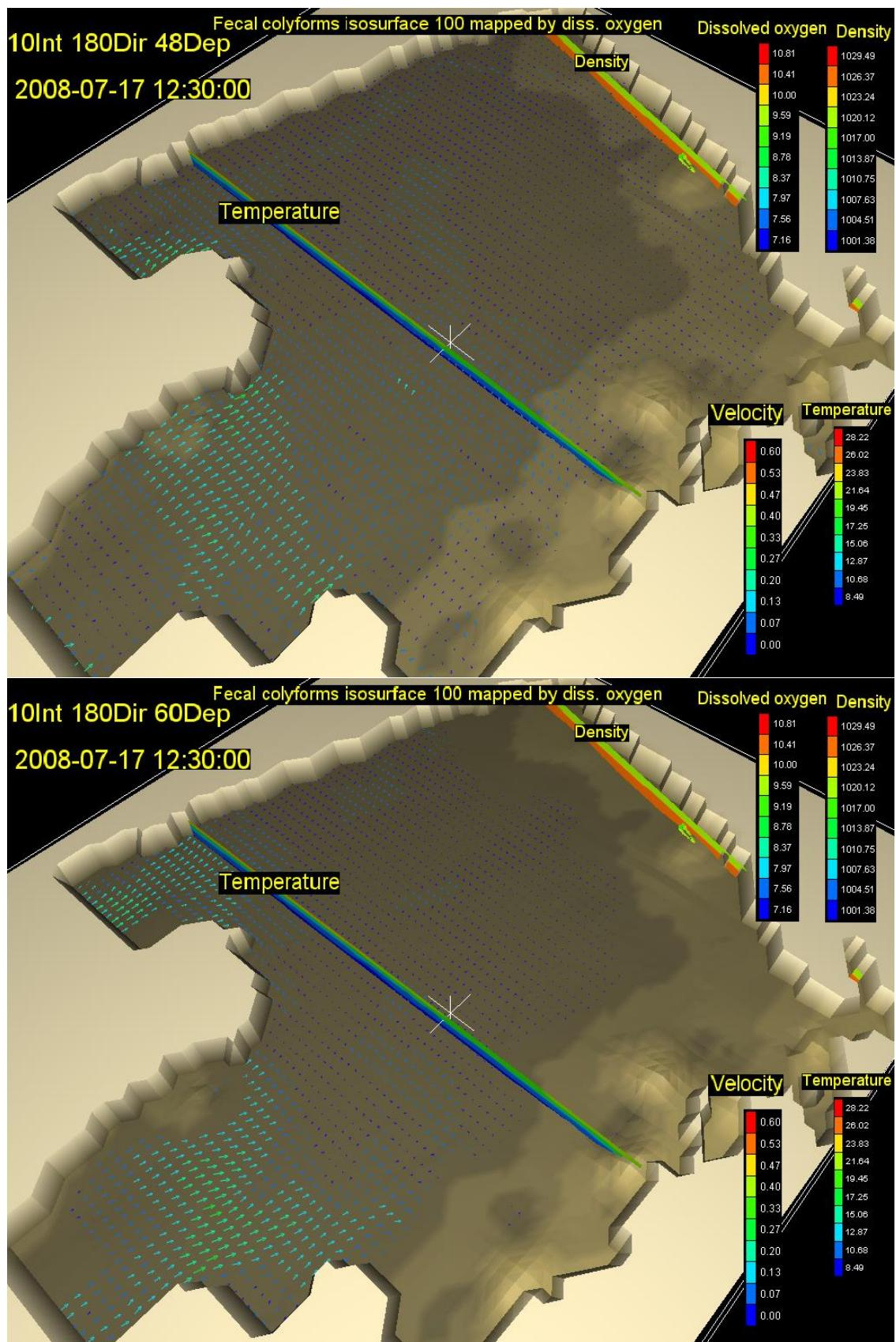
Slika 66. Vektori brzina na dubini od 48m (gore) i 60m (dolje) s vertikalnim profilom gustoće i temperature, te oblakom onečišćenja koncentracije  $100 \text{ FC}(100 \text{ ml})^{-1}$  za 16,5. st za vjetar intenziteta  $10 \text{ ms}^{-1}$  iz smjera 180 stupnjeva
