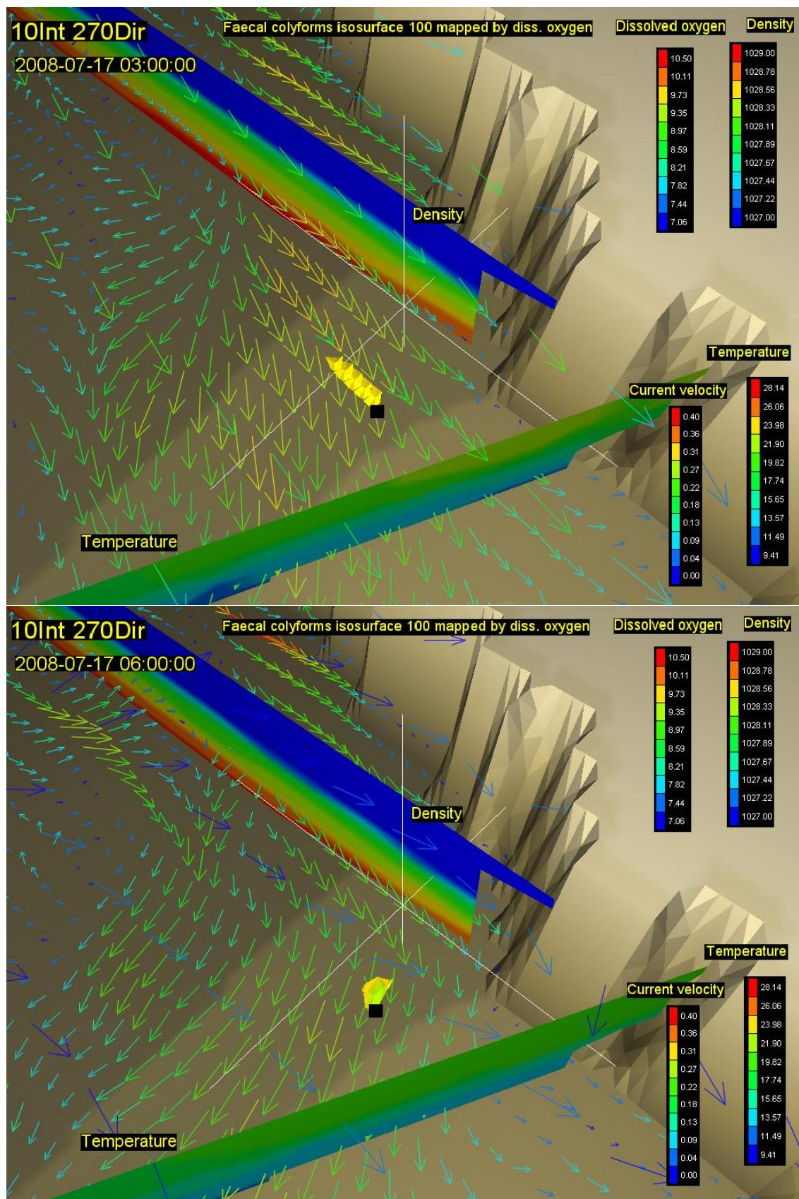
Slika 77. Vektori brzina na površini (rijetki raster) i na dubini od 20m (gusti raster) s vertikalnim profilom gustoće i temperature, te oblakom onečišćenja koncentracije 100 FC( $100 \text{ ml}^{-1}$ ) za 09. (gore) i 12. st (dolje) za vjetar intenziteta  $10 \text{ ms}^{-1}$  iz smjera 270 stupnjeva
