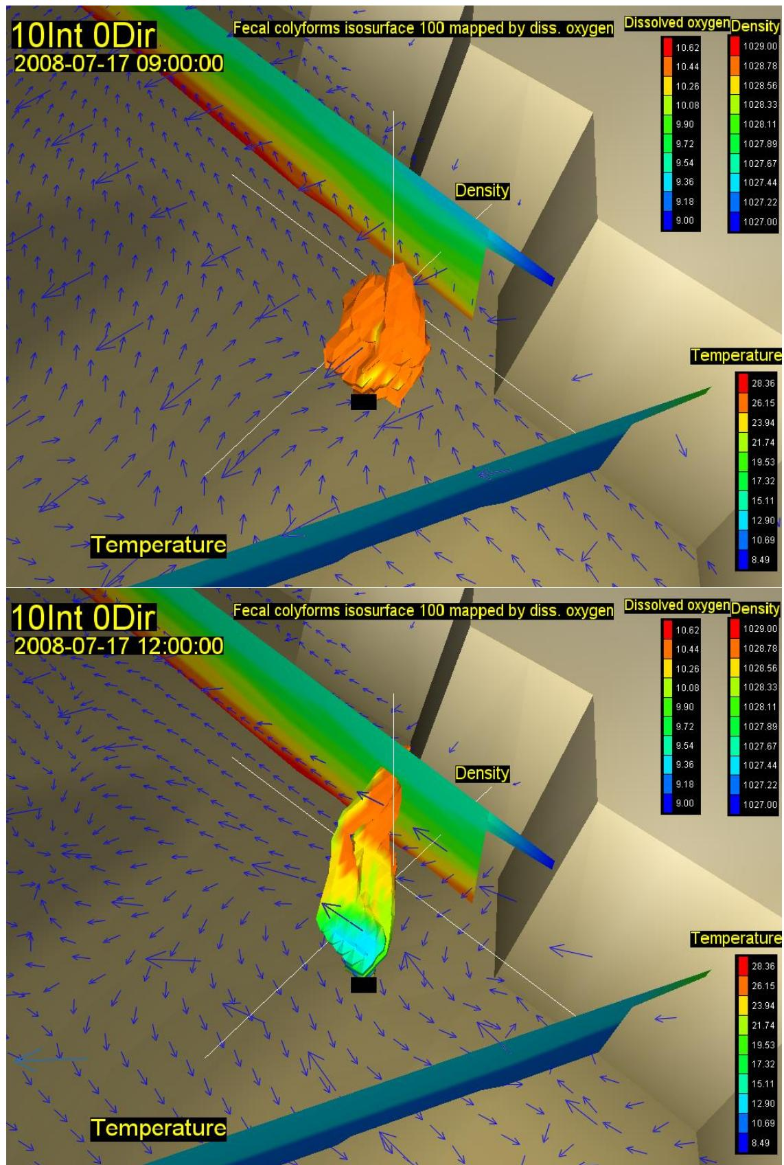
Slika 43. Vektori brzina na površini (rijetki raster) i na dubini od 20m (gusti raster) s vertikalnim profilom gustoće i temperature, te oblakom onečišćenja koncentracije 100 FC(100 ml)<sup>-1</sup> za 15. (gore) i 18. st (dolje) za vjetar intenziteta 10 ms<sup>-1</sup> iz smjera 0 stupnjeva
