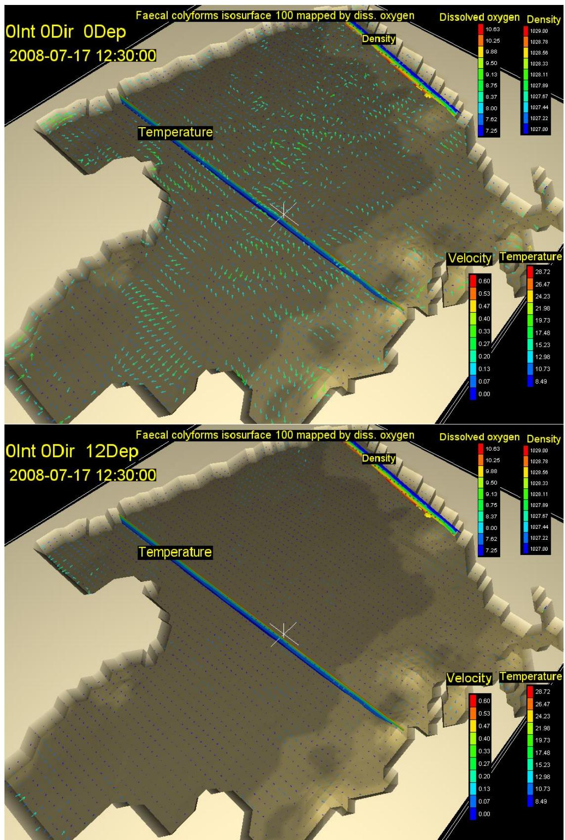
Slika 38. Vektori brzina na površini (gore) i na dubini od 12m (dolje) s vertikalnim profilom gustoće i temperature, te oblakom onečišćenja koncentracije 100 FC(100 ml)<sup>-1</sup> za 16,5. st za vjetar intenziteta 0  $\text{ms}^{-1}$  iz smjera 0 stupnjeva
