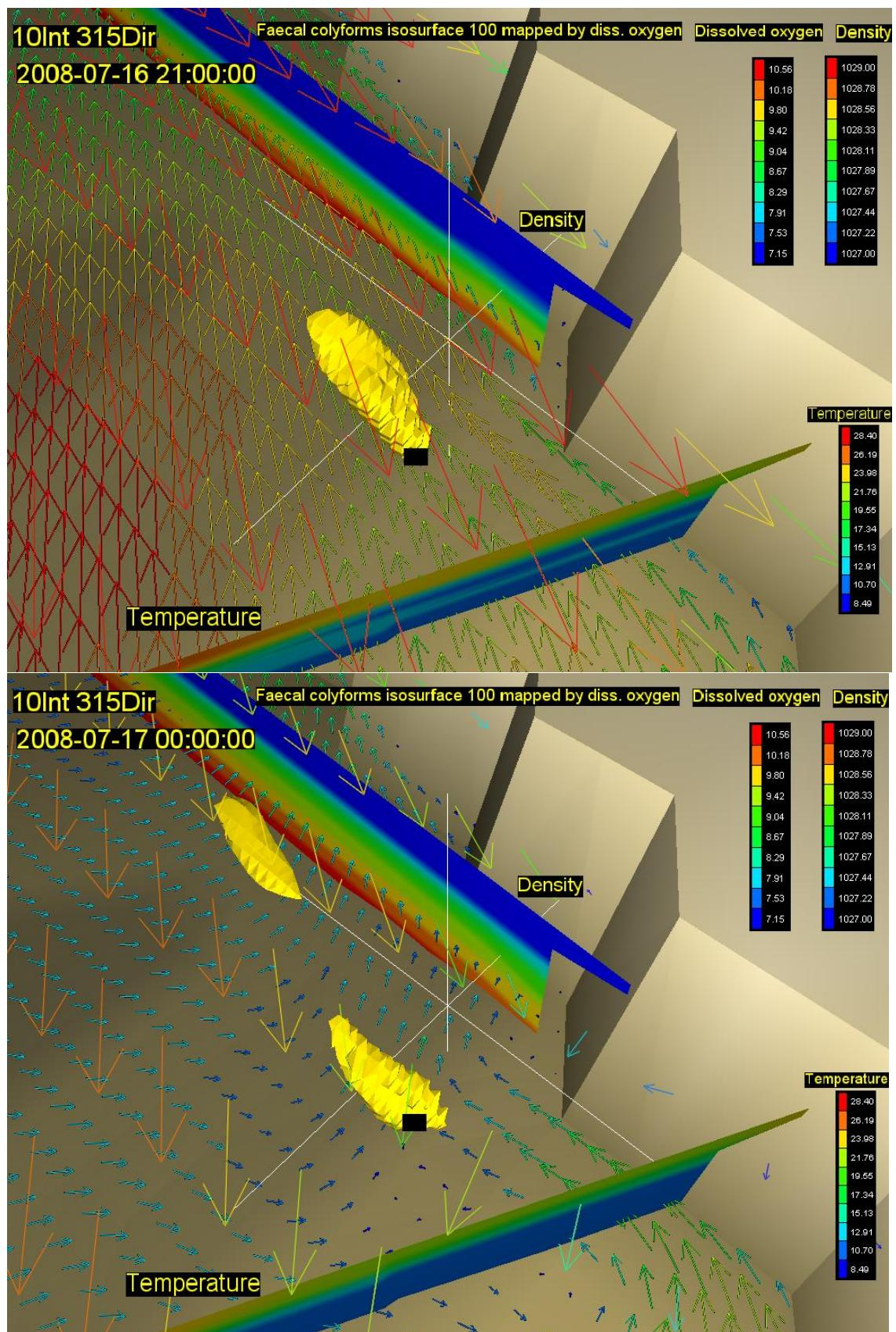
Slika 85. Vektori brzina na površini (rijetki raster) i na dubini od 20m (gusti raster) s vertikalnim profilom gustoće i temperature, te oblakom onečišćenja koncentracije 100 FC( $100 \text{ ml}^{-1}$ ) za 03. (gore) i 06. st (dolje) za vjetar intenziteta  $10 \text{ ms}^{-1}$  iz smjera 315 stupnjeva
