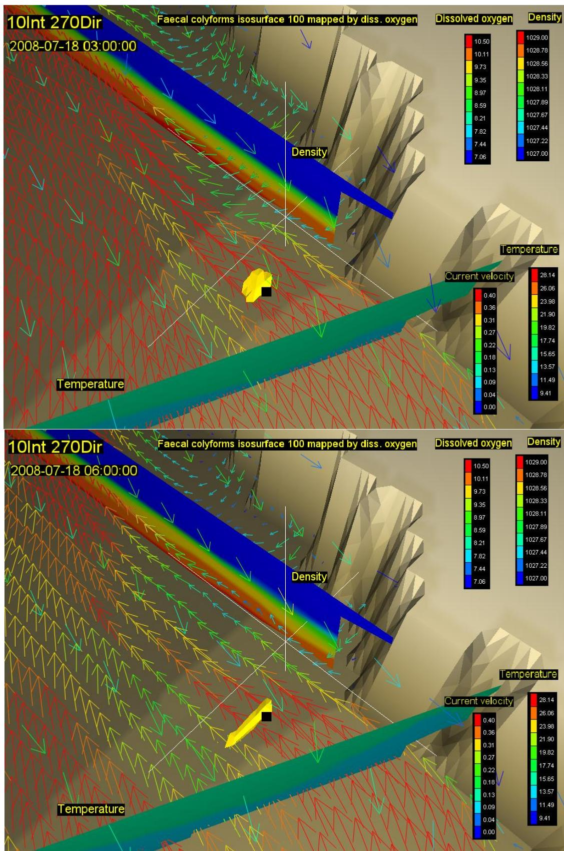
Slika 81. Vektori brzina na površini (rijetki raster) i na dubini od 20m (gusti raster) s vertikalnim profilom gustoće i temperature, te oblakom onečišćenja koncentracije 100 FC(100 ml)<sup>-1</sup> za 33. (gore) i 36. st (dolje) za vjetar intenziteta 10 ms<sup>-1</sup> iz smjera 270 stupnjeva
