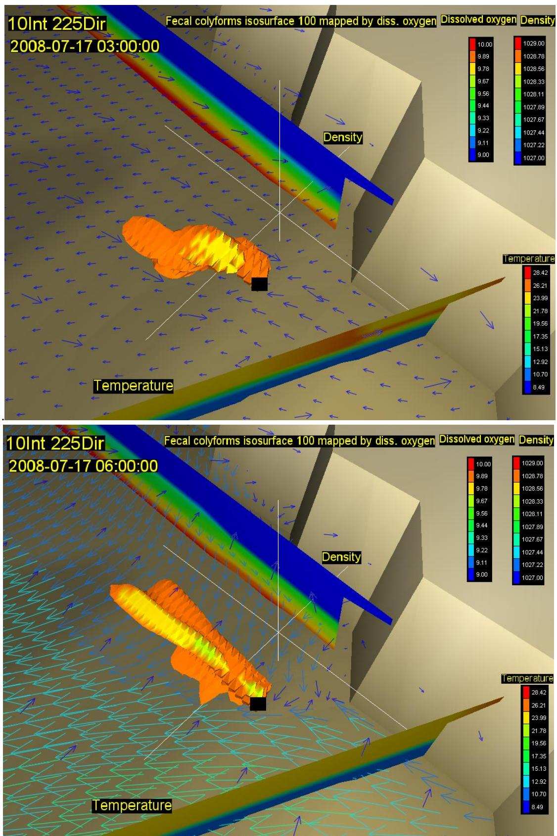
Slika 68. Vektori brzina na površini (rijetki raster) i na dubini od 20m (gusti raster) s vertikalnim profilom gustoće i temperature, te oblakom onečišćenja koncentracije 100 FC(100 ml)<sup>-1</sup> za 09. (gore) i 12. st (dolje) za vjetar intenziteta 10 ms<sup>-1</sup> iz smjera 225 stupnjeva
