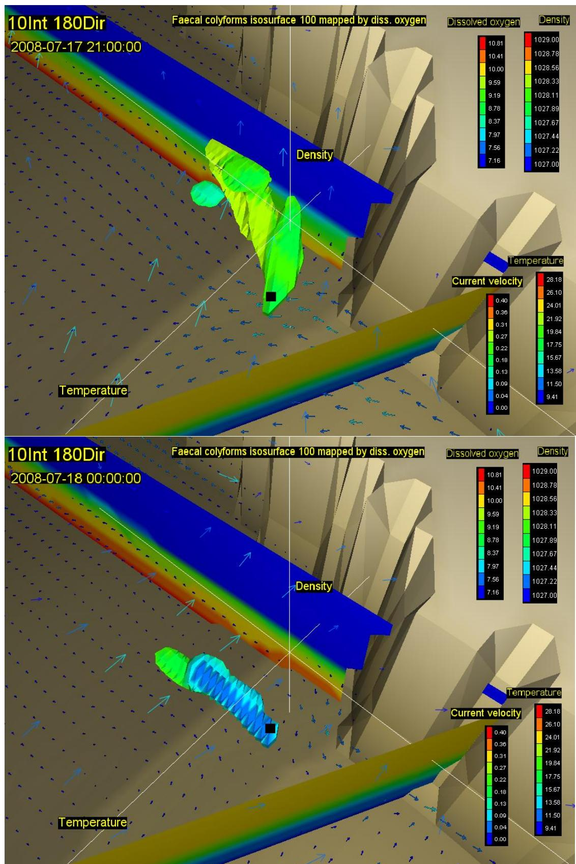
Slika 63. Vektori brzina na površini (rijetki raster) i na dubini od 20m (gusti raster) s vertikalnim profilom gustoće i temperature, te oblakom onečišćenja koncentracije 100 FC( $100 \text{ ml}^{-1}$ ) za 27. (gore) i 30. st (dolje) za vjetar intenziteta  $10 \text{ ms}^{-1}$  iz smjera 180 stupnjeva
