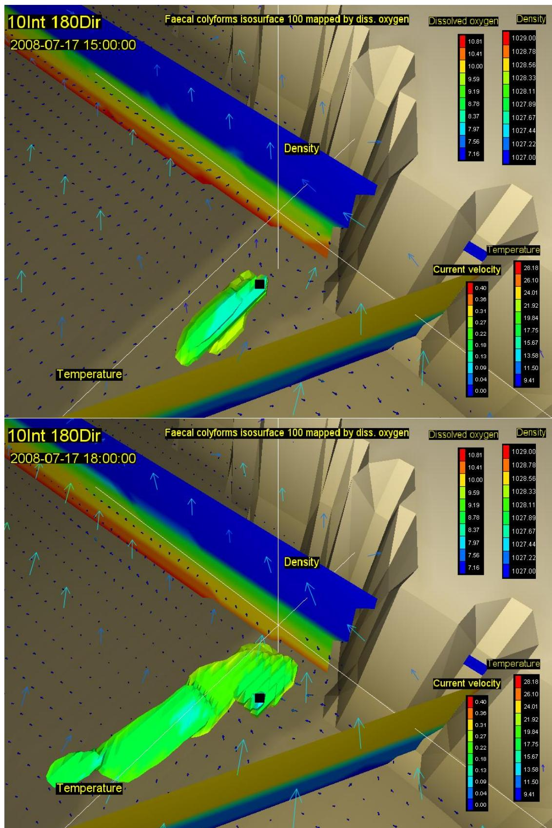
Slika 62. Vektori brzina na površini (rijetki raster) i na dubini od 20m (gusti raster) s vertikalnim profilom gustoće i temperature, te oblakom onečišćenja koncentracije 100 FC( $100 \text{ ml}^{-1}$ ) za 21. (gore) i 24. st (dolje) za vjetar intenziteta  $10 \text{ ms}^{-1}$  iz smjera 180 stupnjeva
