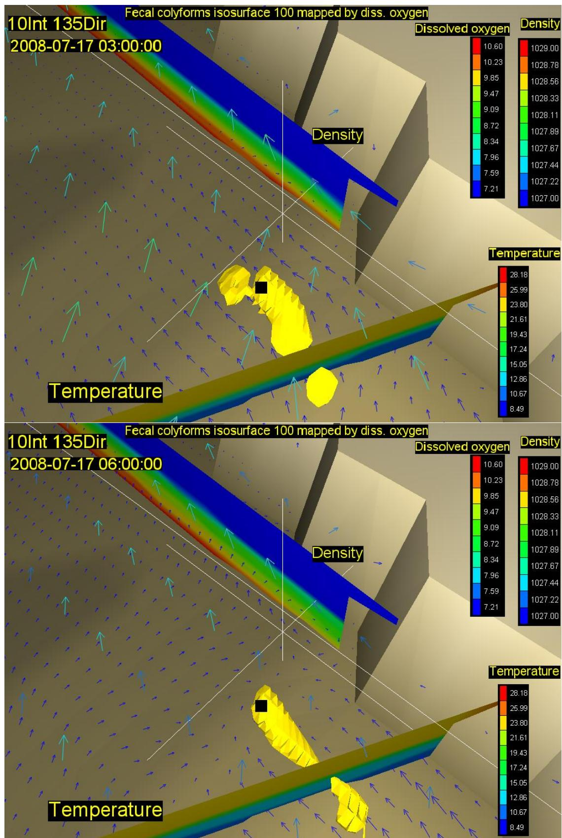
Slika 18. Vektori brzina na površini (rijetki raster) i na dubini od 30m (gusti raster) s vertikalnim profilom gustoće i temperature, te oblakom onečišćenja koncentracije 100 FC(100 ml)<sup>-1</sup> za 06. (gore) i 09. st (dolje) za vjetar intenziteta 10 ms<sup>-1</sup> iz smjera 135 stupnjeva
