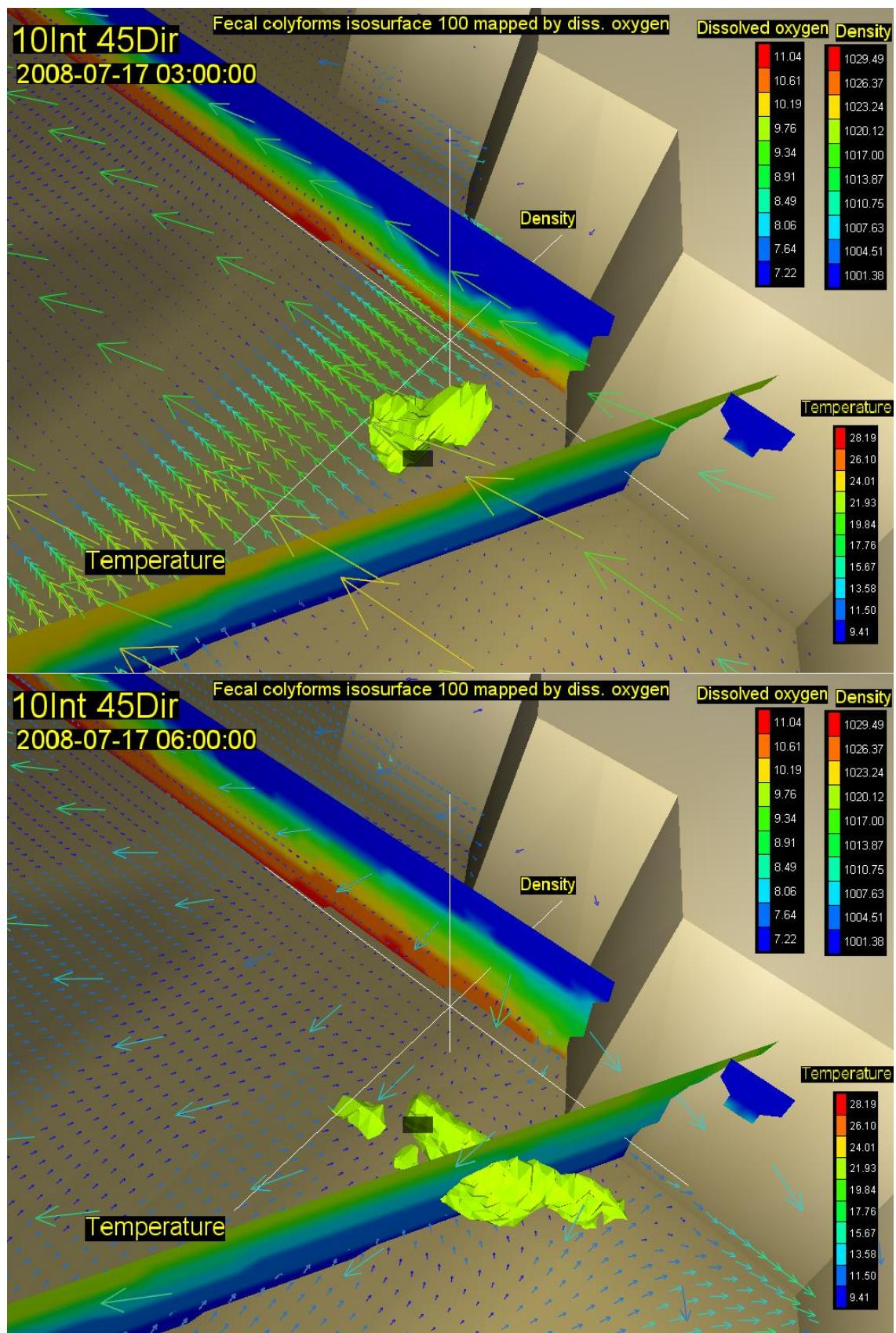
Slika 27. Vektori brzina na površini (rijetki raster) i na dubini od 30m (gusti raster) s vertikalnim profilom gustoće i temperature, te oblakom onečišćenja koncentracije 100 FC( $100 \text{ ml}^{-1}$ ) za 09. (gore) i 12. sat (dolje) za vjetar intenziteta  $10 \text{ ms}^{-1}$  iz smjera 45 stupnjeva
