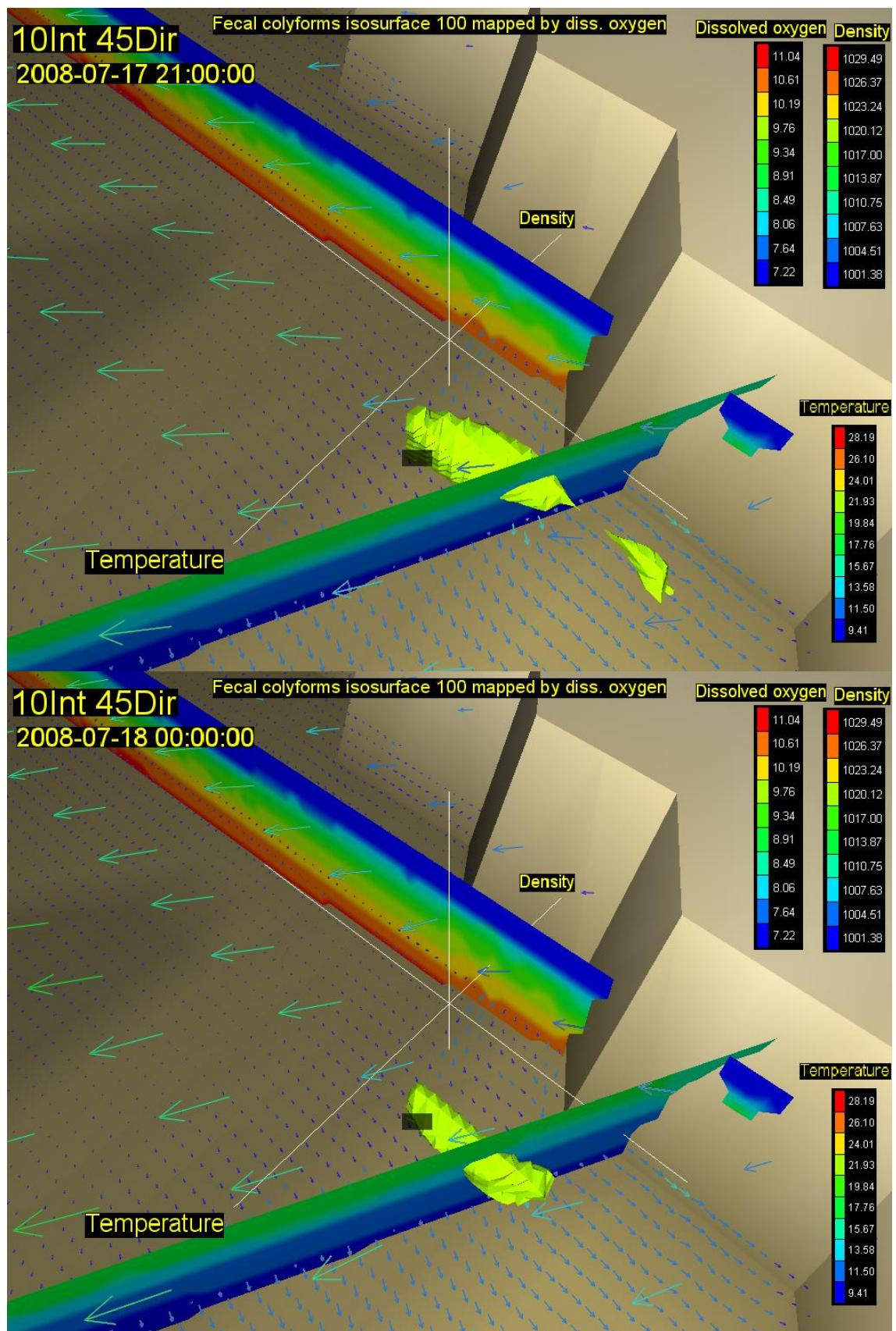
Slika 30. Vektori brzina na površini (rijetki raster) i na dubini od 30m (gusti raster) s vertikalnim profilom gustoće i temperature, te oblakom onečićenja koncentracije 100 FC( $100 \text{ ml}^{-1}$ ) za 27. (gore) i 30. sat (dolje) za vjetar intenziteta  $10 \text{ ms}^{-1}$  iz smjera 45 stupnjeva
