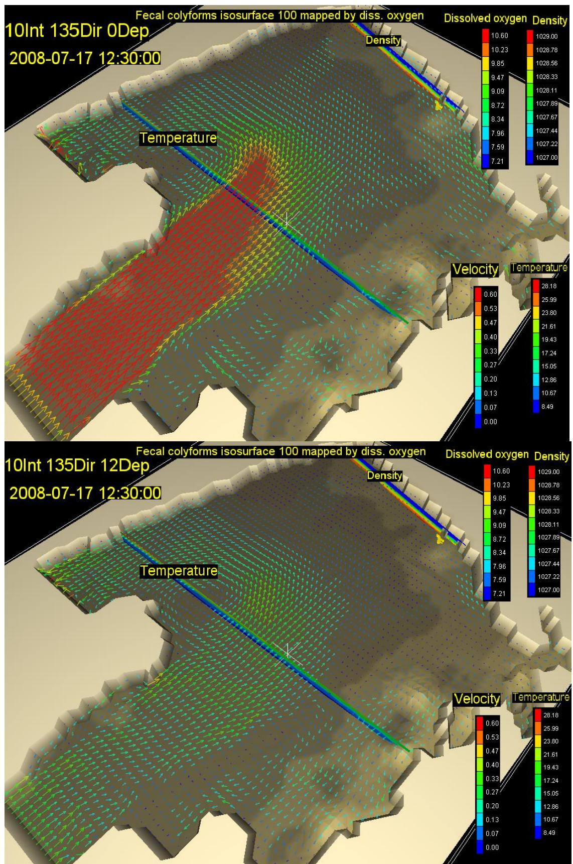
Slika 14. Vektori brzina na površini (gore) i na dubini od 12m (dolje) s vertikalnim profilom gustoće i temperature, te oblakom onečišćenja koncentracije  $100 \text{ FC}(100 \text{ ml})^{-1}$  za 16,5. st za vjetar intenziteta  $10 \text{ ms}^{-1}$  iz smjera 135 stupnjeva.
