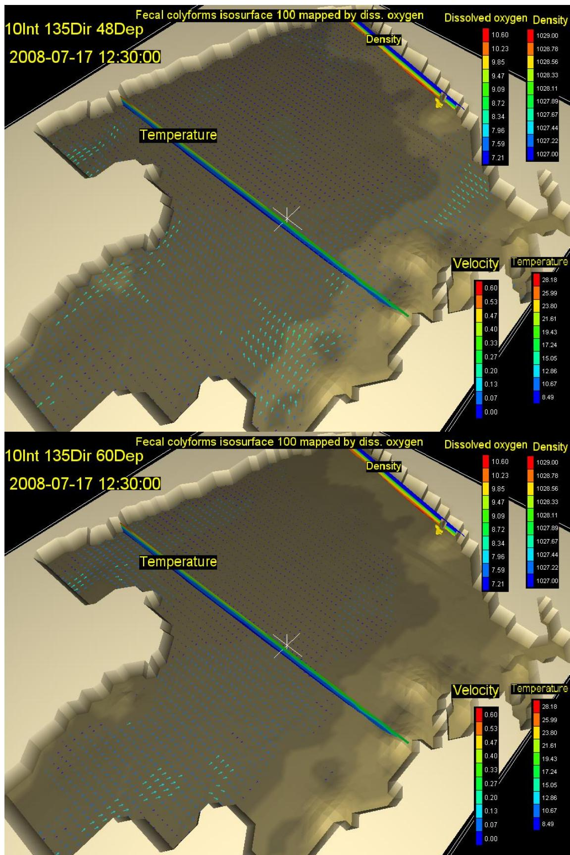
Slika 16. Vektori brzina na dubini od 48m (gore) i 60m (dolje) s vertikalnim profilom gustoće i temperature, te oblakom onečišćenja koncentracije  $100 \text{ FC}(100 \text{ ml})^{-1}$  za 16,5. st za vjetar intenziteta  $10 \text{ ms}^{-1}$  iz smjera 135 stupnjeva
