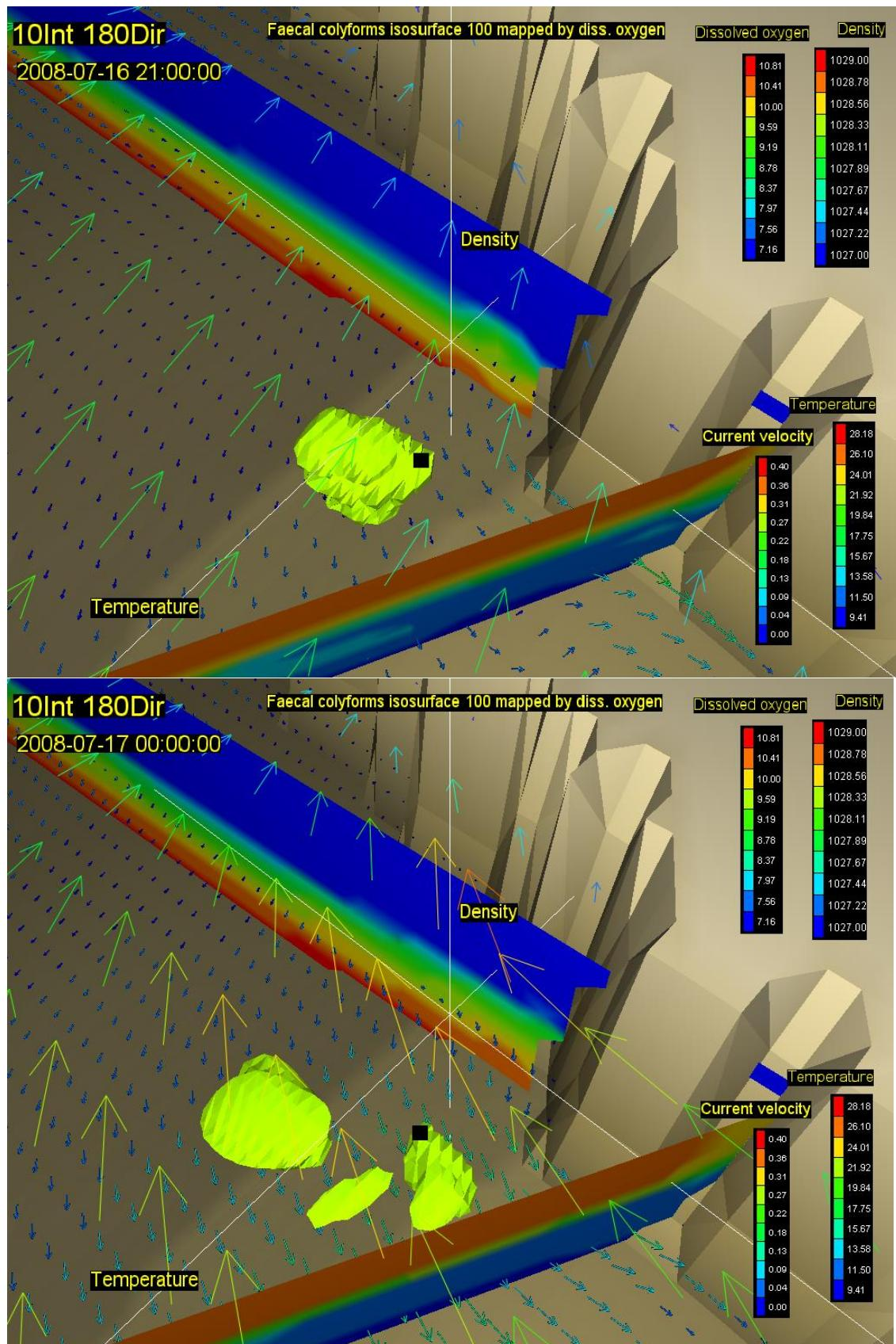
Slika 59. Vektori brzina na površini (rijetki raster) i na dubini od 20m (gusti raster) s vertikalnim profilom gustoće i temperature, te oblakom onečišćenja koncentracije 100 FC( $100 \text{ ml}^{-1}$ ) za 03. (gore) i 06. st (dolje) za vjetar intenziteta  $10 \text{ ms}^{-1}$  iz smjera 180 stupnjeva
