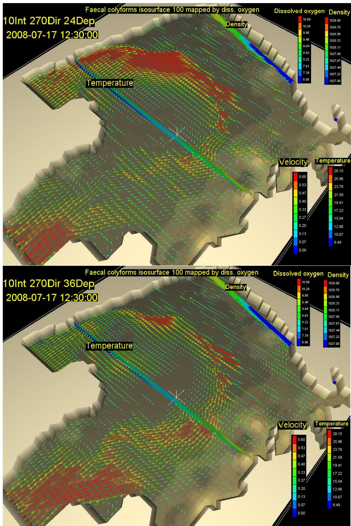
Slika 83. Vektori brzina na dubini od 24m (gore) i 36m (dolje) s vertikalnim profilom gustoće i temperature, te oblakom onečišćenja koncentracije  $100 \text{ FC}(100 \text{ ml})^{-1}$  za 16,5. st za vjetar intenziteta  $10 \text{ ms}^{-1}$  iz smjera 270 stupnjeva
