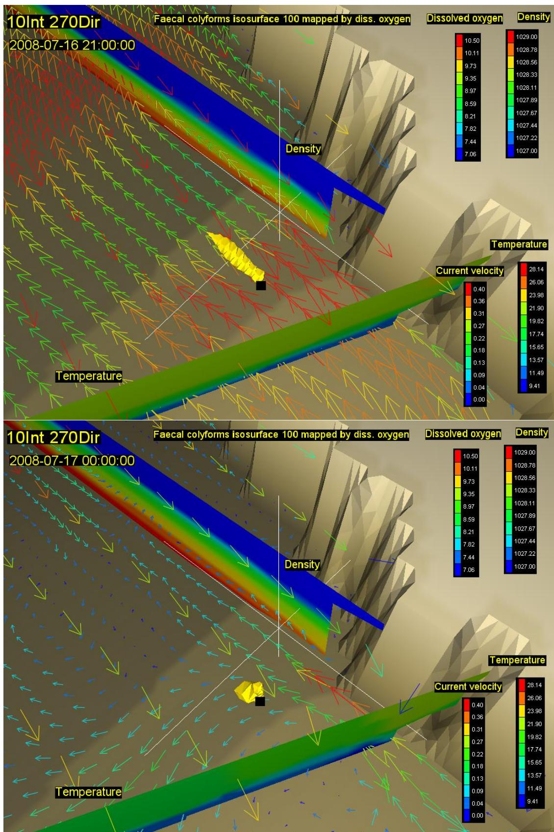
Slika 76. Vektori brzina na površini (rijetki raster) i na dubini od 20m (gusti raster) s vertikalnim profilom gustoće i temperature, te oblakom onečišćenja koncentracije 100 FC(100 ml)<sup>-1</sup> za 03. (gore) i 06. st (dolje) za vjetar intenziteta 10 ms<sup>-1</sup> iz smjera 270 stupnjeva
