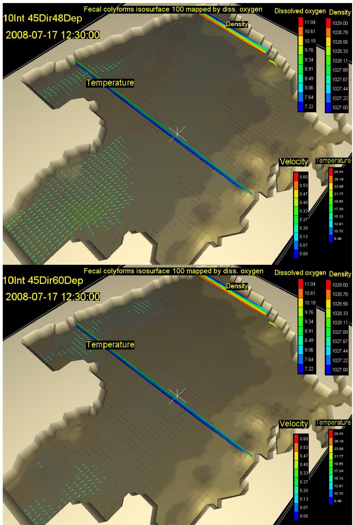
Slika 25. Vektori brzina na dubini od 48m (gore) i na 60 (dolje) s vertikalnim profilom gustoće i temperature, te oblakom onečišćenja koncentracije  $100 \text{ FC}(100 \text{ ml})^{-1}$  za 16,5. sat za vjetar intenziteta  $10 \text{ ms}^{-1}$  iz smjera 45 stupnjeva
