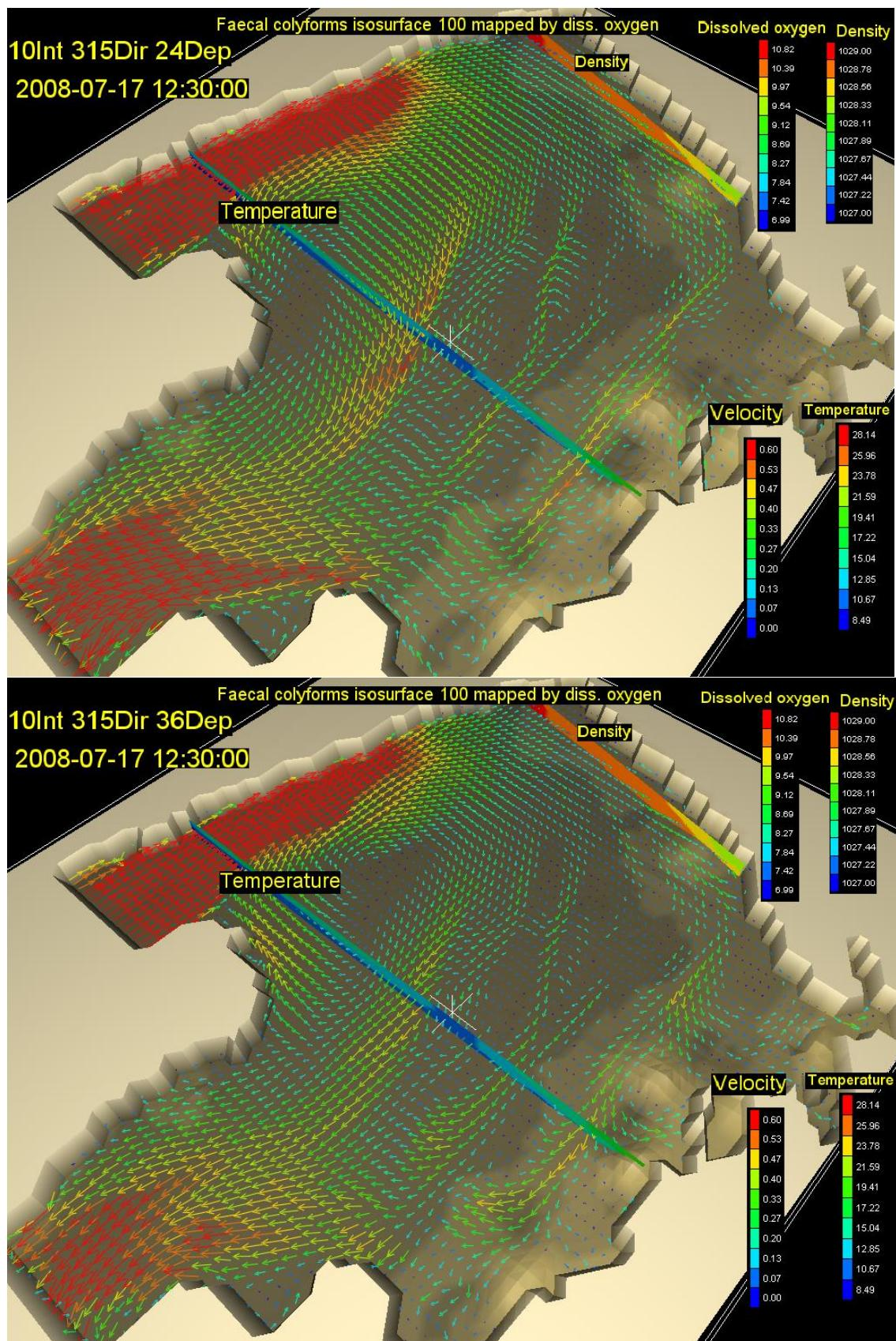
Slika 92. Vektori brzina na dubini od 24m (gore) i 36m (dolje) s vertikalnim profilom gustoće i temperature, te oblakom onečišćenja koncentracije  $100 \text{ FC}(100 \text{ ml})^{-1}$  za 16,5. st za vjetar intenziteta  $10 \text{ ms}^{-1}$  iz smjera 315 stupnjeva
