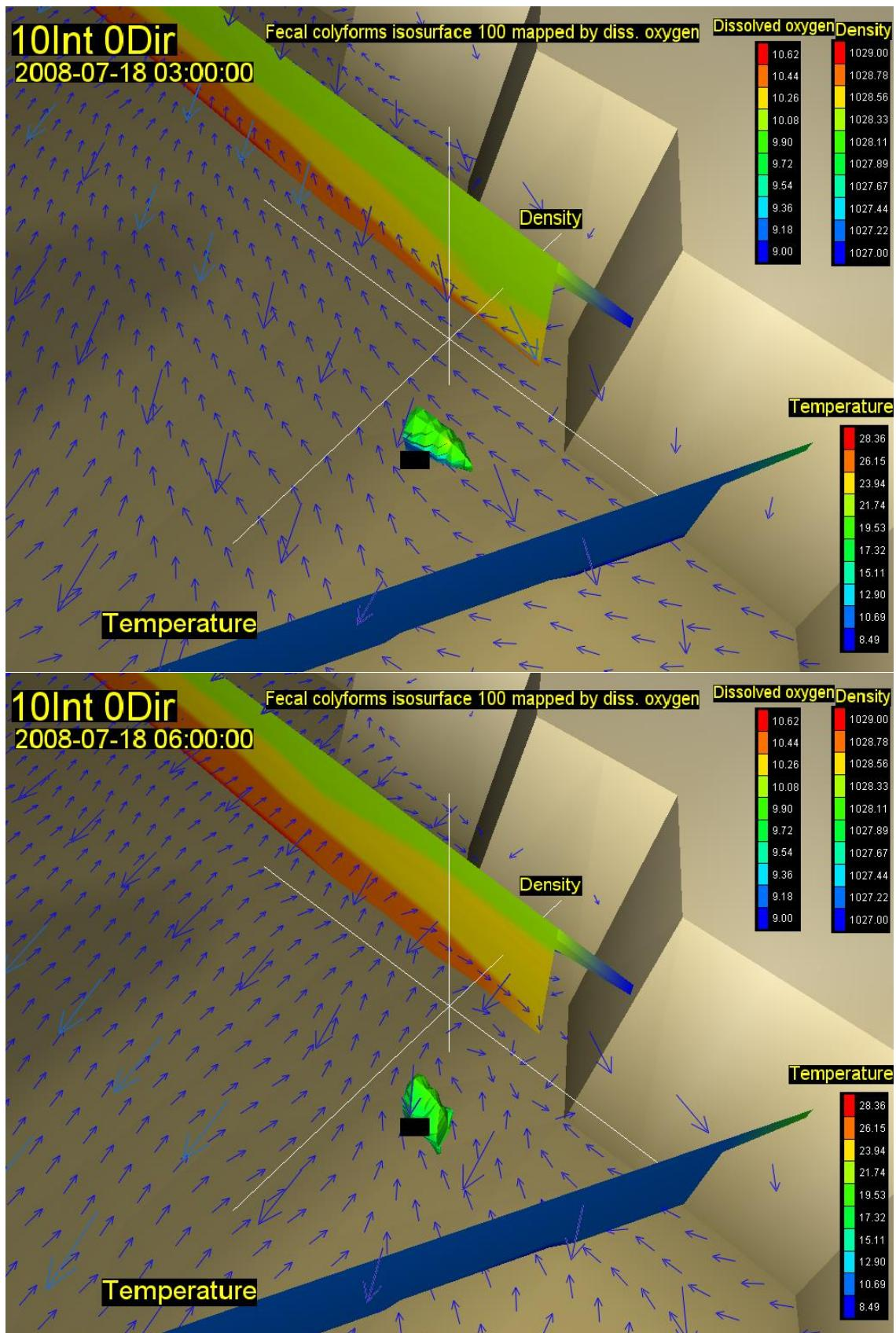
Slika 46. Vektori brzina na površini (rijetki raster) i na dubini od 20m (gusti raster) s vertikalnim profilom gustoće i temperature, te oblakom onečišćenja koncentracije 100 FC(100 ml)<sup>-1</sup> za 33. (gore) i 36. st (dolje) za vjetar intenziteta 10 ms<sup>-1</sup> iz smjera 0 stupnjeva
