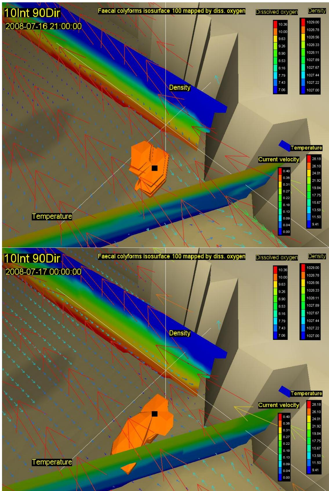
Slika 50. Vektori brzina na površini (rijetki raster) i na dubini od 20m (gusti raster) s vertikalnim profilom gustoće i temperature, te oblakom onečišćenja koncentracije 100 FC(100 ml)<sup>-1</sup> za 03. (gore) i 06. st (dolje) za vjetar intenziteta 10 ms<sup>-1</sup> iz smjera 90 stupnjeva
