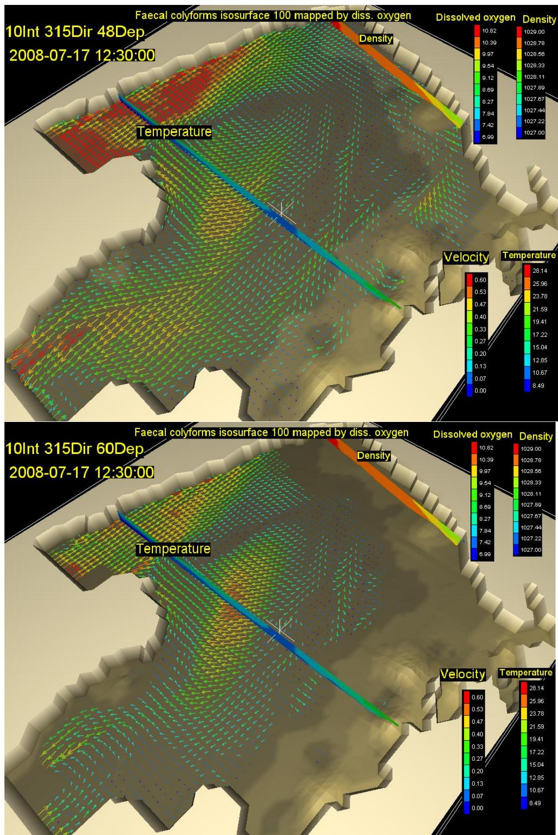
Slika 93. Vektori brzina na dubini od 48m (gore) i 60m (dolje) s vertikalnim profilom gustoće i temperature, te oblakom onečišćenja koncentracije  $100 \text{ FC}(100 \text{ ml})^{-1}$  za 16,5. st za vjetar intenziteta  $10 \text{ ms}^{-1}$  iz smjera 315 stupnjeva
