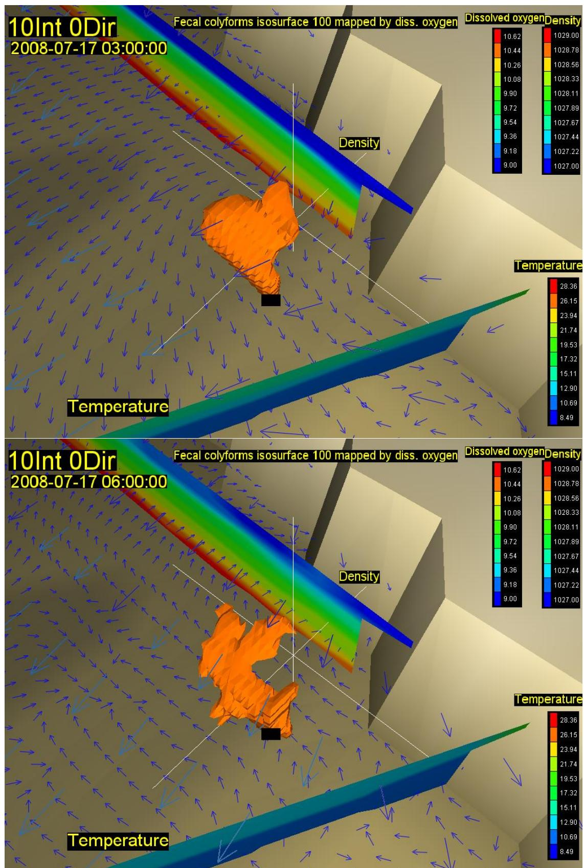
Slika 42. Vektori brzina na površini (rijetki raster) i na dubini od 20m (gusti raster) s vertikalnim profilom gustoće i temperature, te oblakom onečišćenja koncentracije 100 FC(100 ml)<sup>-1</sup> za 09. (gore) i 12. st (dolje) za vjetar intenziteta 10 ms<sup>-1</sup> iz smjera 0 stupnjeva
