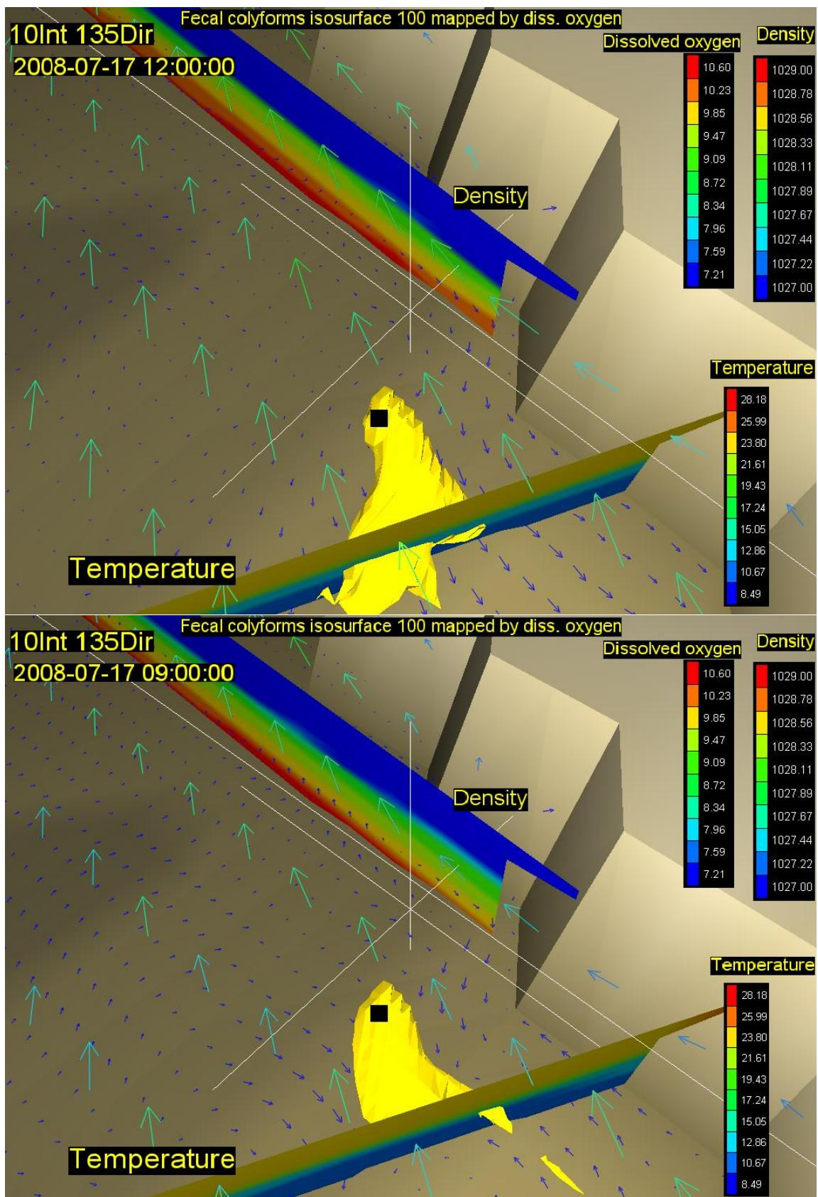
Slika 19. Vektori brzina na površini (rijetki raster) i na dubini od 30m (gusti raster) s vertikalnim profilom gustoće i temperature, te oblakom onečišćenja koncentracije 100 FC(100 ml)<sup>-1</sup> za 12. (gore) i 15. st (dolje) za vjetar intenziteta 10 ms<sup>-1</sup> iz smjera 135 stupnjeva
