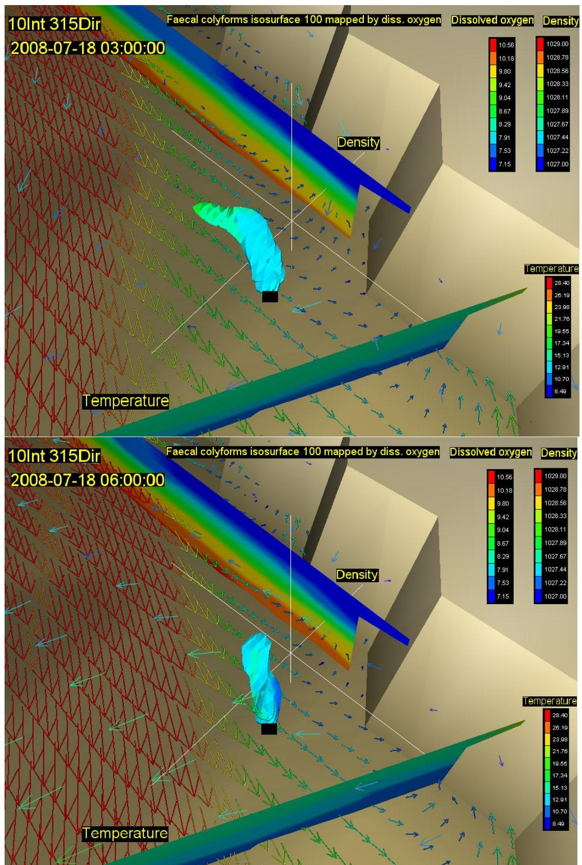
Slika 90. Vektori brzina na površini (rijetki raster) i na dubini od 20m (gusti raster) s vertikalnim profilom gustoće i temperature, te oblakom onečišćenja koncentracije 100 FC( $100 \text{ ml}^{-1}$ ) za 33. (gore) i 36. st (dolje) za vjetar intenziteta  $10 \text{ ms}^{-1}$  iz smjera 315 stupnjeva
