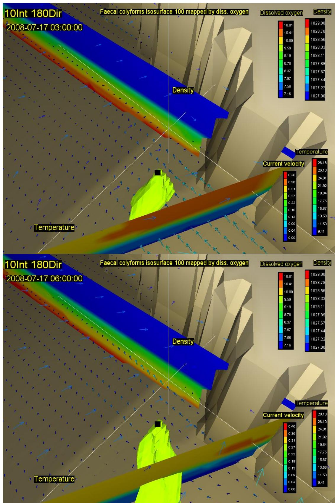
Slika 60. Vektori brzina na površini (rijetki raster) i na dubini od 20m (gusti raster) s vertikalnim profilom gustoće i temperature, te oblakom onečišćenja koncentracije 100 FC( $100 \text{ ml}^{-1}$ ) za 09. (gore) i 12. st (dolje) za vjetar intenziteta  $10 \text{ ms}^{-1}$  iz smjera 180 stupnjeva
