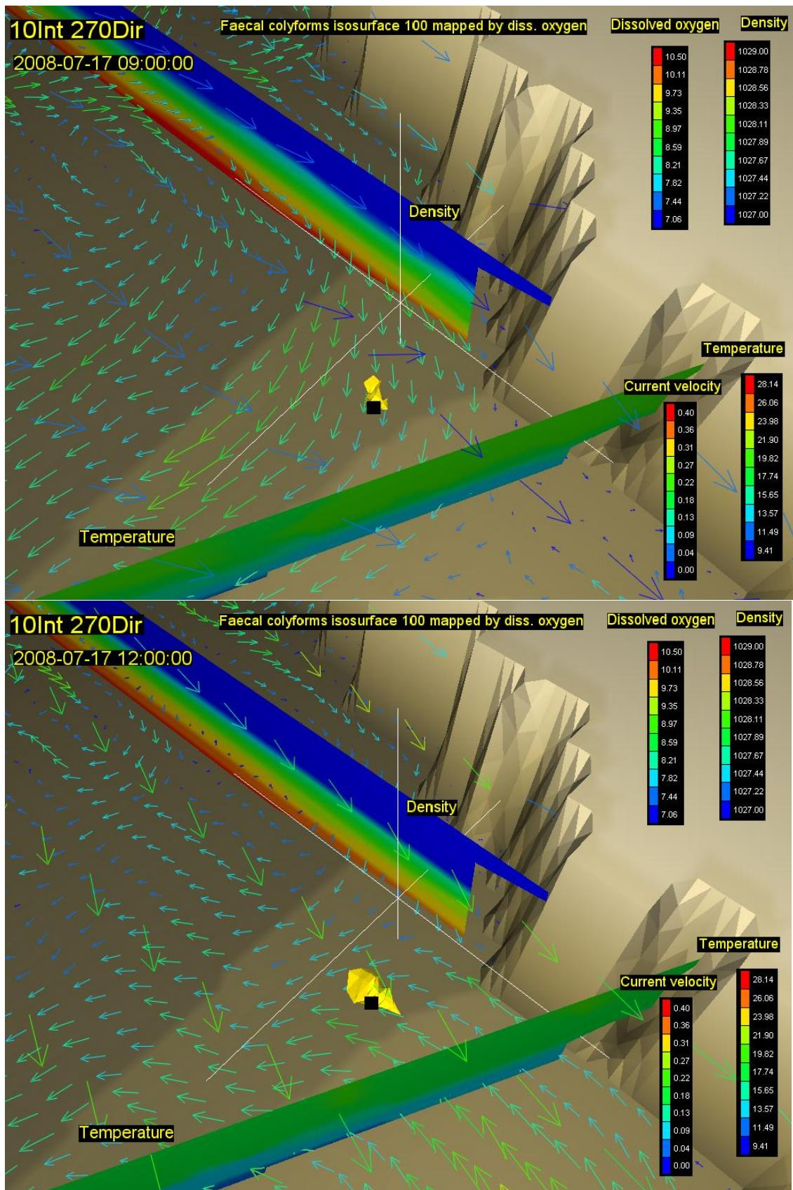
Slika 78. Vektori brzina na površini (rijetki raster) i na dubini od 20m (gusti raster) s vertikalnim profilom gustoće i temperature, te oblakom onečišćenja koncentracije 100 FC( $100 \text{ ml}^{-1}$ ) za 15. (gore) i 18. st (dolje) za vjetar intenziteta  $10 \text{ ms}^{-1}$  iz smjera 270 stupnjeva
