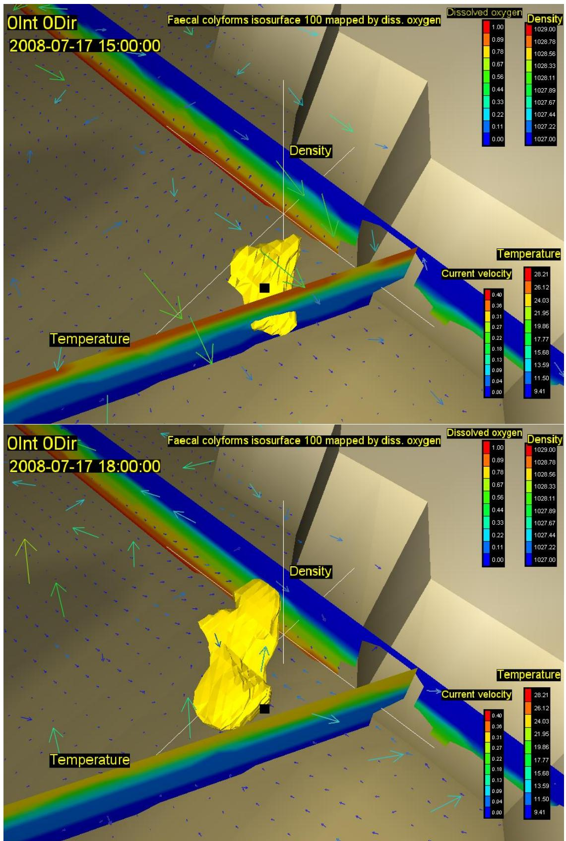
Slika 35. Vektori brzina na površini (rijetki raster) i na dubini od 20m (gusti raster) s vertikalnim profilom gustoće i temperature, te oblakom onečišćenja koncentracije 100 FC(100 ml)<sup>-1</sup> za 18. (gore) i 21. st (dolje) za vjetar intenziteta 0 ms<sup>-1</sup> iz smjera 0 stupnjeva
