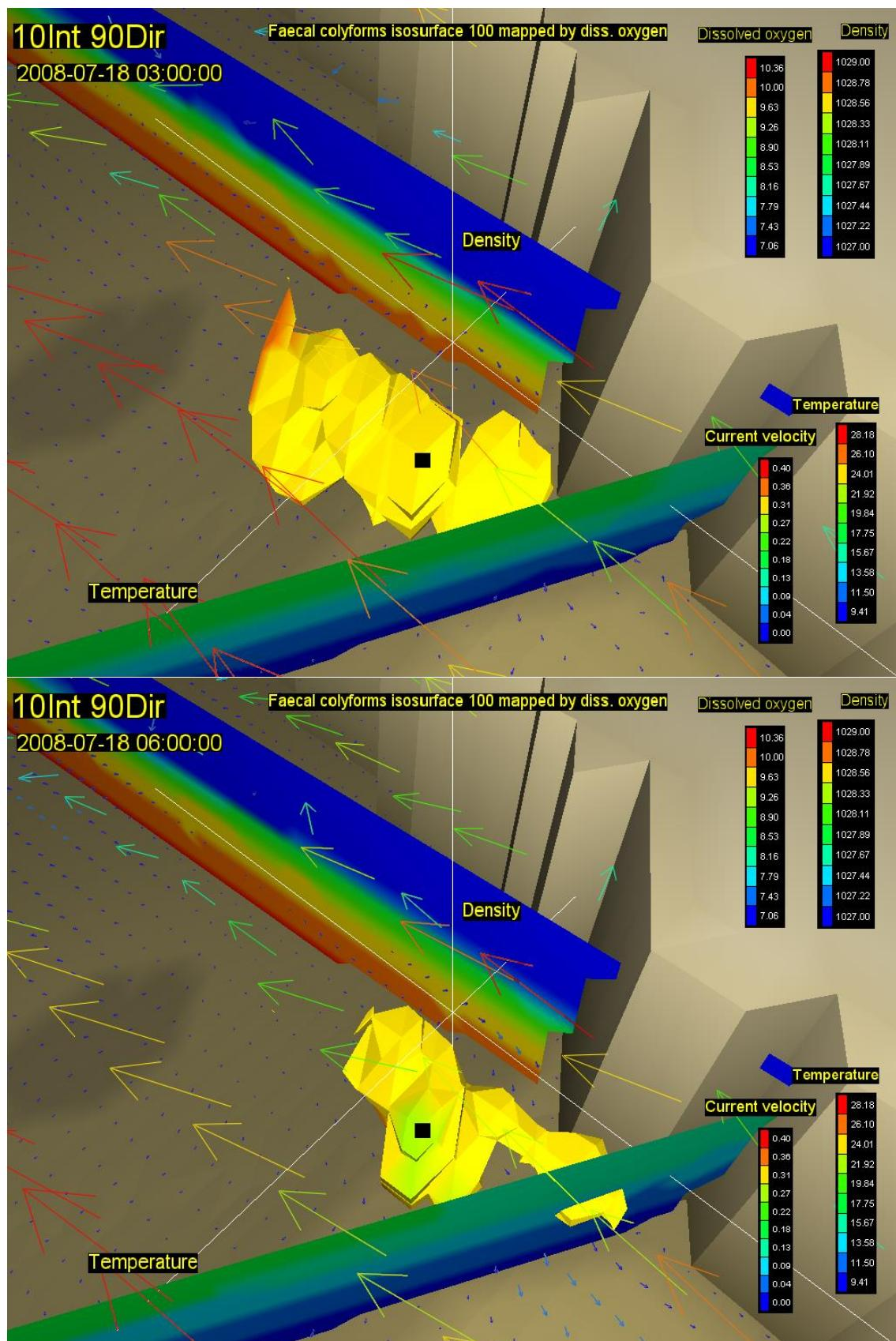
Slika 55. Vektori brzina na površini (rijetki raster) i na dubini od 20m (gusti raster) s vertikalnim profilom gustoće i temperature, te oblakom onečišćenja koncentracije 100 FC(100 ml)<sup>-1</sup> za 33. (gore) i 36. st (dolje) za vjetar intenziteta 10 ms<sup>-1</sup> iz smjera 90 stupnjeva
