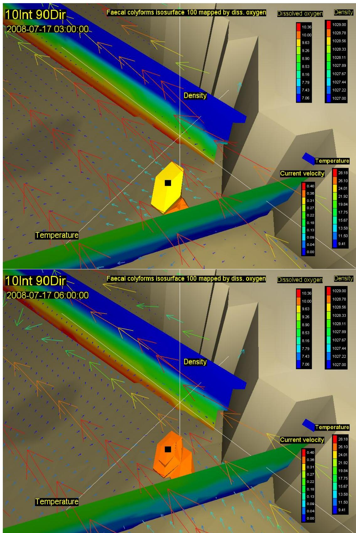
Slika 51. Vektori brzina na površini (rijetki raster) i na dubini od 20m (gusti raster) s vertikalnim profilom gustoće i temperature, te oblakom onečišćenja koncentracije 100 FC(100 ml)<sup>-1</sup> za 09. (gore) i 12. st (dolje) za vjetar intenziteta 10 ms<sup>-1</sup> iz smjera 90 stupnjeva
