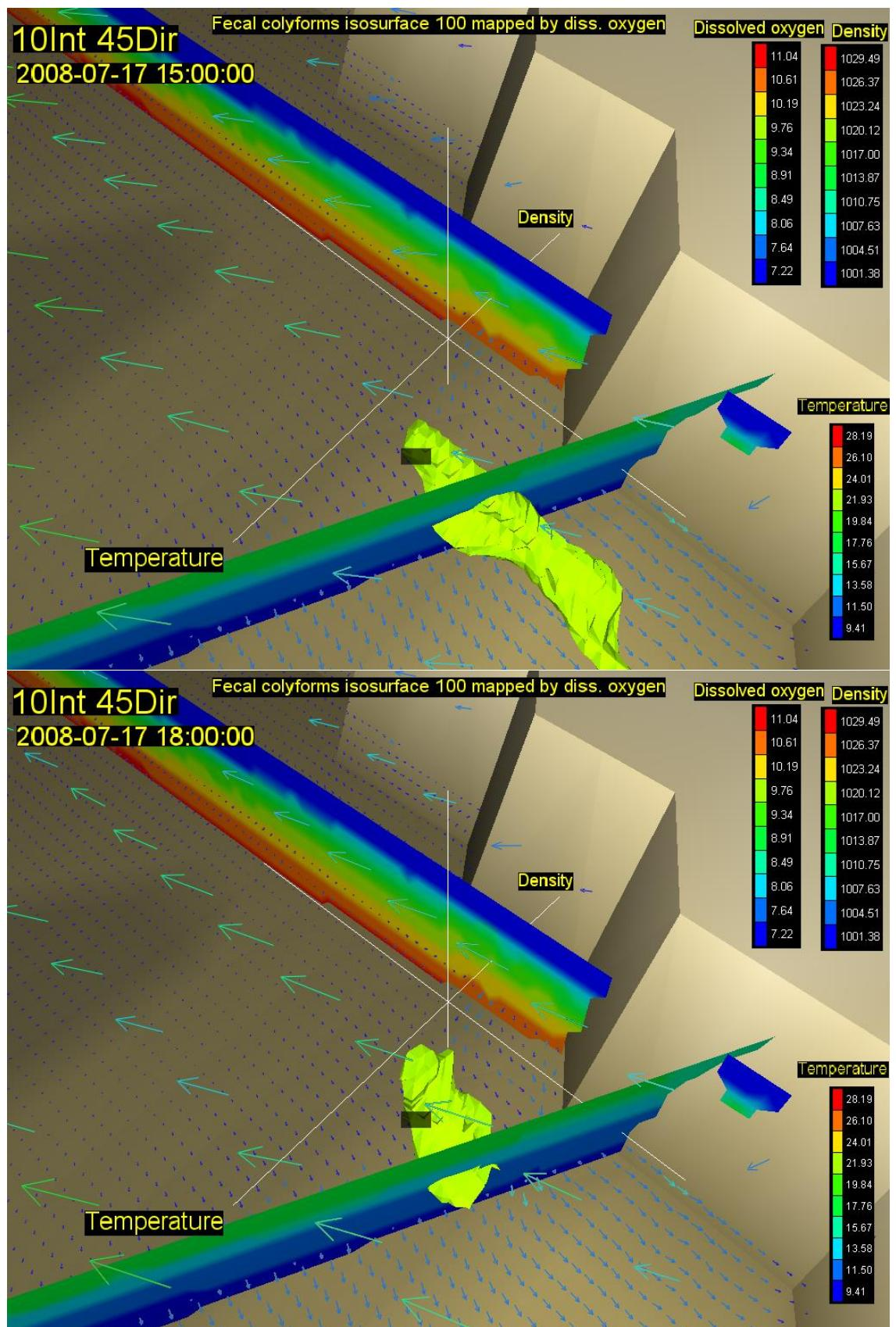
Slika 29 . Vektori brzina na površini (rijetki raster) i na dubini od 30m (gusti raster) s vertikalnim profilom gustoće i temperature, te oblakom onečišćenja koncentracije 100 FC(100 ml)<sup>-1</sup> za 21. (gore) i 24. sat (dolje) za vjetar intenziteta 10 ms<sup>-1</sup> iz smjera 45 stupnjeva
