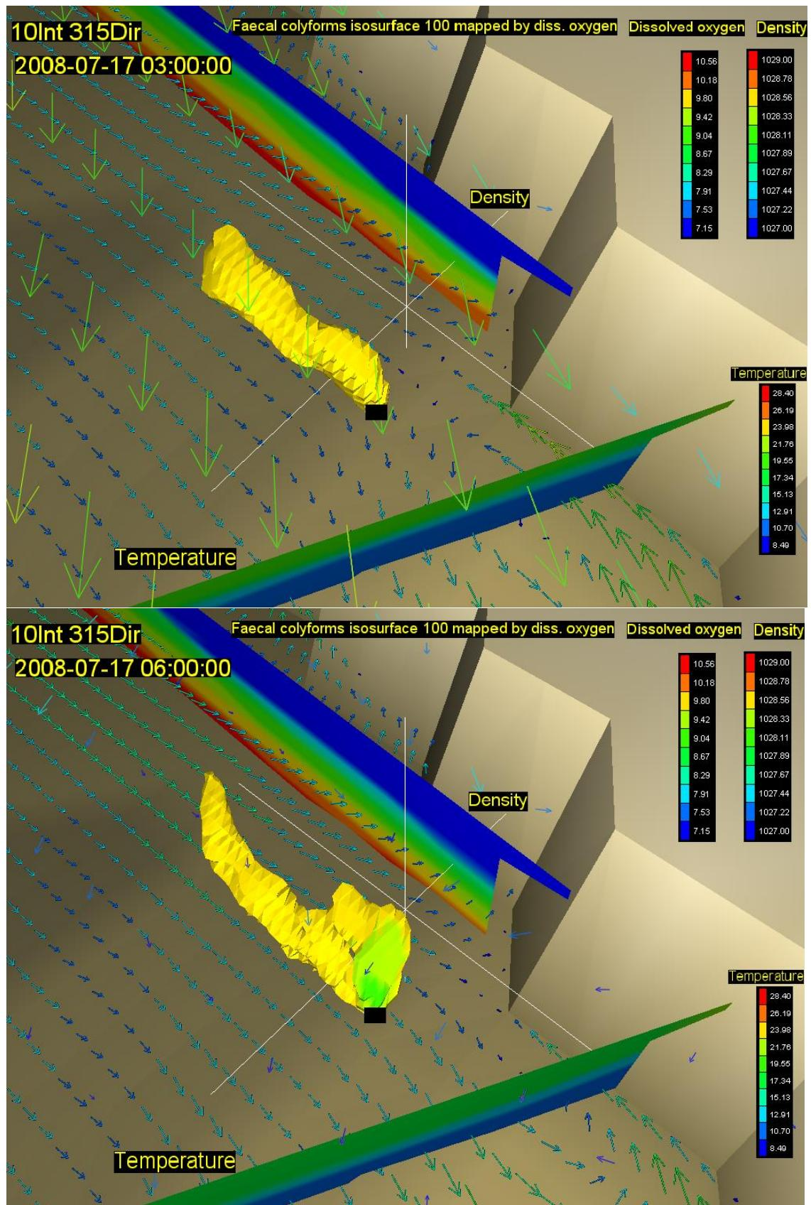
Slika 86. Vektori brzina na površini (rijetki raster) i na dubini od 20m (gusti raster) s vertikalnim profilom gustoće i temperature, te oblakom onečišćenja koncentracije 100 FC(100 ml)<sup>-1</sup> za 09. (gore) i 12. st (dolje) za vjetar intenziteta 10 ms<sup>-1</sup> iz smjera 315 stupnjeva
