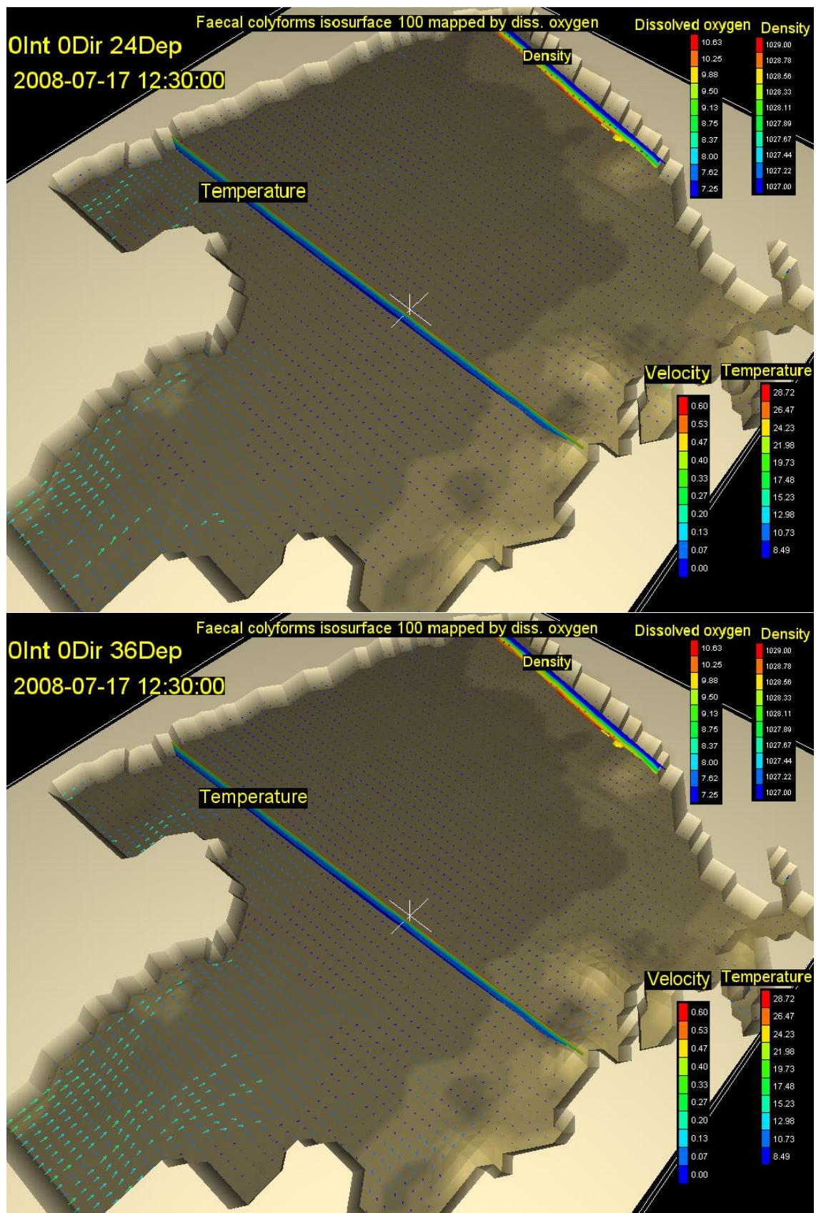
Slika 39. Vektori brzina na dubini od 24m (gore) i 12m (dolje) s vertikalnim profilom gustoće i temperature, te oblakom onečišćenja koncentracije  $100 \text{ FC}(100 \text{ ml})^{-1}$  za 16,5. st za vjetar intenziteta  $0 \text{ ms}^{-1}$  iz smjera 0 stupnjeva
