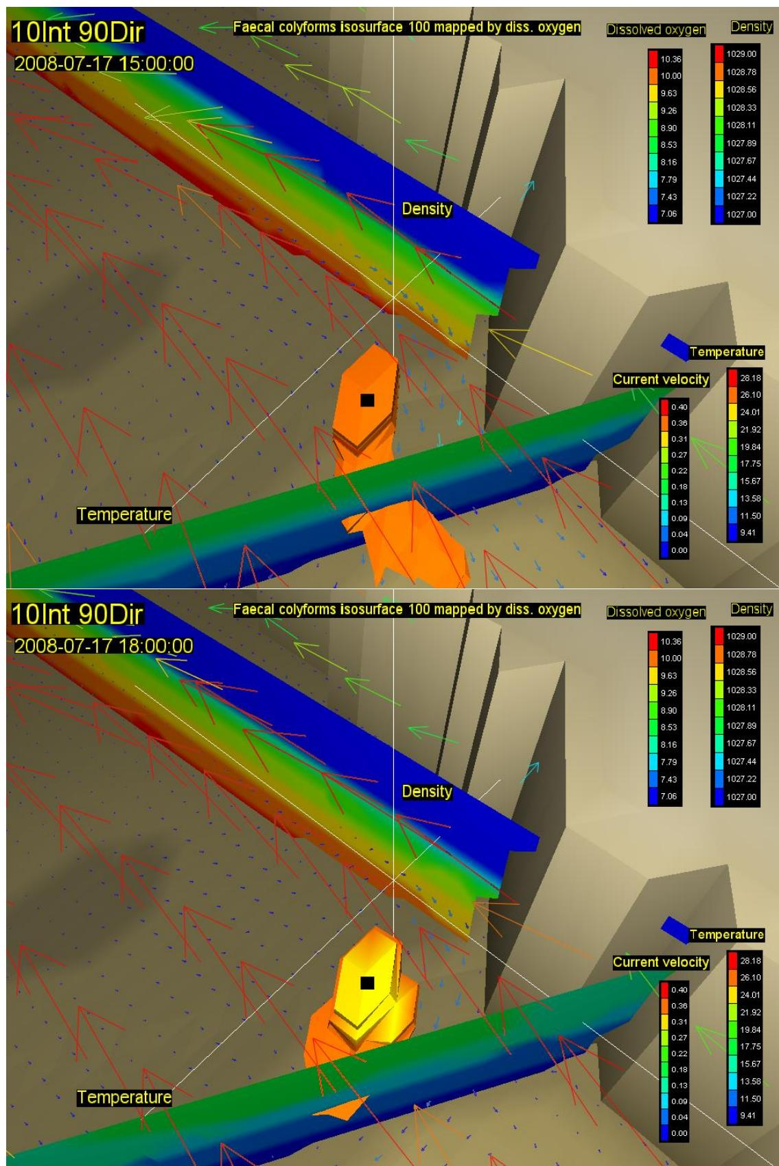
Slika 53. Vektori brzina na površini (rijetki raster) i na dubini od 20m (gusti raster) s vertikalnim profilom gustoće i temperature, te oblakom onečišćenja koncentracije 100 FC( $100 \text{ ml}^{-1}$ ) za 21. (gore) i 24. st (dolje) za vjetar intenziteta  $10 \text{ ms}^{-1}$  iz smjera 90 stupnjeva
