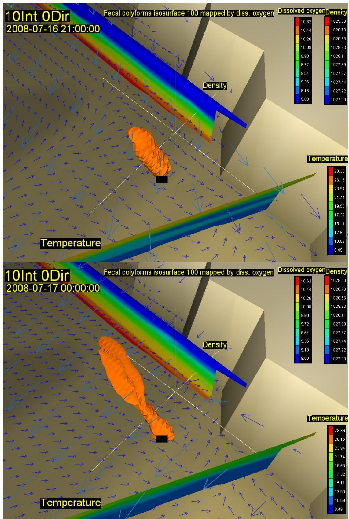
Slika 41. Vektori brzina na površini (rijetki raster) i na dubini od 20m (gusti raster) s vertikalnim profilom gustoće i temperature, te oblakom onečišćenja koncentracije 100 FC(100 ml)<sup>-1</sup> za 03. (gore) i 06. st (dolje) za vjetar intenziteta 10 ms<sup>-1</sup> iz smjera 0 stupnjeva
