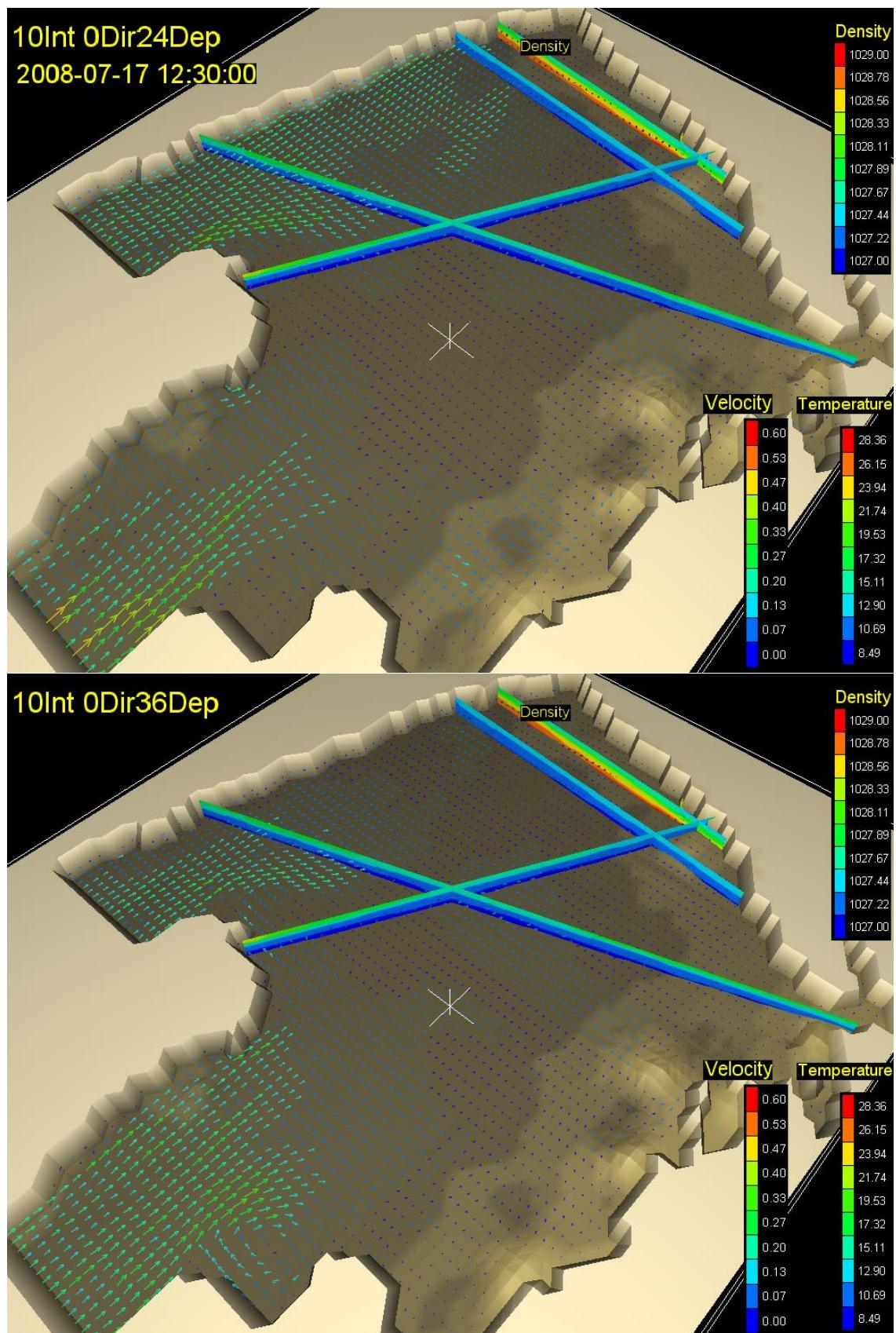
Slika 48. Vektori brzina na dubini od 24m (gore) i 36m (dolje) s vertikalnim profilom gustoće i temperature, te oblakom onečišćenja koncentracije  $100 \text{ FC}(100 \text{ ml})^{-1}$  za  $16,5 \text{ st}$  za vjetar intenziteta  $10 \text{ ms}^{-1}$  iz smjera 0 stupnjeva
