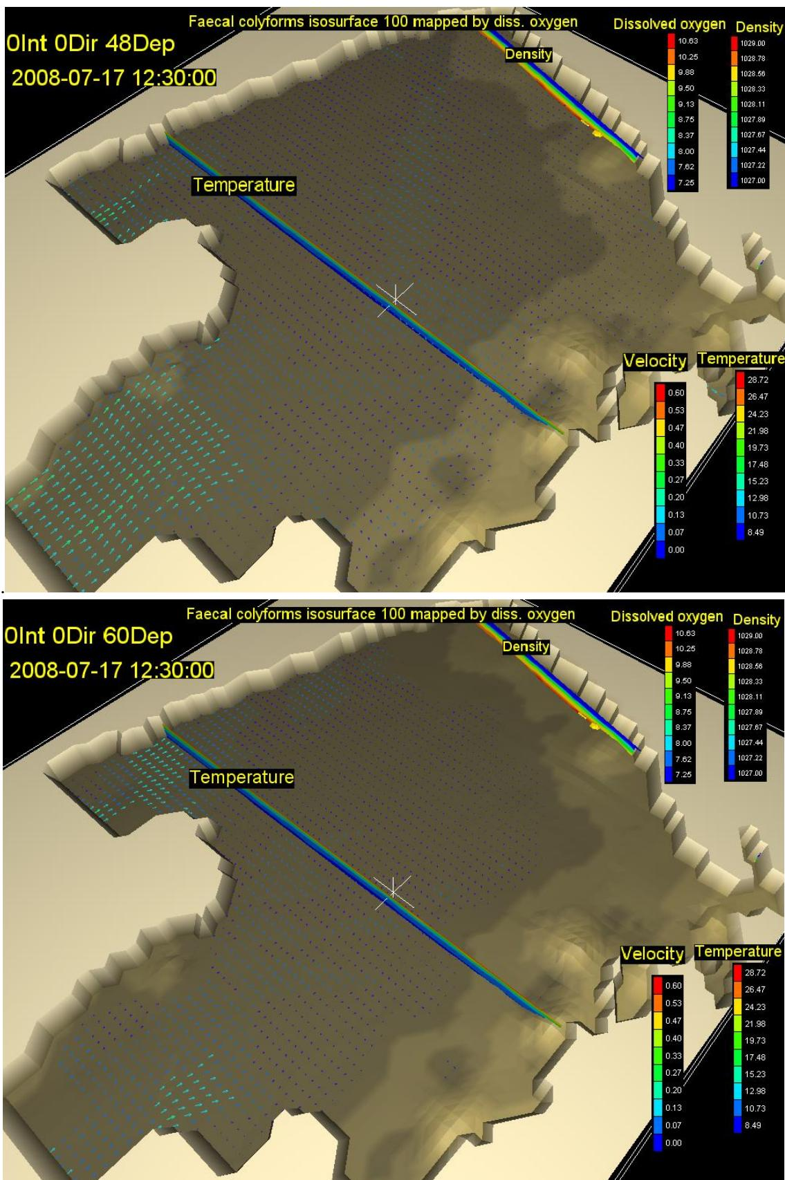
Slika 40. Vektori brzina na dubini od 48m (gore) i 60m (dolje) s vertikalnim profilom gustoće i temperature, te oblakom onečišćenja koncentracije  $100 \text{ FC}(100 \text{ ml})^{-1}$  za 16,5. st za vjetar intenziteta  $0 \text{ ms}^{-1}$  iz smjera 0 stupnjeva
