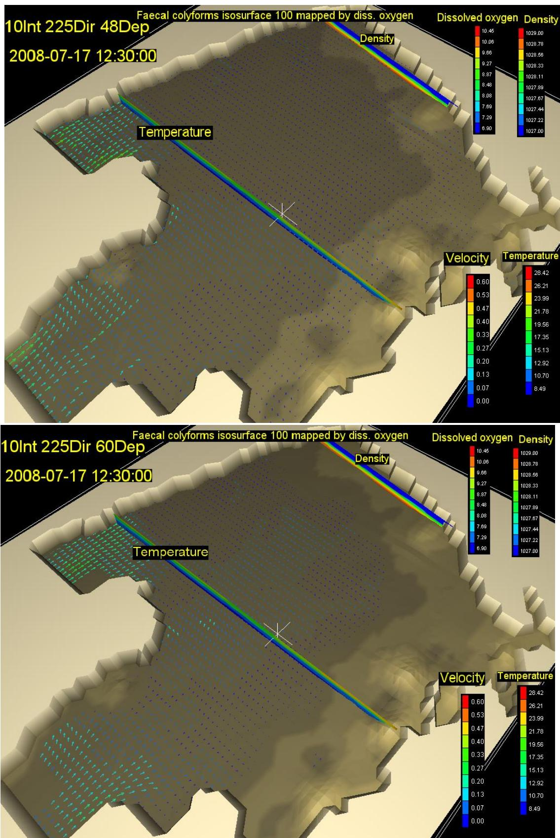
Slika 75. Vektori brzina na dubini od 48m (gore) i 60m (dolje) s vertikalnim profilom gustoće i temperature, te oblakom onečišćenja koncentracije  $100 \text{ FC}(100 \text{ ml})^{-1}$  za 16,5. st za vjetar intenziteta  $10 \text{ ms}^{-1}$  iz smjera 225 stupnjeva
