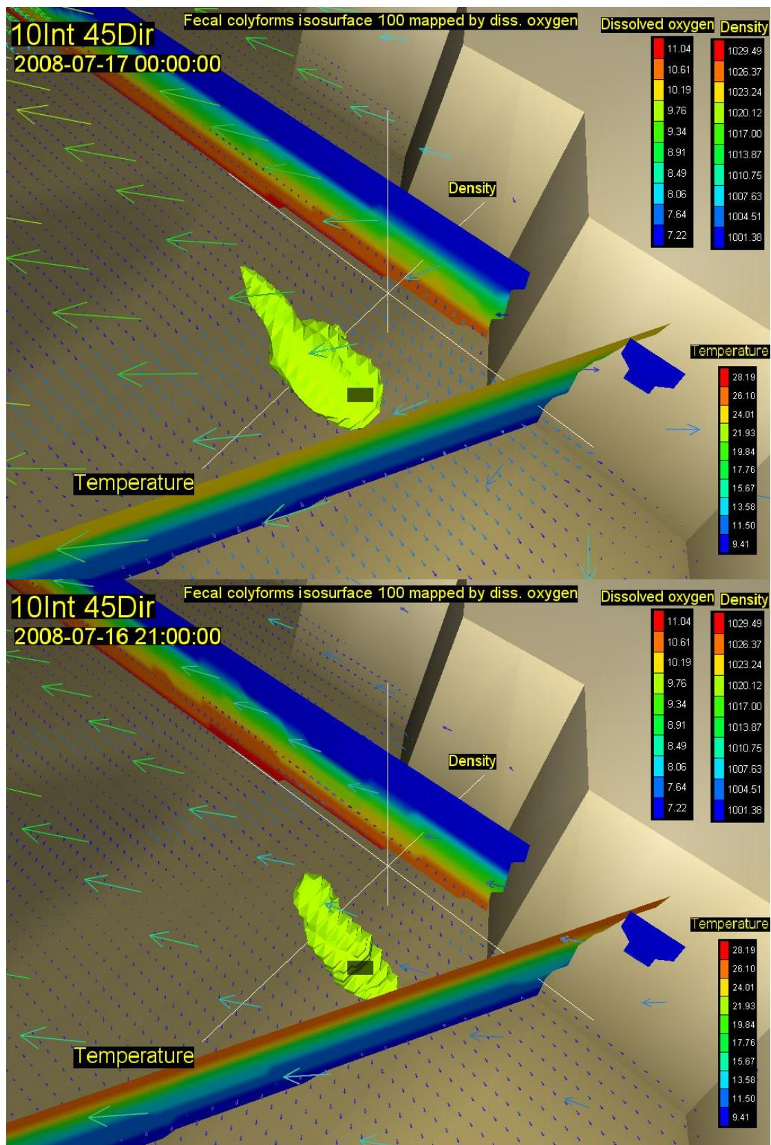
Slika 26. Vektori brzina na površini (rijetki raster) i na dubini od 30m (gusti raster) s vertikalnim profilom gustoće i temperature, te oblakom onečišćenja koncentracije 100 FC(100 ml)<sup>-1</sup> za 03. (gore) i 06. sat (dolje) za vjetar intenziteta 10 ms<sup>-1</sup> iz smjera 45 stupnjeva
