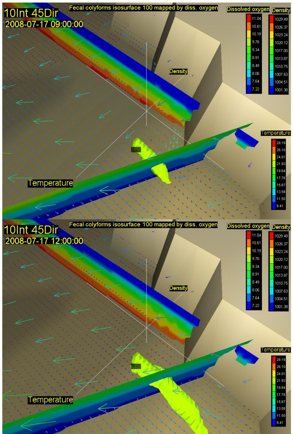
Slika 28. Vektori brzina na površini (rijetki raster) i na dubini od 30m (gusti raster) s vertikalnim profilom gustoće i temperature, te oblakom onečišćenja koncentracije 100 FC( $100 \text{ ml}^{-1}$ ) za 15. (gore) i 18. sat (dolje) za vjetar intenziteta  $10 \text{ ms}^{-1}$  iz smjera 45 stupnjeva
