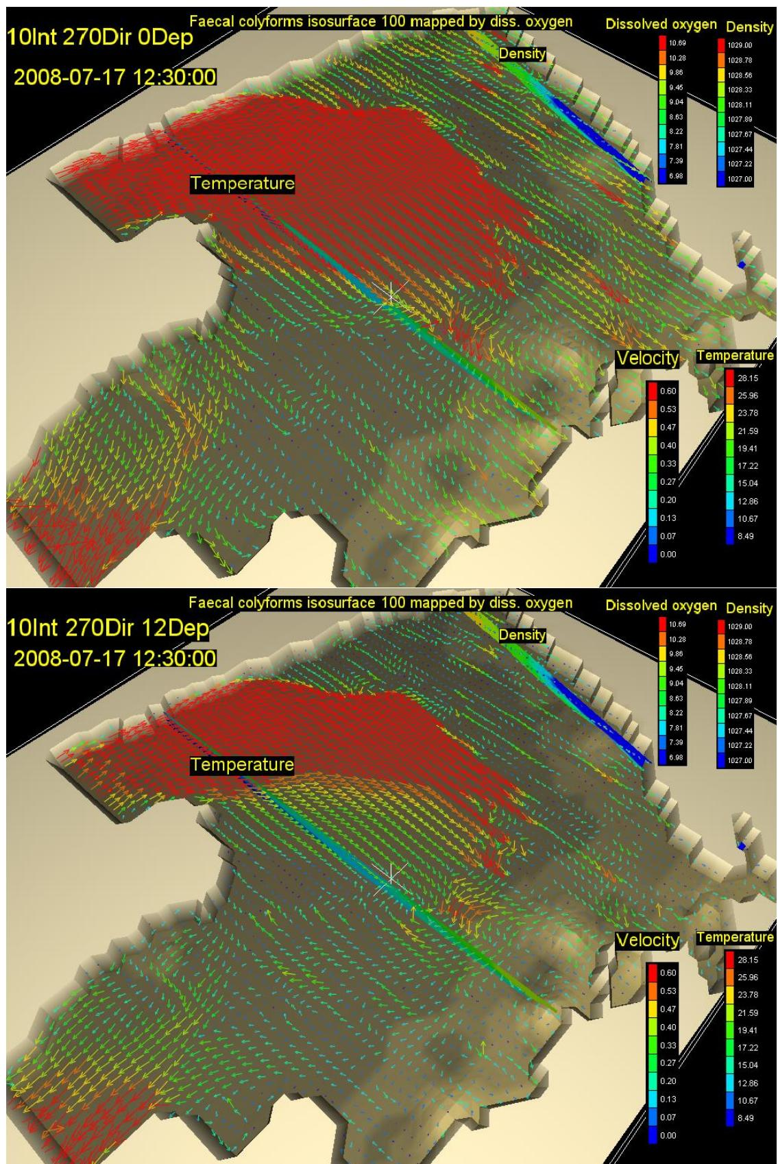
Slika 82. Vektori brzina na površini (gore) i na dubini od 12m (dolje) s vertikalnim profilom gustoće i temperature, te oblakom onečišćenja koncentracije 100 FC( $100 \text{ ml}^{-1}$ ) za 16,5. st za vjetar intenziteta  $10 \text{ ms}^{-1}$  iz smjera 270 stupnjeva
