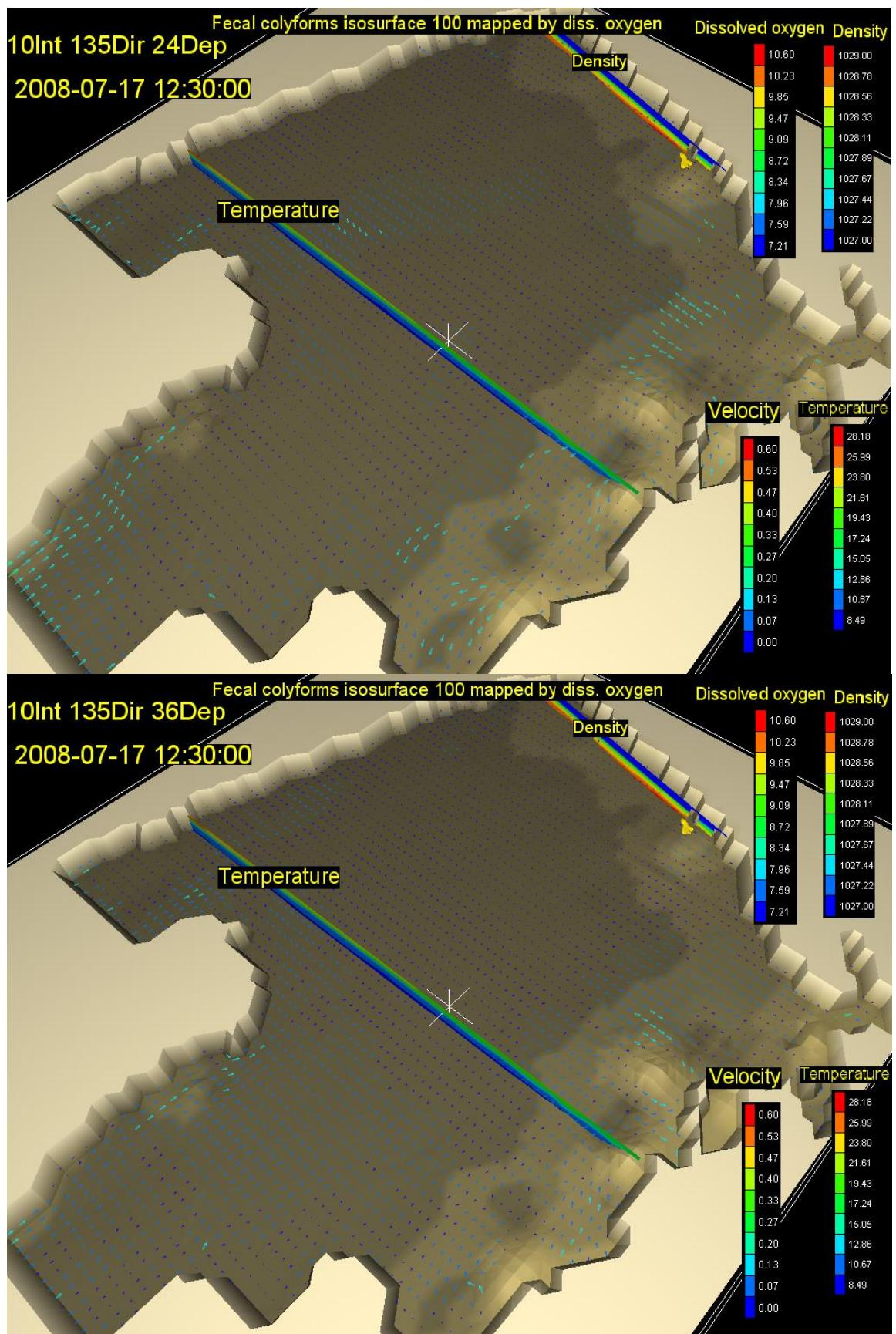
Slika 15. Vektori brzina na dubini od 24m (gore) i 36m (dolje) s vertikalnim profilom gustoće i temperature, te oblakom onečišćenja koncentracije  $100 \text{ FC}(100 \text{ ml})^{-1}$  za 16,5. st za vjetar intenziteta  $10 \text{ ms}^{-1}$  iz smjera 135 stupnjeva
