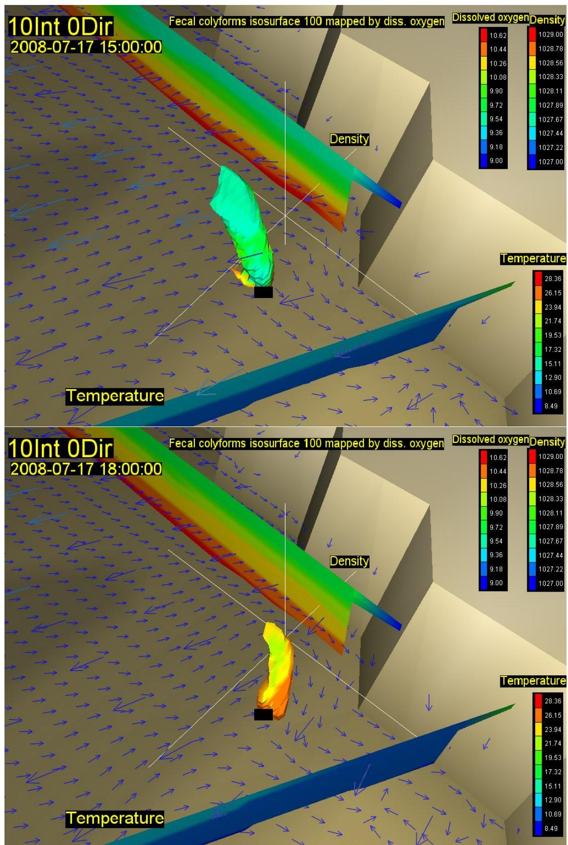
Slika 44. Vektori brzina na površini (rijetki raster) i na dubini od 20m (gusti raster) s vertikalnim profilom gustoće i temperature, te oblakom onečišćenja koncentracije 100 FC(100 ml)<sup>-1</sup> za 21. (gore) i 24. st (dolje) za vjetar intenziteta 10 ms<sup>-1</sup> iz smjera 0 stupnjeva
