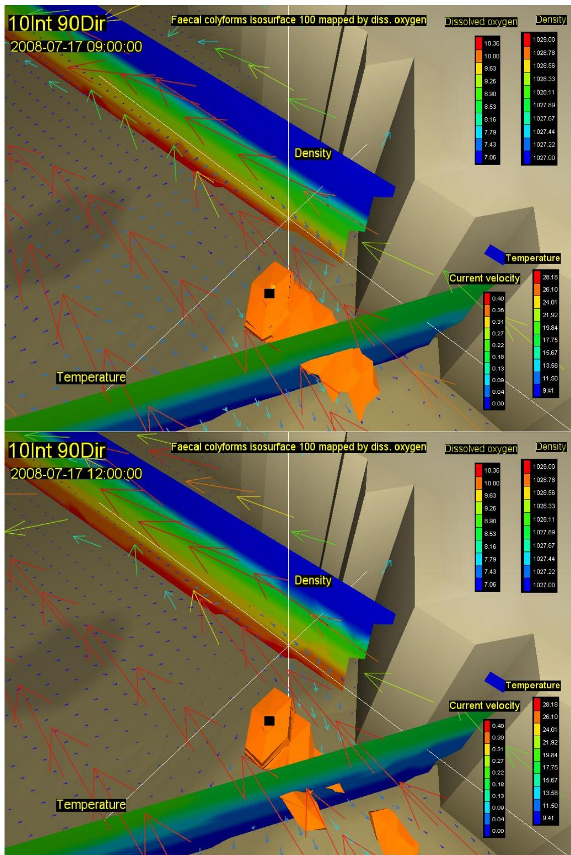
Slika 52. Vektori brzina na površini (rijetki raster) i na dubini od 20m (gusti raster) s vertikalnim profilom gustoće i temperature, te oblakom onečišćenja koncentracije 100 FC( $100 \text{ ml}^{-1}$ ) za 15. (gore) i 18. st (dolje) za vjetar intenziteta  $10 \text{ ms}^{-1}$  iz smjera 90 stupnjeva
