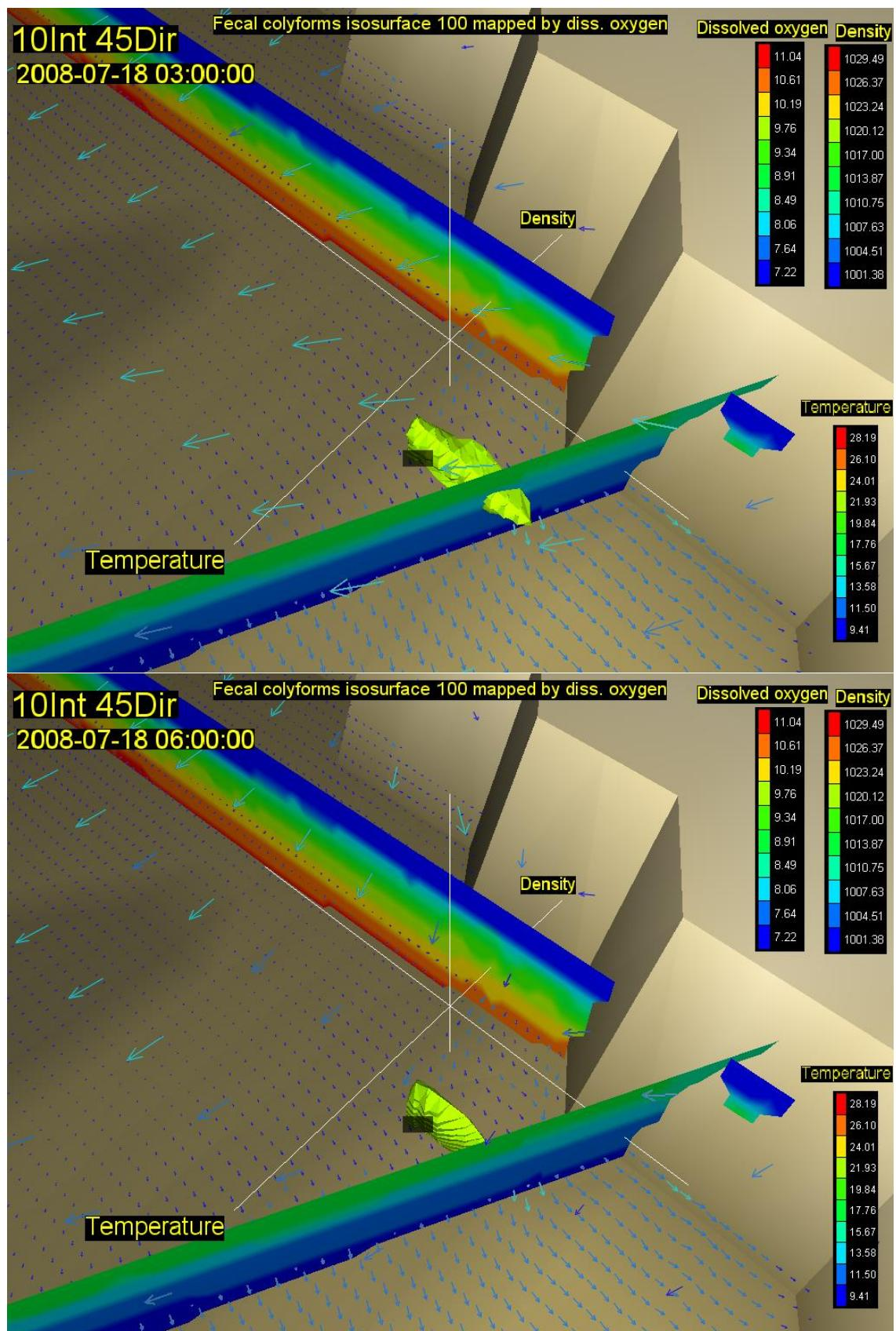
Slika 31. Vektori brzina na površini (rijetki raster) i na dubini od 30m (gusti raster) s vertikalnim profilom gustoće i temperature, te oblakom onečišćenja koncentracije 100 FC( $100 \text{ ml}^{-1}$ ) za 33. (gore) i 36. sat (dolje) za vjetar intenziteta  $10 \text{ ms}^{-1}$  iz smjera 45 stupnjeva
