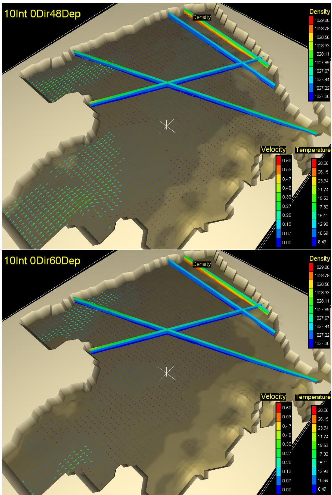
Slika 49. Vektori brzina na dubini od 48m (gore) i 60m (dolje) s vertikalnim profilom gustoće i temperature, te oblakom onečišćenja koncentracije  $100 \text{ FC}(100 \text{ ml})^{-1}$  za  $16,5 \text{ st}$  za vjetar intenziteta  $10 \text{ ms}^{-1}$  iz smjera 0 stupnjeva
