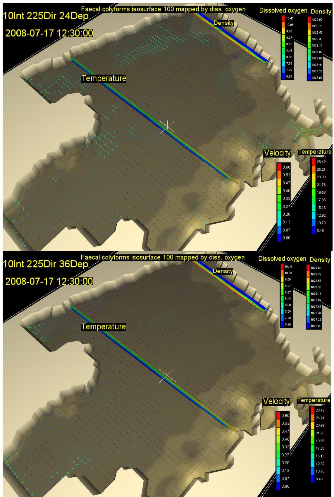
Slika 74. Vektori brzina na dubini od 24m (gore) i 36m (dolje) s vertikalnim profilom gustoće i temperature, te oblakom onečišćenja koncentracije  $100 \text{ FC}(100 \text{ ml})^{-1}$  za 16,5. st za vjetar intenziteta  $10 \text{ ms}^{-1}$  iz smjera 225 stupnjeva
