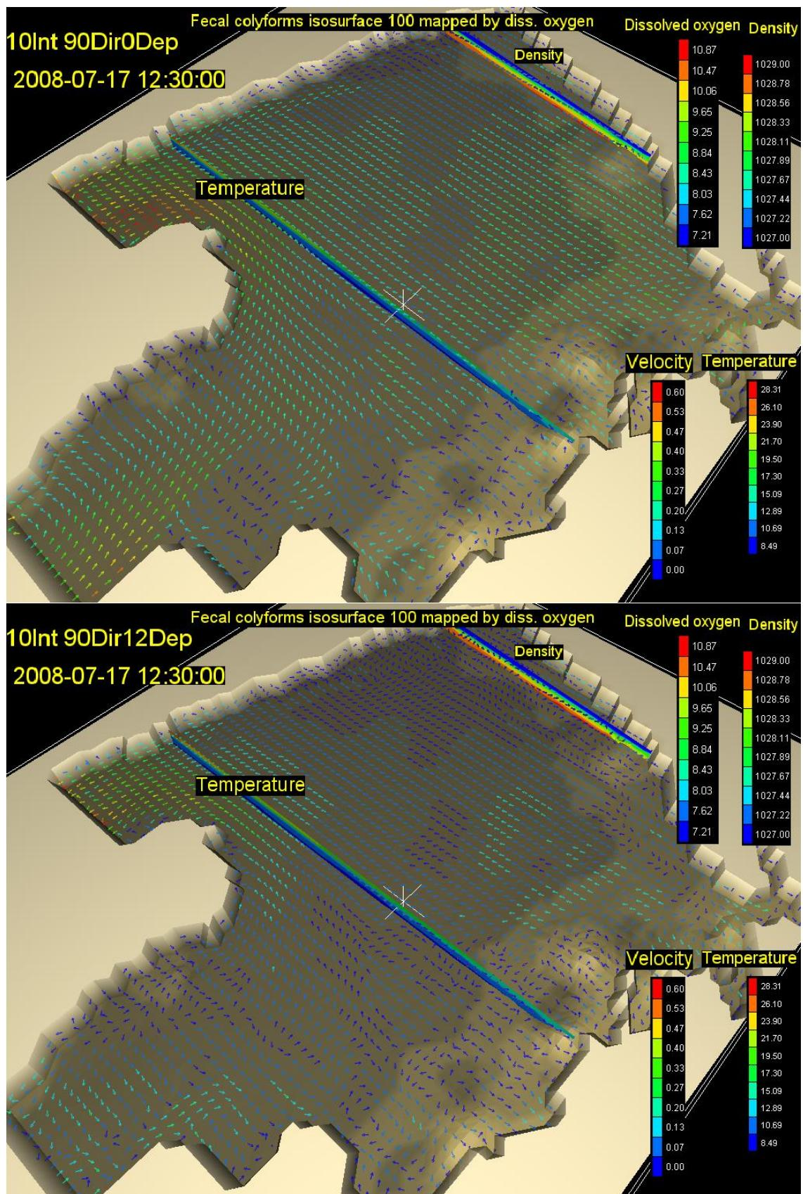
Slika 56. Vektori brzina na površini (gore) i na dubini od 12m (dolje) s vertikalnim profilom gustoće i temperature, te oblakom onečišćenja koncentracije 100 FC( $100 \text{ ml}$ )<sup>-1</sup> za 16,5. st za vjetar intenziteta  $10 \text{ ms}^{-1}$  iz smjera 90 stupnjeva
