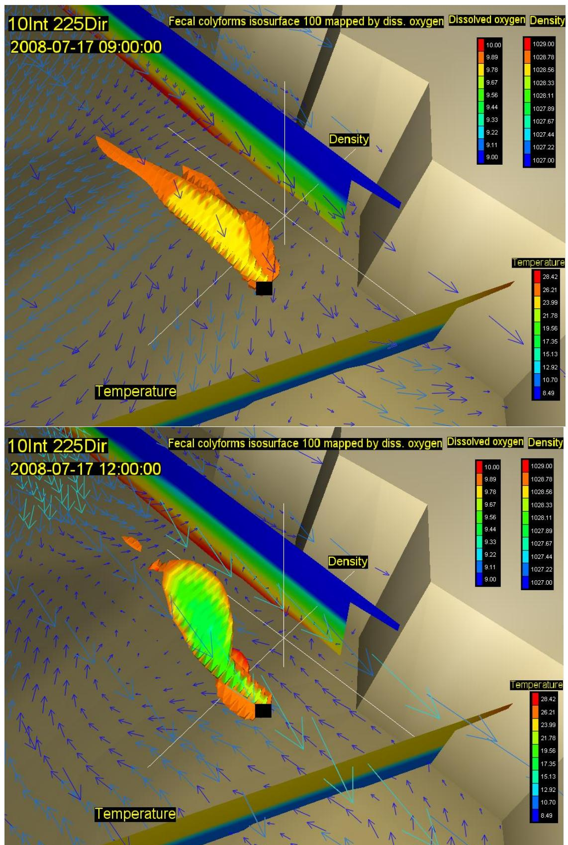
Slika 69. Vektori brzina na površini (rijetki raster) i na dubini od 20m (gusti raster) s vertikalnim profilom gustoće i temperature, te oblakom onečišćenja koncentracije 100 FC( $100 \text{ ml}^{-1}$ ) za 15. (gore) i 18. st (dolje) za vjetar intenziteta  $10 \text{ ms}^{-1}$  iz smjera 225 stupnjeva
