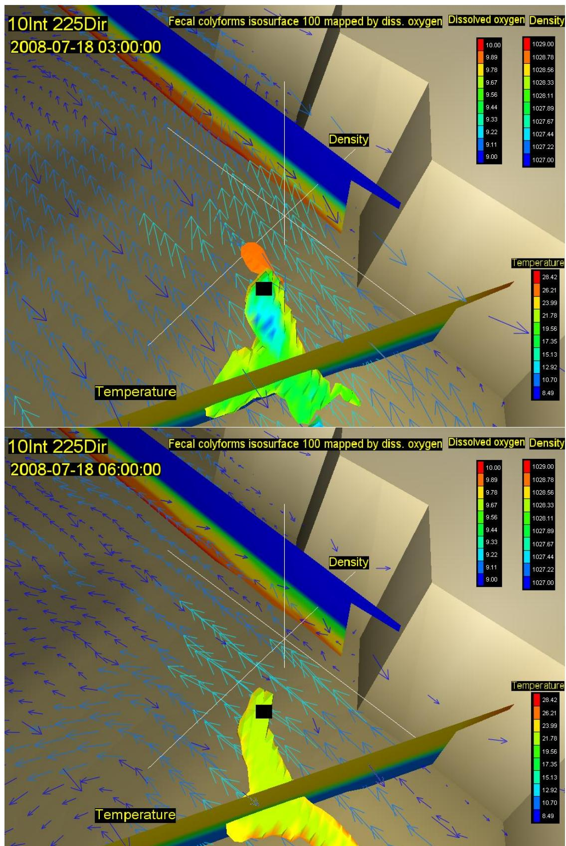
Slika 72. Vektori brzina na površini (rijetki raster) i na dubini od 20m (gusti raster) s vertikalnim profilom gustoće i temperature, te oblakom onečišćenja koncentracije 100 FC( $100 \text{ ml}^{-1}$ ) za 33. (gore) i 36. st (dolje) za vjetar intenziteta  $10 \text{ ms}^{-1}$  iz smjera 225 stupnjeva
