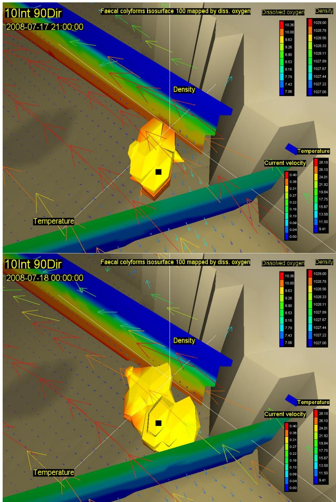
Slika 54. Vektori brzina na površini (rijetki raster) i na dubini od 20m (gusti raster) s vertikalnim profilom gustoće i temperature, te oblakom onečišćenja koncentracije 100 FC(100 ml)<sup>-1</sup> za 27. (gore) i 30. st (dolje) za vjetar intenziteta 10 ms<sup>-1</sup> iz smjera 90 stupnjeva
