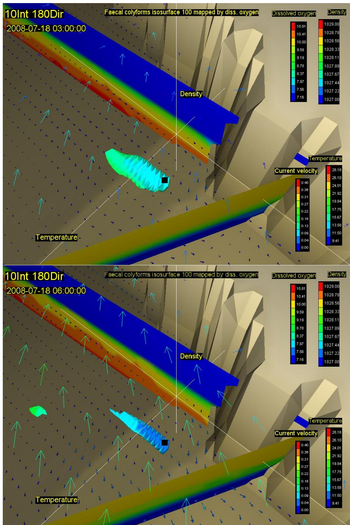
Slika 64. Vektori brzina na površini (rijetki raster) i na dubini od 20m (gusti raster) s vertikalnim profilom gustoće i temperature, te oblakom onečišćenja koncentracije 100 FC(100 ml)<sup>-1</sup> za 33. (gore) i 36. st (dolje) za vjetar intenziteta 10 ms<sup>-1</sup> iz smjera 180 stupnjeva
