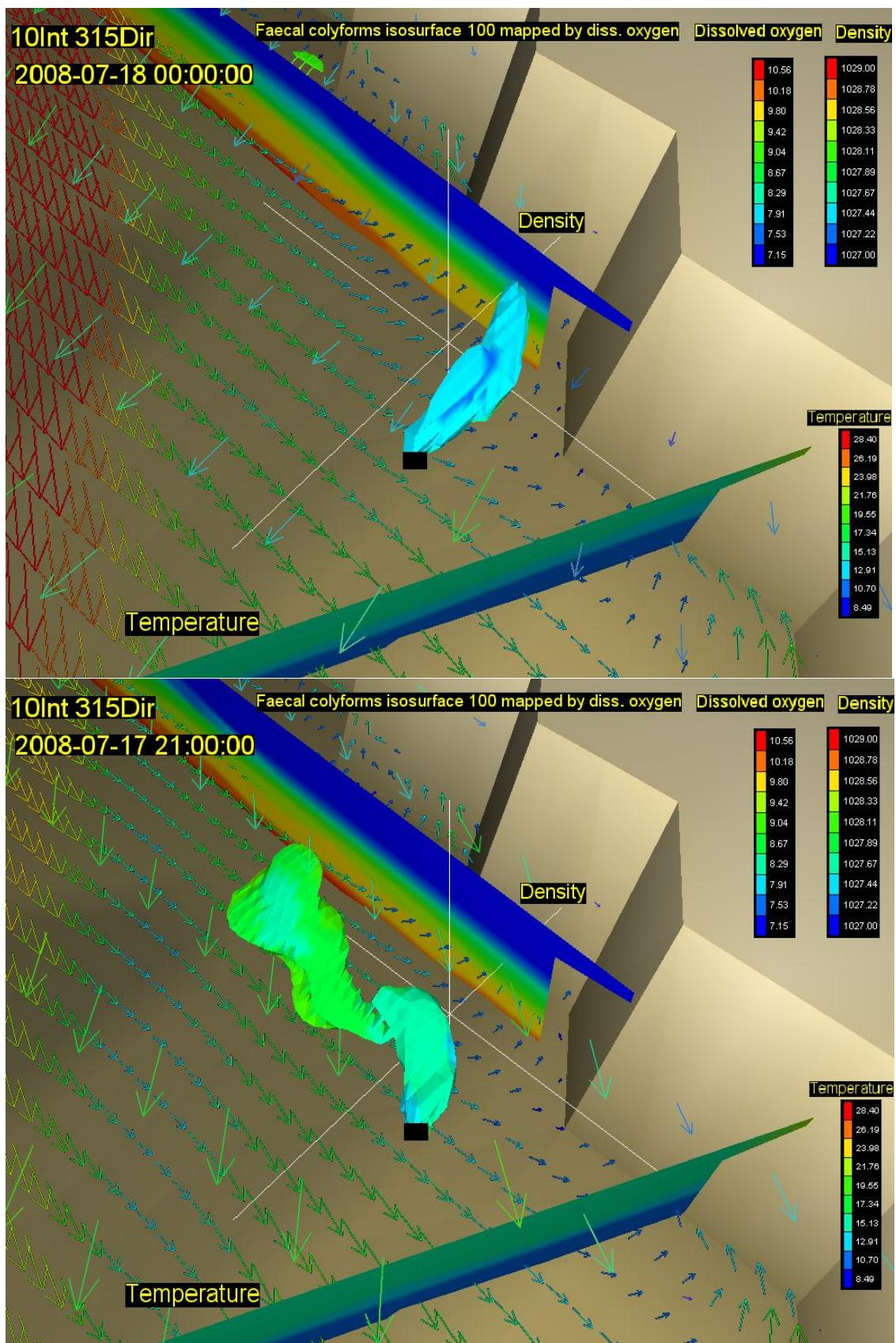
Slika 89. Vektori brzina na površini (rijetki raster) i na dubini od 20m (gusti raster) s vertikalnim profilom gustoće i temperature, te oblakom onečišćenja koncentracije 100 FC(100 ml)<sup>-1</sup> za 27. (gore) i 30. st (dolje) za vjetar intenziteta 10 ms<sup>-1</sup> iz smjera 315 stupnjeva
