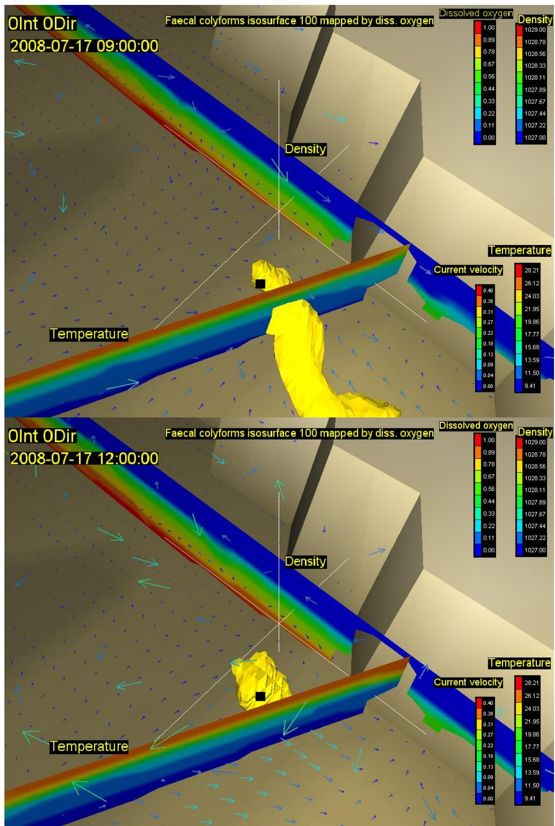
Slika 34. Vektori brzina na površini (rijetki raster) i na dubini od 20m (gusti raster) s vertikalnim profilom gustoće i temperature, te oblakom onečišćenja koncentracije 100 FC(100 ml)<sup>-1</sup> za 12. (gore) i 15. st (dolje) za vjetar intenziteta 0 ms<sup>-1</sup> iz smjera 0 stupnjeva
