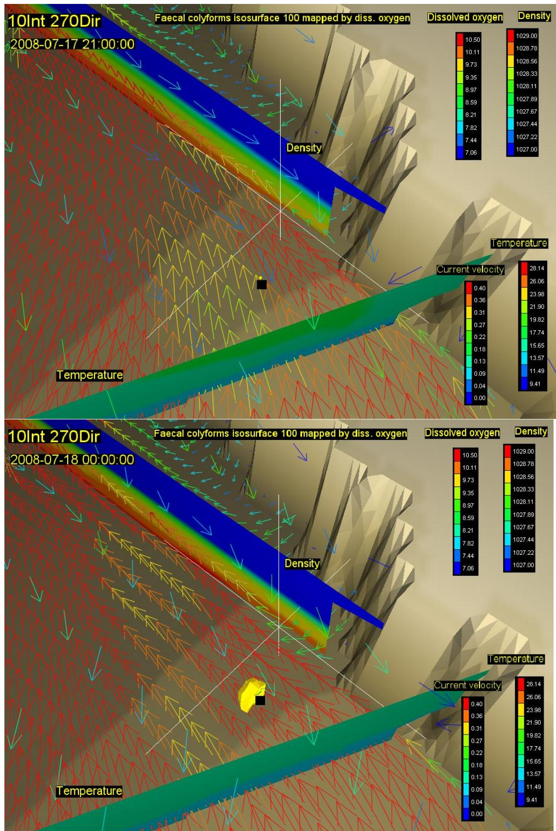
Slika 80. Vektori brzina na površini (rijetki raster) i na dubini od 20m (gusti raster) s vertikalnim profilom gustoće i temperature, te oblakom onečišćenja koncentracije 100 FC(100 ml)<sup>-1</sup> za 27. (gore) i 30. st (dolje) za vjetar intenziteta 10 ms<sup>-1</sup> iz smjera 270 stupnjeva
