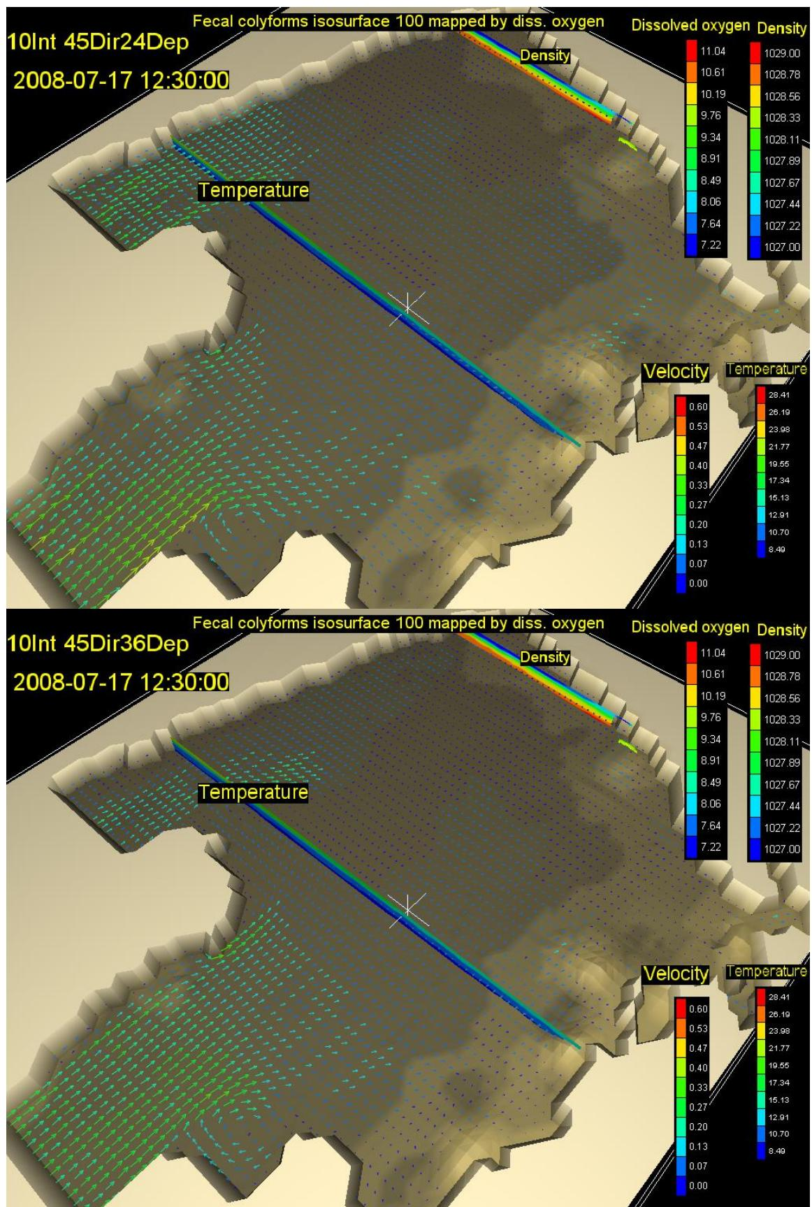
Slika 24. Vektori brzina na dubini od 24m (gore) i na 36 (dolje) s vertikalnim profilom gustoće i temperature, te oblakom onečišćenja koncentracije  $100 \text{ FC}(100 \text{ ml})^{-1}$  za 16,5. sat za vjetar intenziteta  $10 \text{ ms}^{-1}$  iz smjera 45 stupnjeva
