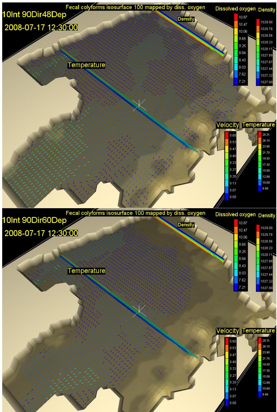
Slika 58. Vektori brzina na dubini od 48m (gore) i 60m (dolje) s vertikalnim profilom gustoće i temperature, te oblakom onečišćenja koncentracije  $100 \text{ FC}(100 \text{ ml})^{-1}$  za 16,5. st za vjetar intenziteta  $10 \text{ ms}^{-1}$  iz smjera 90 stupnjeva
