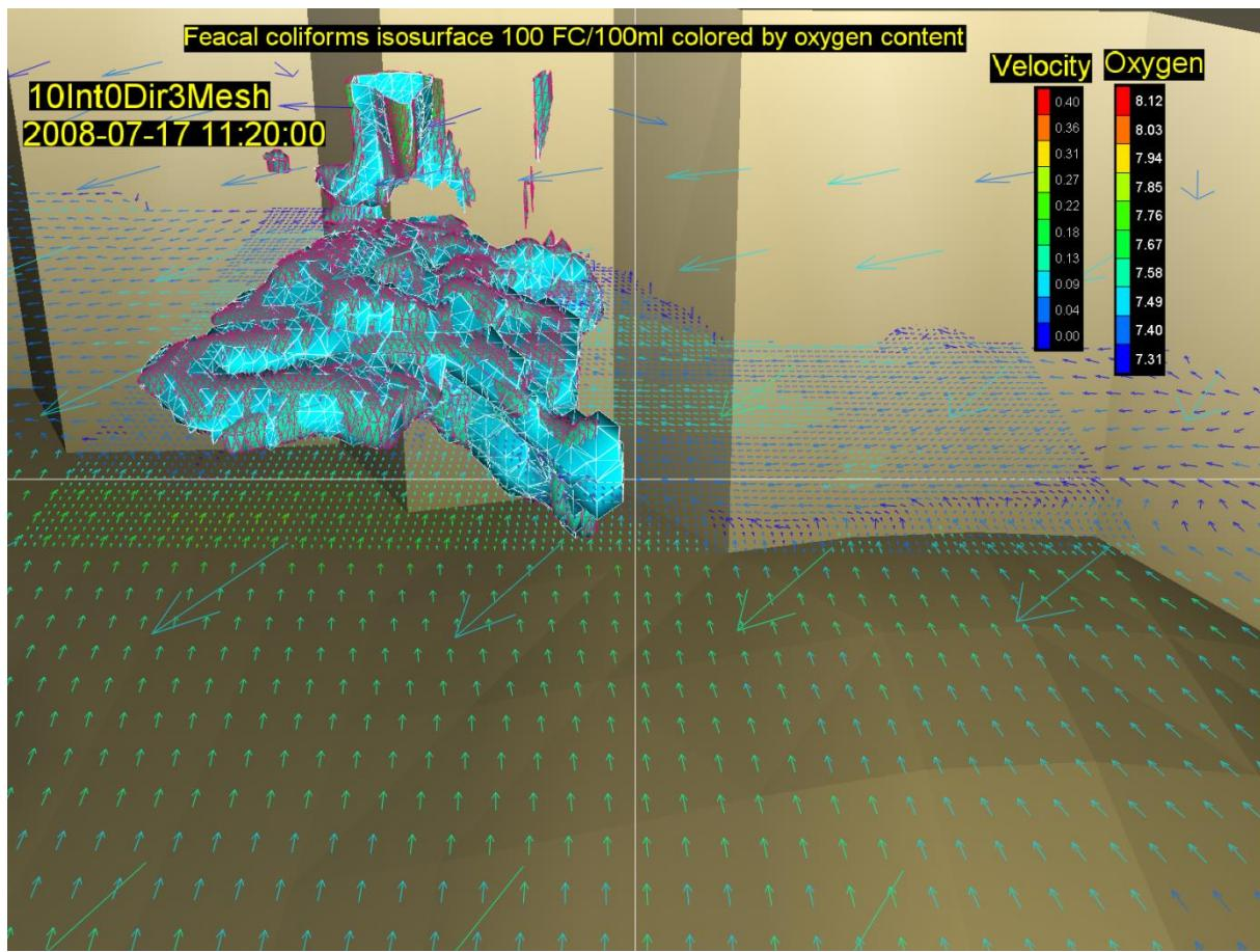
Slika 12. Vektori brzina i oblak FC koncentracije 100 bakterija po 100 ml mora na tri različite mreže: gruboj (bijeli bridovi), srednjoj (crni bridovi) i finoj (crveni bridovi) za vjetar intenziteta  $10 \text{ ms}^{-1}$  i smjer od 0 stupnjeva
