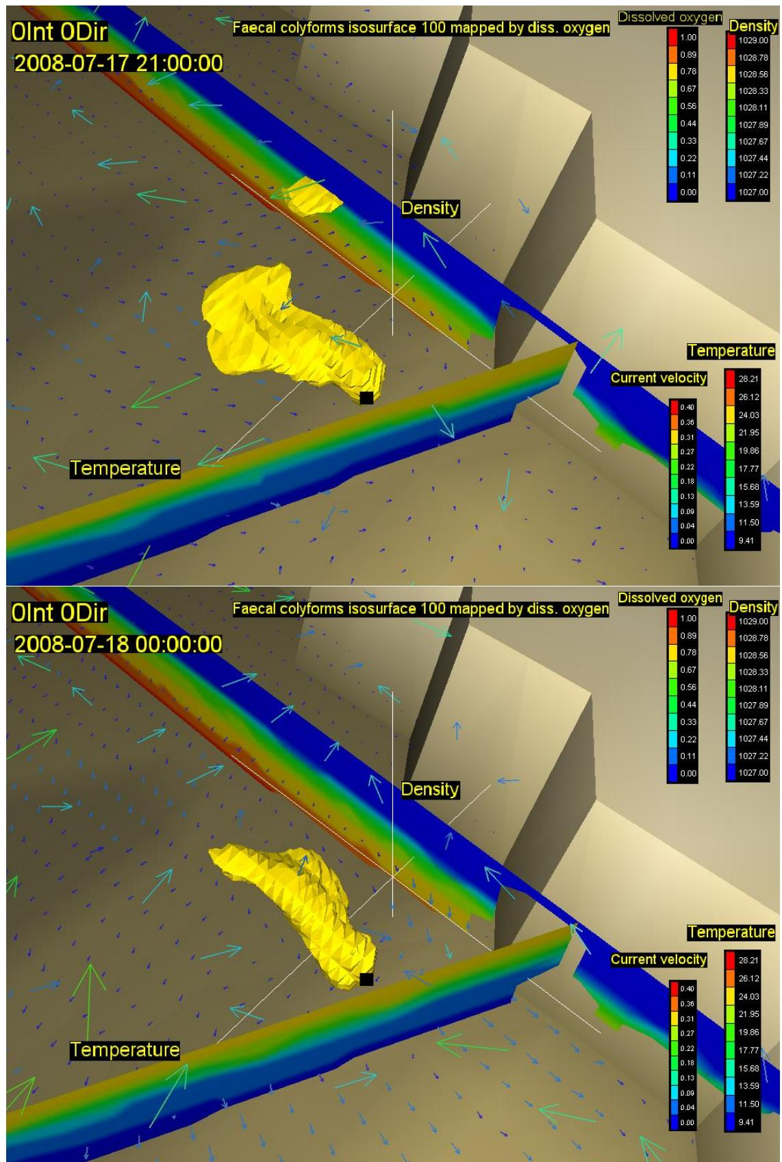
Slika 36. Vektori brzina na površini (rijetki raster) i na dubini od 20m (gusti raster) s vertikalnim profilom gustoće i temperature, te oblakom onečišćenja koncentracije 100 FC(100 ml)<sup>-1</sup> za 24. (gore) i 27. st (dolje) za vjetar intenziteta 0 ms<sup>-1</sup> iz smjera 0 stupnjeva
