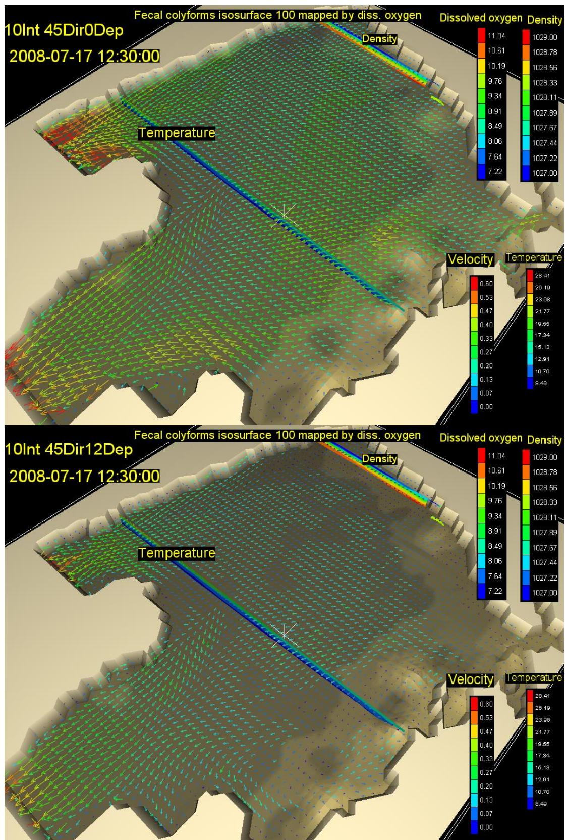
Slika 23. Vektori brzina na površini (gore) i na dubini od 12m (dolje) s vertikalnim profilom gustoće i temperature, te oblakom onečišćenja koncentracije 100 FC(100 ml)<sup>-1</sup> za 16,5. st za vjetar intenziteta  $10 \text{ ms}^{-1}$  iz smjera 45 stupnjeva
