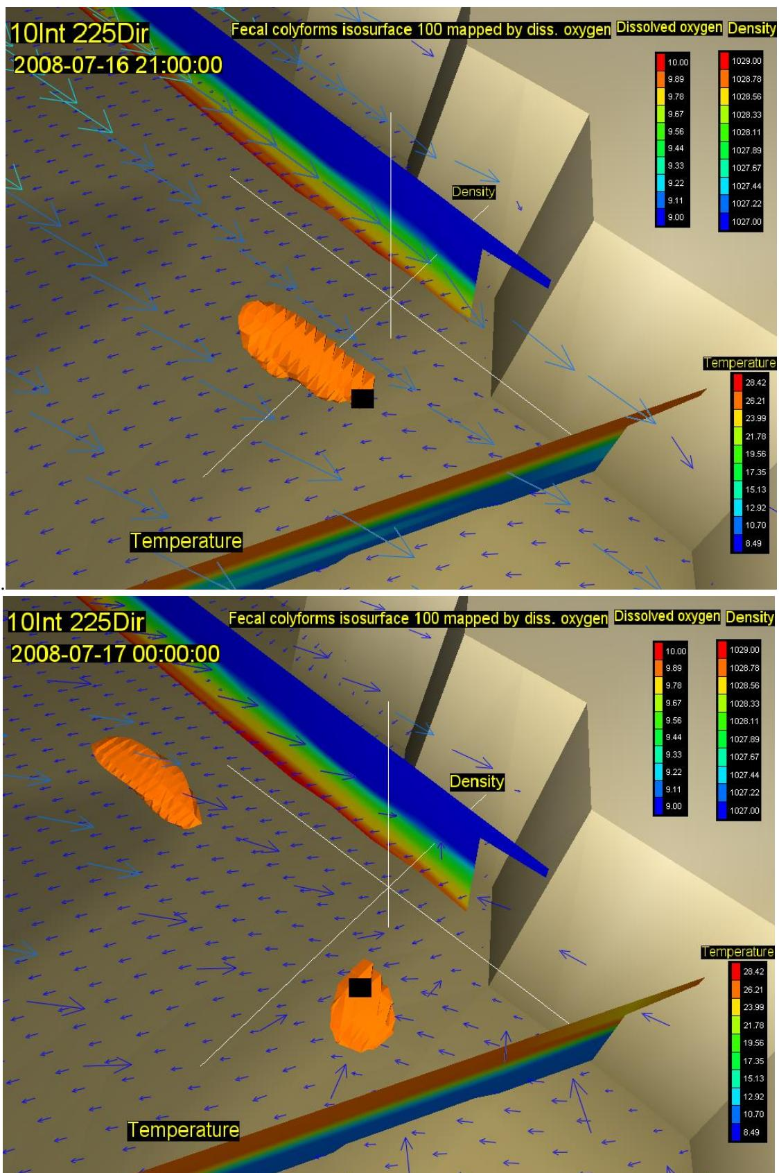
Slika 67. Vektori brzina na površini (rijetki raster) i na dubini od 20m (gusti raster) s vertikalnim profilom gustoće i temperature, te oblakom onečišćenja koncentracije 100 FC/(100 ml)<sup>-1</sup> za 03. (gore) i 06. st (dolje) za vjetar intenziteta 10 ms<sup>-1</sup> iz smjera 225 stupnjeva
