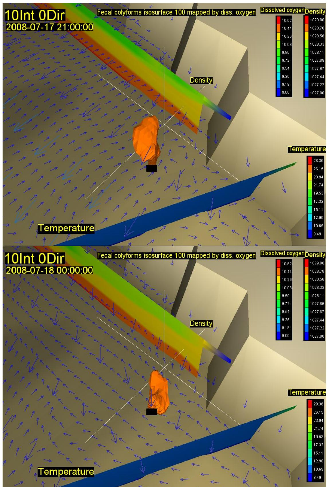
Slika 45. Vektori brzina na površini (rijetki raster) i na dubini od 20m (gusti raster) s vertikalnim profilom gustoće i temperature, te oblakom onečišćenja koncentracije 100 FC(100 ml)<sup>-1</sup> za 27. (gore) i 30. st (dolje) za vjetar intenziteta  $10 \text{ ms}^{-1}$  iz smjera 0 stupnjeva
