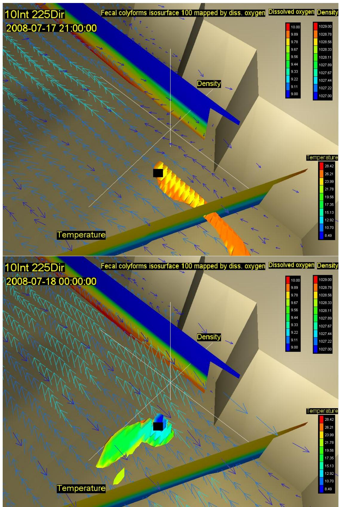
Slika 71. Vektori brzina na površini (rijetki raster) i na dubini od 20m (gusti raster) s vertikalnim profilom gustoće i temperature, te oblakom onečišćenja koncentracije 100 FC( $100 \text{ ml}^{-1}$ ) za 27. (gore) i 30. st (dolje) za vjetar intenziteta  $10 \text{ ms}^{-1}$  iz smjera 225 stupnjeva
