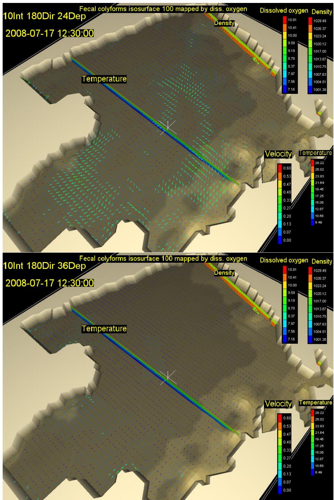
Slika 65. Vektori brzina na dubini od 24m (gore) i 36m (dolje) s vertikalnim profilom gustoće i temperature, te oblakom onečišćenja koncentracije  $100 \text{ FC}(100 \text{ ml})^{-1}$  za 16,5. st za vjetar intenziteta  $10 \text{ ms}^{-1}$  iz smjera 180 stupnjeva
