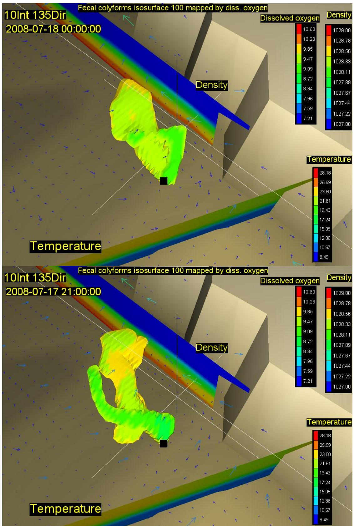
Slika 21. Vektori brzina na površini (rijetki raster) i na dubini od 30m (gusti raster) s vertikalnim profilom gustoće i temperature, te oblakom onečišćenja koncentracije 100 FC(100 ml)<sup>-1</sup> za 24. (gore) i 27. st (dolje) za vjetar intenziteta 10 ms<sup>-1</sup> iz smjera 135 stupnjeva
