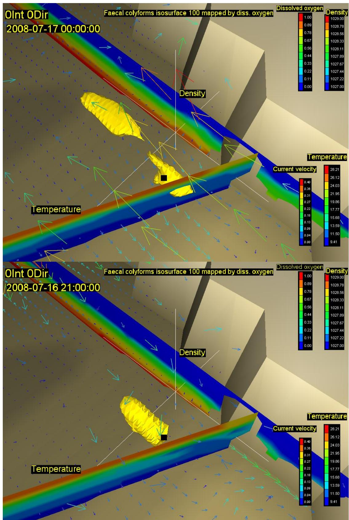
Slika 32. Vektori brzina na površini (rijetki raster) i na dubini od 20m (gusti raster) s vertikalnim profilom gustoće i temperature, te oblakom onečišćenja koncentracije 100 FC(100 ml)<sup>-1</sup> za 00. (gore) i 03. st (dolje) za vjetar intenziteta 0 ms<sup>-1</sup> iz smjera 0 stupnjeva
