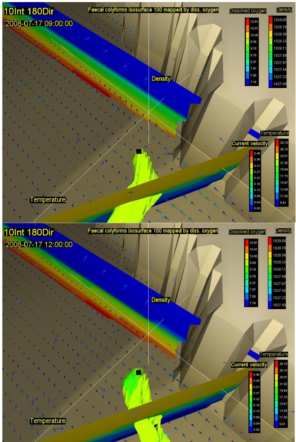
Slika 61. Vektori brzina na površini (rijetki raster) i na dubini od 20m (gusti raster) s vertikalnim profilom gustoće i temperature, te oblakom onečišćenja koncentracije 100 FC( $100 \text{ ml}^{-1}$ ) za 15. (gore) i 18. st (dolje) za vjetar intenziteta  $10 \text{ ms}^{-1}$  iz smjera 180 stupnjeva
