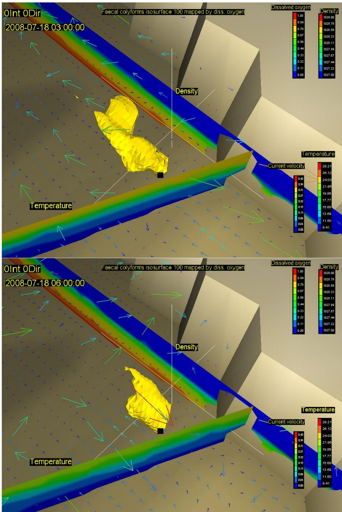
Slika 37. Vektori brzina na površini (rijetki raster) i na dubini od 20m (gusti raster) s vertikalnim profilom gustoće i temperature, te oblakom onečišćenja koncentracije 100 FC(100 ml)<sup>-1</sup> za 30. (gore) i 33. st (dolje) za vjetar intenziteta 0 ms<sup>-1</sup> iz smjera 0 stupnjeva
