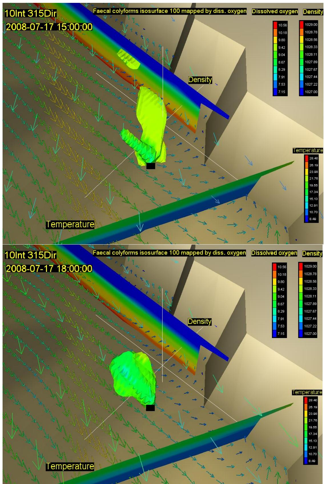
Slika 88. Vektori brzina na površini (rijetki raster) i na dubini od 20m (gusti raster) s vertikalnim profilom gustoće i temperature, te oblakom onečišćenja koncentracije 100 FC( $100 \text{ ml}^{-1}$ ) za 21. (gore) i 24. st (dolje) za vjetar intenziteta  $10 \text{ ms}^{-1}$  iz smjera 315 stupnjeva
