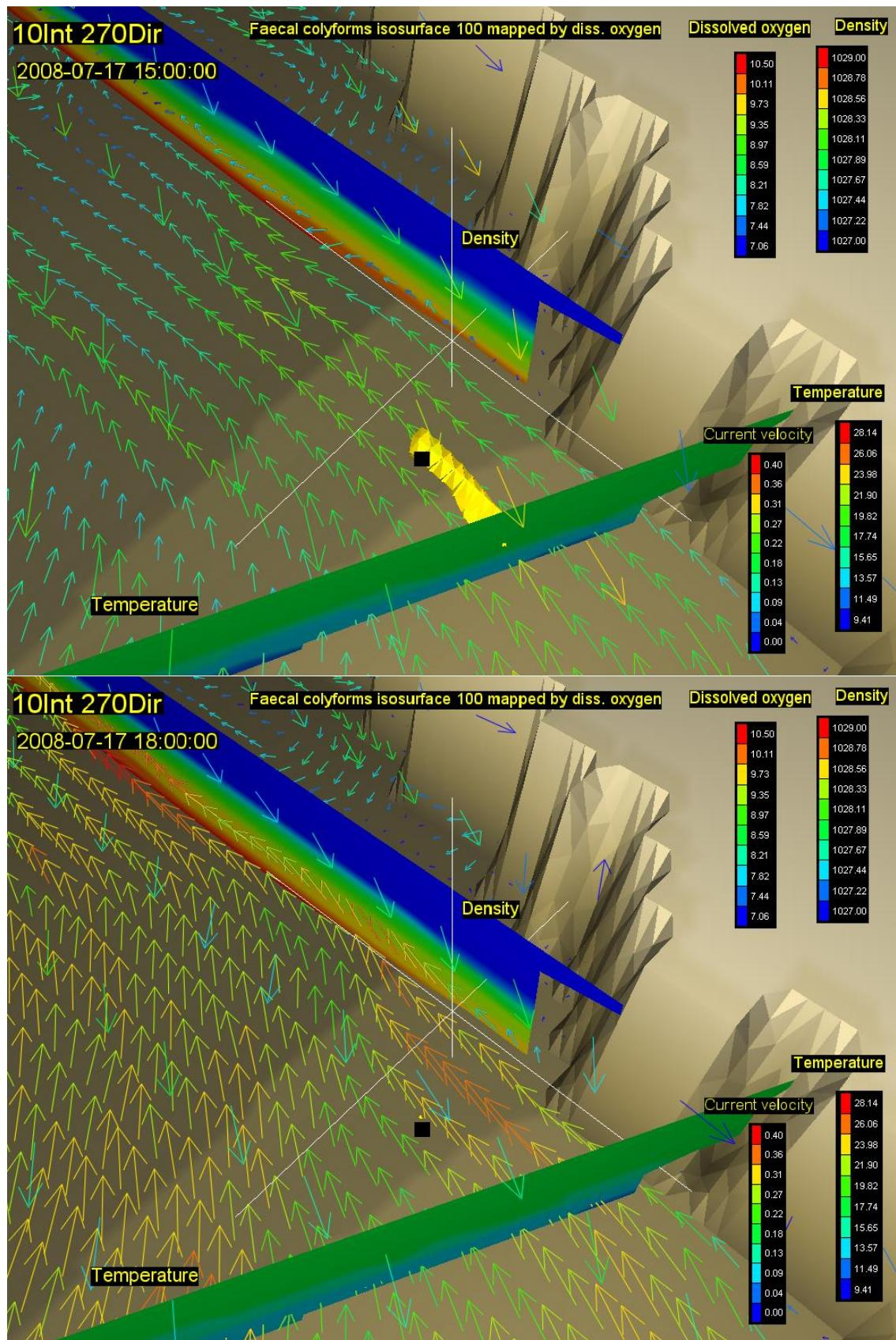
Slika 79. Vektori brzina na površini (rijetki raster) i na dubini od 20m (gusti raster) s vertikalnim profilom gustoće i temperature, te oblakom onečišćenja koncentracije 100 FC(100 ml)<sup>-1</sup> za 21. (gore) i 24. st (dolje) za vjetar intenziteta 10 ms<sup>-1</sup> iz smjera 270 stupnjeva
