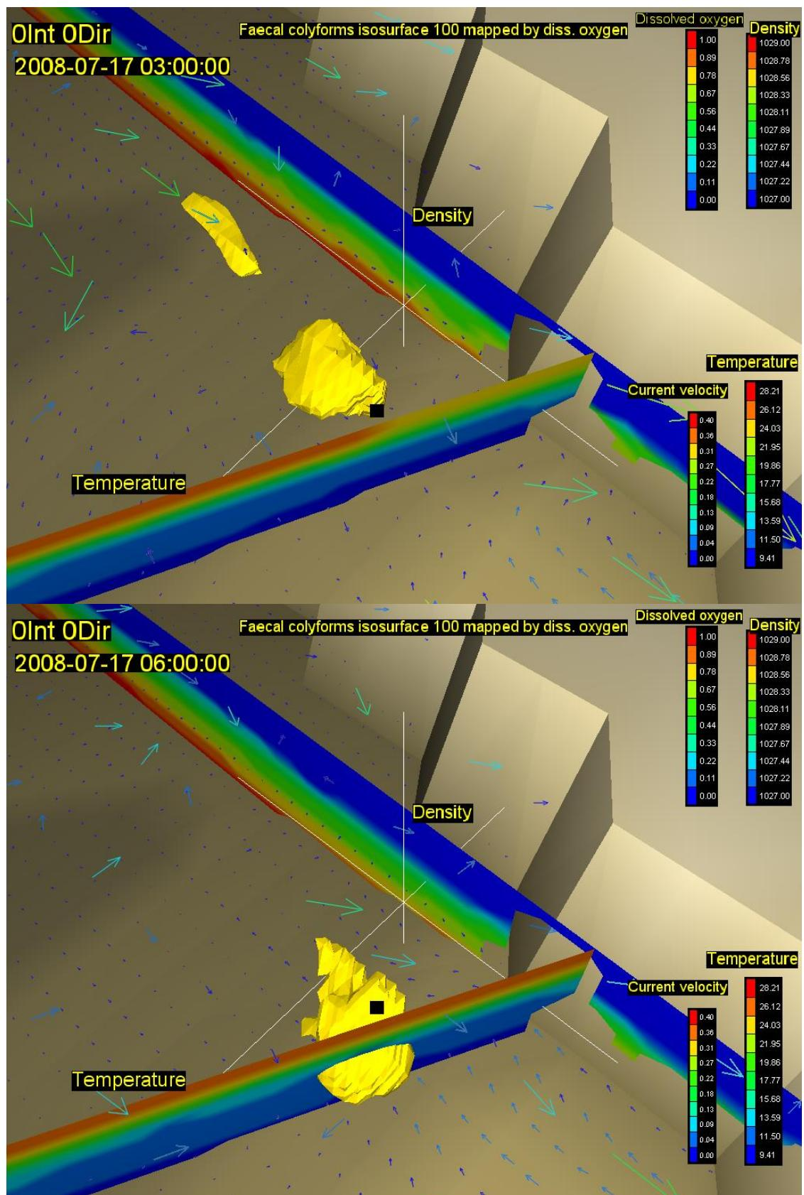
Slika 33. Vektori brzina na površini (rijetki raster) i na dubini od 20m (gusti raster) s vertikalnim profilom gustoće i temperature, te oblakom onečišćenja koncentracije 100 FC( $100 \text{ ml}^{-1}$ ) za 06. (gore) i 09. st (dolje) za vjetar intenziteta  $0 \text{ ms}^{-1}$  iz smjera 0 stupnjeva
