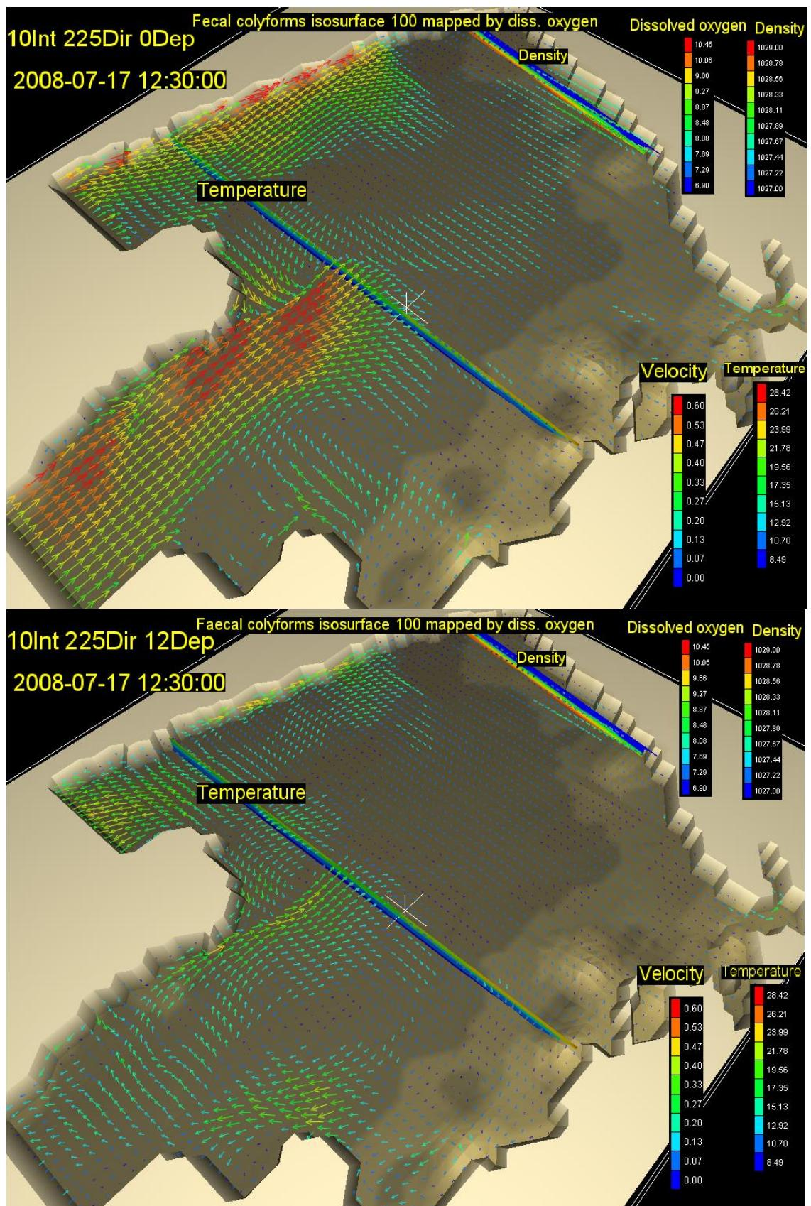
Slika 73. Vektori brzina na površini (gore) i na dubini od 12m (dolje) s vertikalnim profilom gustoće i temperature, te oblakom onečišćenja koncentracije 100 FC( $100 \text{ ml}^{-1}$ ) za 16,5. st za vjetar intenziteta  $10 \text{ ms}^{-1}$  iz smjera 225 stupnjeva
