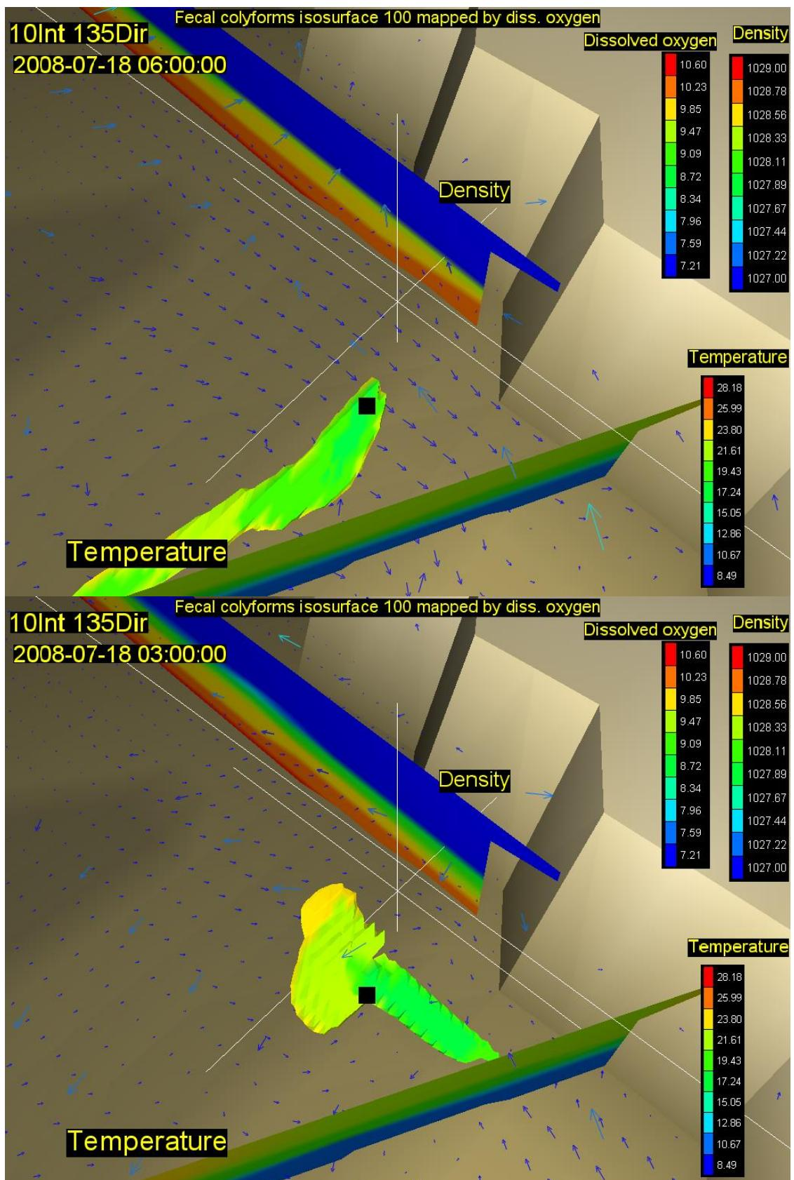
Slika 22. Vektori brzina na površini (rijetki raster) i na dubini od 30m (gusti raster) s vertikalnim profilom gustoće i temperature, te oblakom onečišćenja koncentracije 100 FC(100 ml)<sup>-1</sup> za 30. (gore) i 33. st (dolje) za vjetar intenziteta 10 ms<sup>-1</sup> iz smjera 135 stupnjeva
