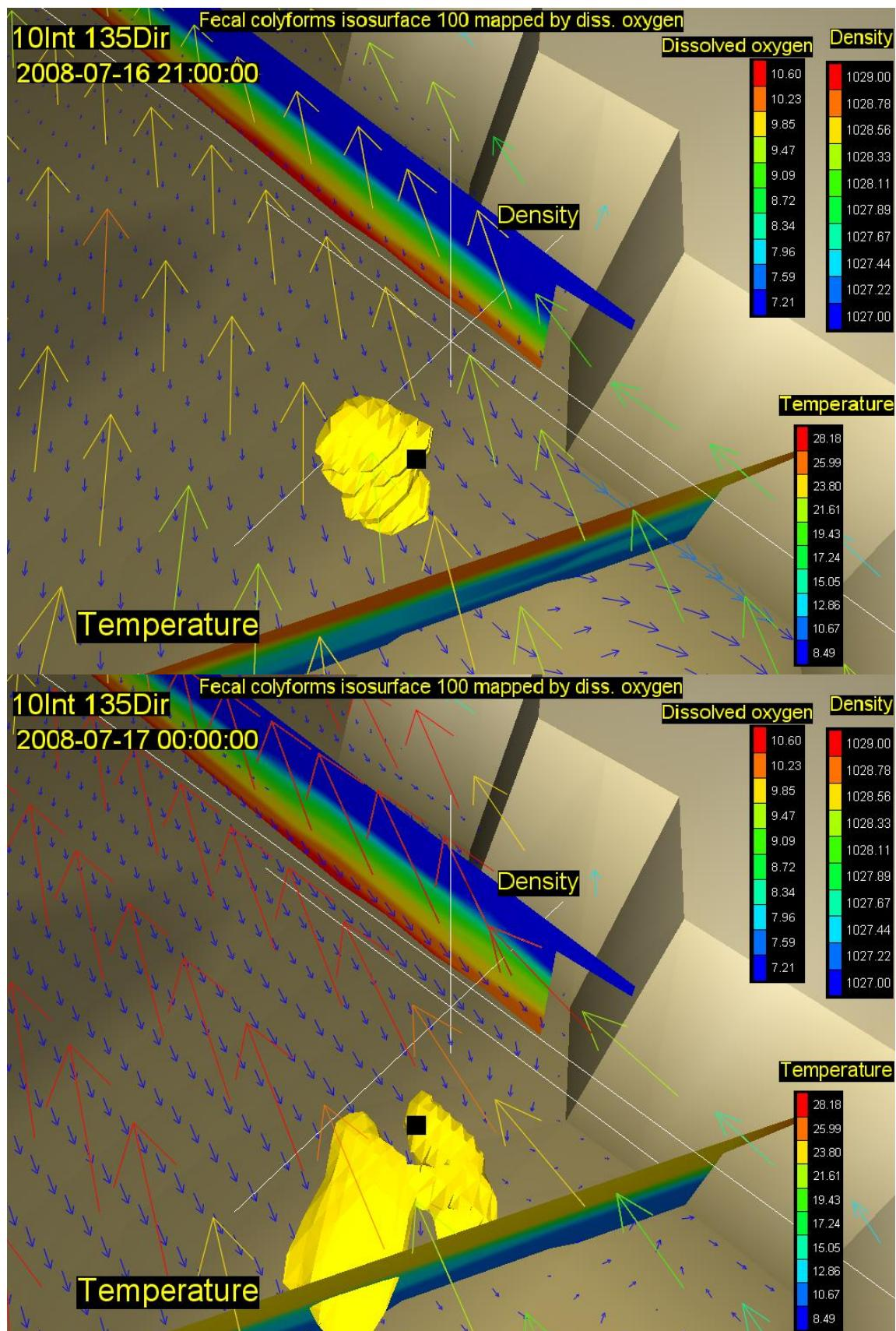
Slika 17. Vektori brzina na površini (rijetki raster) i na dubini od 30m (gusti raster) s vertikalnim profilom gustoće i temperature, te oblakom onečišćenja koncentracije 100 FC(100 ml)<sup>-1</sup> za 00. (gore) i 03. st (dolje) za vjetar intenziteta 10 ms<sup>-1</sup> iz smjera 135 stupnjeva
