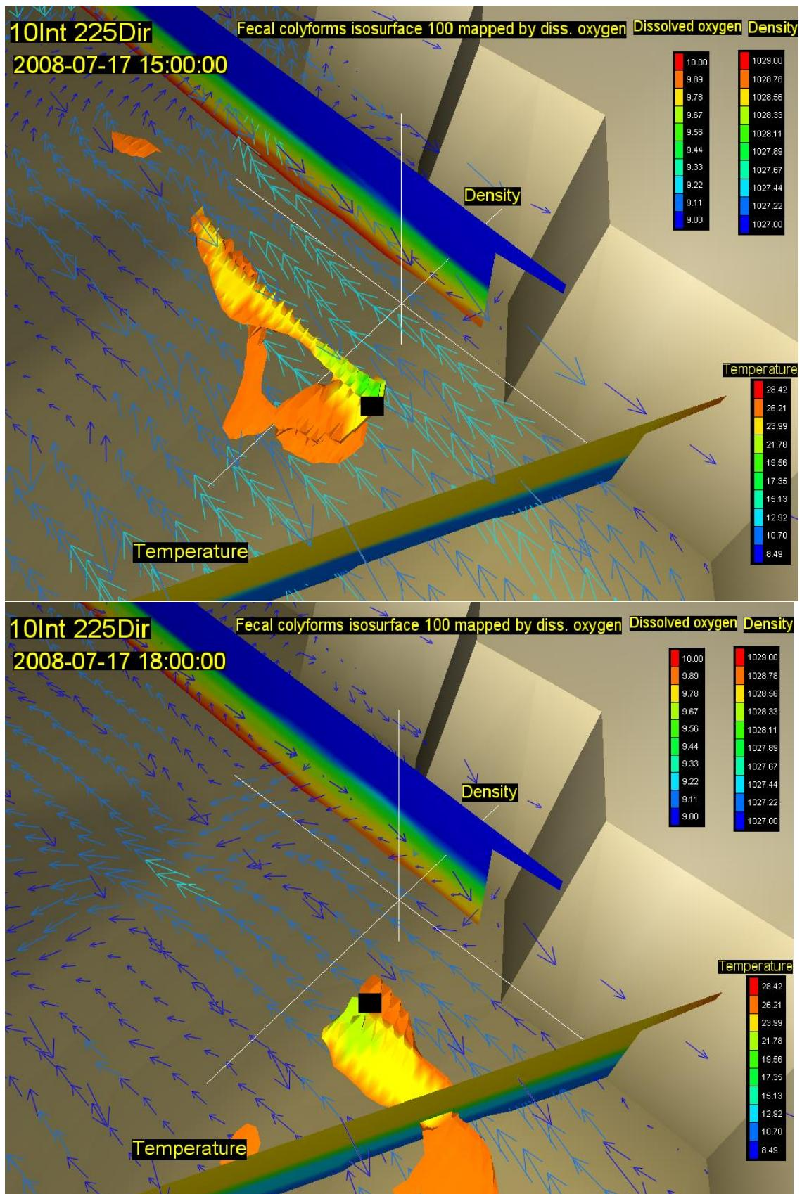
Slika 70. Vektori brzina na površini (rijetki raster) i na dubini od 20m (gusti raster) s vertikalnim profilom gustoće i temperature, te oblakom onečišćenja koncentracije 100 FC( $100 \text{ ml}^{-1}$ ) za 21. (gore) i 24. st (dolje) za vjetar intenziteta  $10 \text{ ms}^{-1}$  iz smjera 225 stupnjeva
