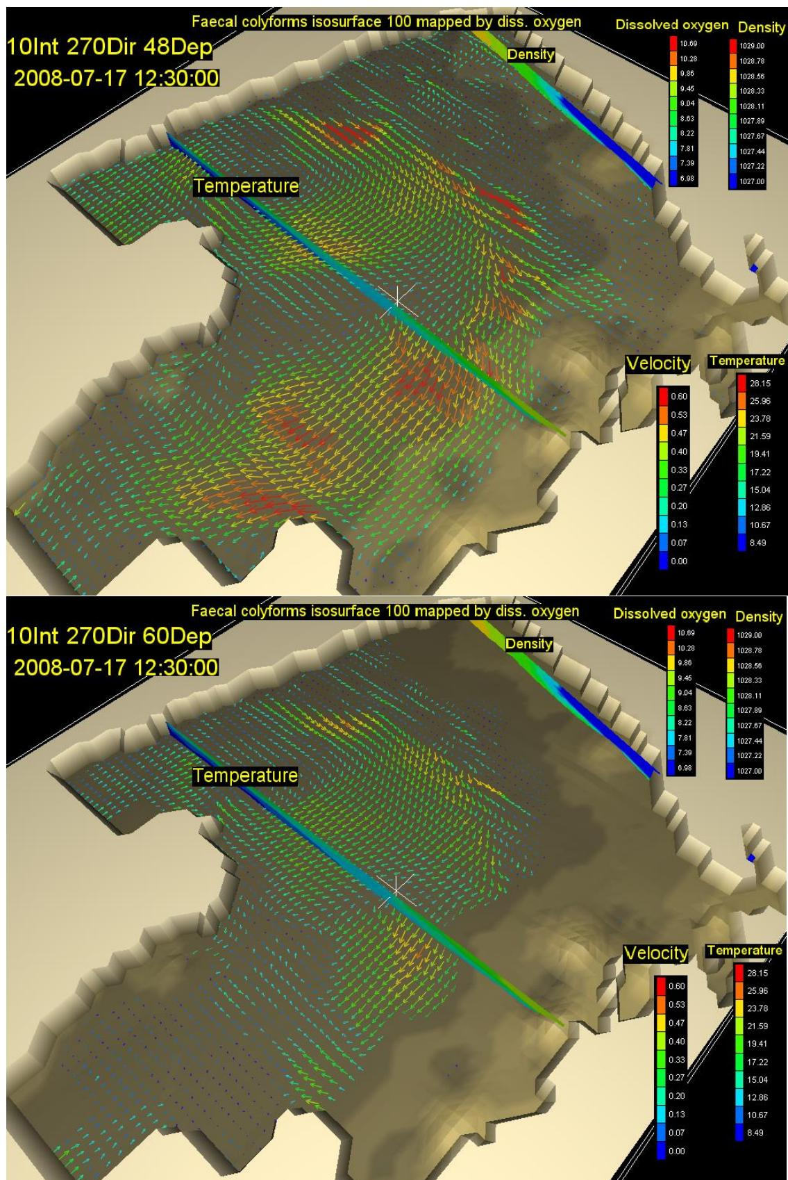
Slika 84. Vektori brzina na dubini od 48m (gore) i 60m (dolje) s vertikalnim profilom gustoće i temperature, te oblakom onečišćenja koncentracije  $100 \text{ FC}(100 \text{ ml})^{-1}$  za 16,5. st za vjetar intenziteta  $10 \text{ ms}^{-1}$  iz smjera 270 stupnjeva
