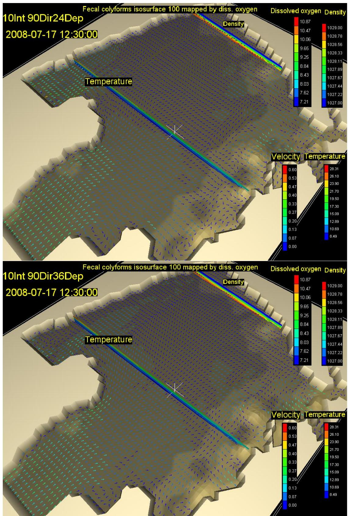
Slika 57. Vektori brzina na dubini od 24m (gore) i 36m (dolje) s vertikalnim profilom gustoće i temperature, te oblakom onečišćenja koncentracije 100 FC(100 ml)<sup>-1</sup> za 16,5. st za vjetar intenziteta  $10 \text{ ms}^{-1}$  iz smjera 90 stupnjeva
