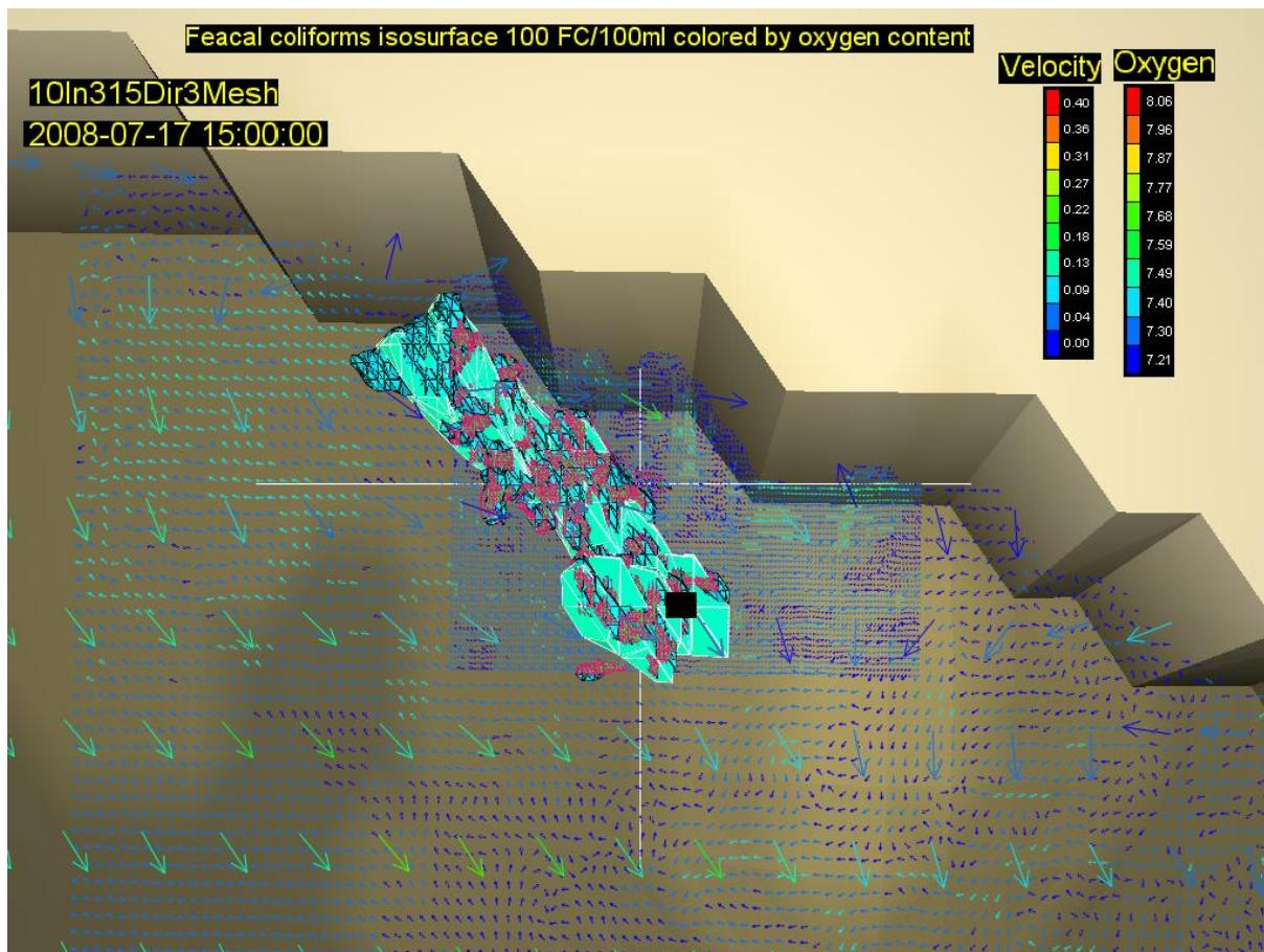
Slika 11. Vektori brzina i oblak FC koncentracije 100 bakterija po 100 ml mora na tri različite mreže: gruboj (bijeli bridovi), srednjoj (crni bridovi) i finoj (crveni bridovi) za vjetar intenziteta  $10 \text{ ms}^{-1}$  i smjer od 135 stupnjeva
