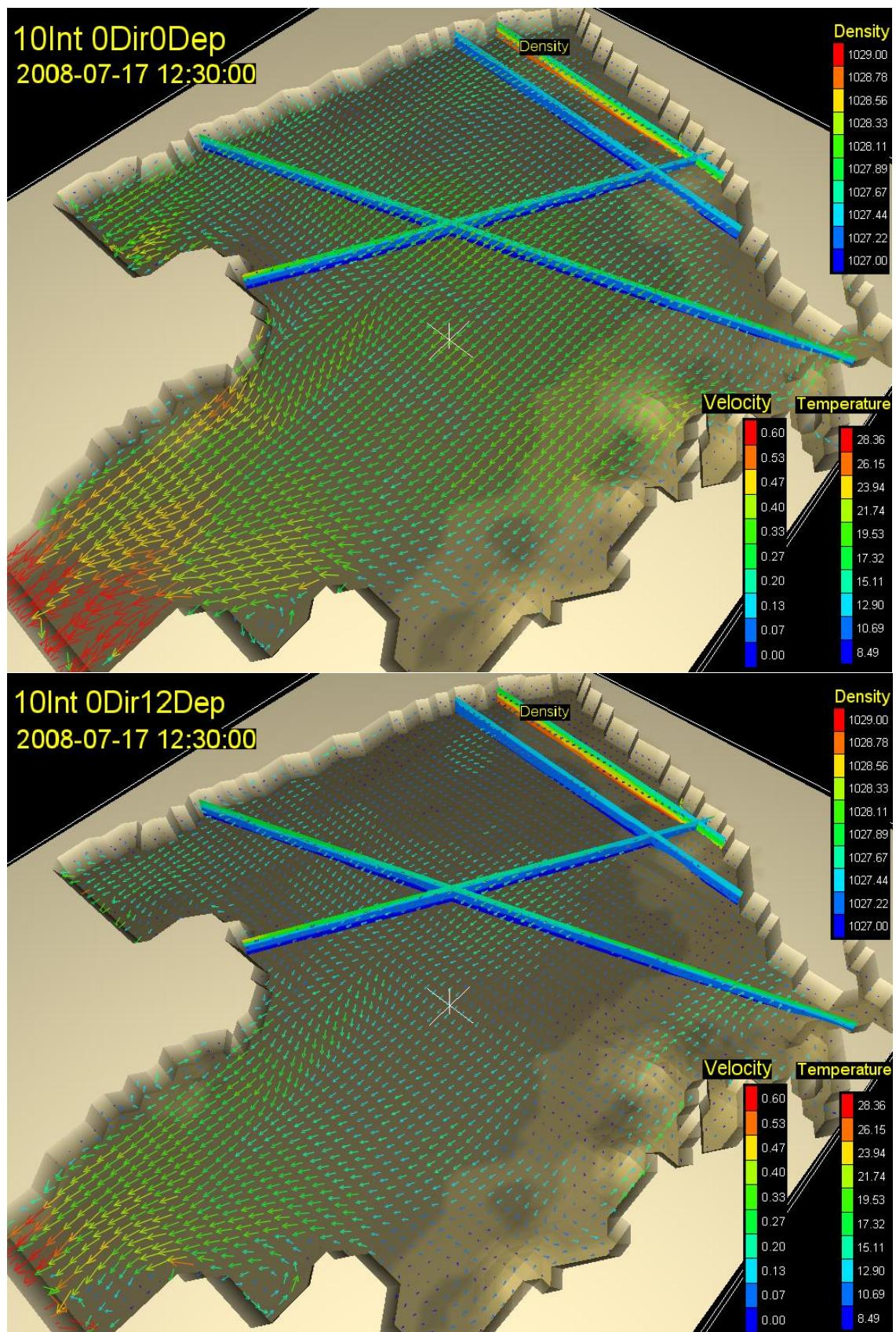
Slika 47. Vektori brzina na površini (gore) i na dubini od 12m (dolje) s vertikalnim profilom gustoće i temperature, te oblakom onečišćenja koncentracije  $100 \text{ FC}(100 \text{ ml})^{-1}$  za 16,5. st za vjetar intenziteta  $10 \text{ ms}^{-1}$  iz smjera 0 stupnjeva
