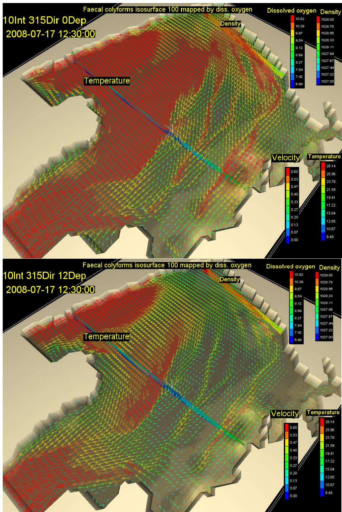
Slika 91. Vektori brzina na površini (gore) i na dubini od 12m (dolje) s vertikalnim profilom gustoće i temperature, te oblakom onečišćenja koncentracije 100 FC( $100 \text{ ml}^{-1}$ ) za 16,5. st za vjetar intenziteta  $10 \text{ ms}^{-1}$  iz smjera 315 stupnjeva
