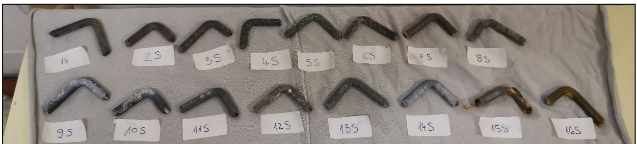
Slika 8.62. Sušenje uzoraka žice Savijenog dijela
