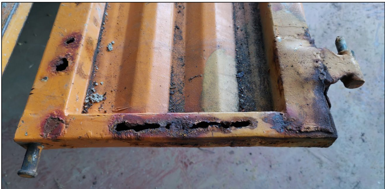
Slika 2.4. Korodirani dijelovi stranice dostavnog vozila [11]
