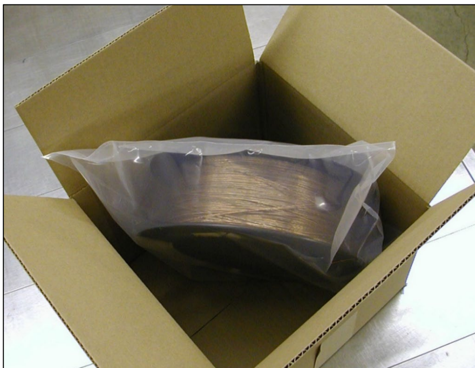
Slika 6.6. Zaštita žice za zavarivanje pomoći VCI molekula u foliji [67]
