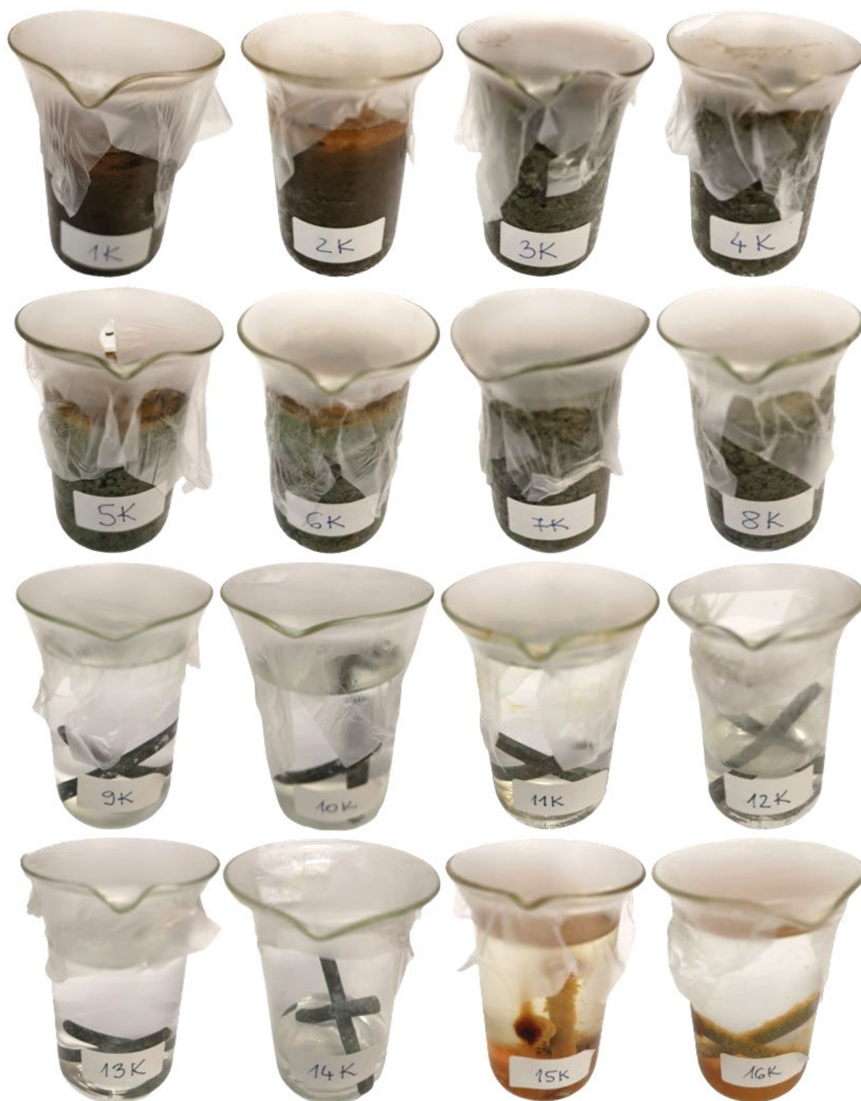
Slika 8.57. Čaše Križnog zavarenog spoja na kraju eksperimenta
