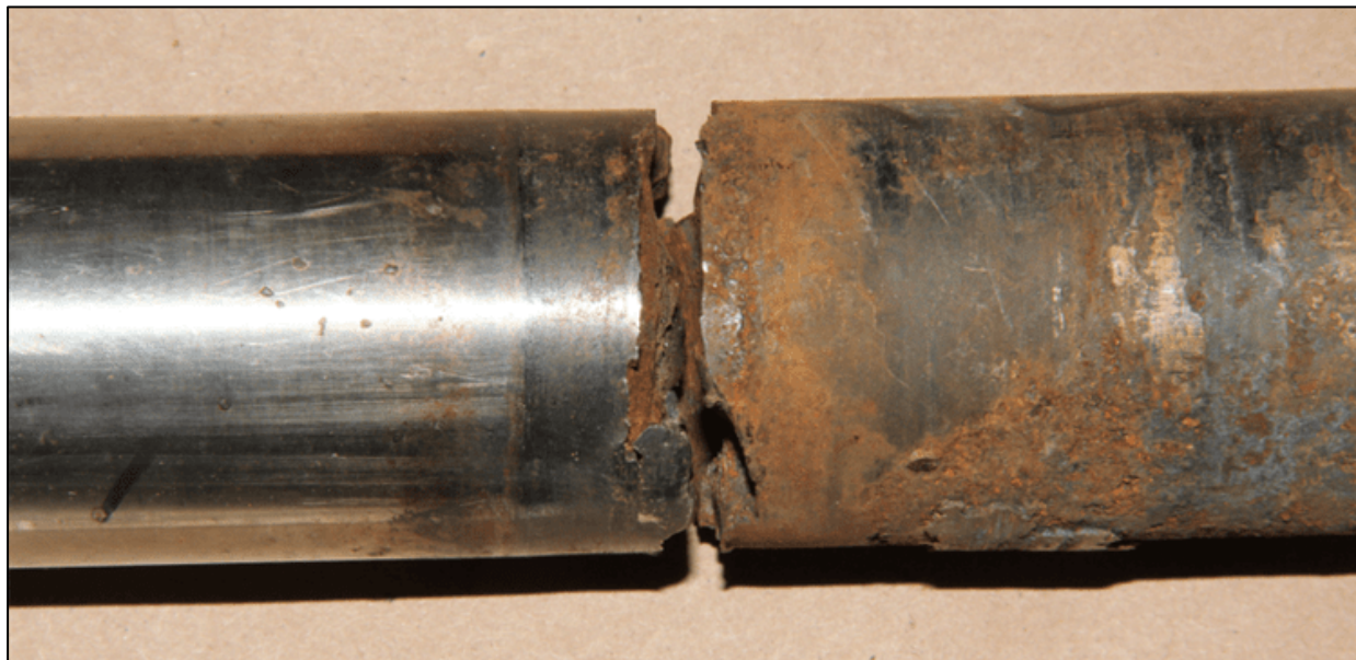
Slika 5.26. Lom vratila uzrokovan korozijskim zamorom [57]
