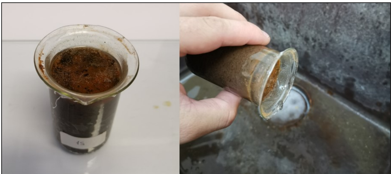
Slika 8.60. Odstranjivanje laboratorijskog filma i pražnjenje vode iz čaše
