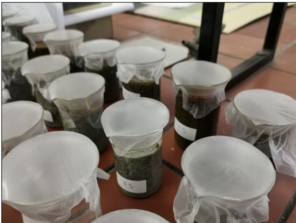
Slika 8.33. Postavljeni Parafilm® na čašama
