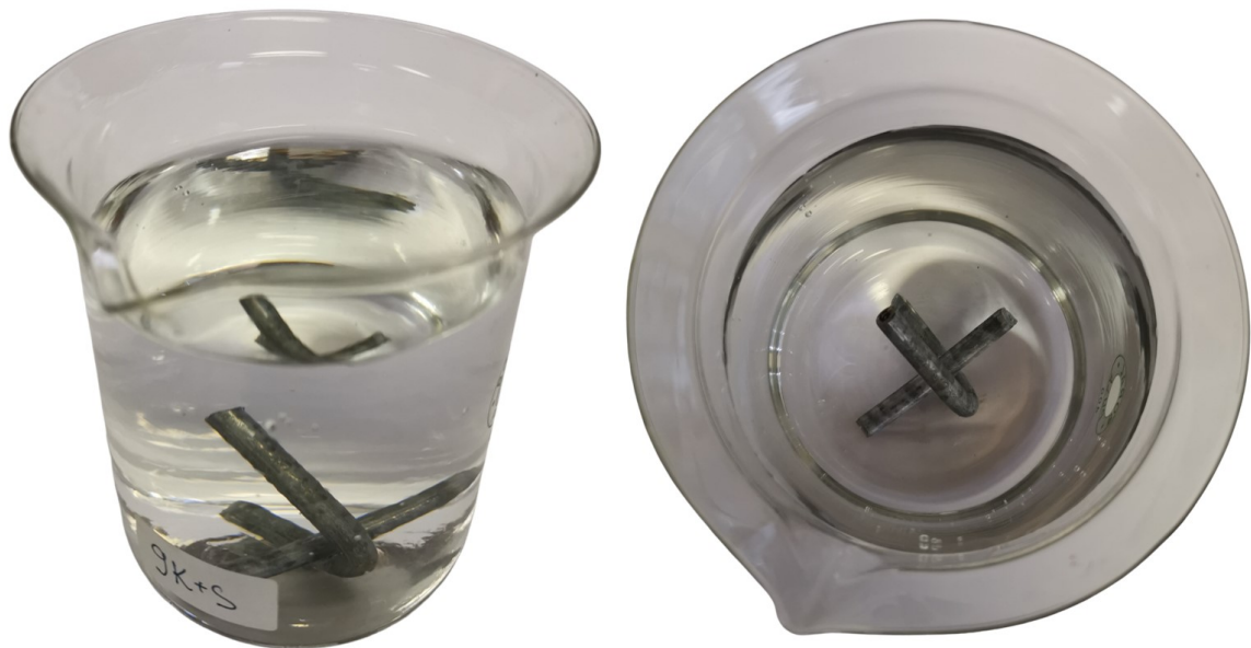
Slika 8.28. Postavljanje uzorka 3K+S u čašu
