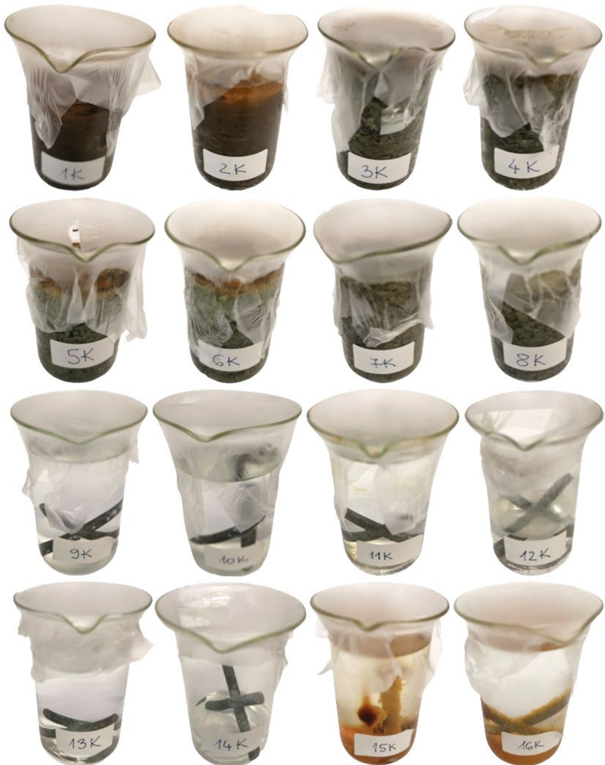
Slika 8.57. Čaše Križnog zavarenog spoja na kraju eksperimenta
