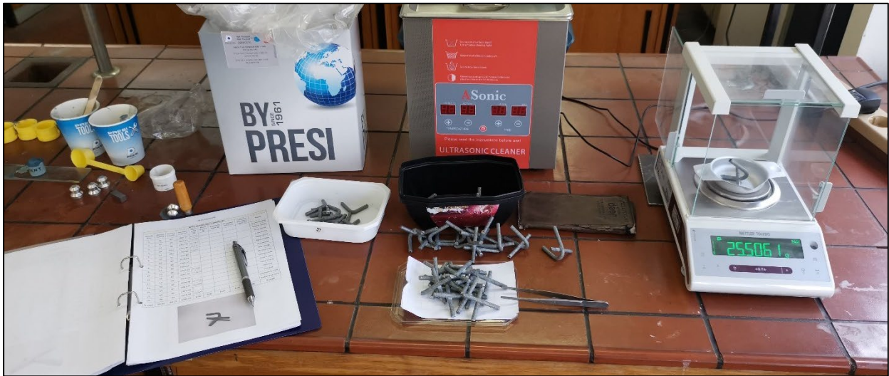
Slika 8.22. Mjerenje početne mase uzoraka žice i ručni unos u tablice
