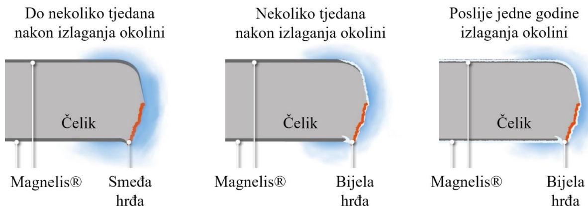
Slika 7.12. Tri glavne faze samozacjeljivanja Magnelis® metalne prevlake [79]
