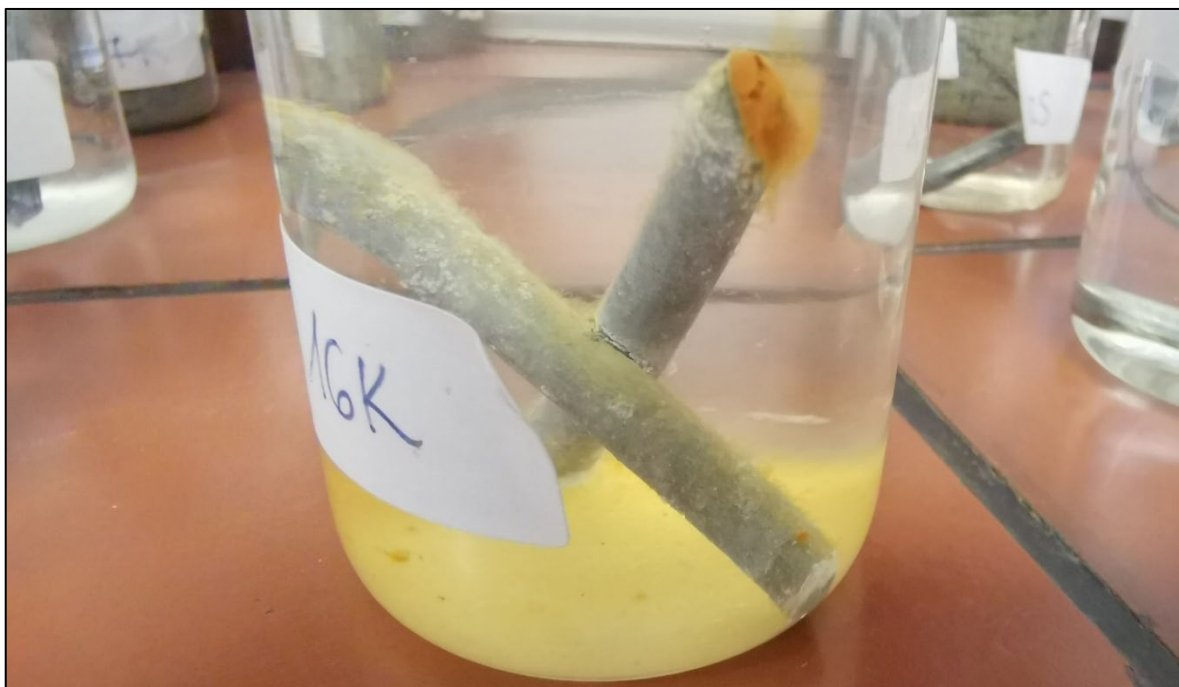
Slika 8.48. Treći pregled – 16K – korozija na mjestu dodira žice i stijenke čaše
