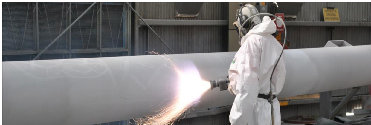
Slika 6.18. Vruće prskanje aluminija na cjevovod [81]
