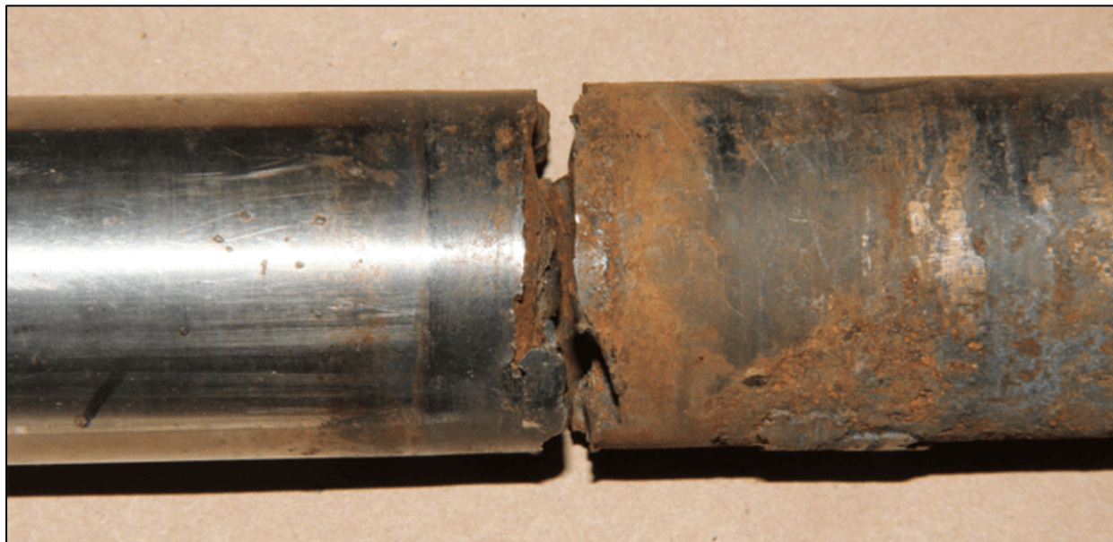
Slika 5.26. Lom vratila uzrokovan korozijskim zamorom [57]
