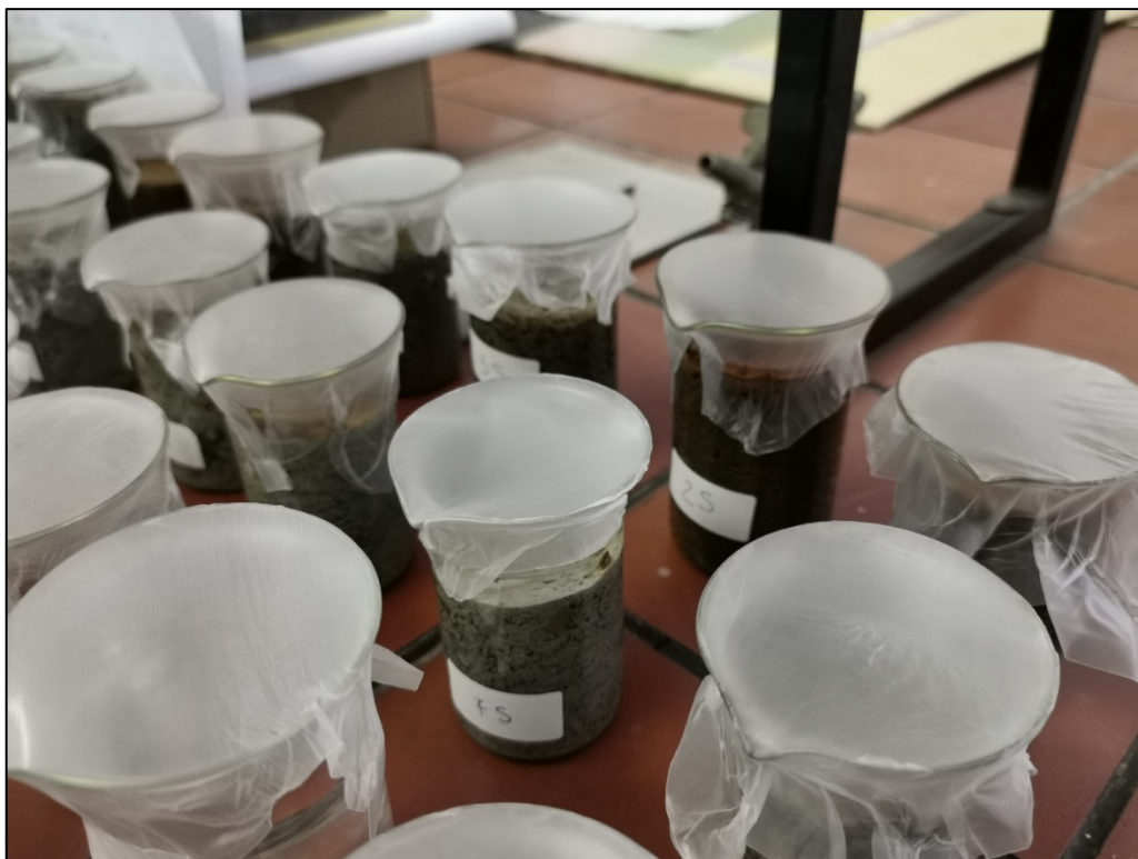
Slika 8.33. Postavljeni Parafilm® na čašama
