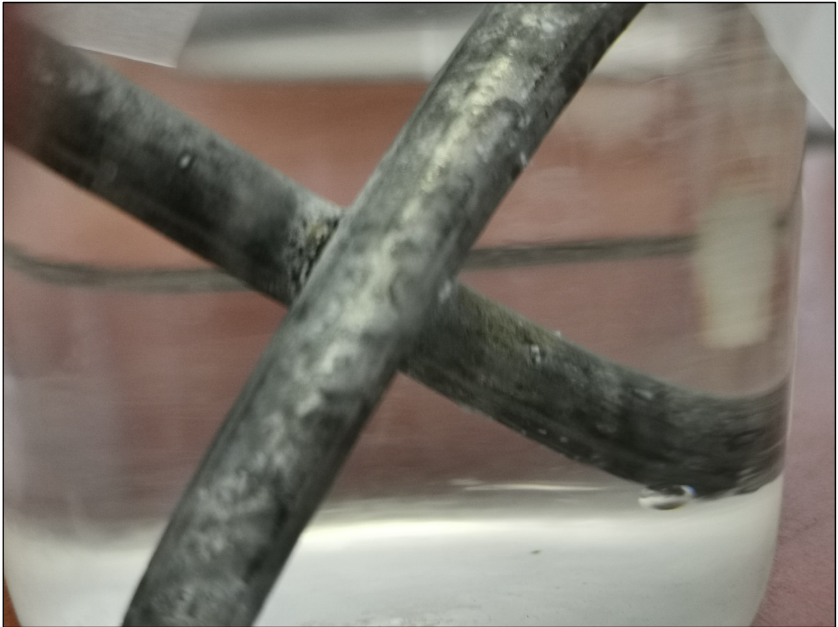
Slika 8.45. Drugi pregled – 9K – slabi znakove korozije pored zavarenog spoja
