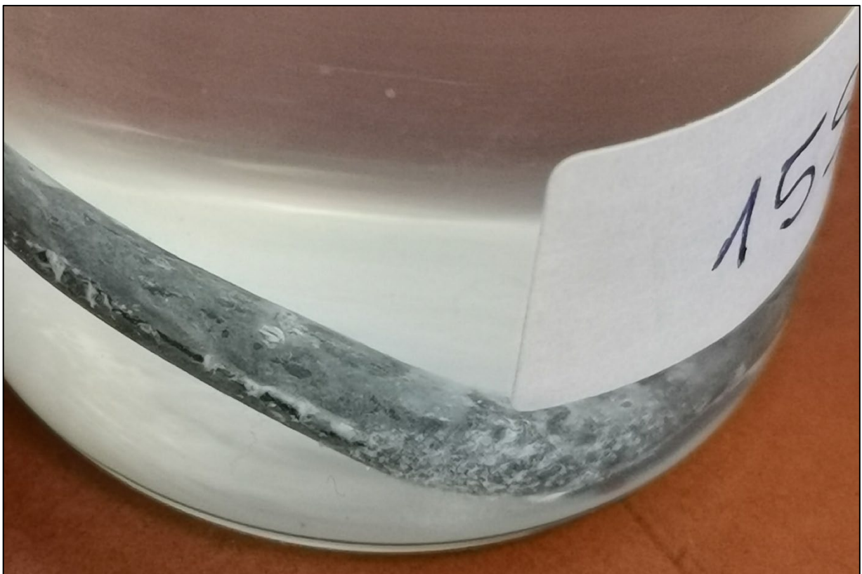
Slika 8.42. Prvi pregled – 15S - bijela korozija cinka
