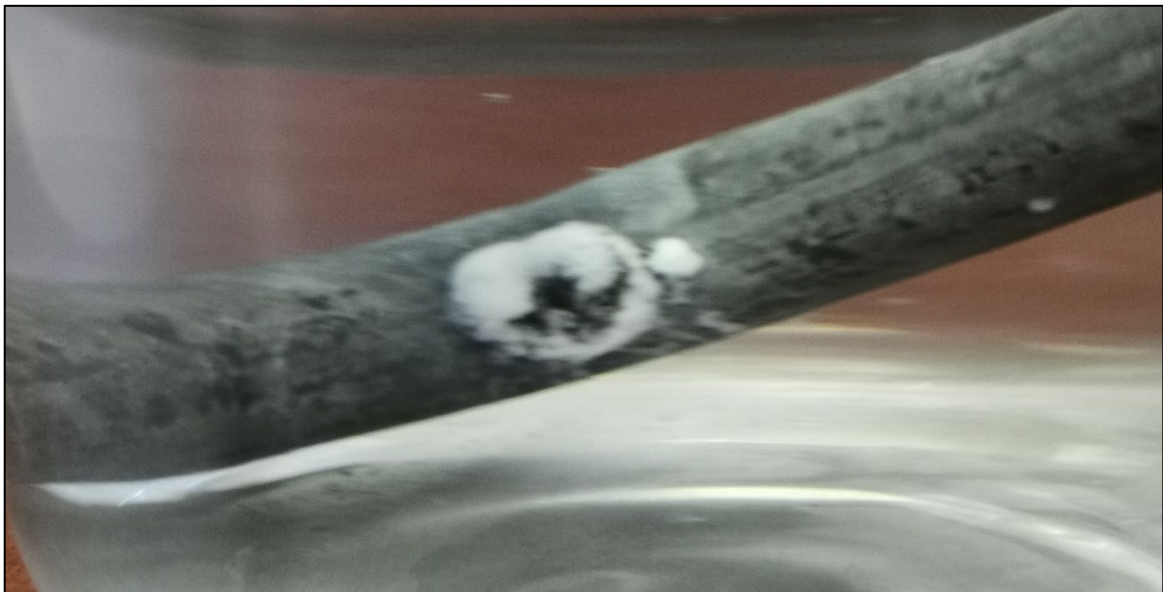
Slika 8.43. Drugi pregled – 15S – znakovi bijele korozije cinka na mjestu savijanja žice
