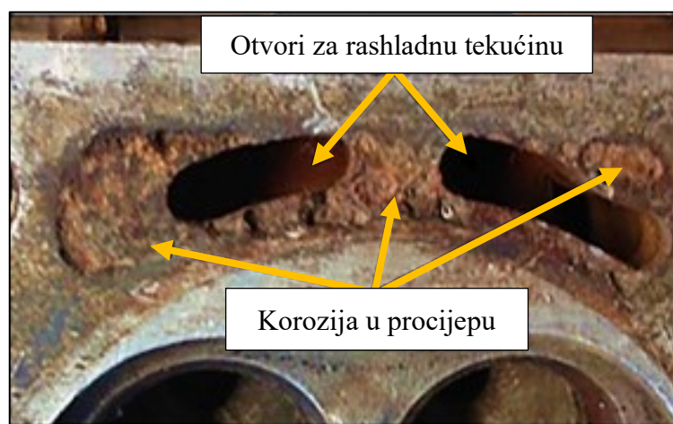
Slika 5.8. Korozija otvora za rashladnu tekućinu u bloku motora
