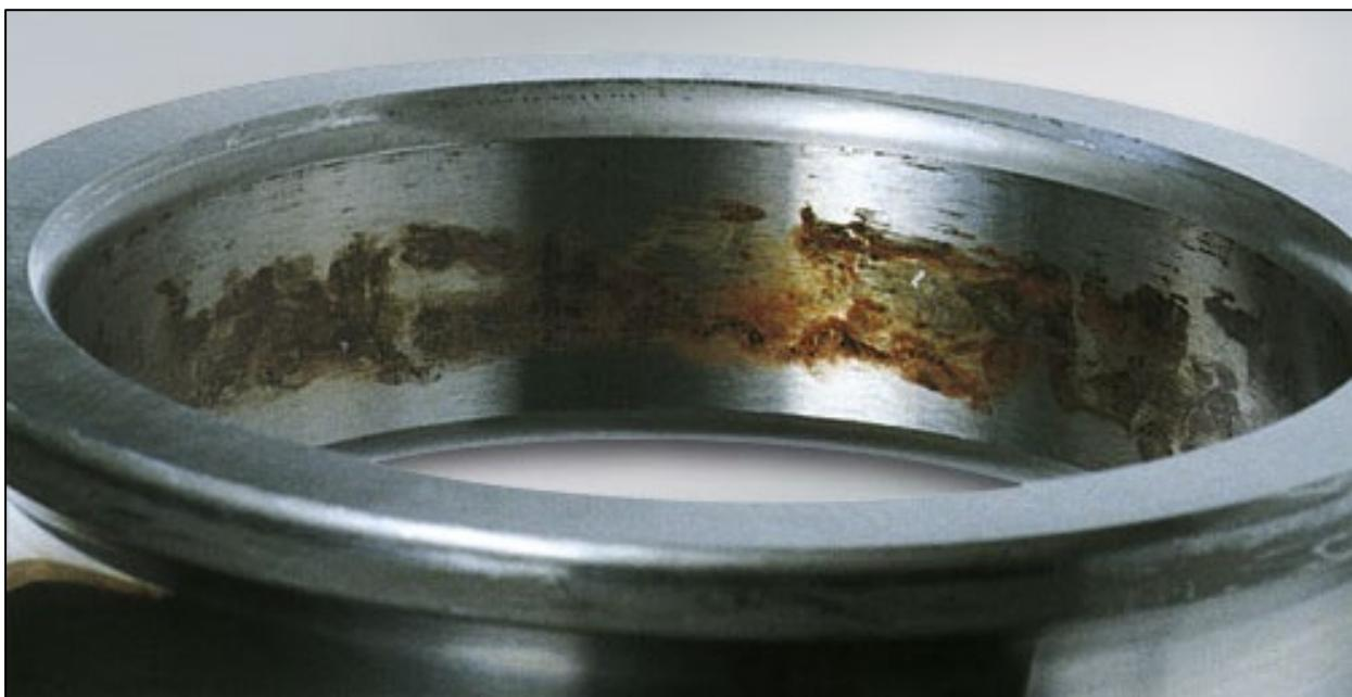
*Slika 5.22. Tarna korozija unutarnjeg prstena jednorednog kugličnog ležaja [54]*
