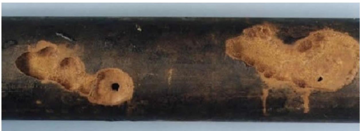
Slika 5.29. Tipičan primjer korozije lutajućih struja [60]
