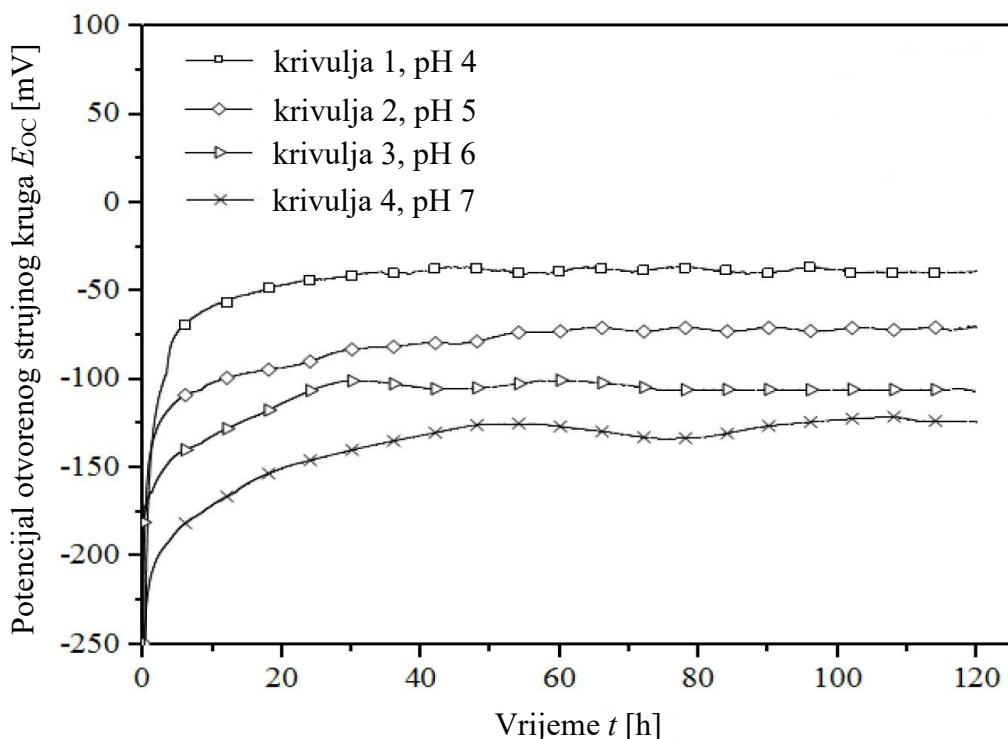
Slika 4.23. Potencijal otvorenog kruga nehrđajućeg čelika AISI 304 [37]
