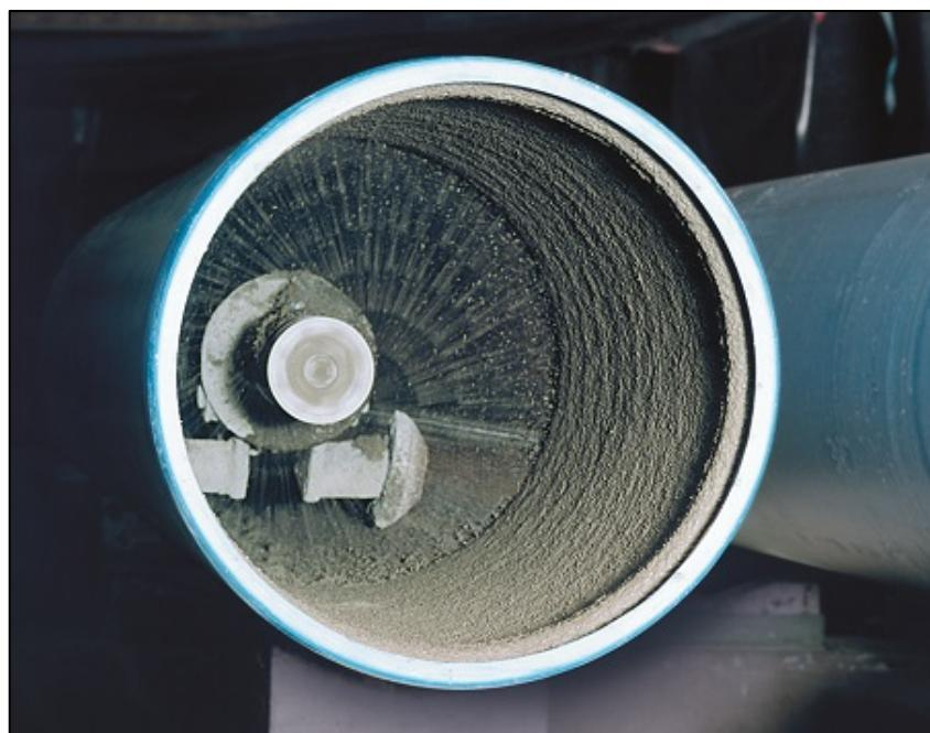
*Slika 6.20. Postavljanje betonske prevlake na unutarnju stranu cjevovoda [83]*
