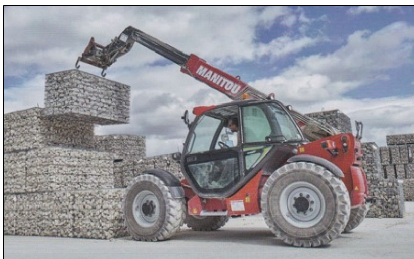
Slika 7.10. Gabion od elektrootporno zavarivane i savijane mreže sa sajlama za podizanje [98]
