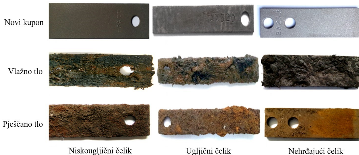
Slika 4.25. Korozijski kuponi različitih materijala u korozivnim okolinama [38]
