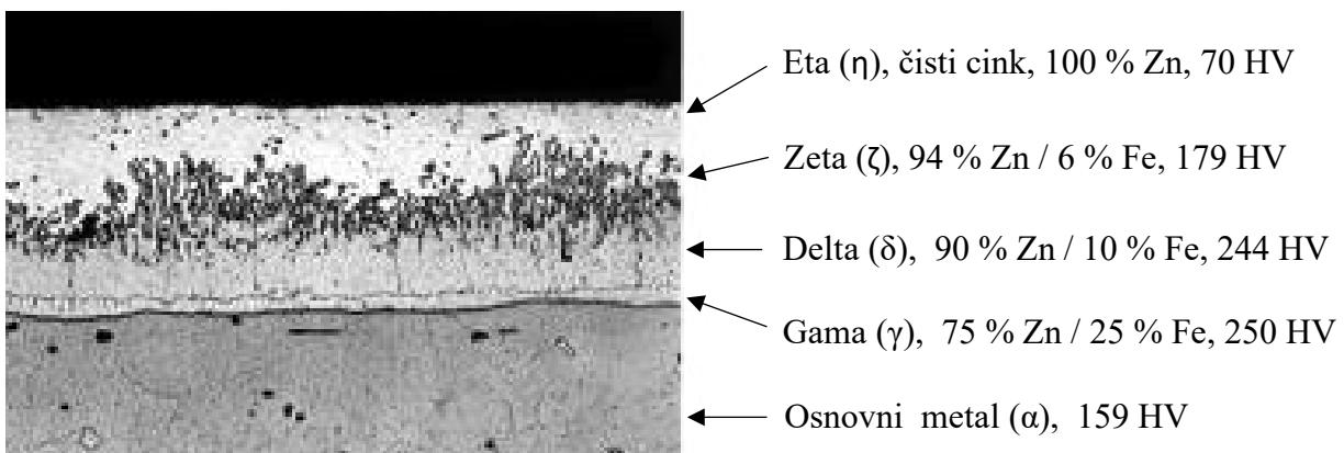
*Slika 6.14. Slojevi legura cinka i željeza na površini pocičanog čelika [77]*
