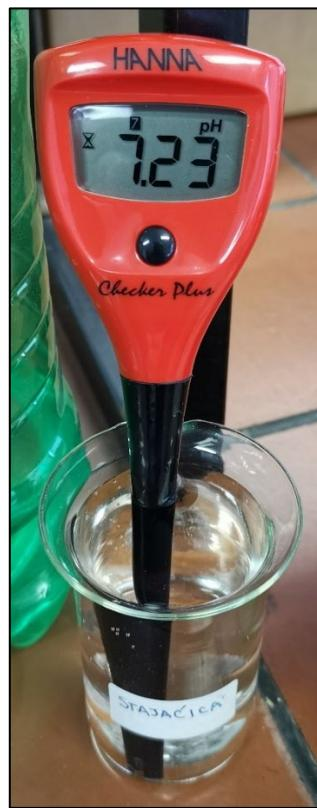
*Slika 8.38. Mjerenje pH-vrijednosti vode pH mjeračem Hanna® Checker® Plus*
