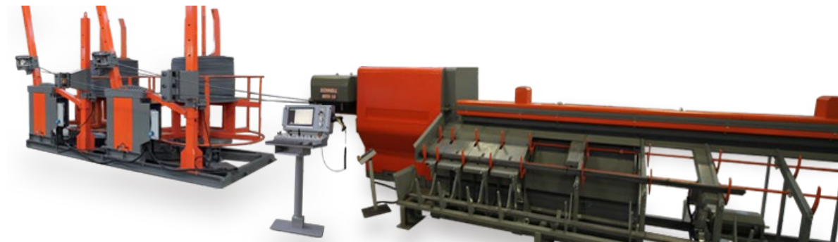
Slika 7.11. Stroj za ravnanje žice u kolutu [99]
