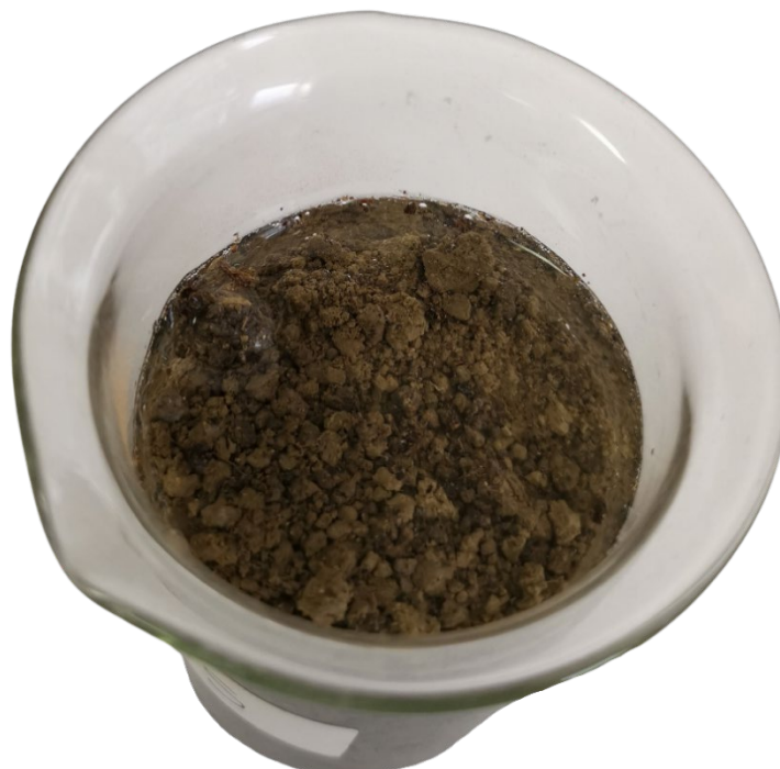
Slika 8.27. Dodavanje destilirane vode u uzorak 3K+S
