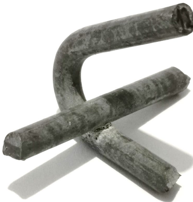
Slika 8.4. Križni zavareni spoj + savijeni dio
