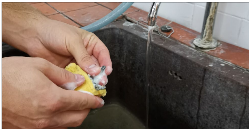
Slika 8.66. Skidanje korozivskog produkta s uzoraka žice
