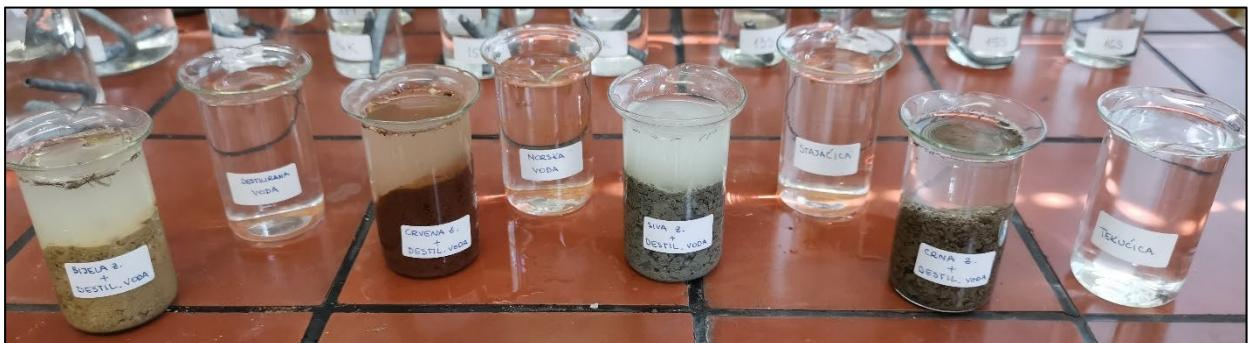
Slika 8.37. Priprema suspenzije zemlje u vodi i tekućine za mjerene pH-vrijednosti
