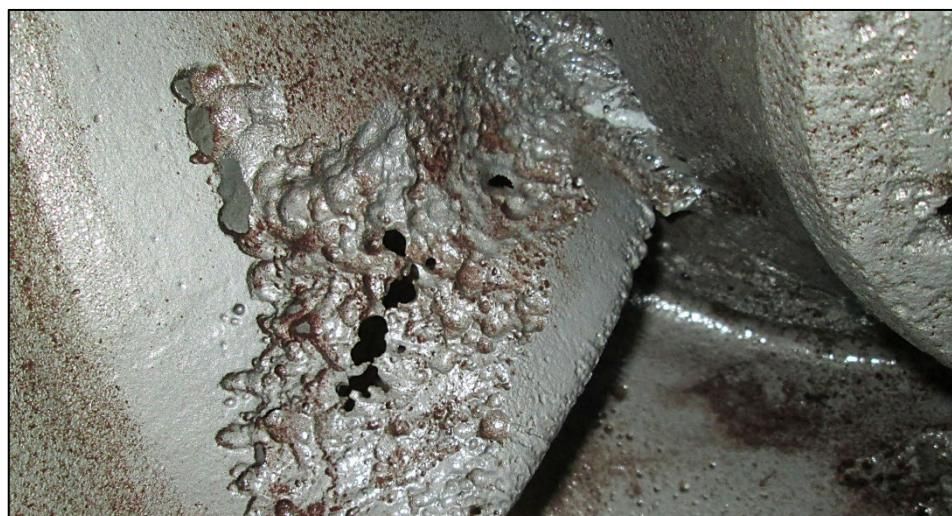
Slika 5.21. Kavitacijska korozija rotora pumpe [53]
