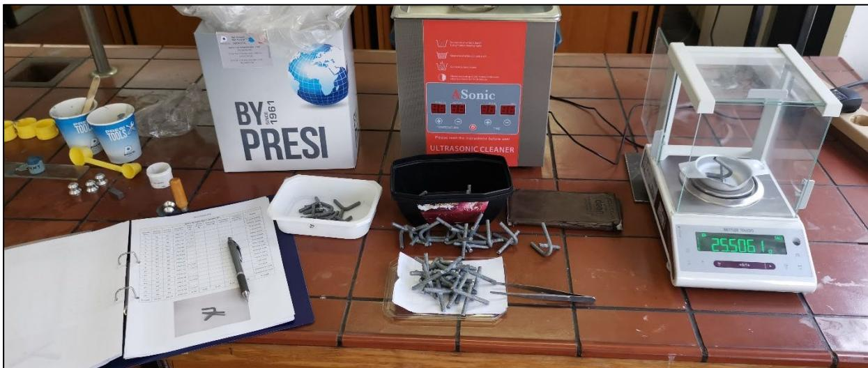
Slika 8.22. Mjerjenje početne mase uzorka žice i ručni unos u tablice
