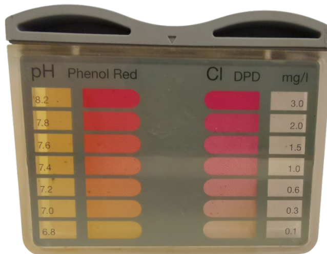
Slika 8.39. Mjerenje pH-vrijednosti destilirane vode reagens tabletama PHENOLRED
