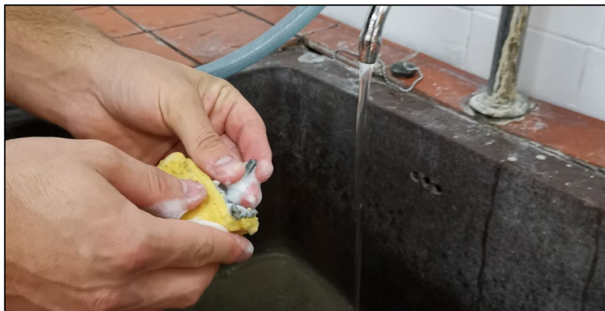
Slika 8.66. Skidanje korozivskog produkta s uzoraka žice
