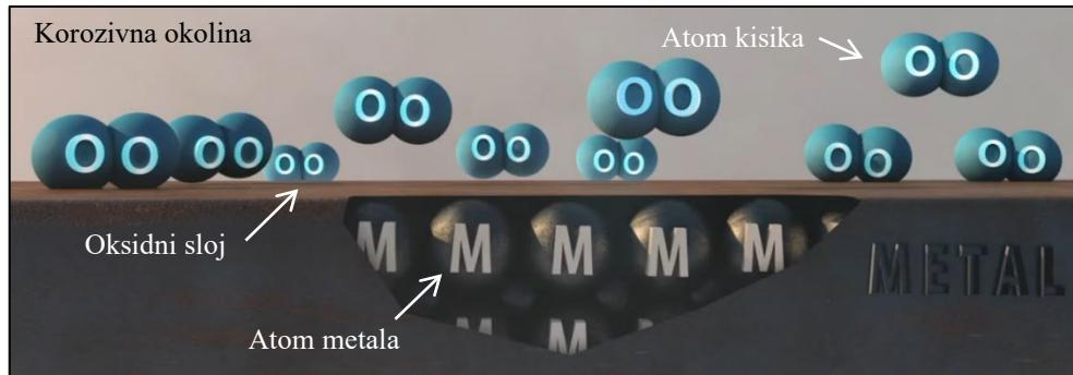
Slika 3.2. Površina metala izložena korozivnoj okolini [17]
