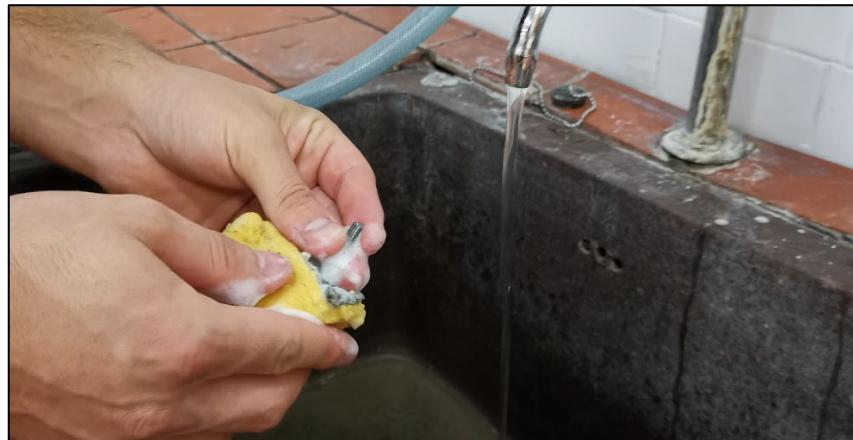
*Slika 8.66. Skidanje korozijskog produkta s uzorka žice*
