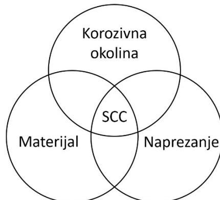
Slika 5.24. Tri faktora koja utječu na napetosnu koroziju (SCC)
