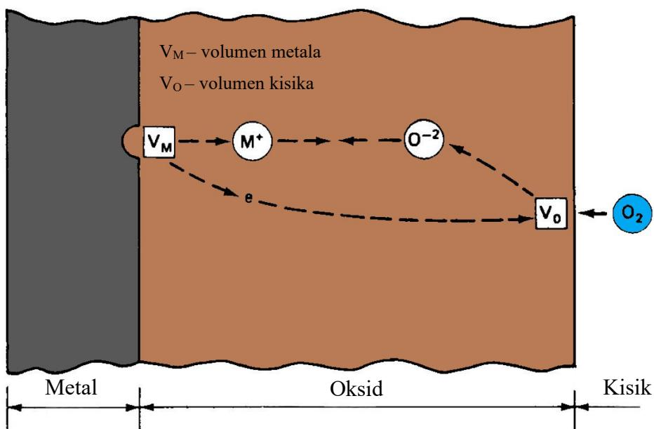
Slika 3.1. Shematska ilustracija elektrokemijskog procesa tijekom oksidacije kisikom [2]
