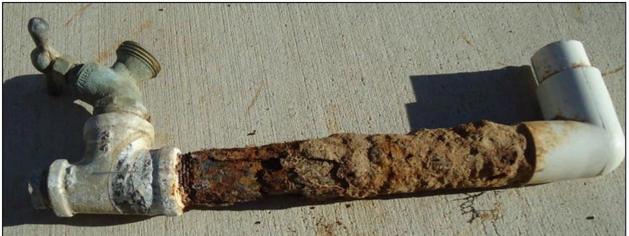
*Slika 5.4. Galvanska korozija pocičane čelične cijevi [41]*
