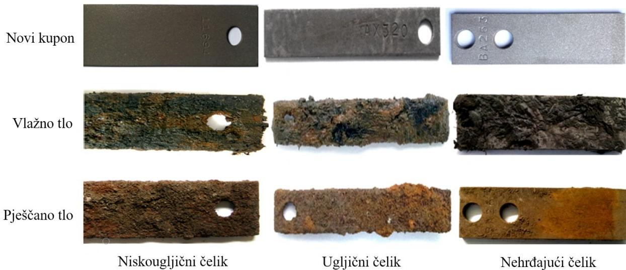
Slika 4.25. Koroziski kuponovi različitih materijala u korozivnim okolinama [38]
