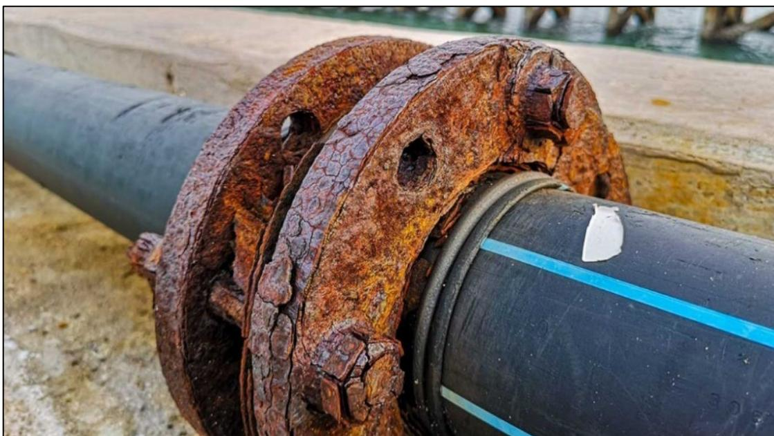
Slika 2.2. Korozija spoja dviju PEHD (alkaten) cijevi [7]
