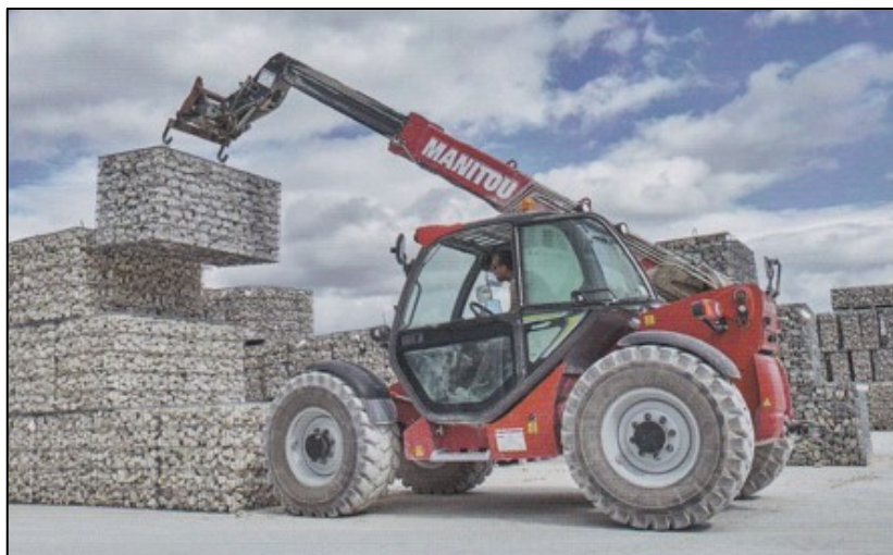
Slika 7.10. Gabion od elektrootporno zavarivane i savijane mreže sa sajlama za podizanje [98]
