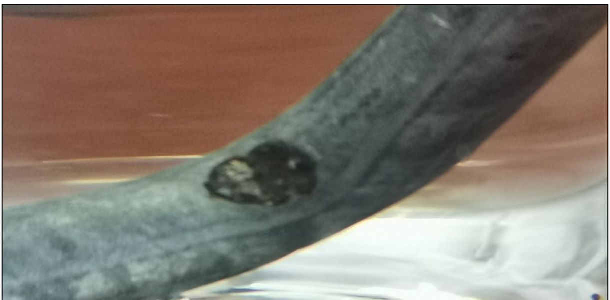
Slika 8.46. Drugi pregled – 12S – nema znakova korozije na mjestu savijanja
