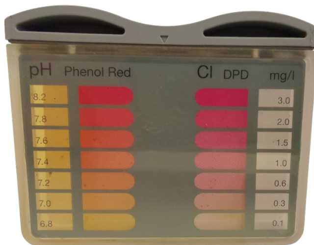
Slika 8.39. Mjerenje pH-vrijednosti destilirane vode reagens tabletama PHENOLRED
