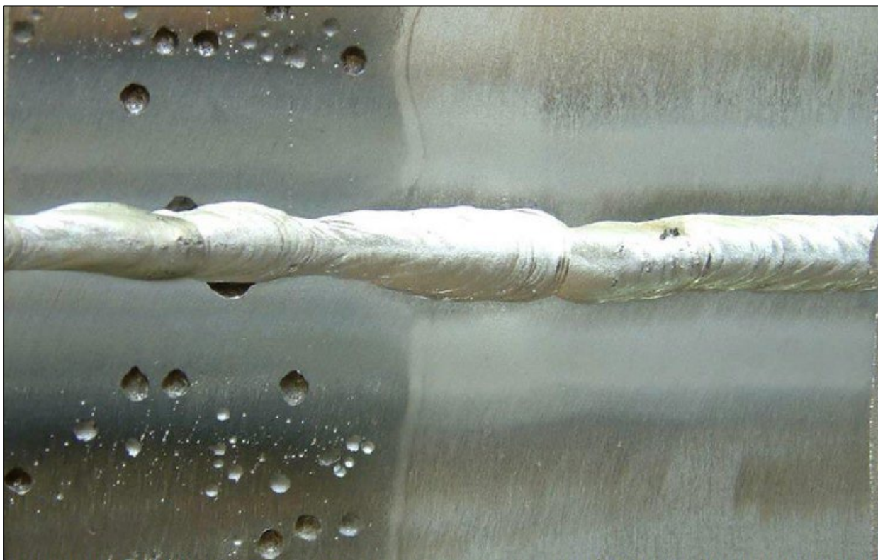
Slika 5.12. Rupičasta korozija nehrđajućeg čelika AISI 304L prilikom zavarivanja [14]
