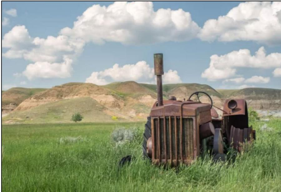
Slika 4.11. Korozija traktora u ruralnoj atmosferi [24]
