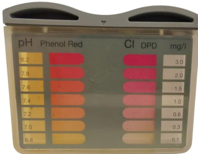
Slika 8.39. Mjerenje pH-vrijednosti destilirane vode reagens tabletama PHENOLRED
