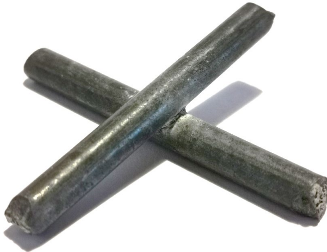
Slika 8.3. Križni zavareni spoj
