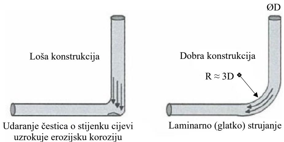
Slika 6.3. Utjecaj radijusa zavoja cijevi na koroziju
