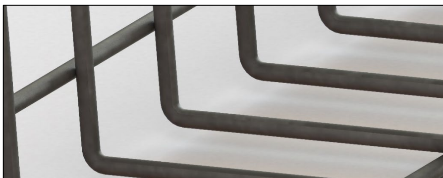
Slika 7.16. Savijanje čelične mreže pod 90^\circ
