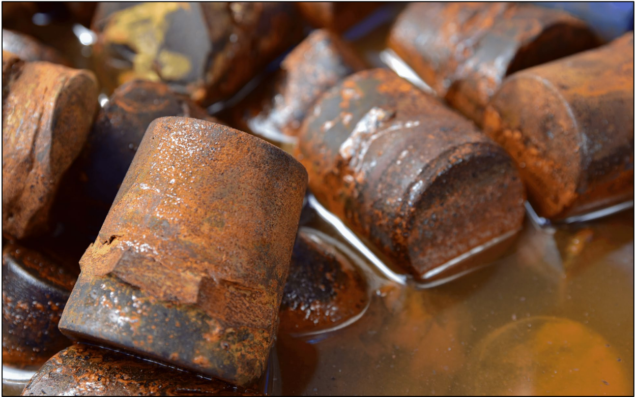
Slika 4.1. Korozija uz prisustvo elektrolita
