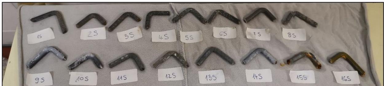
Slika 8.62. Sušenje uzorka žice Savijenog dijela
