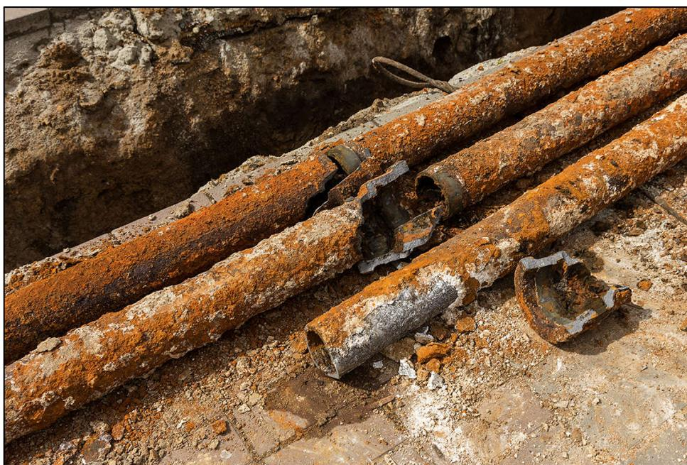
Slika 4.18. Korodirana vodovodna cijev od lijevanog željeza
