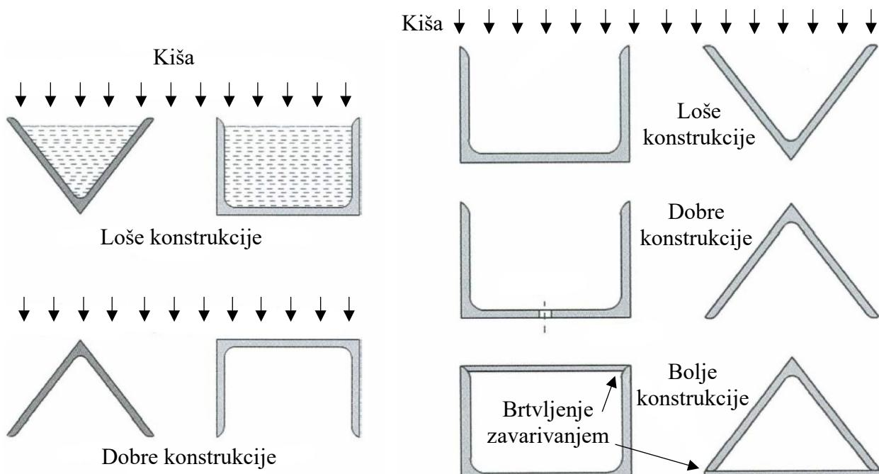
Slika 6.2. Dobre i loše konstrukcije u odvodnji elektrolita [64]
