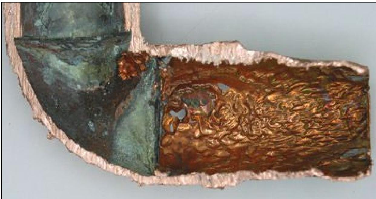
Slika 5.19. Erozijska korozija bakrene cijevi [51]
