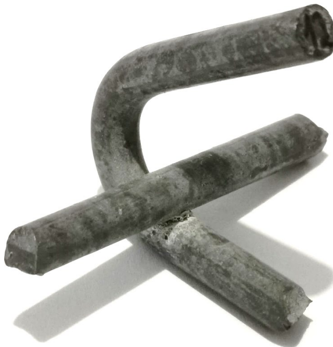
Slika 8.4. Križni zavareni spoj + savijeni dio
