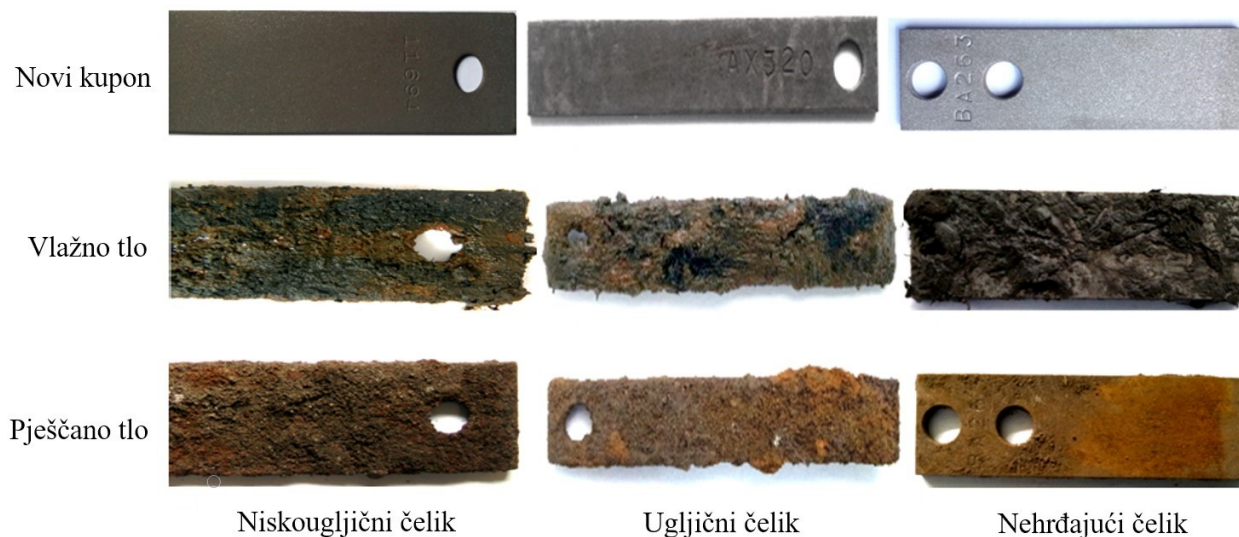
Slika 4.25. Korozijski kuponi različitih materijala u korozivnim okolinama [38]
