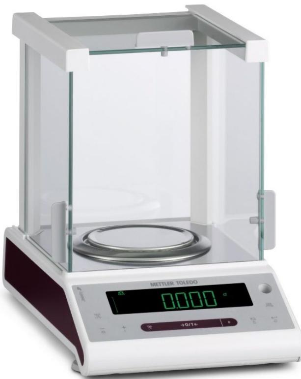
Slika 4.21. Precizna laboratorijska vaga Mettler Toledo NewClassic MF JP703C
