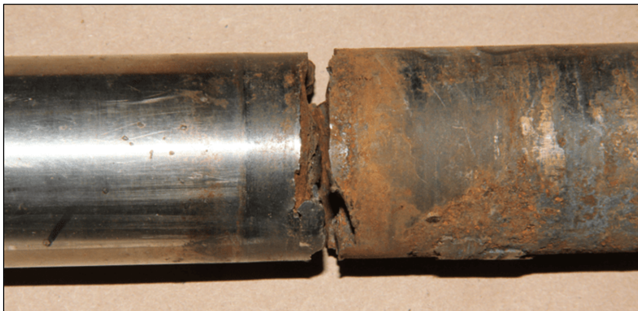
Slika 5.26. Lom vratila uzrokovan korozijskim zamorom [57]
