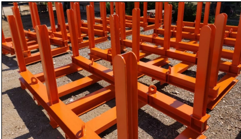
Slika 6.22. Zaštita paleta za skladištenje specijalnih vijaka antikorozivnim premazima [11]
