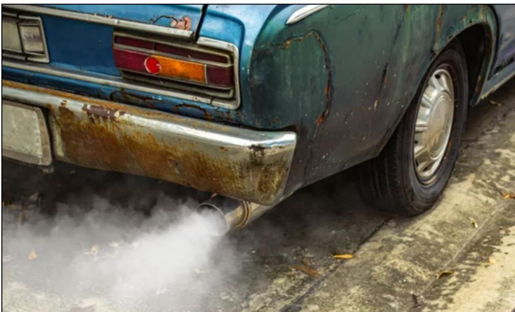
*Slika 4.10. Korozija automobila u gradskoj atmosferi [23]*
