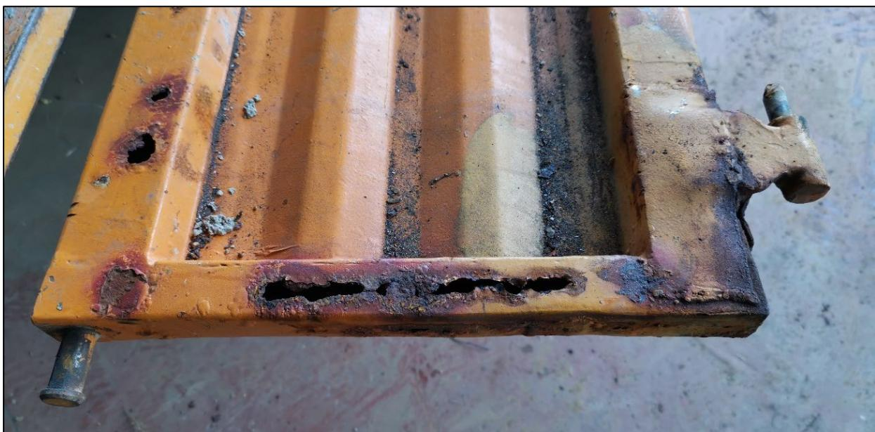
*Slika 2.4. Korodirani dijelovi stranice dostavnog vozila [11]*
