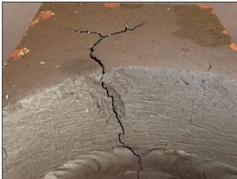
*Slika 5.25. Oštećenje napetosnom korozijom pored zavara [56]*
