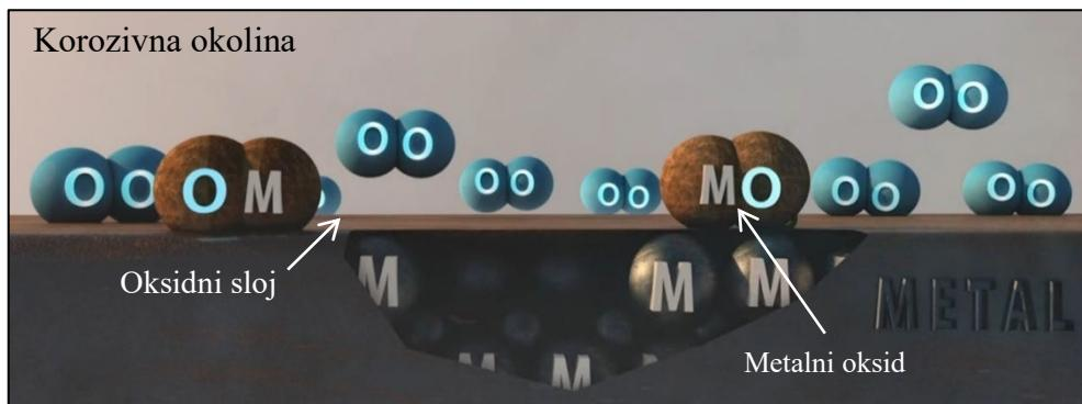
Slika 3.6. Formiranje spoja metalnog oksida [17]
