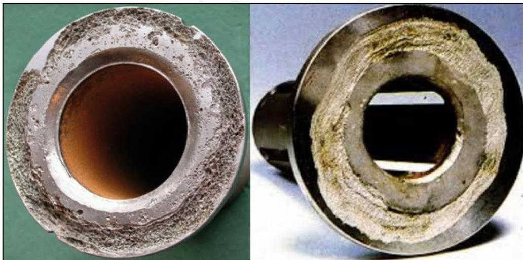
*Slika 5.7. Korozija prirubnica s brtvom [43]*
