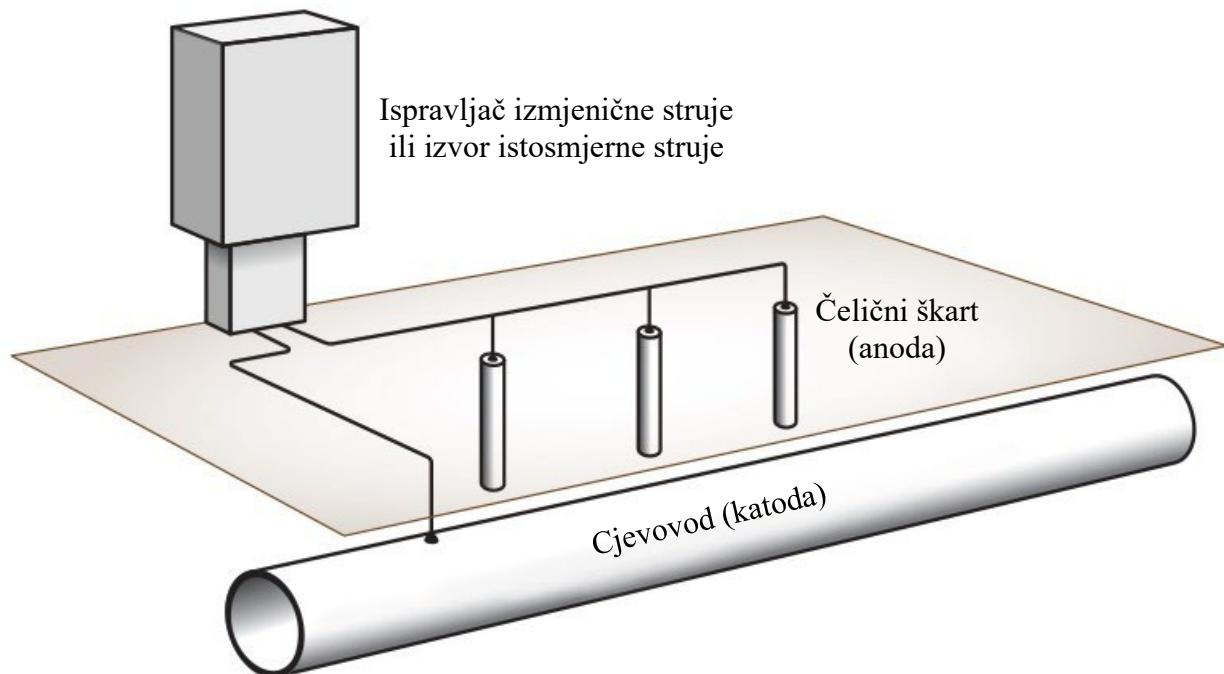
Slika 6.9. Katodna zaštita vanjskim izvorima istosmjerne struje [71]
