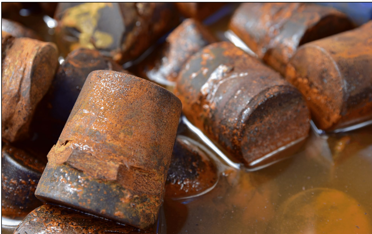
Slika 4.1. Korozija uz prisustvo elektrolita
