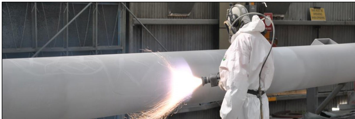
Slika 6.18. Vruće prskanje aluminija na cjevovod [81]
