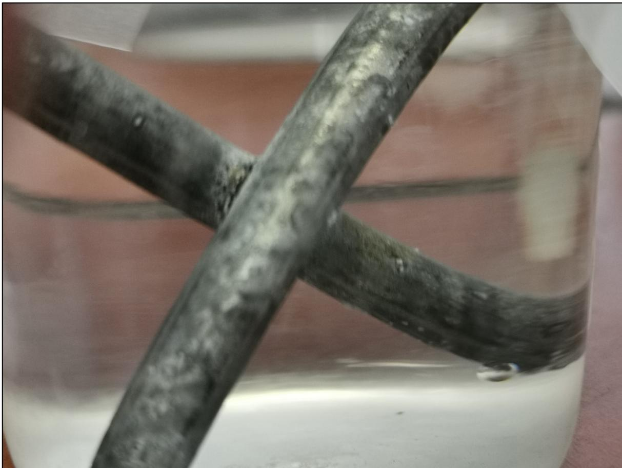
*Slika 8.45. Drugi pregled – 9K – slabи znakove korozije pored zavarenog spoja*
