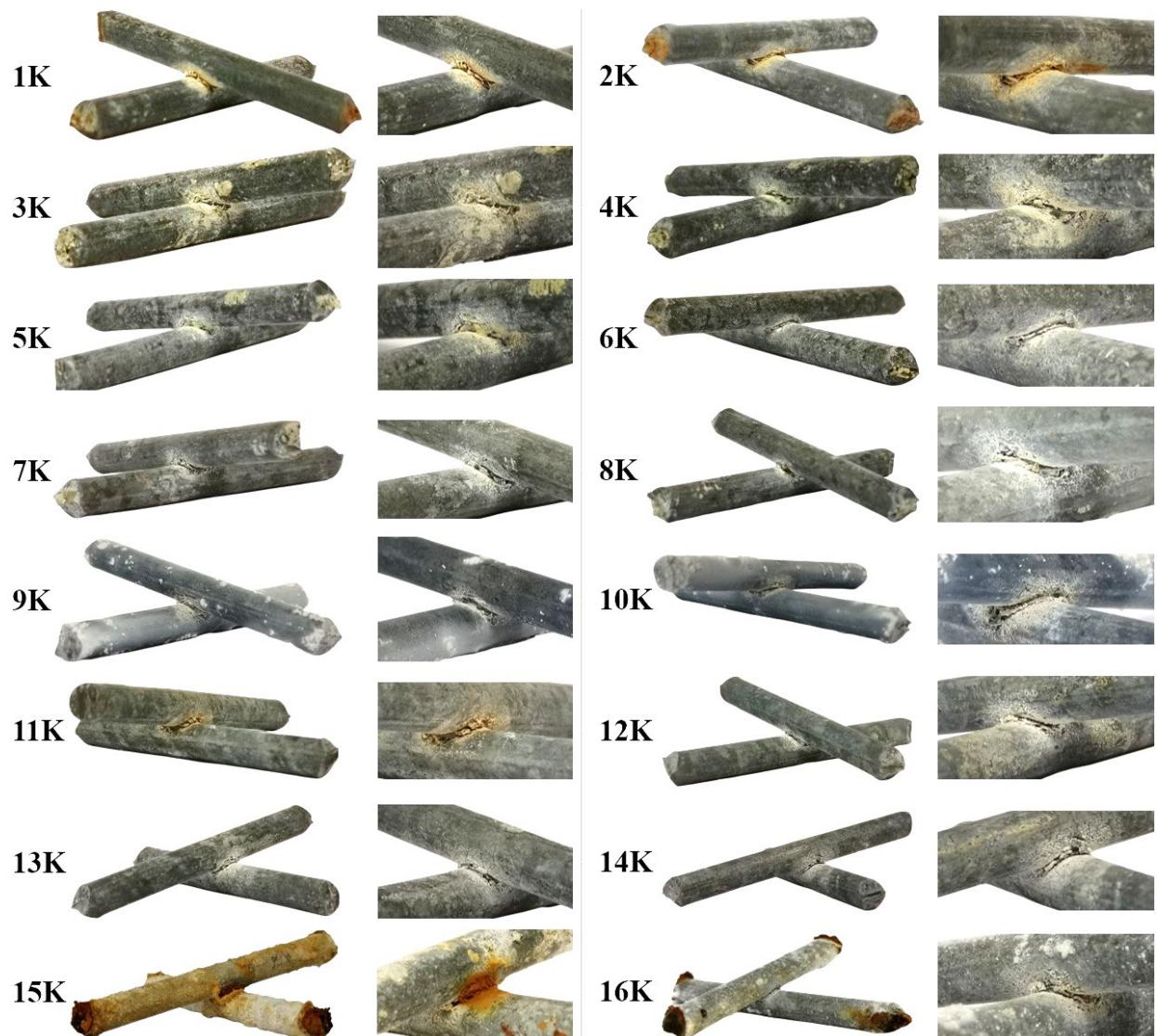
*Slika 8.64. Križni zavareni spojevi na kraju eksperimenta*
