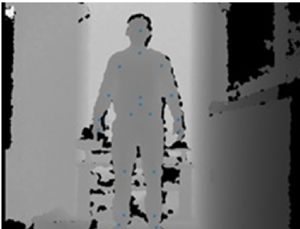
Slika 3.9: Dubinska slika dobivena Kinectom
