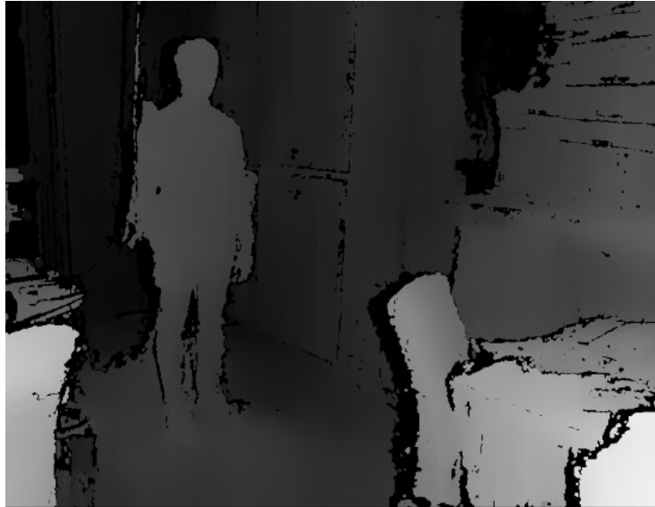
(a) Udaljenost od kamere kodirana u dubinskoj slici
