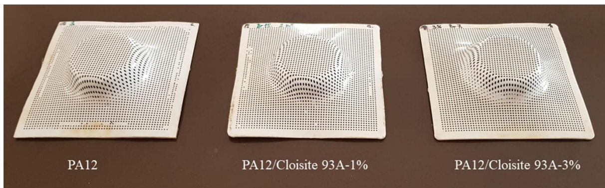
Slika 6.1 Uzorci dobiveni SPIF tehnologijom: PA12 (lijevo), PA12 nanokompozit s 1% gline (sredina) i PA12 nanokompozit s 3% gline (desno) [31]
