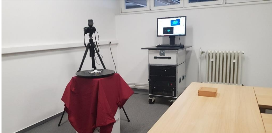
Slika 5.45 Prikaz mjernog sustava GOM ARGUS
