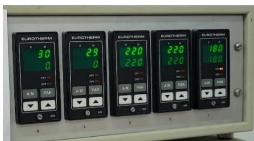
Slika 5.5. Prikaz radnih temperatura tijekom procesa ekstruzije
