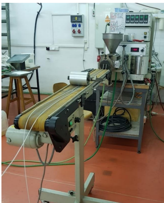
Slika 5.3 Prikaz Brabender dvopužnog ekstrudera i Brabender staze za hlađenje
