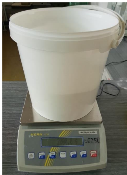
Slika 5.2 Vaganje PA12 polimernog praha za potrebu izrade prve smjese
