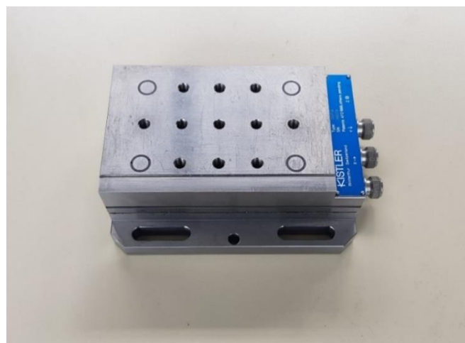
Slika 5.37 Dinamometar Kistler 9257A koji je korišten tijekom eksperimenta
