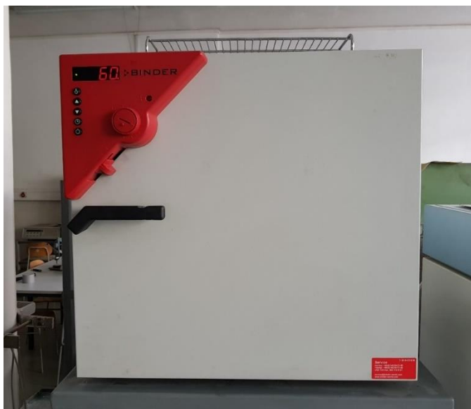
Slika 5.1 Sušenje polimera EOS PA12 2200
