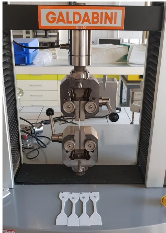
Slika 5.16 Ispitivanje vlačne čvrstoće
