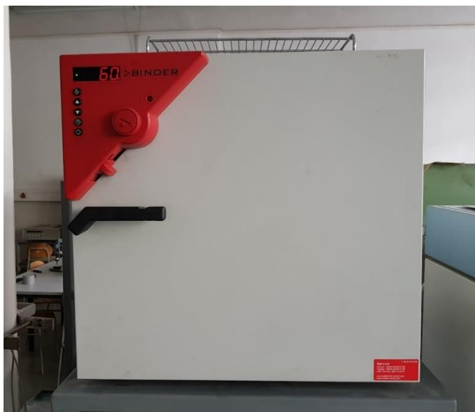
Slika 5.1 Sušenje polimera EOS PA12 2200
