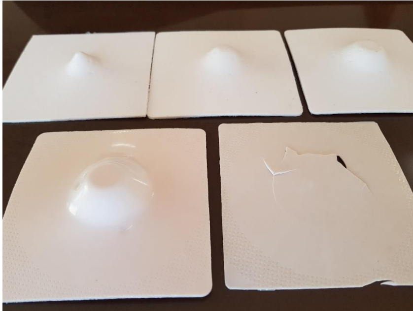
Slika 5.27 Prikaz ploča korištenih u predpokusima – donja strana
