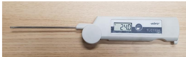
Slika 5.44 Kontaktni mjerač temperature korišten u eksperimentu
