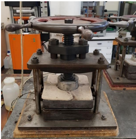
Slika 5.9 Ručna preša s grijačima
