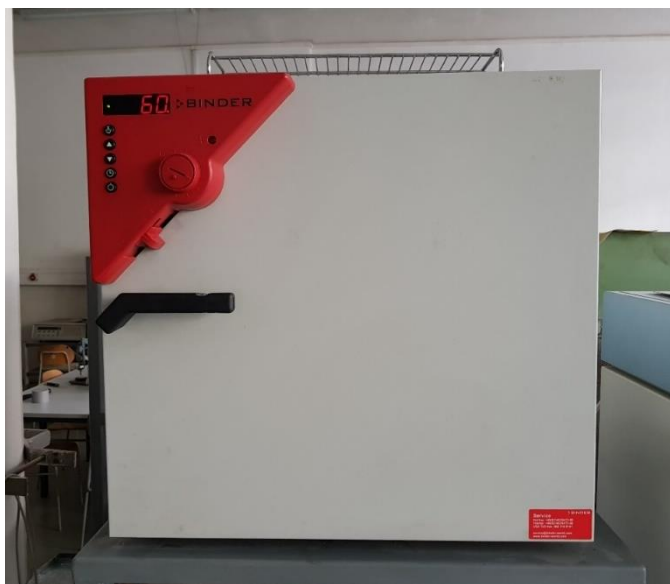
Slika 5.1 Sušenje polimera EOS PA12 2200
