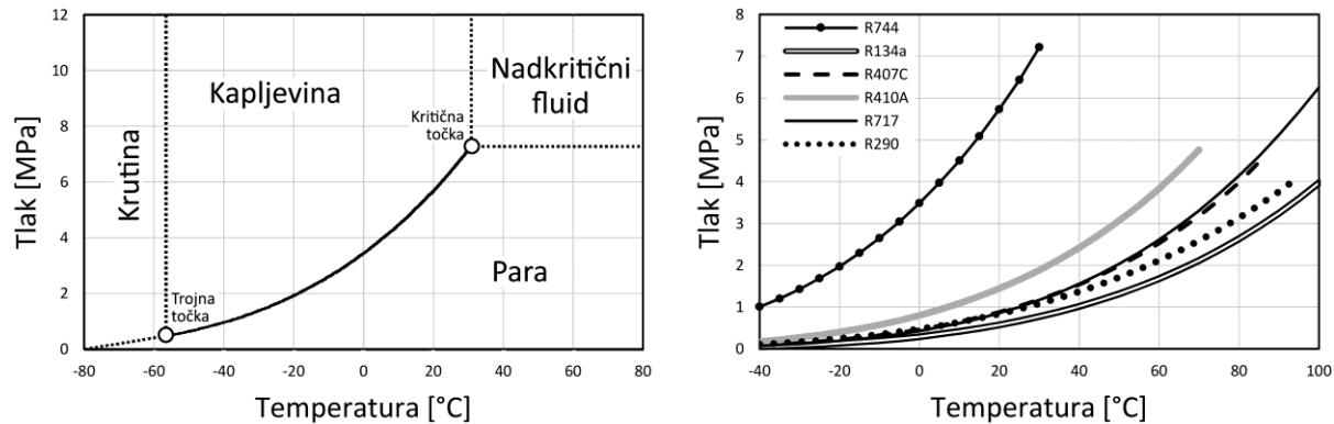
Slika 2.1 Fazni dijagram CO<sub>2</sub> (lijevo) i tlak pare raznih radnih tvari (desno)
