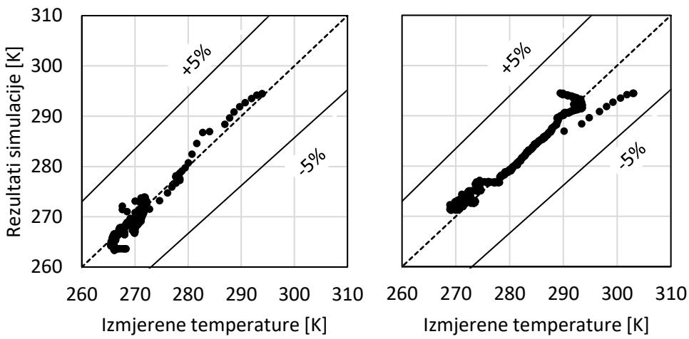
Slika 5.22 Usporedba temperature radne tvari na ulazu (lijevo) i izlazu isparivača (desno), izračunatih numeričkom simulacijom pojednostavljenim modelom cijelokupnog sustava i temperature eksperimentalnih mjerena u prijelaznim uvjetima rada
