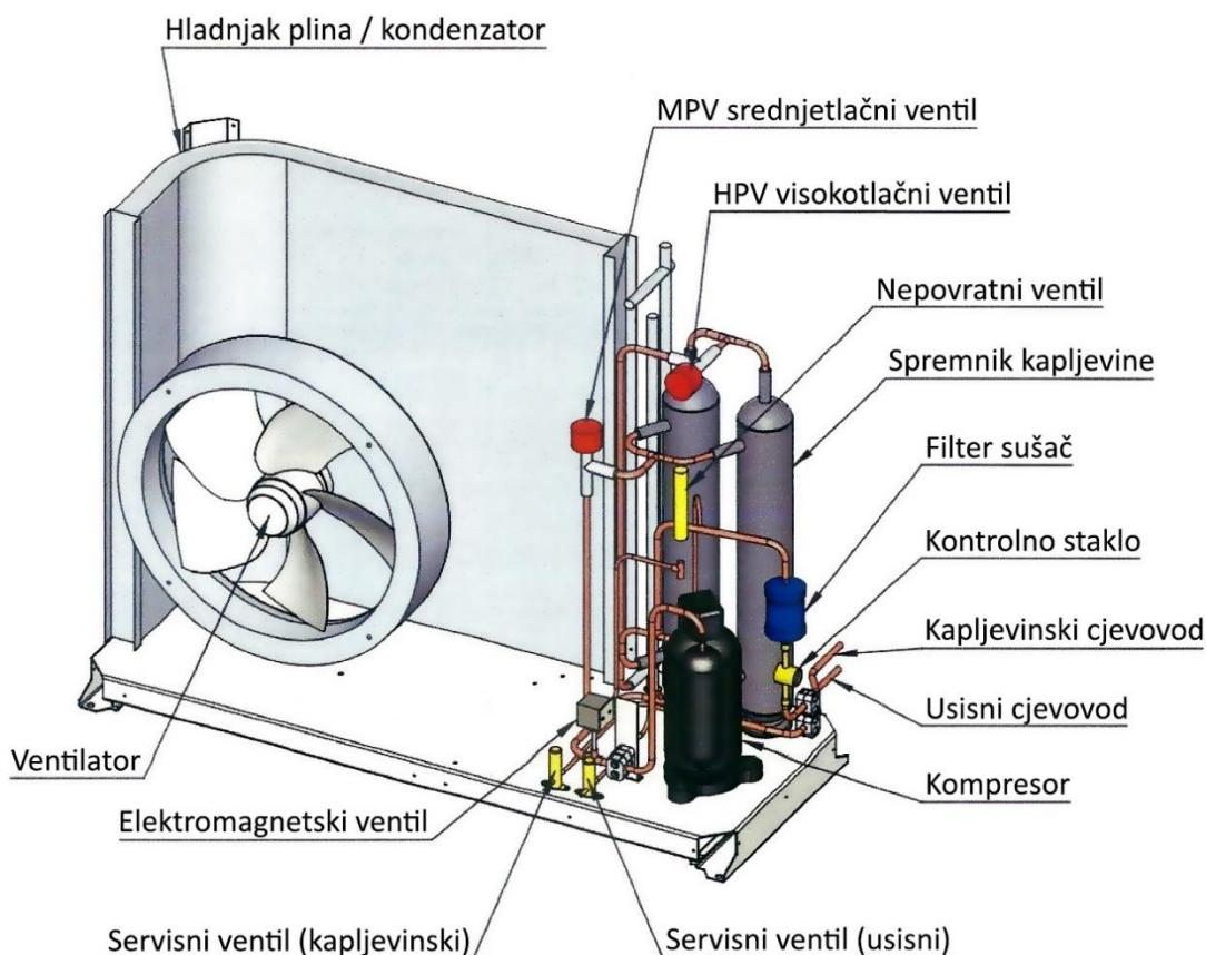
Slika 4.3 Osnovne komponente vanjske jedinice (ArctiCO<sub>2</sub>, 2019)
