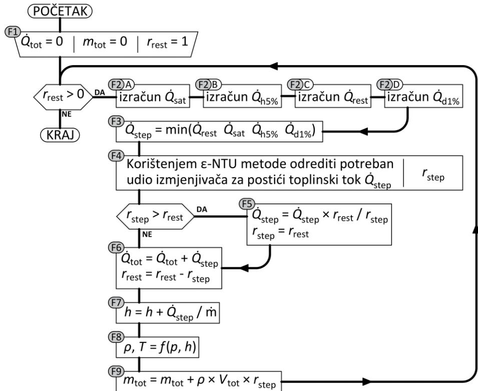
Slika 3.27 Dijagram toka pojednostavljenog modela izmjenjivača topline
