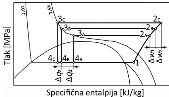
Slika 6.1 Utjecaj temperature CO<sub>2</sub> na izlazu hladnjaka plina na COP sustava
