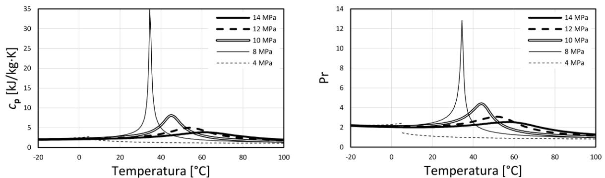
Slika 2.3 Izobarna specifična toplina  $\text{CO}_2$  (lijevo) i Prandtlov broj (desno)
