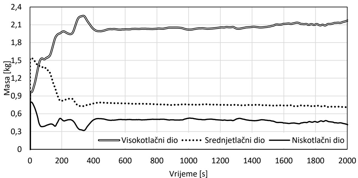
Slika 5.24 Izmještanje mase radne tvari između dijelova rashladnog sustava
