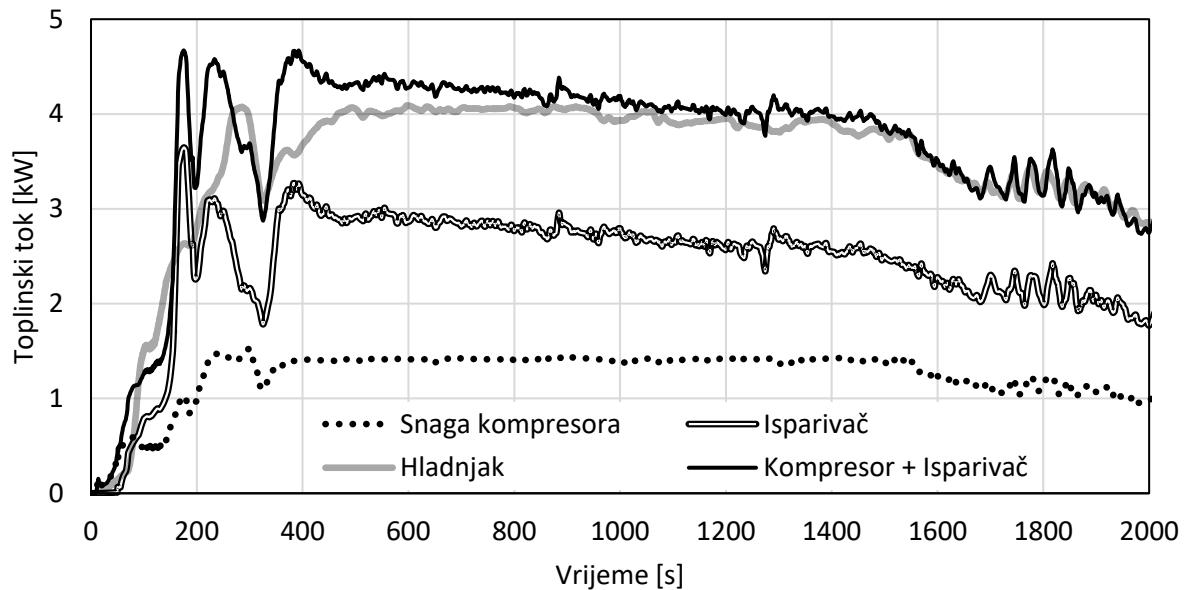
Slika 5.25 Tokovi energije u izmjenjivačima i kompresoru
