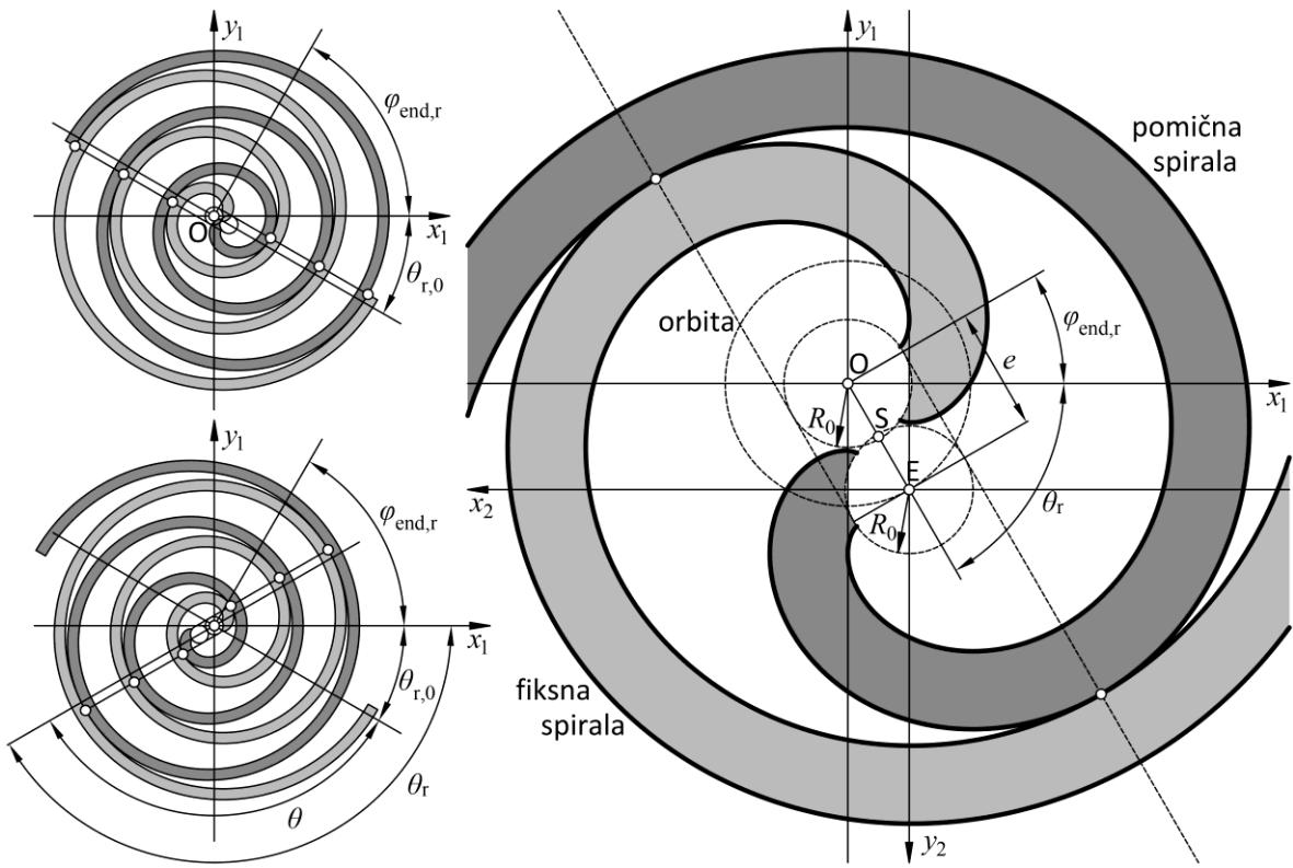
Slika 3.15 Nalaženje dodirnih točki između fiksne spirale (svjetlo siva) i pokretne spirale (tamno siva), pomoću zajedničke tangente baznih kružnica fiksne i pokretne spirale pri proizvolnjem kutu  $\theta_r$ , zakreta pogonskog vratila
