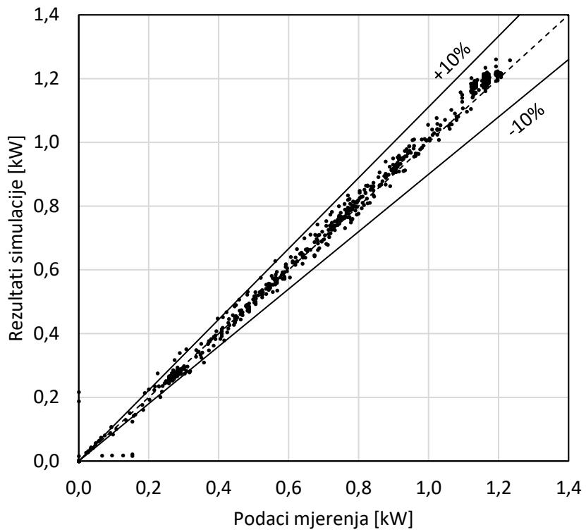
Slika 5.2 Usporedba rezultata numeričkih simulacija i eksperimentalnih mjerena u prijelaznim uvjetima rada kompresora, za električnu snagu
