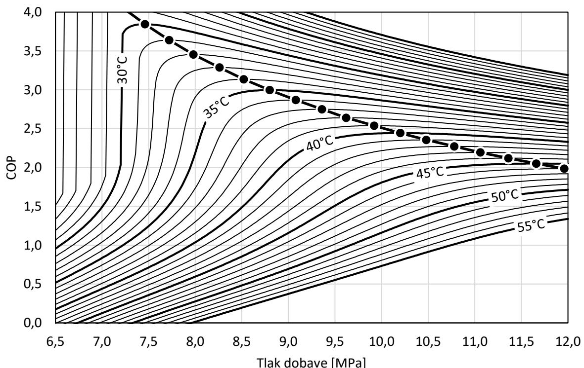
Slika 6.2 Linija optimalnih COP za različite temperature CO<sub>2</sub> na izlazu hladnjaka plina za temperaturu isparivanja -5,5°C
