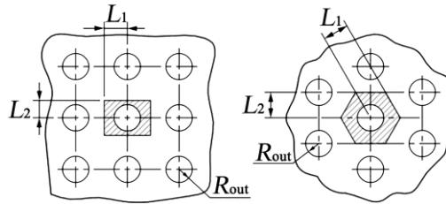
Slika 3.24 Geometrijski detalji za pravokutni (lijevo) i šahovski (desno) raspored cijevi
