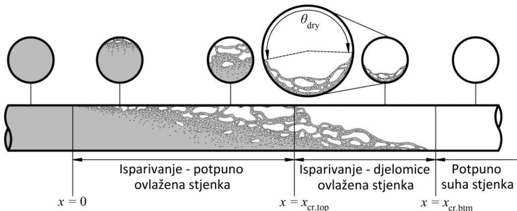
Slika 3.23 Promjene režima strujanja tijekom strujanja s vrenjem  $\text{CO}_2$
