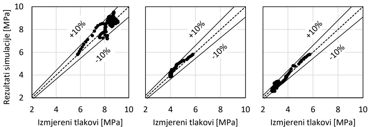
Slika 5.20 Usporedba visokog (lijevo), srednjeg (sredina) i niskog tlaka (desno), izračunatih numeričkom simulacijom pojednostavljenim modelom cijelokupnog sustava i tlakova eksperimentalnih mjerena u prijelaznim uvjetima rada
