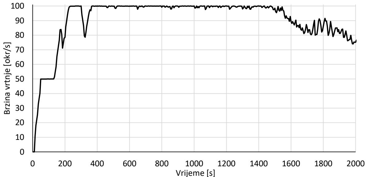
Slika 5.16 Brzina vrtnje pogonskog vratila kompresora tijekom mjerena
