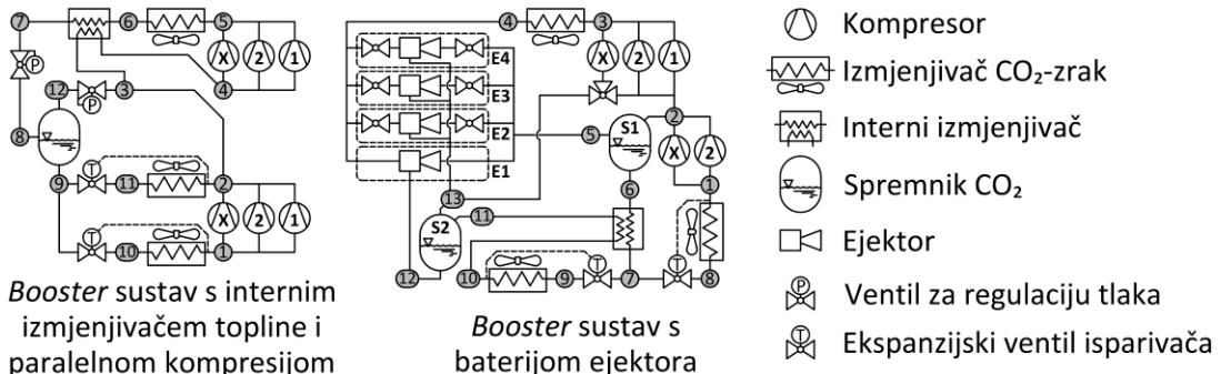
Slika 2.5 Rashladni *booster* sustav paralelnom kompresijom (lijevo) i s baterijom ejektora (desno)
