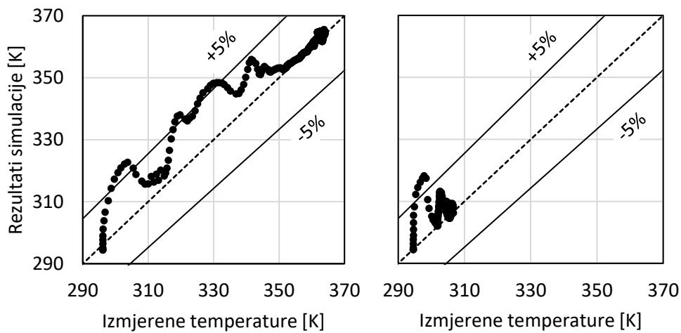
Slika 5.21 Usporedba temperature radne tvari na ulazu (lijevo) i izlazu hladnjaka plina (desno), izračunatih numeričkom simulacijom pojednostavljenim modelom cijelokupnog sustava i temperature eksperimentalnih mjerena u prijelaznim uvjetima rada
