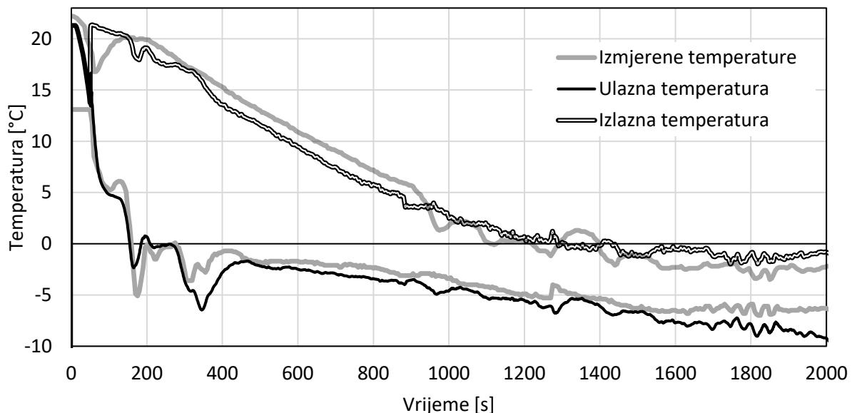
Slika 5.19 Usporedba izračunatih i izmjerena temperatura radne tvari na ulazu i izlazu isparivača
