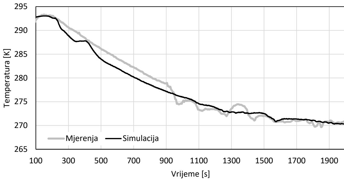
Slika 5.6 Usporedba izlazne temperature isparivača izračunate numeričkom simulacijom detaljnim modelom isparivača i eksperimentalnih mjerena u prijelaznim uvjetima rada
