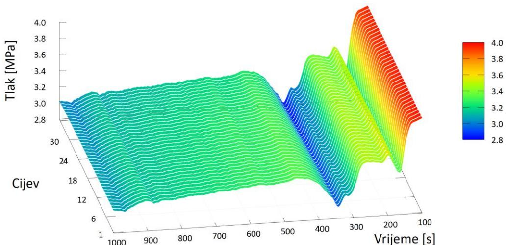
Slika 5.8 Promjena tlaka radne tvari duž isparivača tijekom vremena
