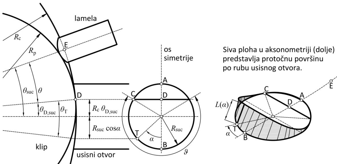
Slika 3.12 Prolaz rotirajućeg klipa preko usisnog otvora
