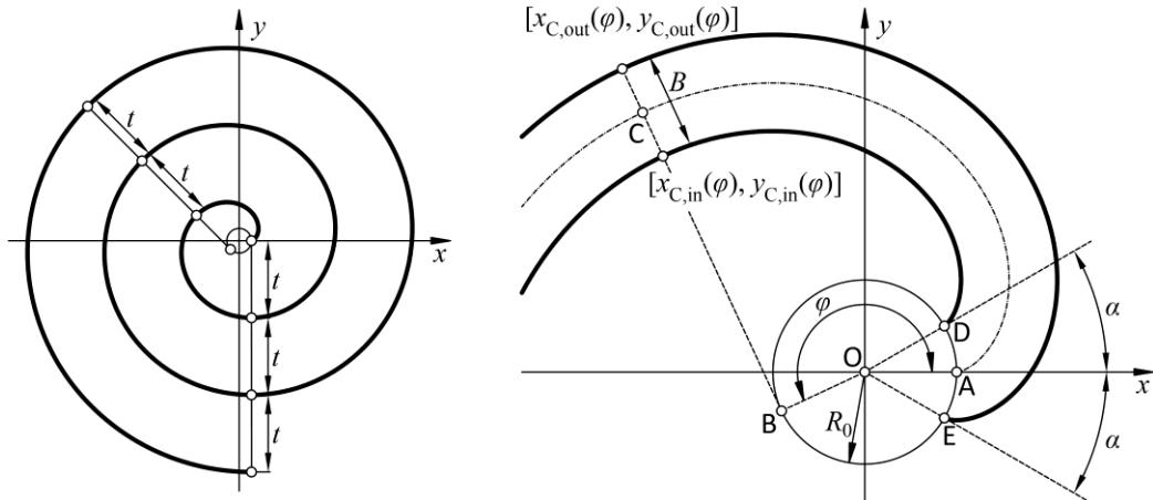
Slika 3.13 Evolventna spirala s  $N = 3$  namotaja (lijevo) i debljina  $B$  namotaja spirale (desno)
