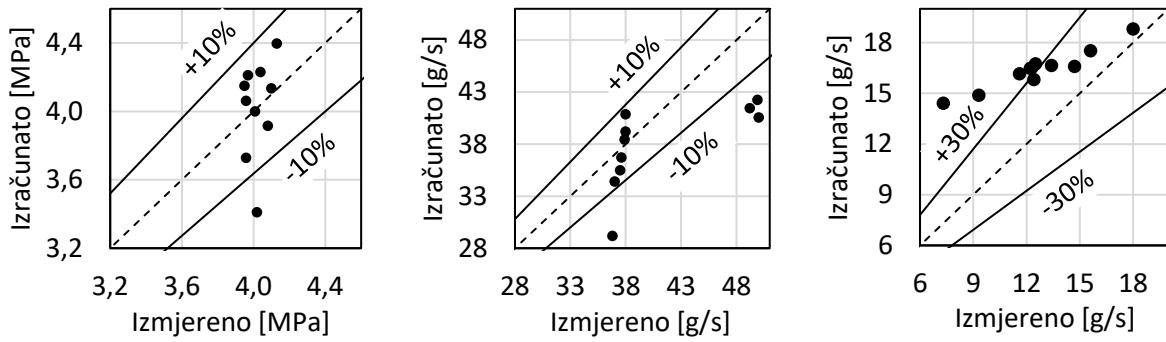
Slika 5.14 Usporedba tlaka radne tvari na izlazu s napinice (lijevo), masenog protoka pogonskog fluida (sredina) i masenog protoka usisanog fluida iz isparivača (desno) izračunatih numeričkom simulacijom ejekتورa i eksperimentalnih mjerena u ustaljenim uvjetima rada ejekتورa
