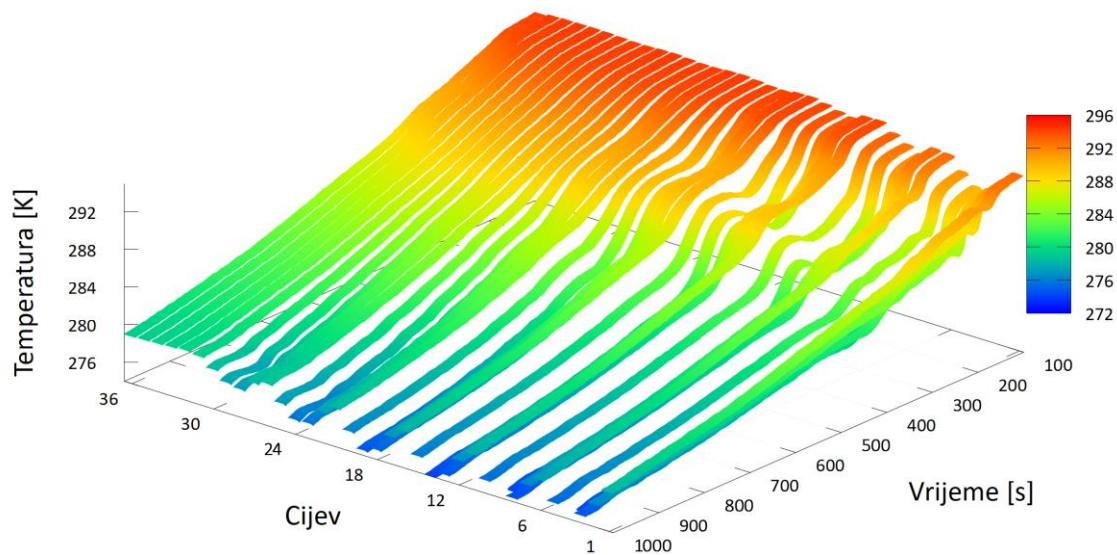
Slika 5.12 Promjena temperature zraka duž isparivača tijekom vremena
