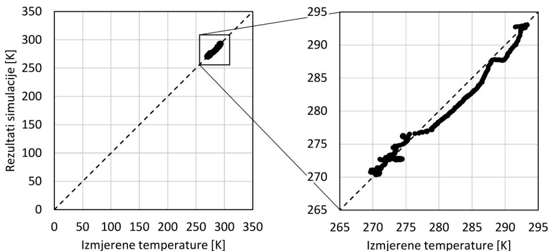
Slika 5.7 Usporedba izlazne temperature isparivača izračunate numeričkom simulacijom detaljnim modelom isparivača i eksperimentalnih mjerena u prijelaznim uvjetima rada
