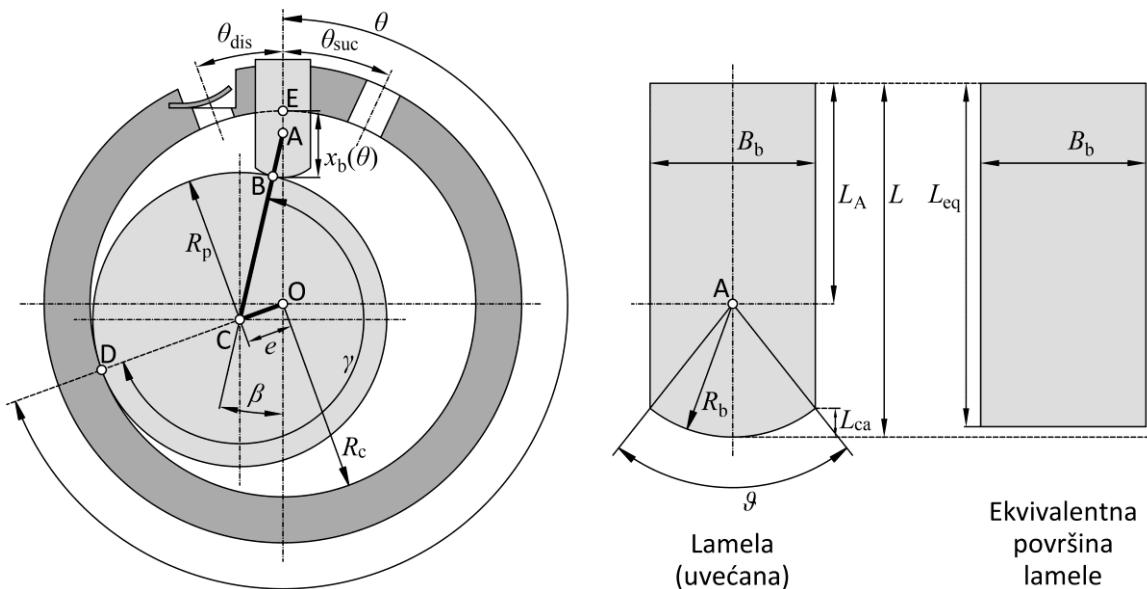
Slika 3.10 Shematski prikaz kompresora s rotirajućim klipom
