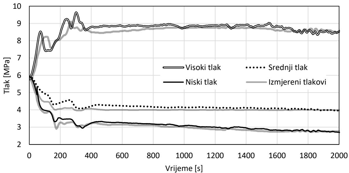
Slika 5.17 Usporedba rezultata numeričkih simulacija i podataka mjerena za tlakove
