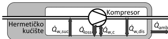
Slika 3.4 Podloga za pojednostavljeni proračun temperature stijenke kompresora
