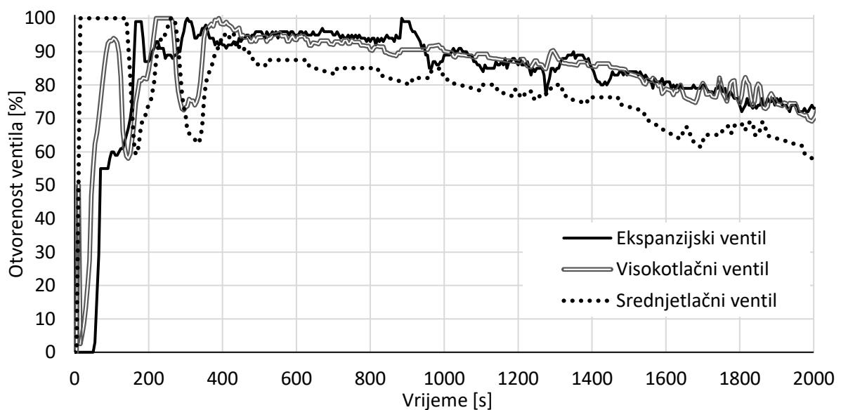
Slika 5.15 Otvorenost ekspanzijskih ventila tijekom mjerena
