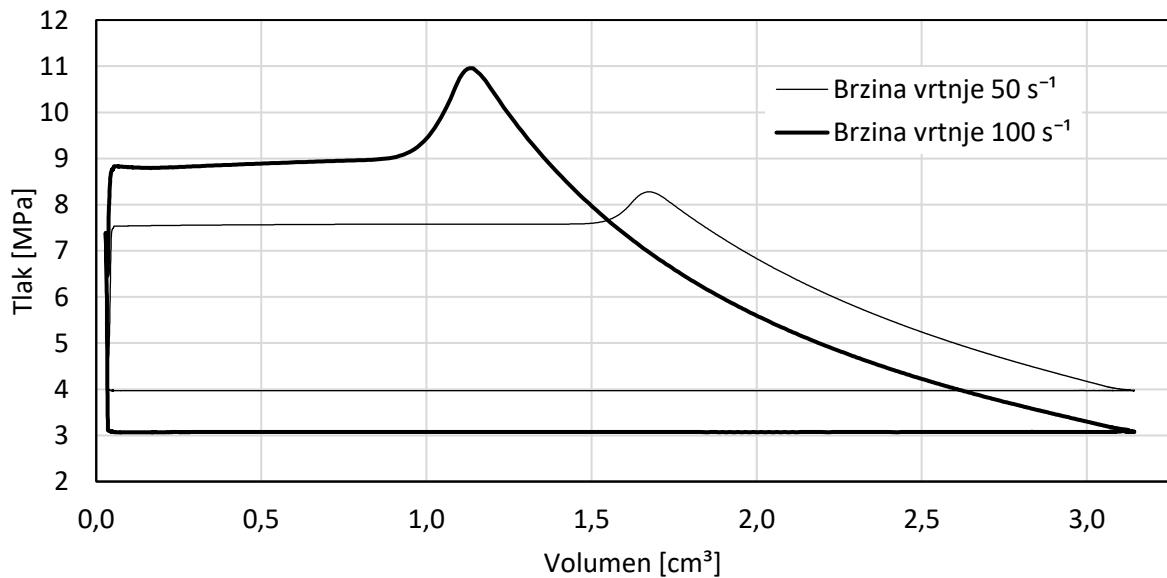
Slika 5.3 Usporedba  $p,V$ -dijagonala za procese kompresora pri brzinama vrtnje od  $50 \text{ s}^{-1}$  i  $100 \text{ s}^{-1}$
