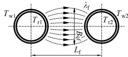
Slika 3.26 Shematski prikaz provođenja topline među susjednim cijevima
