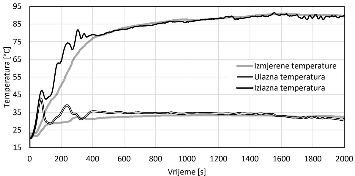
Slika 5.18 Usporedba izračunatih i izmjerena temperatura radne tvari na ulazu i izlazu hladnjaka plina
