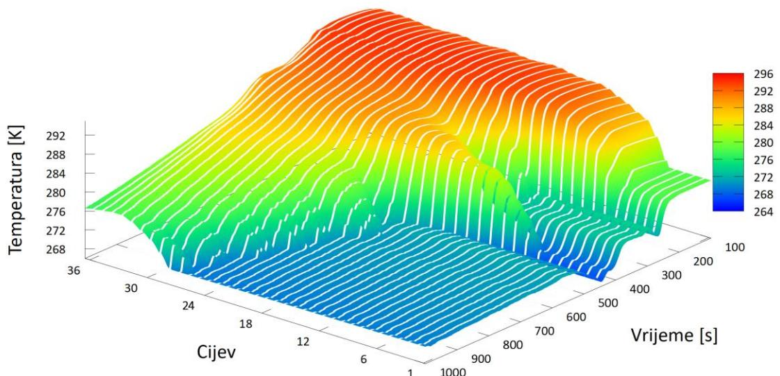
Slika 5.10 Promjena temperature radne tvari duž isparivača tijekom vremena
