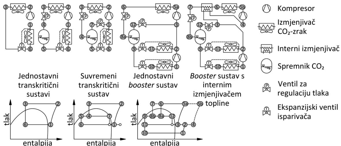
Slika 2.4 Jednostavni (prve dvije sheme slijeva) i suvremeni (treća shema) transkritisni rashladni sustavi s CO<sub>2</sub>, jednostavni *booster* sustav (četvrta shema) i *booster* sustav s unutarnjim izmjenjivačem topline (zadnja shema)
