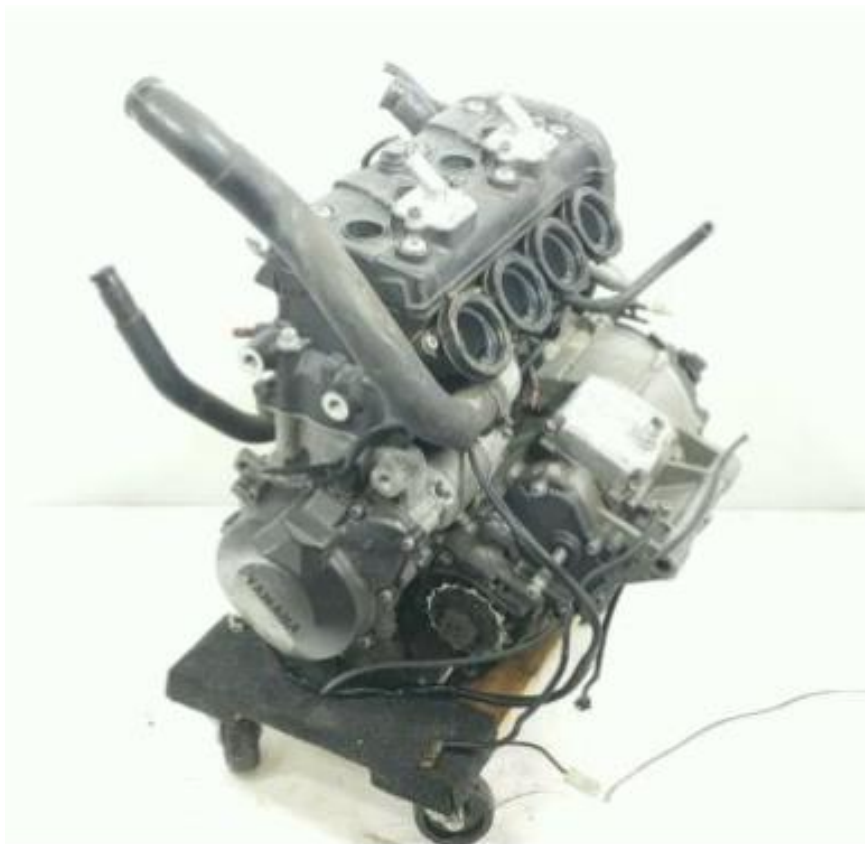
Slika 1.1. Prikaz četverocilindarskog motora Yamaha R6 [1]
