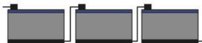
Slika 2. 11. Prikaz mogućeg načina serijskog spajanja solarnih ćelija
