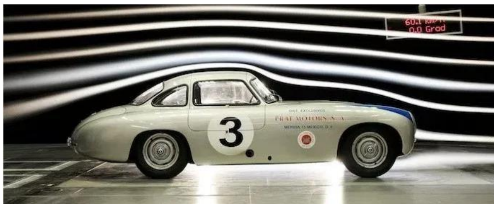
Slika 2.3 Vizualizacija toka fluida oko tijela uz pomoć strujnica [5]
