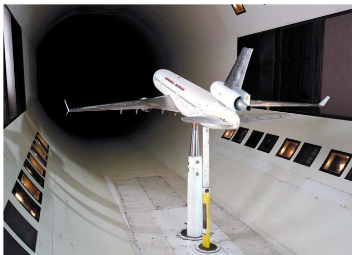
Slika 1.2 Fizička simulacija modela aviona [2]
