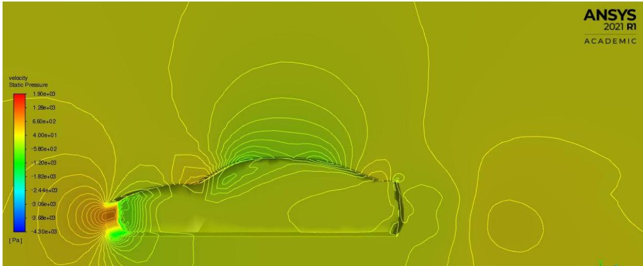
Slika 6.8 Kontura statičkog tlaka za brzinu 35 m/s
