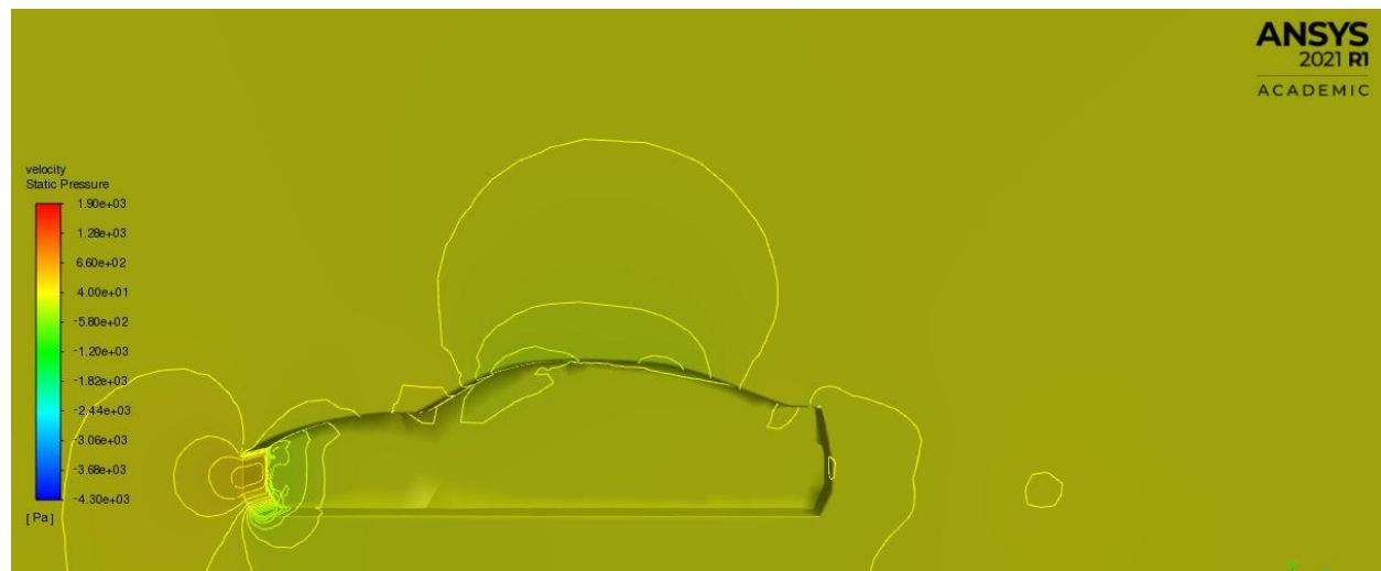
Slika 6.7 Kontura statičkog tlaka za brzinu 20 m/s
