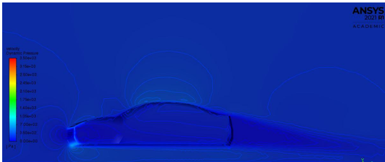
Slika 6.11 Kontura dinamičkog tlaka za brzinu 20 m/s
