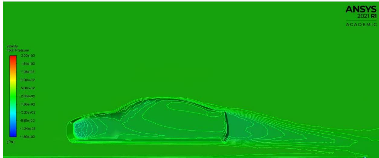
Slika 6.15 Kontura totalnog tlaka za brzinu 20 m/s
