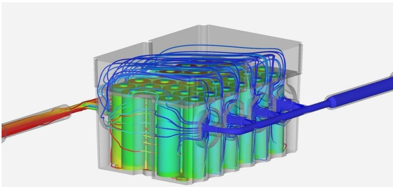
*Slika 3.5: Hlađenje baterija električnog automobila [7]*
