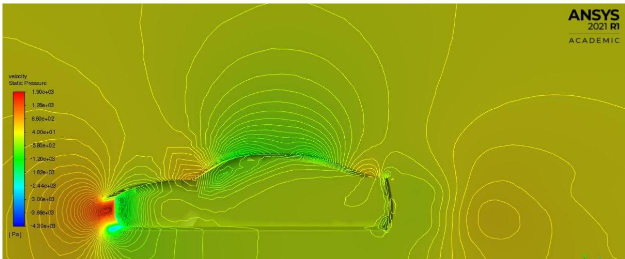
Slika 6.9 Kontura statičkog tlaka za brzinu 50 m/s
