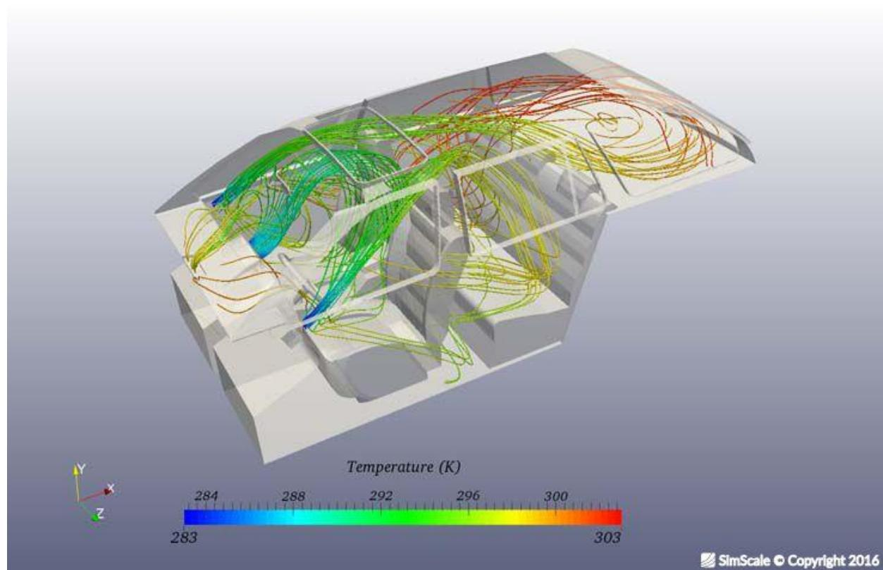
Slika 3.3: Strujanje zraka u kabini automobila [5]
