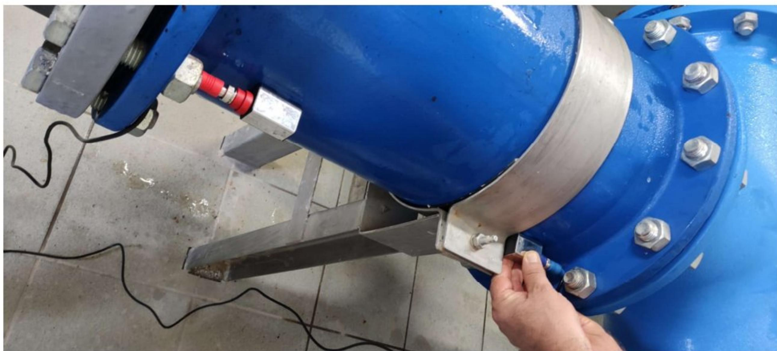
Slika 11: Postavljanje sondi na određenu udaljenost na cijev
