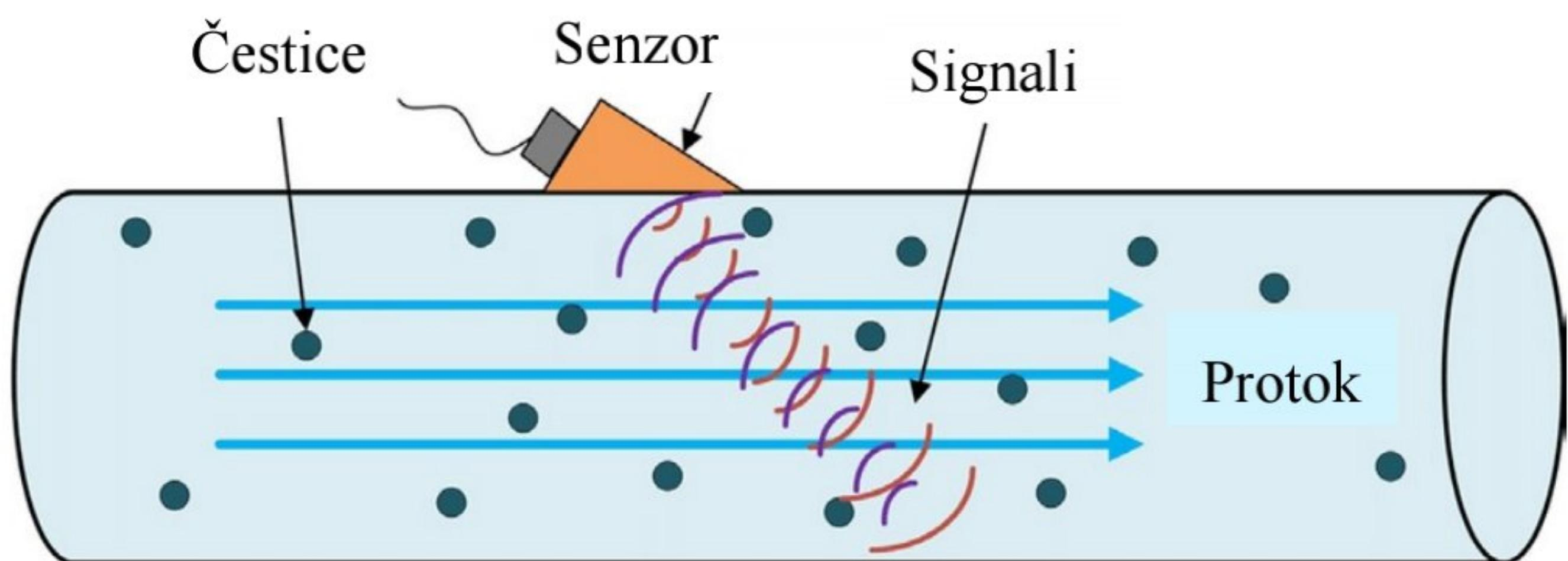
Slika 5: Ultrazvučni mjerač protoka baziran na Dopplerovom efektu [4]
