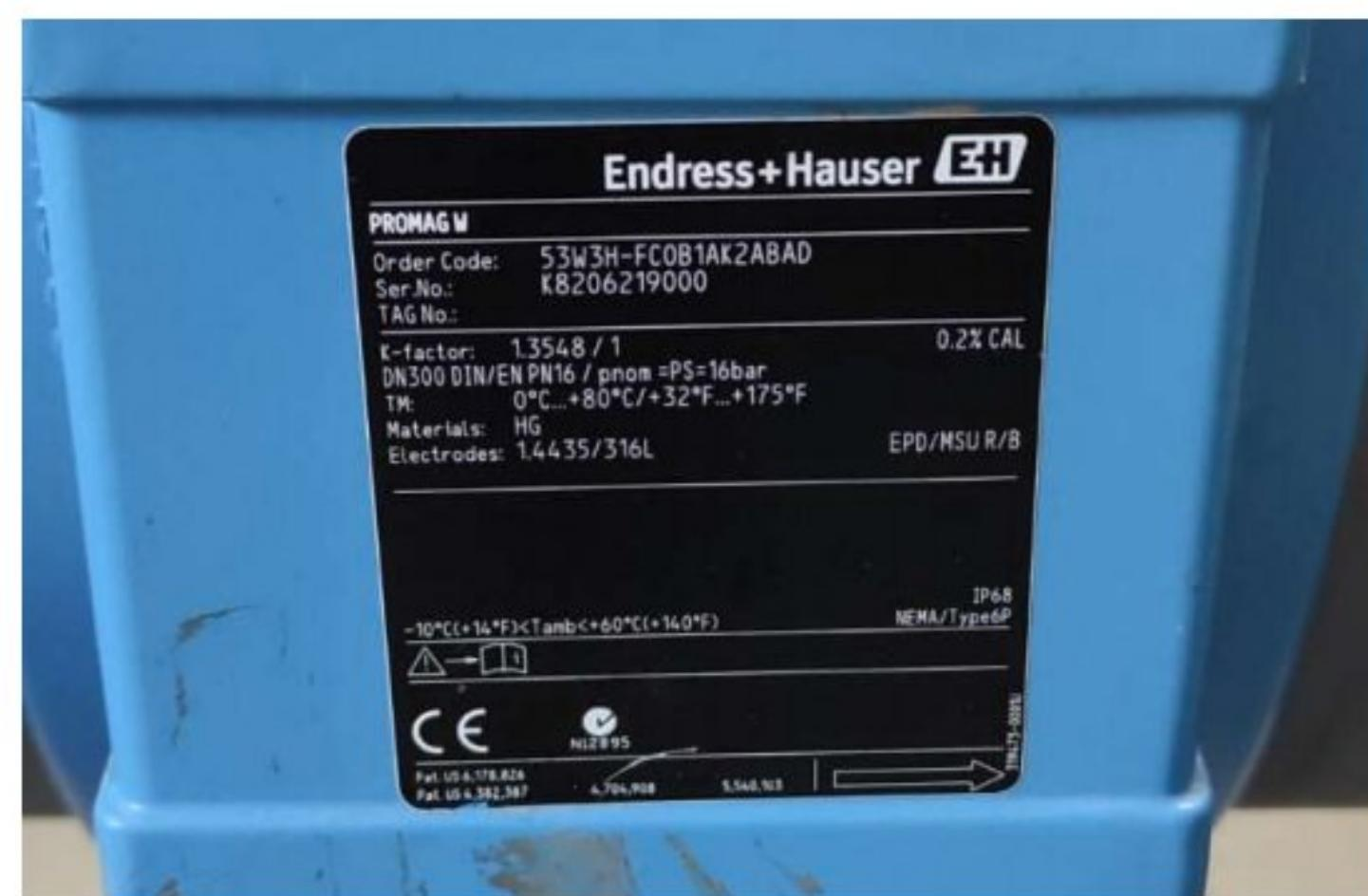
Slika 2: Podaci elektromagnetskog mjerača protoka Endress+Hauser
