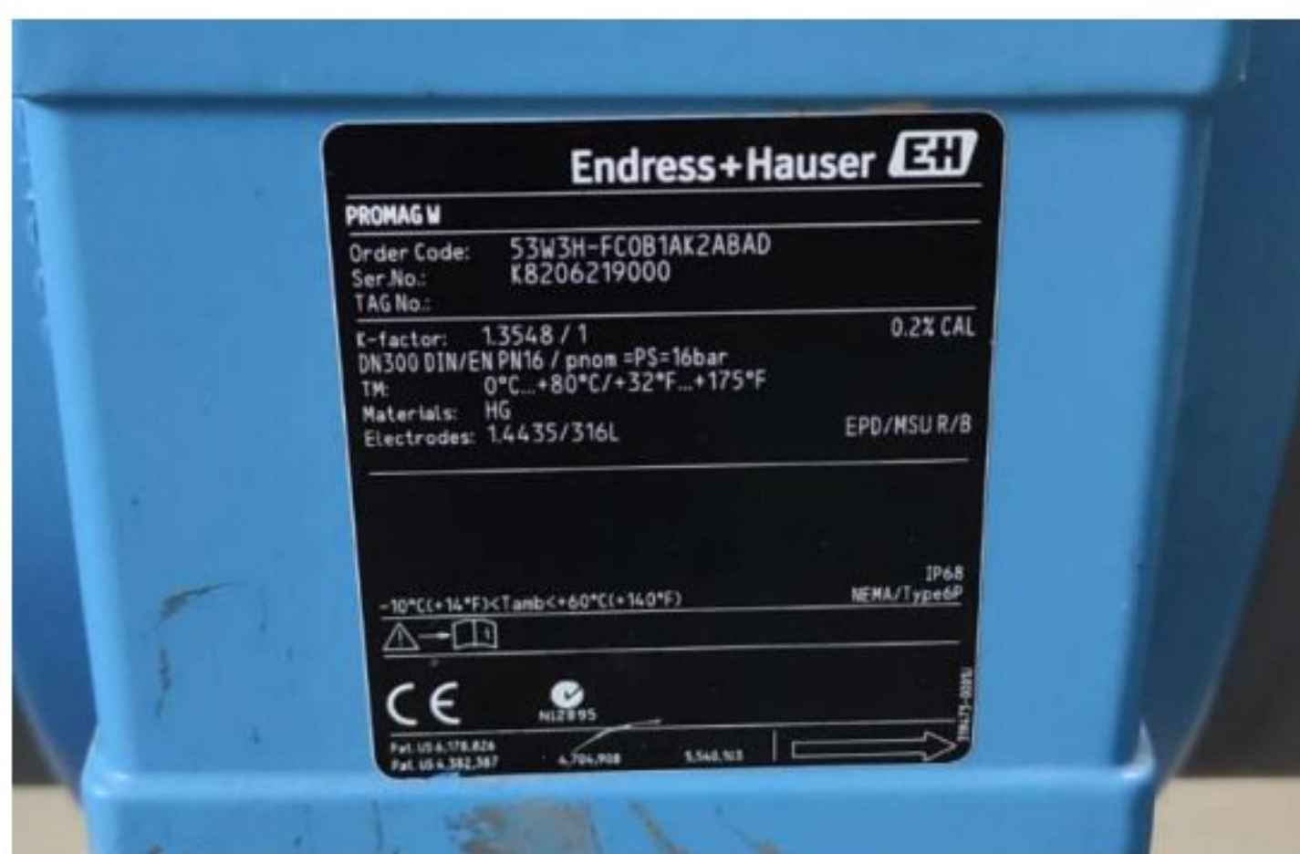
Slika 2: Podaci elektromagnetskog mjeraca protoka Endress+Hauser
