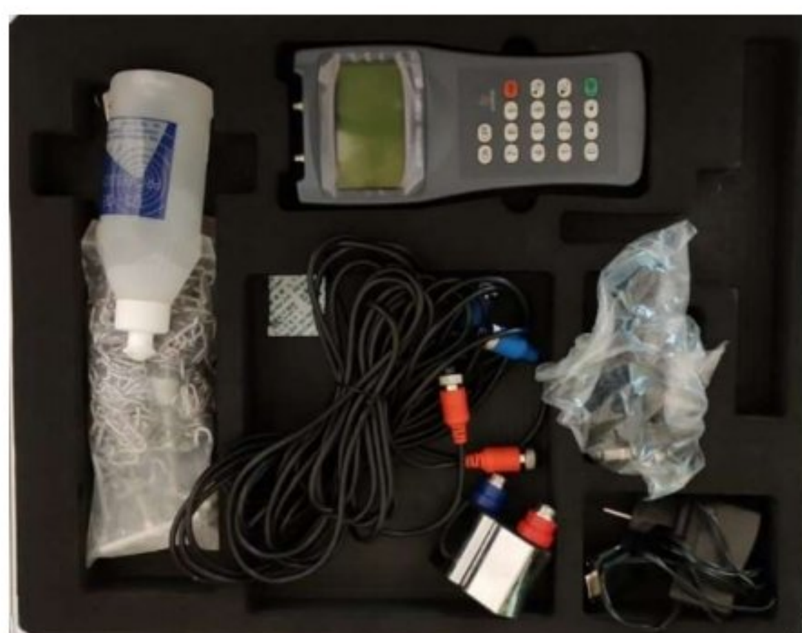
Slika 10: Ultrazvučni mjerač FDT-21
