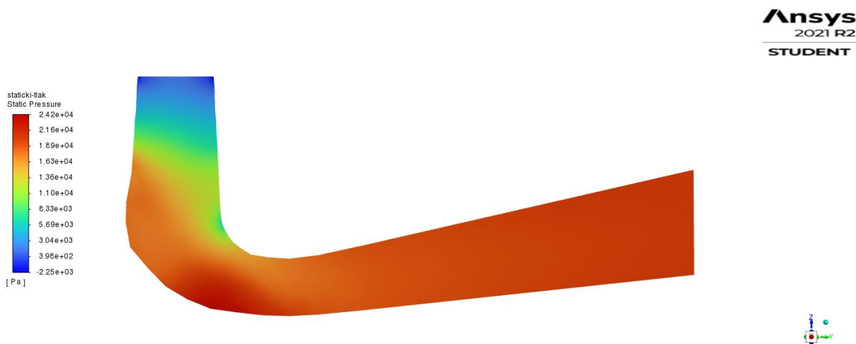
Slika 5.11. Konture statičkog tlaka u YZ ravnini
