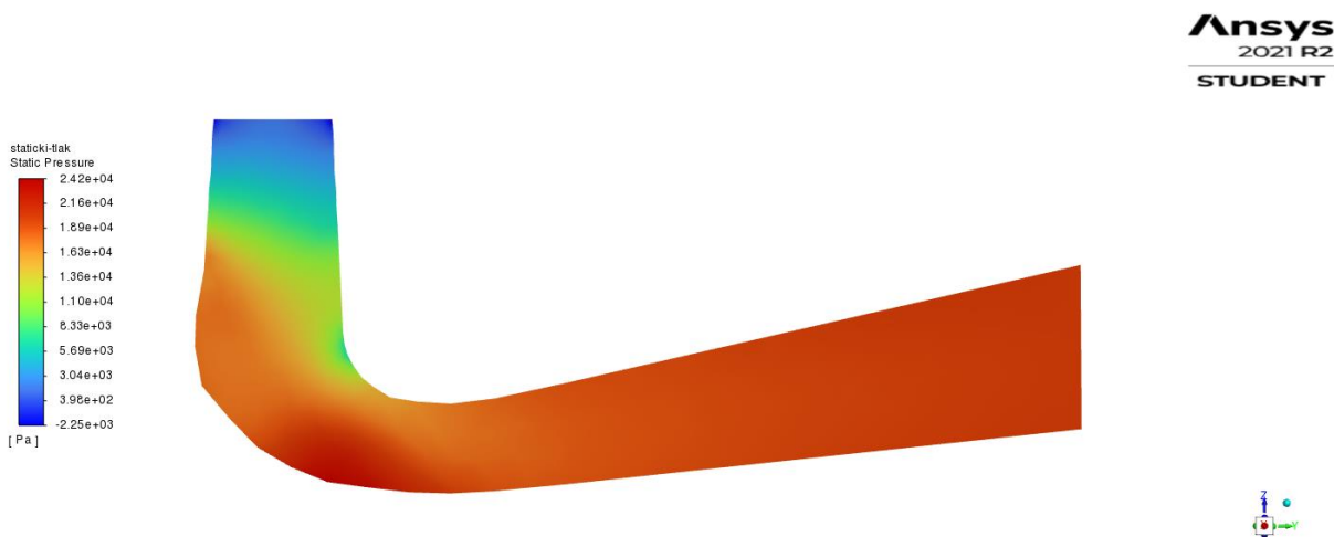
Slika 5.11. Konture statičkog tlaka u YZ ravnini
