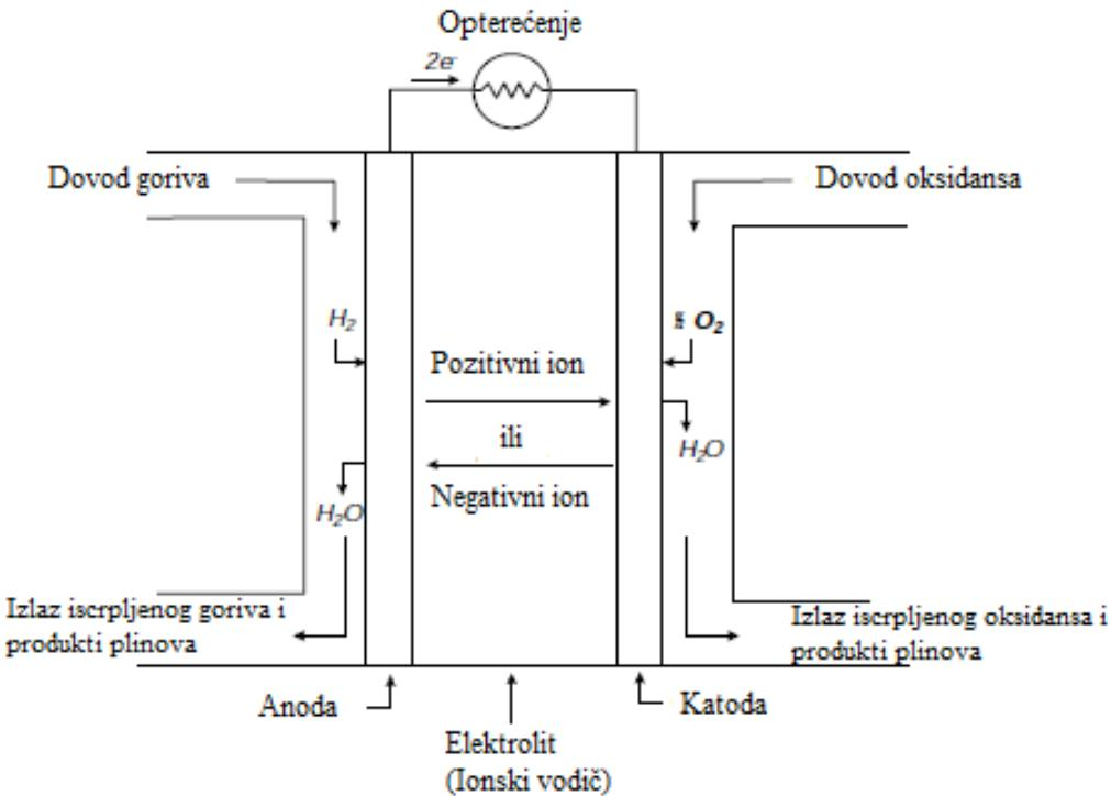
Slika 5.4. Shematski prikaz jednog gorivnog članka [110]
