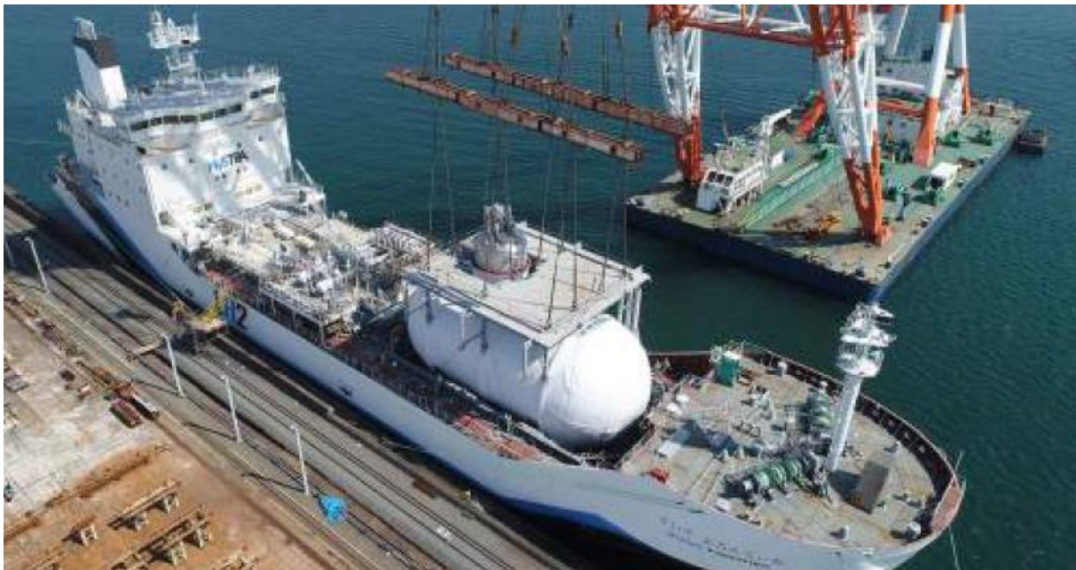
Slika 4.9. Brod za prijevoz tekućeg vodika „Suiso Frontier“ [96]
