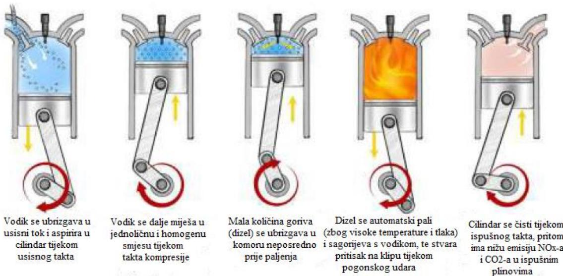
Slika 6.4. Princip rada motora na vodik [163]
