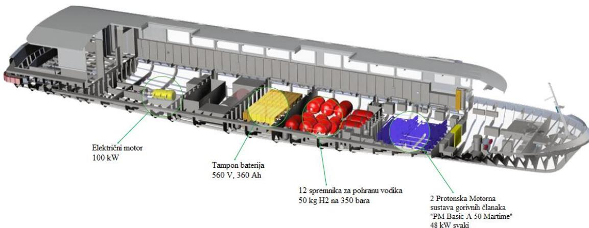
Slika 4.3. Prikaz sustava propulzije „FCS Alsterwasser“ broda [60]
