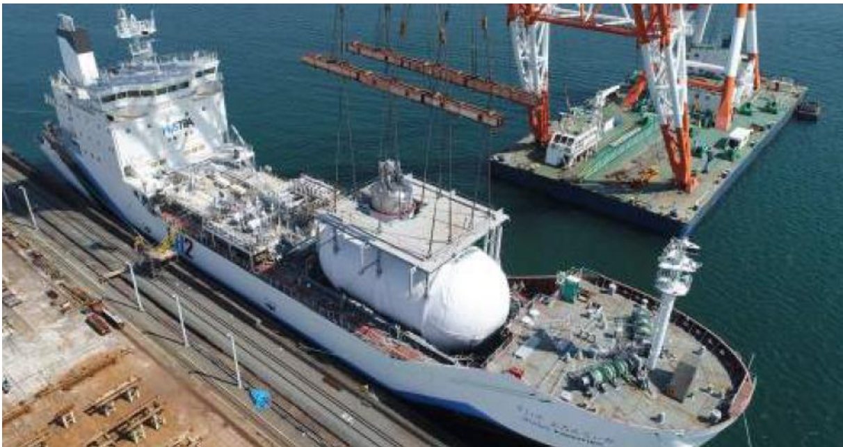
Slika 4.9. Brod za prijevoz tekućeg vodika „Suiso Frontier“ [96]
