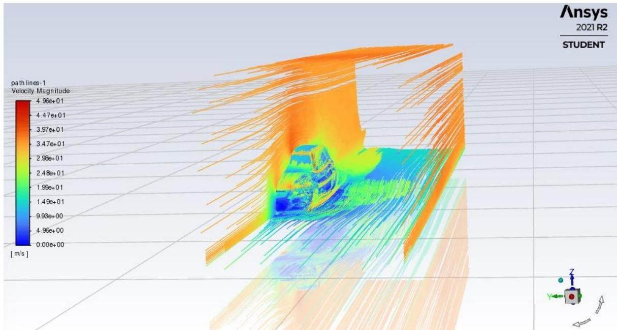
Slika 5.4. Putanje vektora brzina zraka ispred automobila
