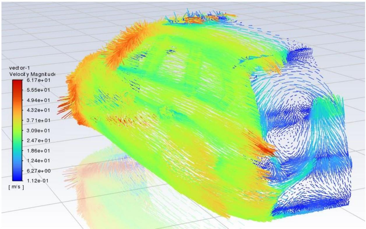
Slika 8.9. Turbulencija iza automobila prikazana vektorima brzine
