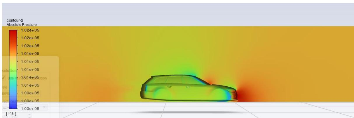
Slika 5.1. Konture apsolutnog tlaka zraka na presječnoj ravnini
