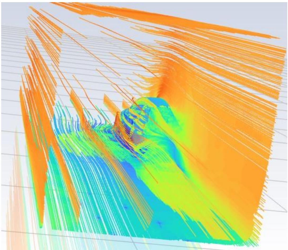
Slika 5.5. Putanje vektora brzina zraka iza automobila
