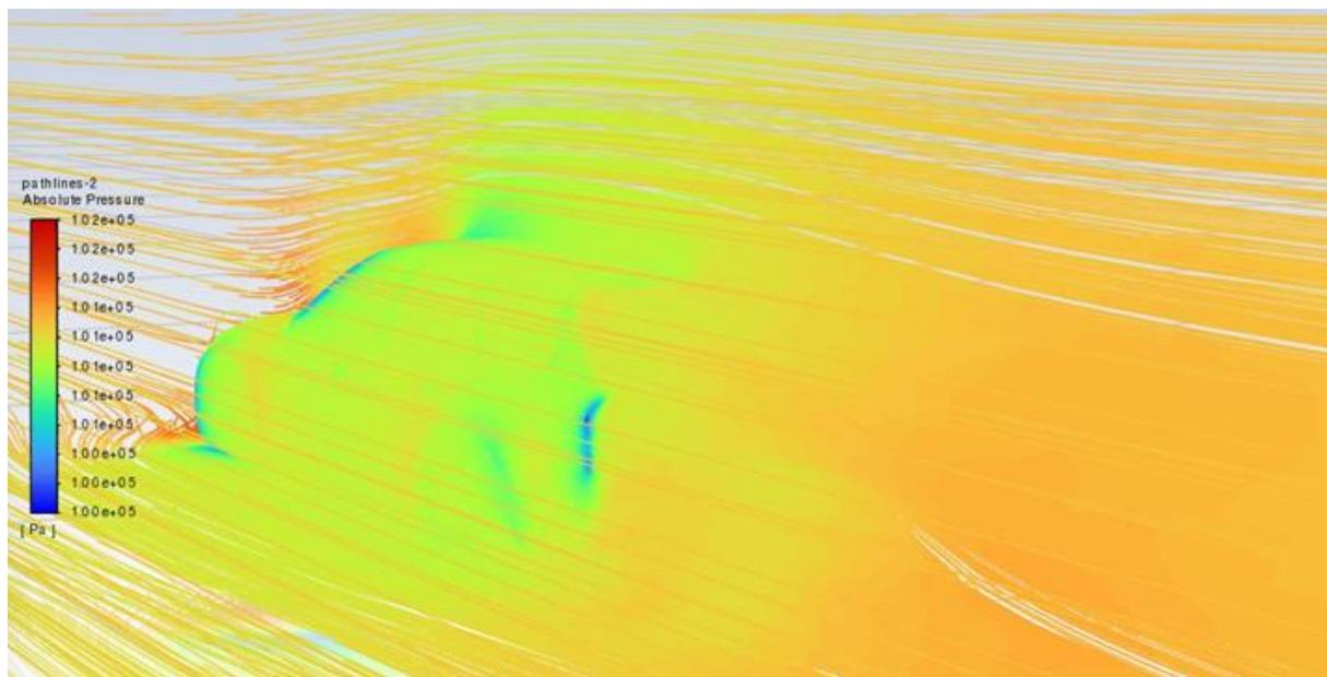
Slika 5.3. Strujnice apsolutnog tlaka sa zadnje strane automobila
