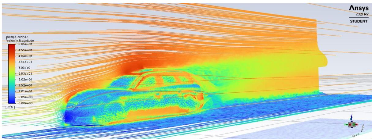
Slika 8.7. Putanje brzina zraka s otvorenim krovnim prozorom
