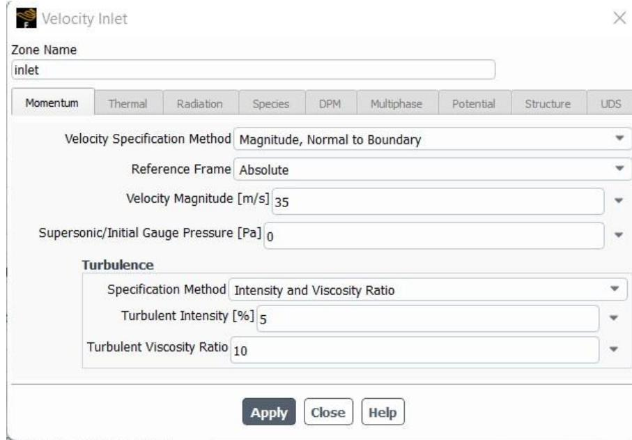
Slika 4.6. Primjer rubnih uvjeta na ulazu u tunel
