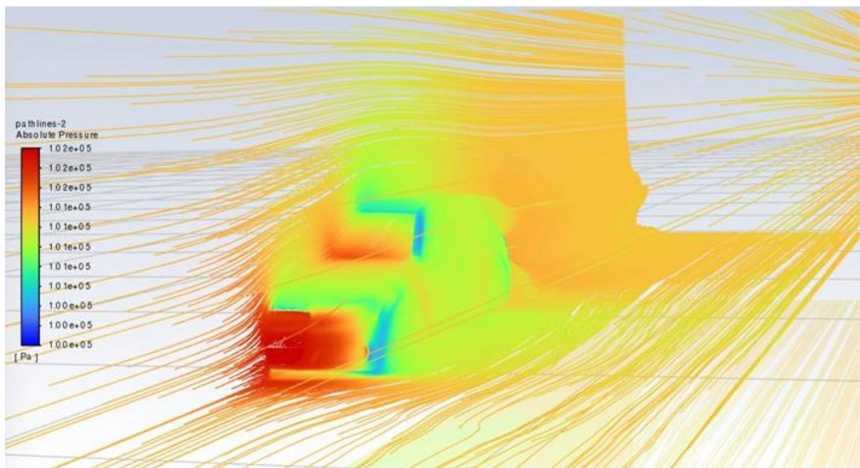
Slika 5.2. Strujnice apsolutnog tlaka.s prednje strane automobila
