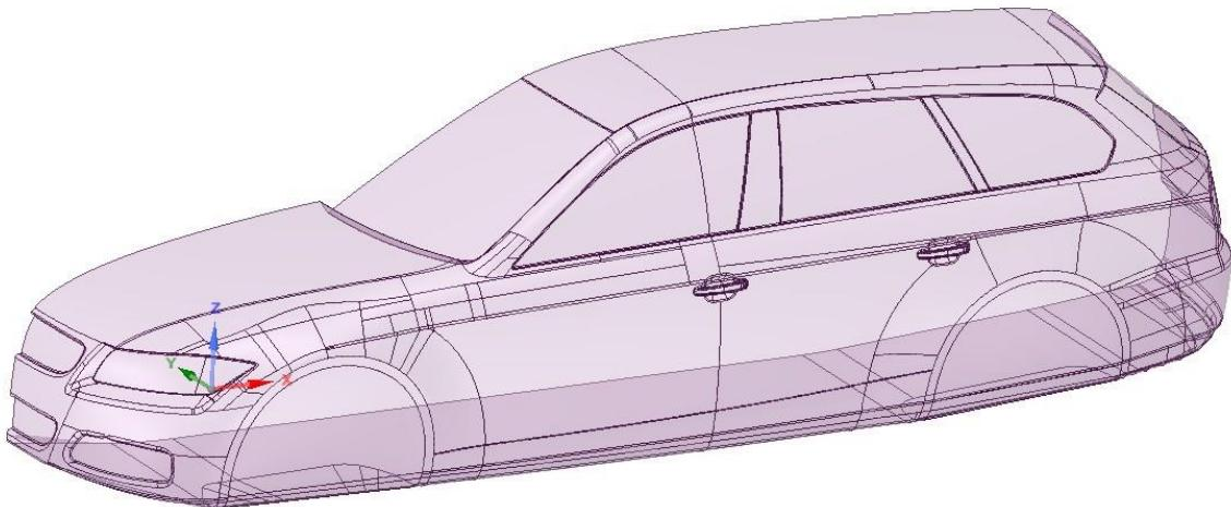
Slika 4.2. Pojednostavljenja geometrije automobila
