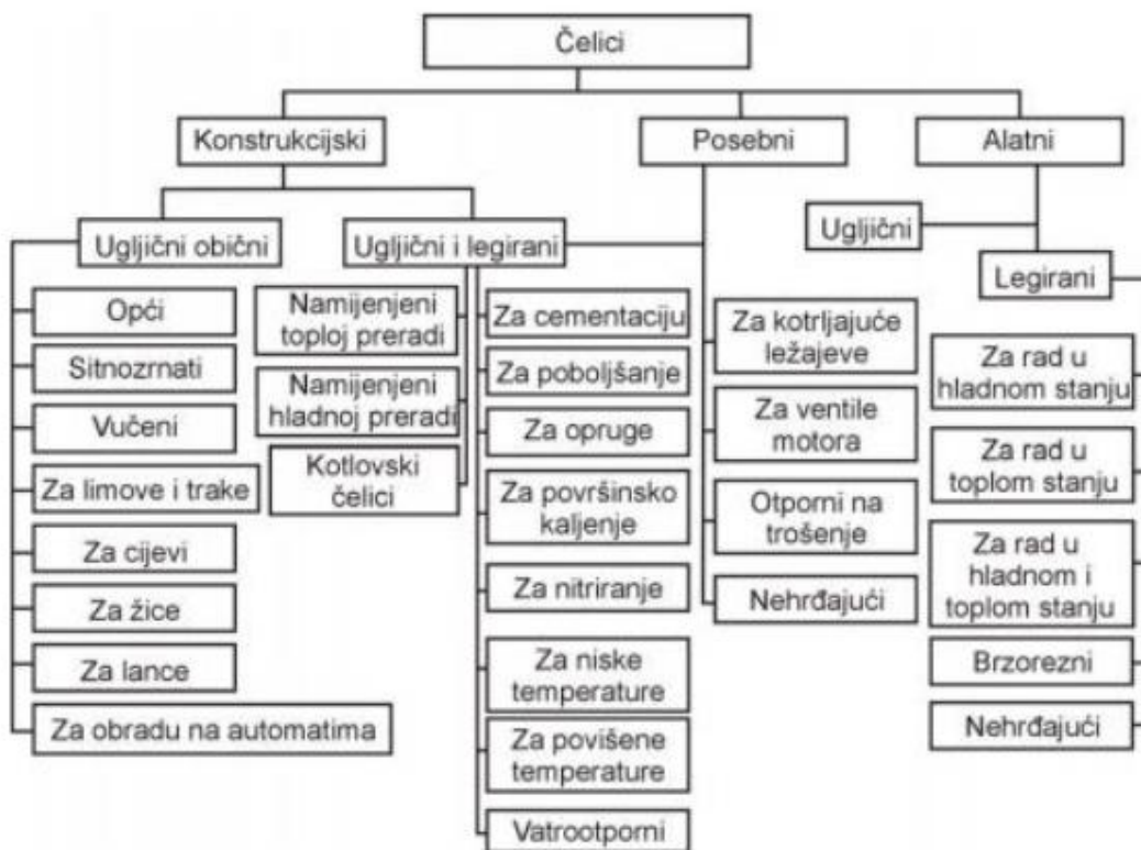
Slika 1. Opća klasifikacija čelika [1]
