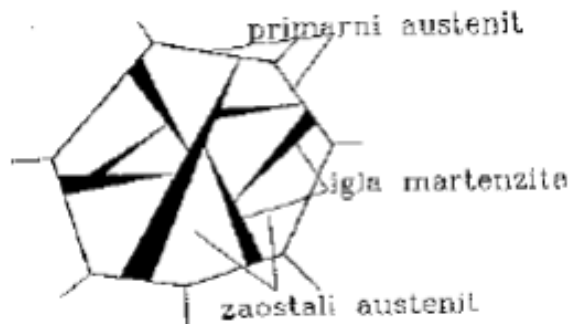
Slika 24. Igličasta mikrostruktura martenzita [3]
