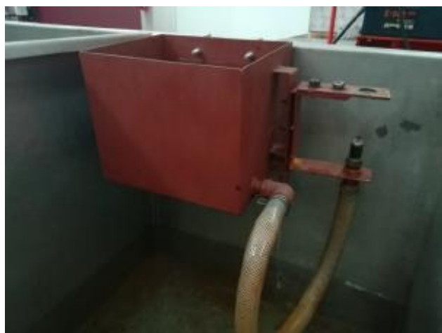
Slika 49. Naprava za Jominyjev pokus
