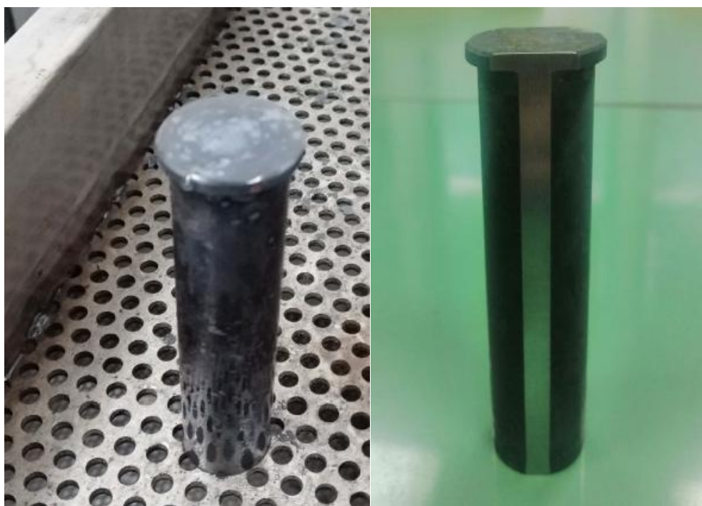
Slika 52. a) Jominyjev uzorak nakon kaljenja; b) Kaljeni Jominyjev uzorak nakon brušenja
