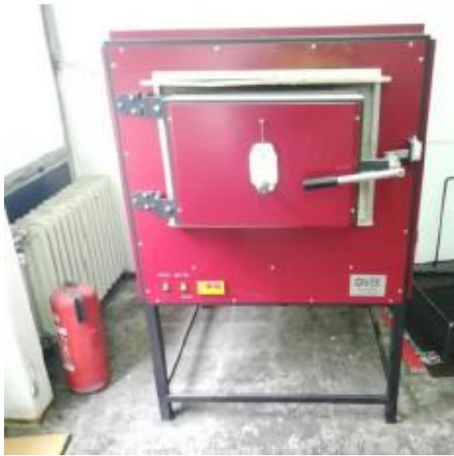
Slika 47. Peć za kaljenje
