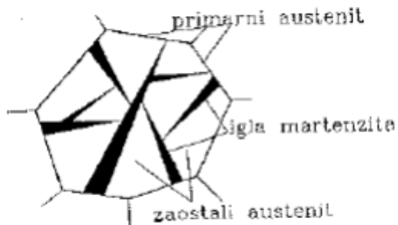
Slika 24. Igličasta mikrostruktura martenzita [3]
