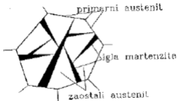
Slika 24. Igličasta mikrostruktura martenzita [3]
