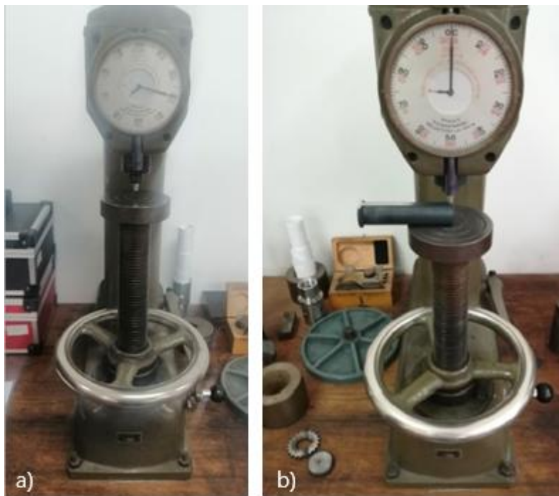
Slika 53. a) Tvrdomjer za ispitivanje tvrdoće Rockwellovom metodom; b) Početna pozicija ispitivanja tvrdoće uzorka
