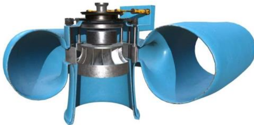
Slika 3.9. Presjek Francis turbine [12]
