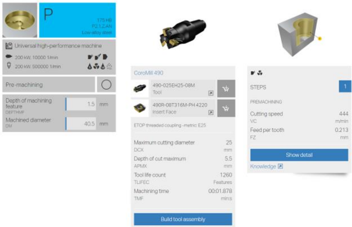
Slika 4.26 Izbor alata i režimi obrade - operacija 20, zahvat 4
