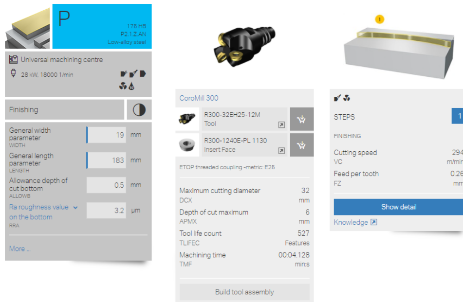
Slika 4.18 Izbor alata i režimi obrade - operacija 10, zahvat 11
