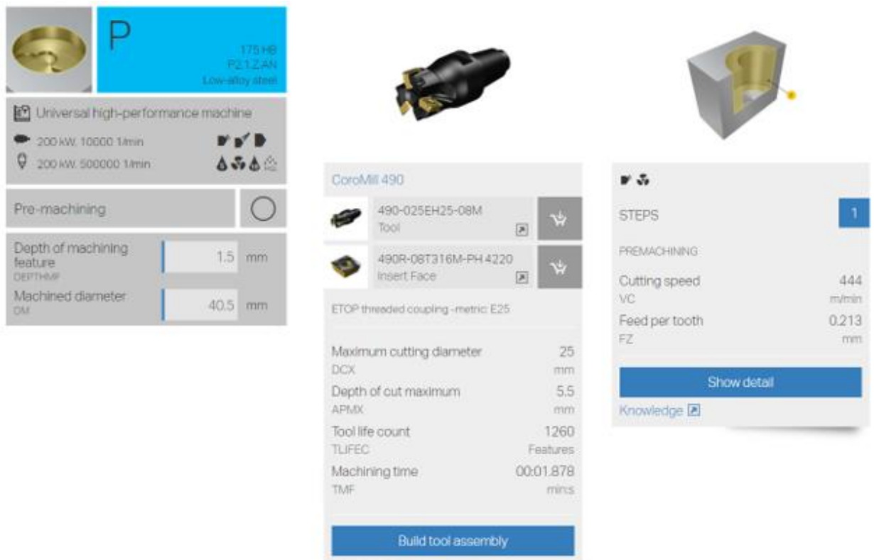
Slika 4.26 Izbor alata i režimi obrade - operacija 20, zahvat 4
