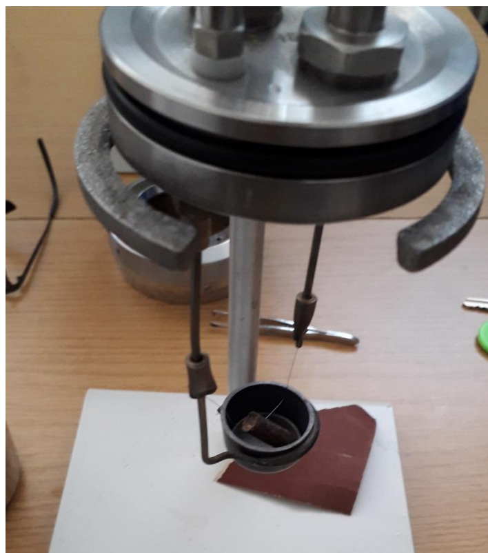
Slika 7.14 Priprema peleta za određivanje ogrjevnice moći
