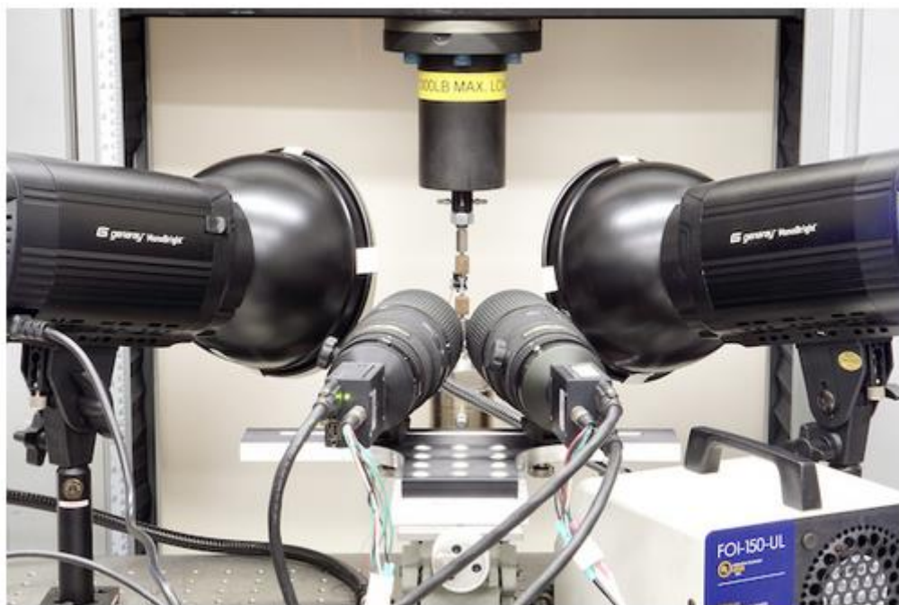
Slika 7.16: Pravilno postavljeni sustav za snimanje slike [16]
