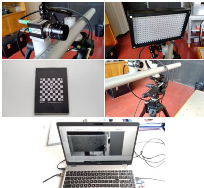
Slika 8.7: Elementi sustava za primjenu metode korelacije digitalne slike
