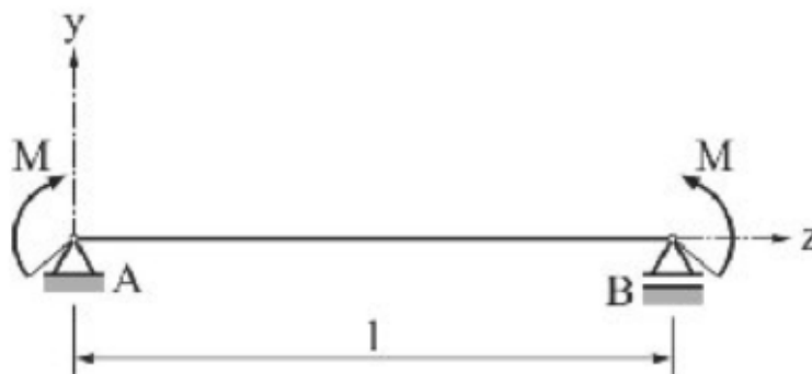
Slika 2.8: Nosač opterećen na ravno čisto savijanje [6]
