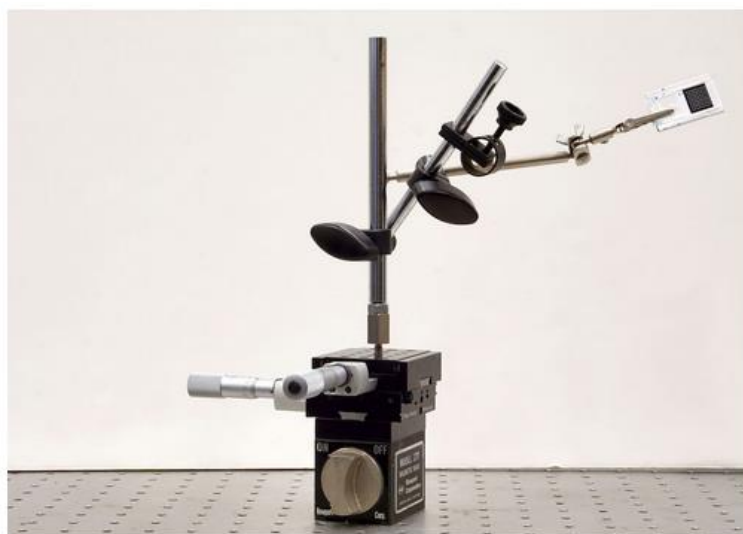
Slika 7.18: Postolje za pridržavanje kalibracijske mreže [16]
