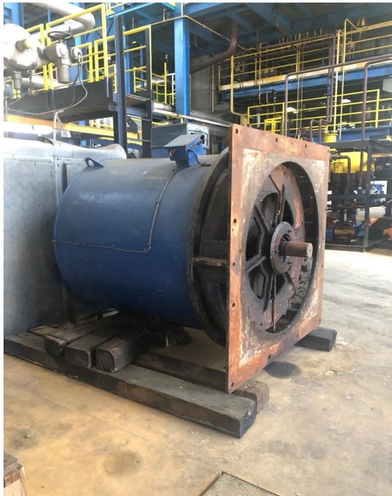
Slika 4.7. Stari elektromotor pumpe morske vode s vertikalnom osovinom i pogonom dolje
