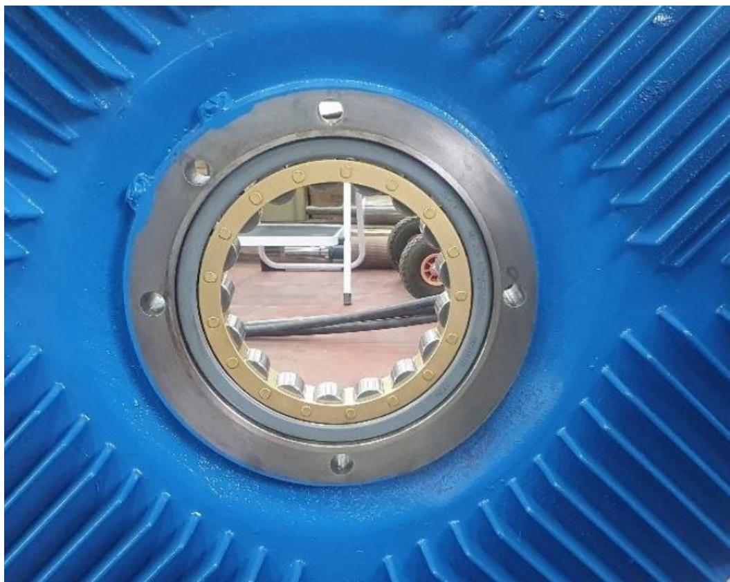
Slika 7.4. Montaža novog ležaja s keramičkom oblogom
