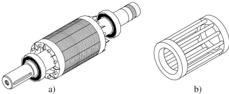
*Slika 4.3. Kavezni rotor asinkronog motora- a) rotor b) kavez [5]*
