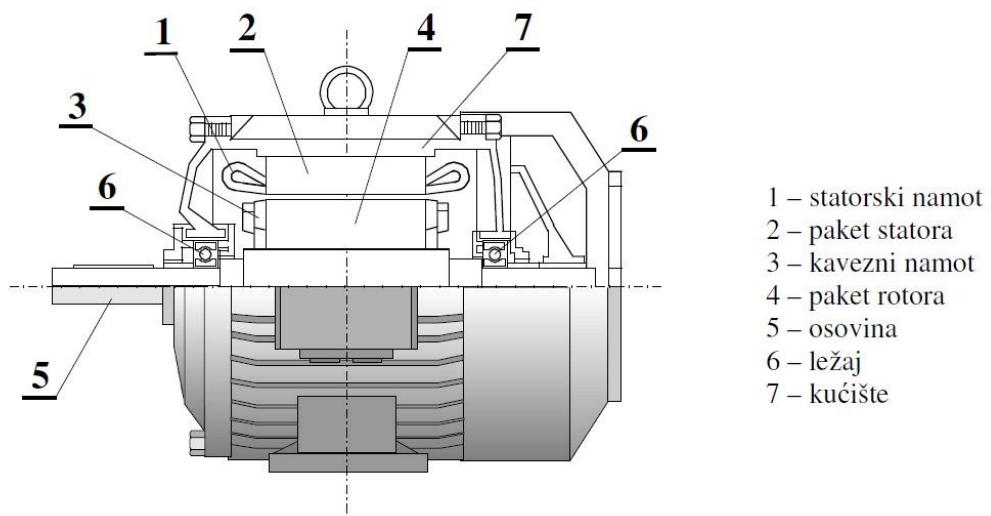
Slika 4.1. Uzdužni presjek gornjeg dijela asinkronog kaveznog motora [5]
