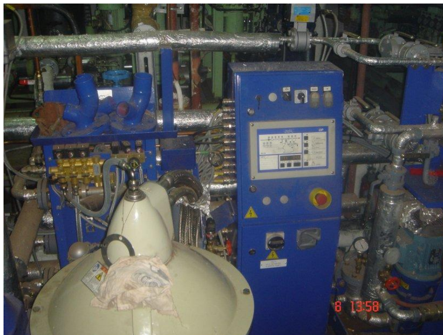
Slika 4.4 Modul separatora goriva u prostoriji separatora
