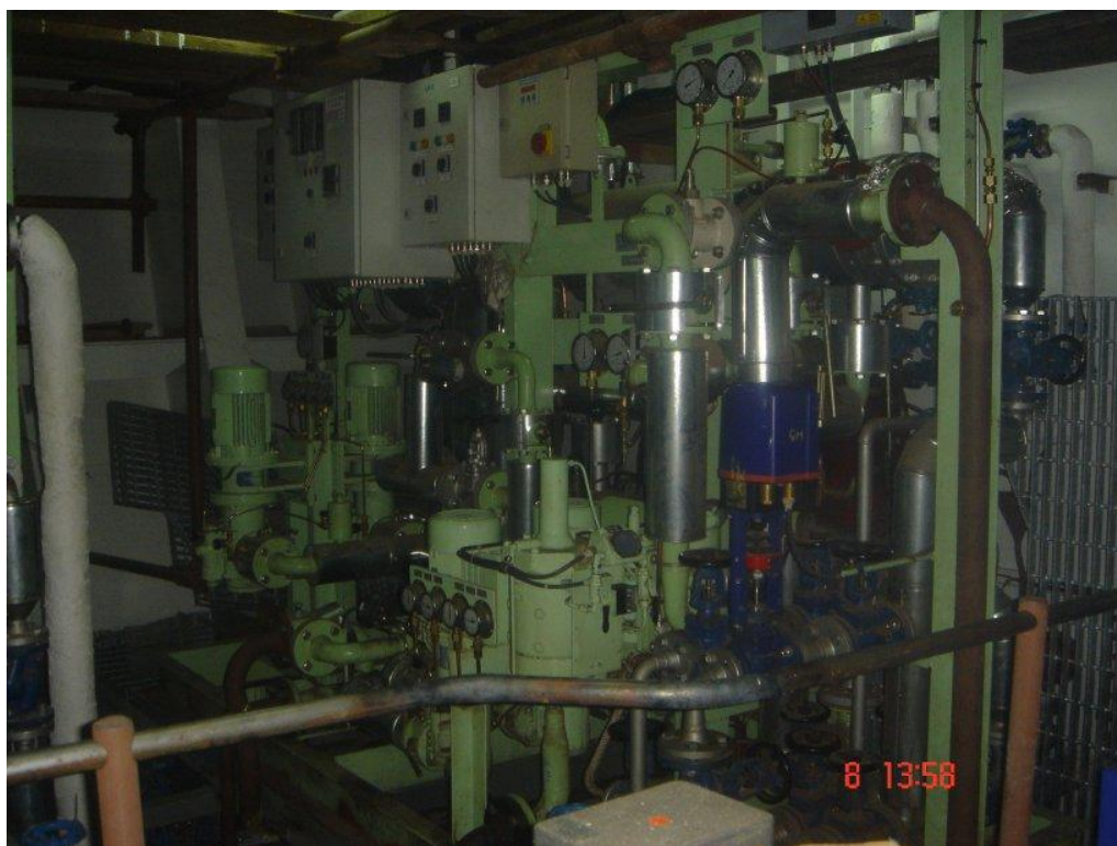
Slika 4.5 Modul dobave goriva glavnog pogonskog motora u prostoriji separatora
