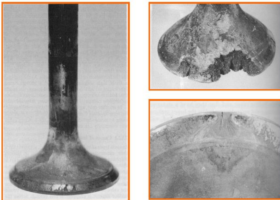
Slika 2.2 Primjer oštećenja dosjednih površina ispušnih ventila dizelskih motora zbog visokotemperaturne korozije [1]
