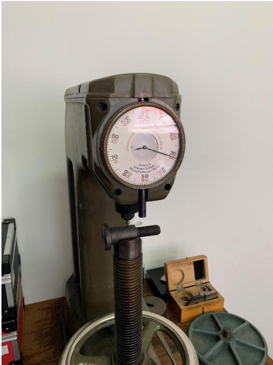
Slika 4.18. Ispitivanje tvrdoće na obodu nakon visokotemperaturnog popuštanja
