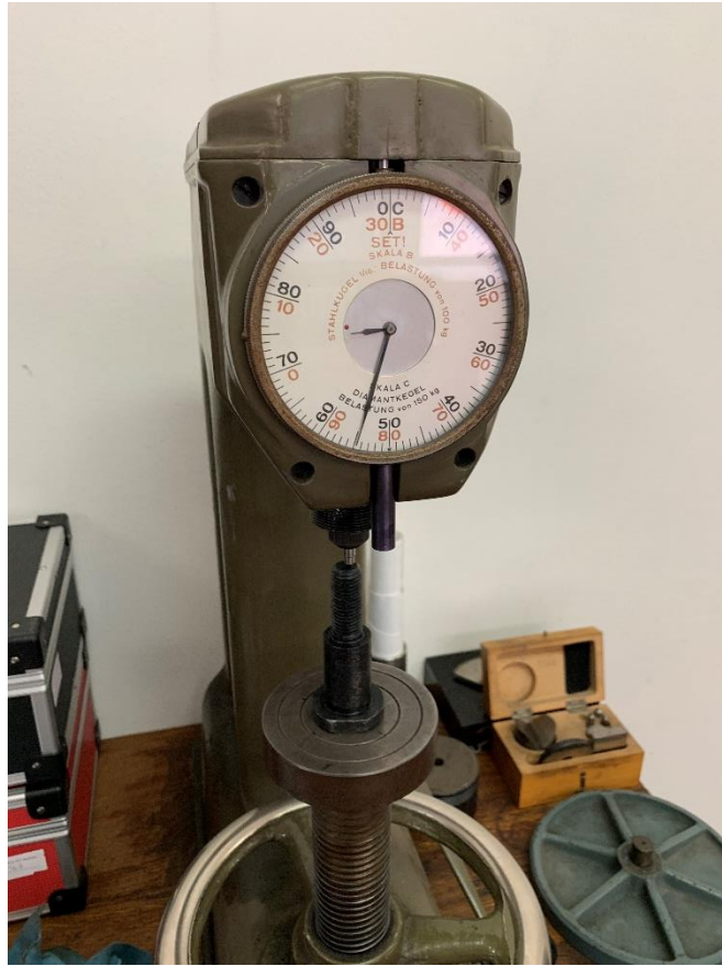
Slika 4.16. Mjerenje tvrdoće na čeonj strani obratka
