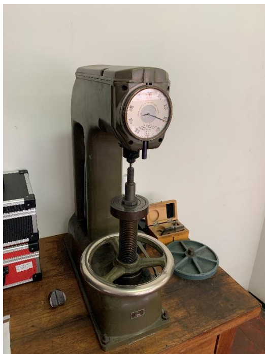
Slika 4.19. Ispitivanje tvrdoće na čeonj strani nakon visokotemperaturnog popuštanja
