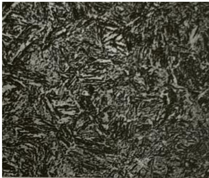
Slika 3.1. Mikrostruktura poboljšanog čelika (uvećanje 500:1) [6]
