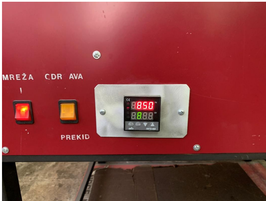
Slika 4.8. Zagrijavanje peći na temperaturu austenitizacije
