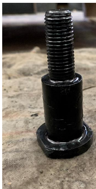
Slika 4.12. Izgled obratka nakon postupka kaljenja
