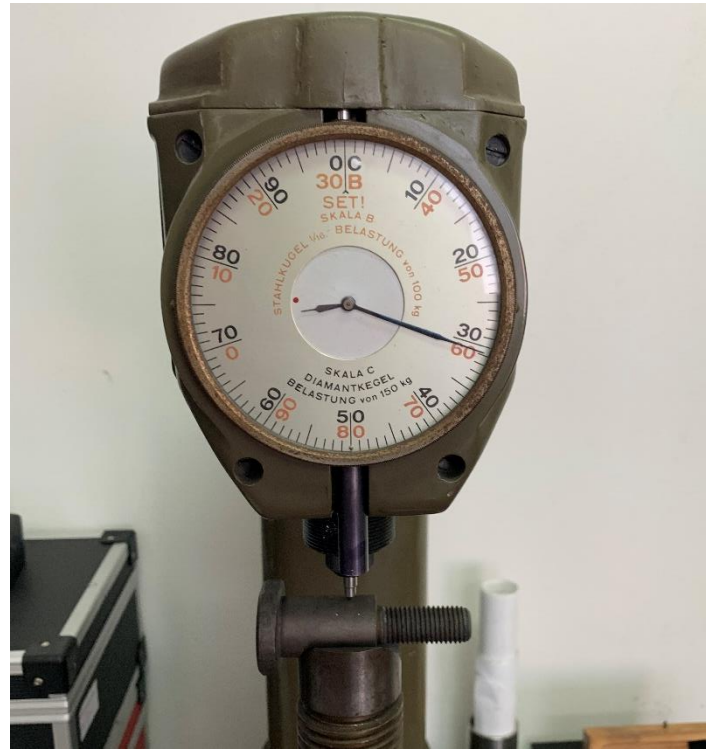
Slika 4.18. Ispitivanje tvrdoće na obodu nakon visokotemperaturnog popuštanja
