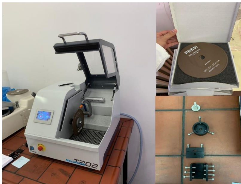
Slika 5.12. Mecatome T202, rezna ploča i stezne naprave
