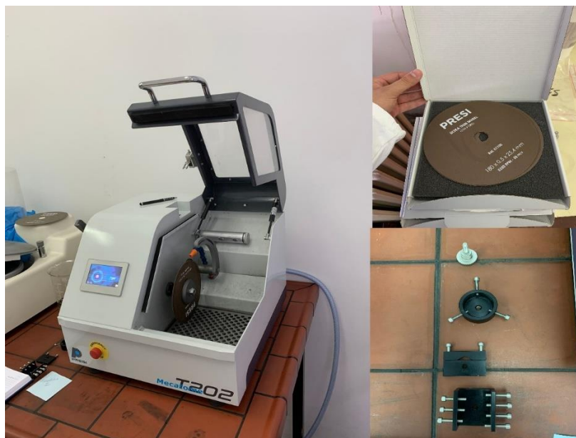
Slika 5.12. Mecatome T202, rezna ploča i stezne naprave
