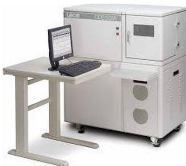
Slika 4.1. Spektrometar Leco GDS500A [11]
