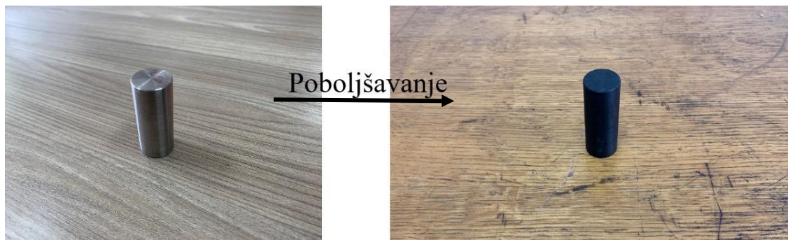
Slika 5.11. Strojni dio prije i poslije poboljšavanja
