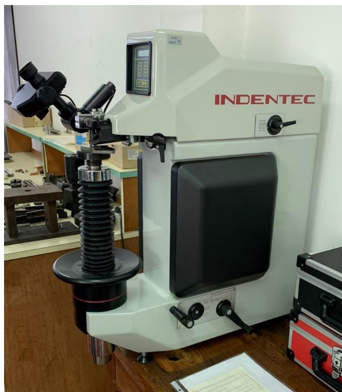
Slika 5.21. Uređaj za mjerenje tvrdoće
