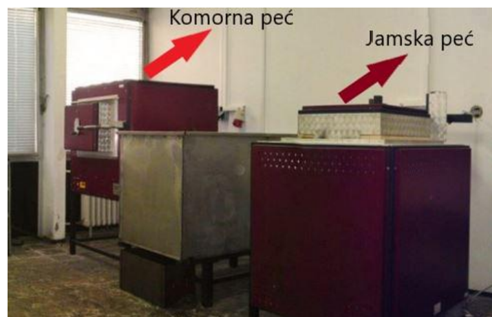
Slika 2.1. Komorna i jamska peć [3]
