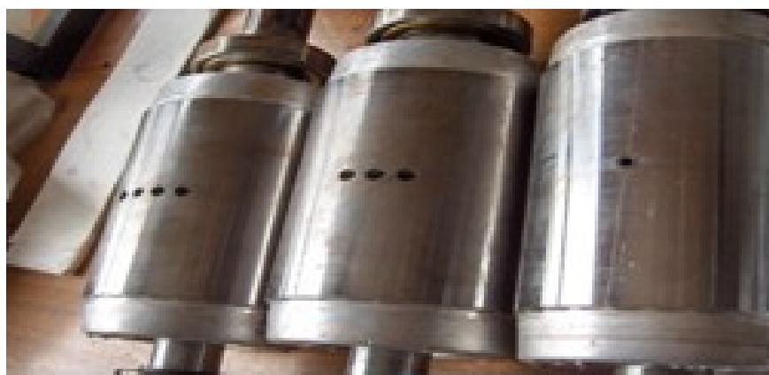
Slika 8.2. Primjer kvara stroja (slomljene šipke rotora indukcijskog stroja), Izvor: [10]
