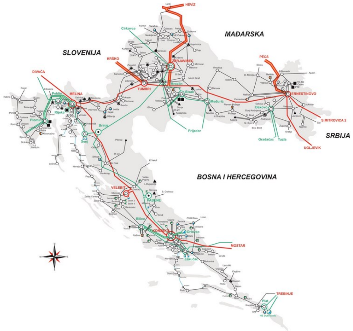
Slika 2.1. Shema elektroenergetskog sustava Republike Hrvatske
