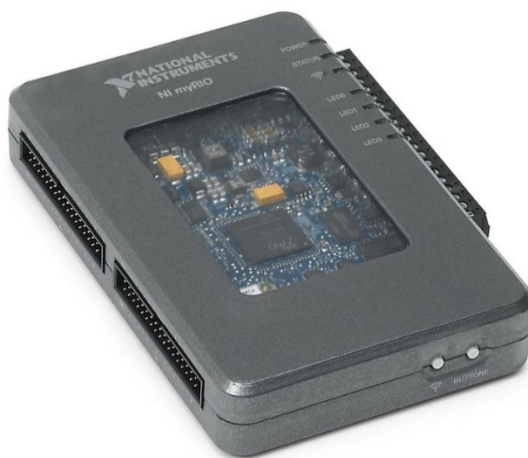
Slika 3.10. Upravljačko računalo NI myRIO 1900 [21]
