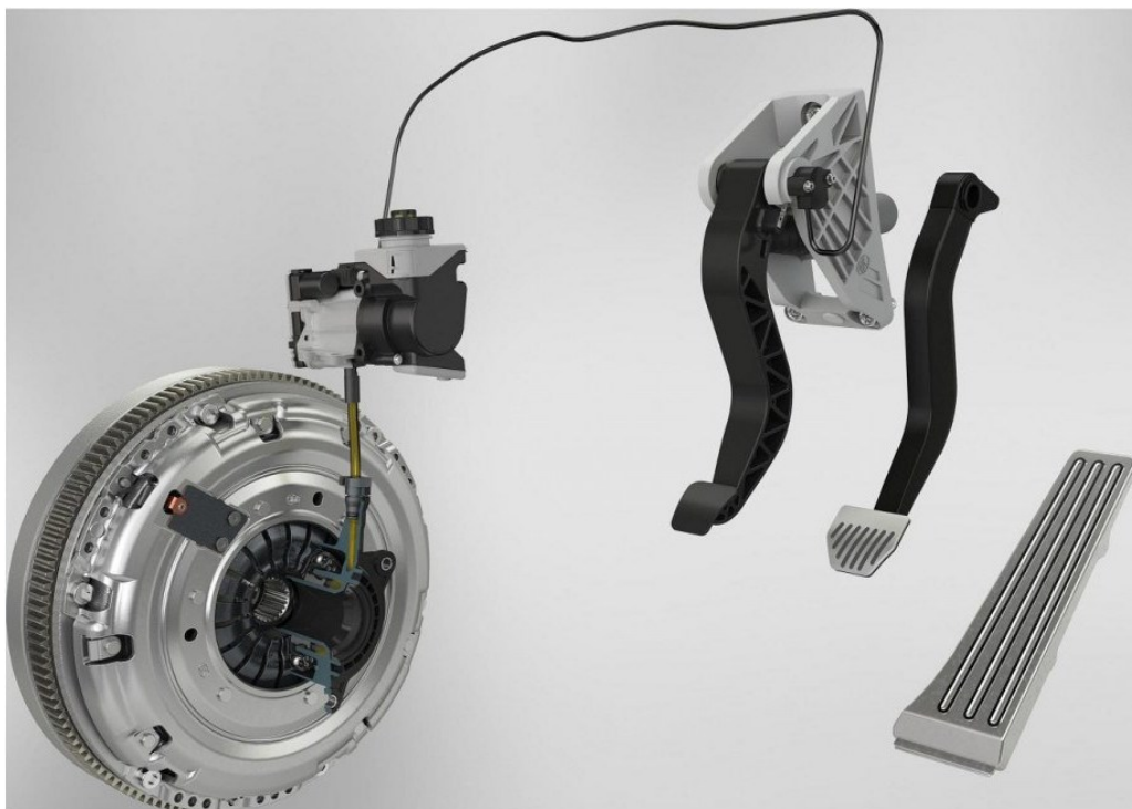
Slika 2.13. Clutch-by-wire sustav upravljanja spojkom [13]
