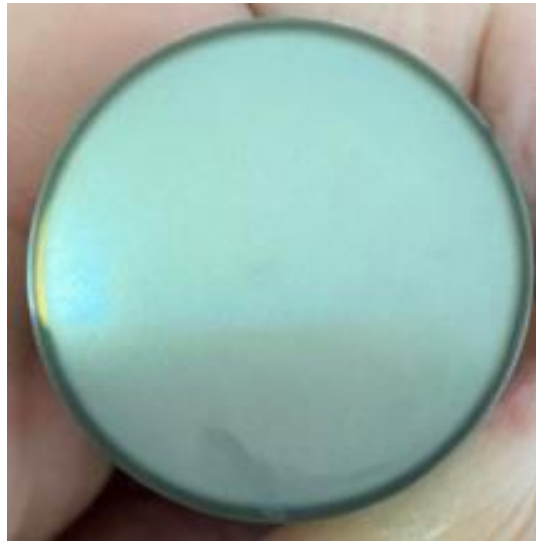
Slika 4.13. Strojni dio MJ.22-DT.39 nakon brušenja i poliranja
