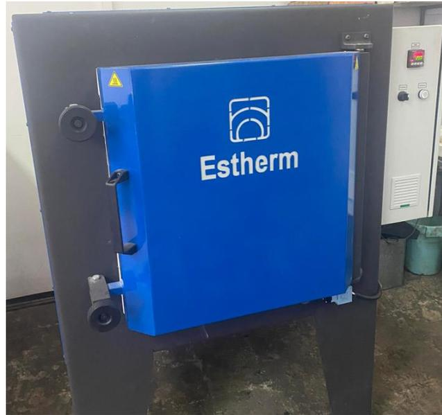
*Slika 4.5. Peć za žarenje, tip "KER 175"*
