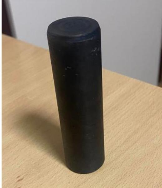
*Slika 4.10. Strojni dio MJ.22-DT.39 nakon provedenog cementiranja*
