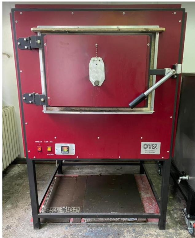
*Slika 4.4. Peć za pougljičavanje i kaljenje marke "OVER"*
