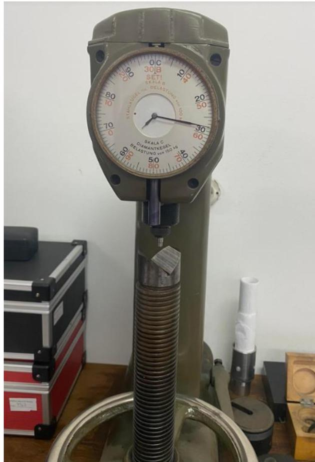
*Slika 4.14. Uređaj za ispitivanje tvrdoće*
