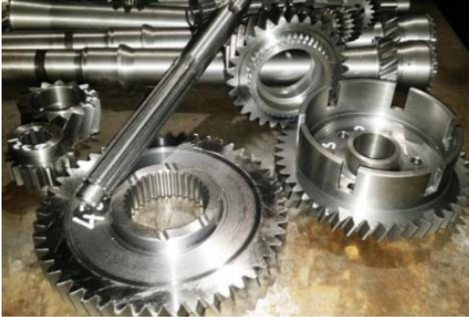
*Slika 3.2. Cementirani strojni dijelovi – zupčanici [9]*
