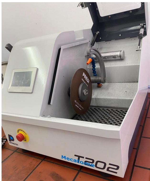
*Slika 4.6. Uređaj za rezanje "Mecatome T202"*
