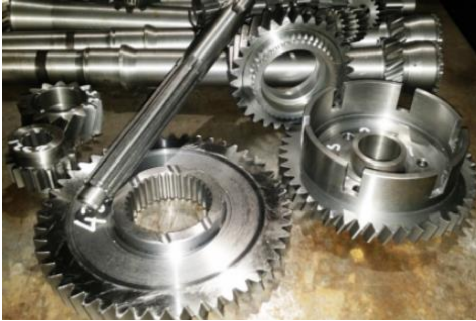
Slika 3.2. Cementirani strojni dijelovi – zupčanici [9]
