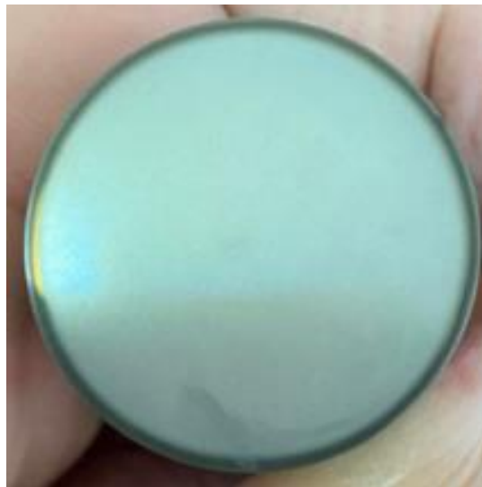
Slika 4.13. Strojni dio MJ.22-DT.39 nakon brušenja i poliranja
