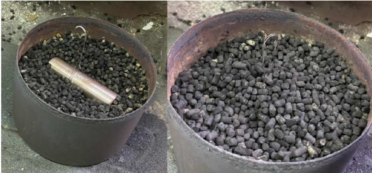
Slika 4.8. Strojni dio u posudi s granulatom prije umetanja u peć
