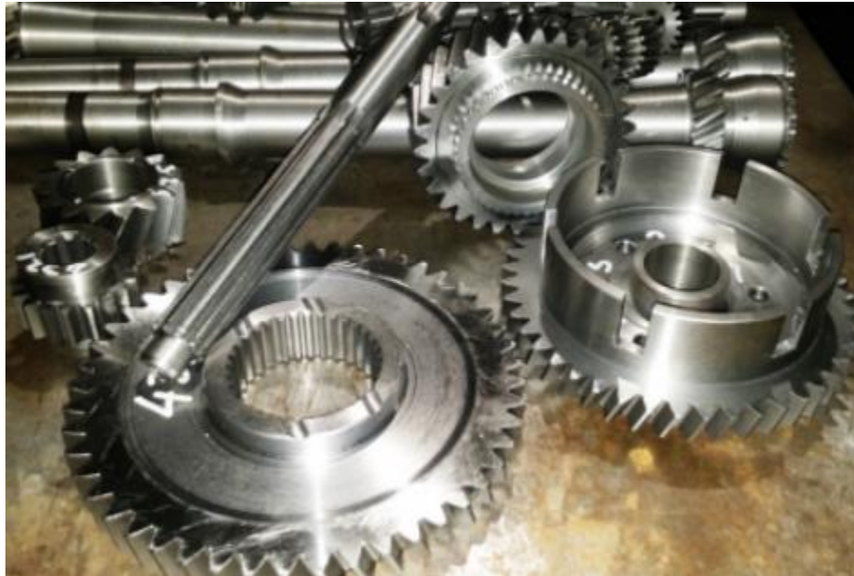
Slika 3.2. Cementirani strojni dijelovi – zupčanici [9]
