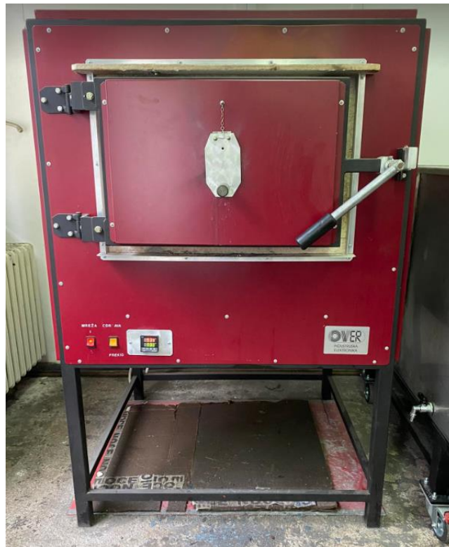
Slika 4.4. Peć za pougljičavanje i kaljenje marke "OVER"
