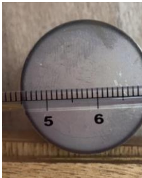
Slika 4.15. Mjerenje dubine pougljičenja ravnalom
