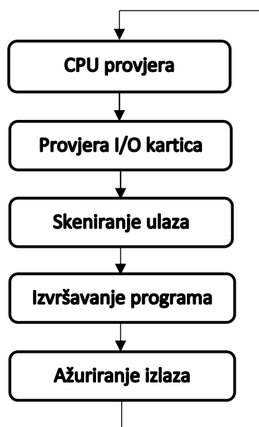
Slika 4.3.1. Ciklus skeniranja i rada PLC-a
