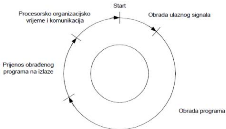
Slika 3.2. Shematski prikaz ciklusa rada PLC-a
