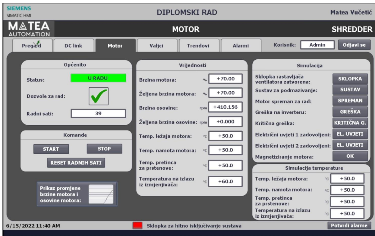
Slika 5.8. Izgled kartice „Motor“ nakon što motor dosegne zadanu brzinu vrtnje
