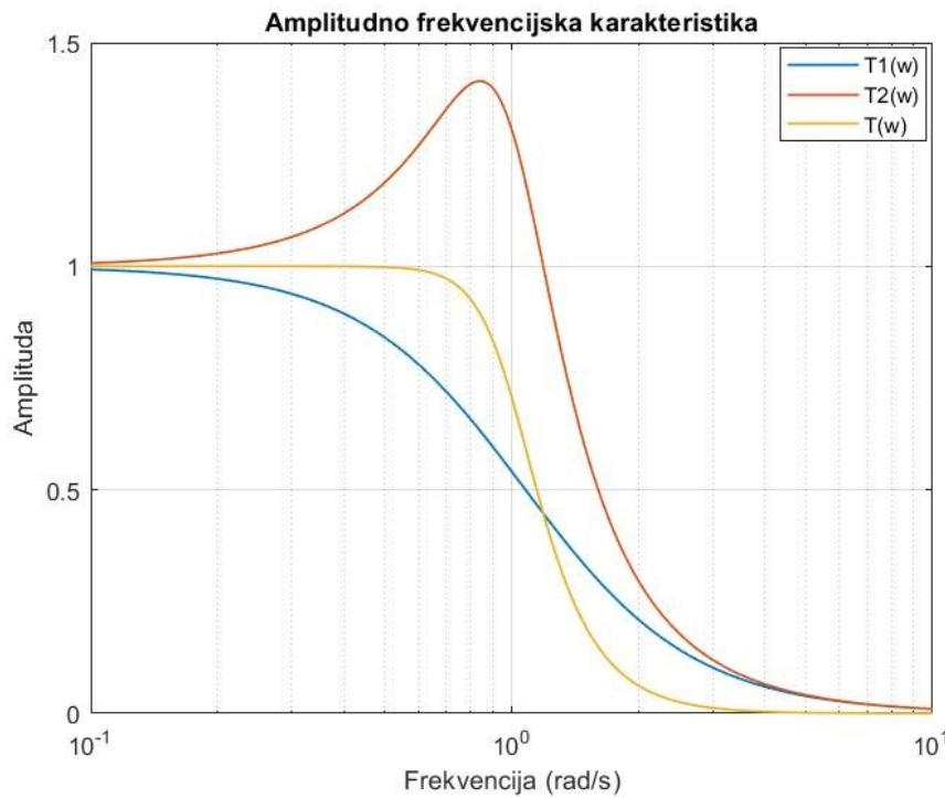
Slika 3.2. Prikaz svih normiranih amplitudno frekvencijskih karakteristika.
