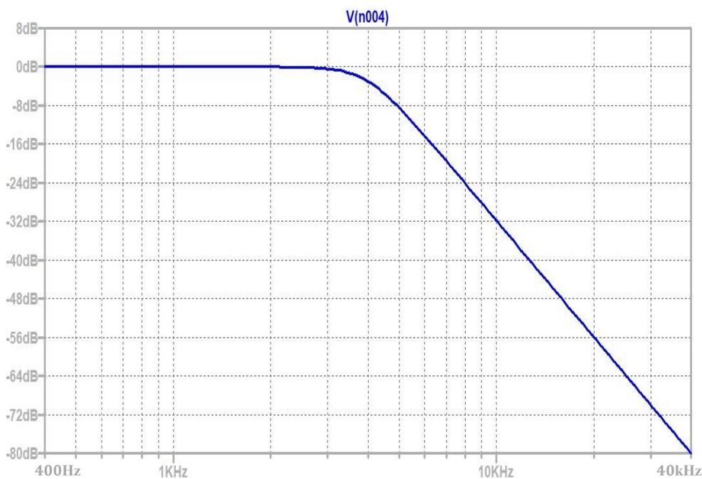
Slika 5.3. Prikaz amplitudno frekvencijske karakteristike u „LTspice“ programu.
