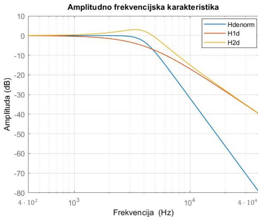
Slika 4.2. Amplitudno frekvencijske karakteristike denormirane funkcije u dB.
