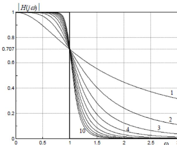
Slika 2.8. Amplitudno frekvencijska karakteristika (Butterworthova aproksimacija) [1]
