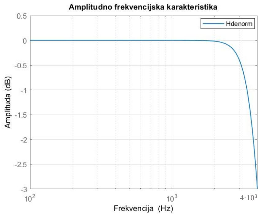
Slika 4.3. Amplitudno frekvencijska karakteristika denormirane funkcije na -3db.
