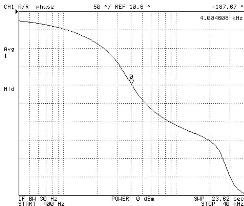
Slika 8.5. Fazno frekvencijska karakteristika dobivena mrežnim analizatorom
