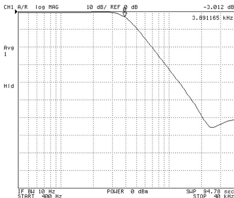
Slika 8.4. Amplitudno frekvencijska karakteristika dobivena mrežnim analizatorom.
