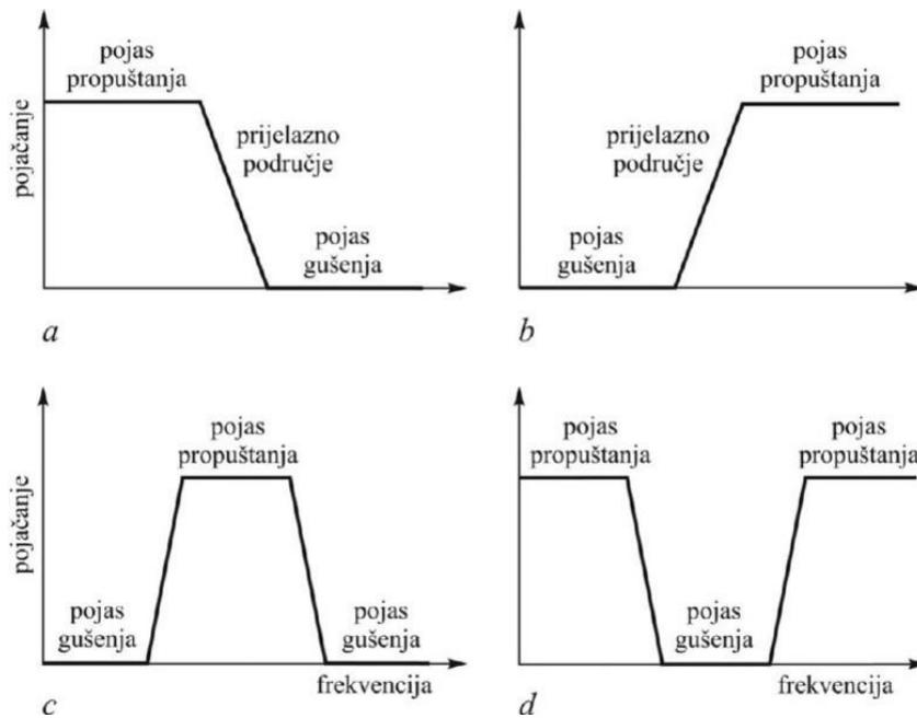
Slika 2.1. Frekvencijske karakteristike električnog filtra: a) nisko propusni; b) visoko propusni; c) pojасno propusni; d) pojасna brana [2]
