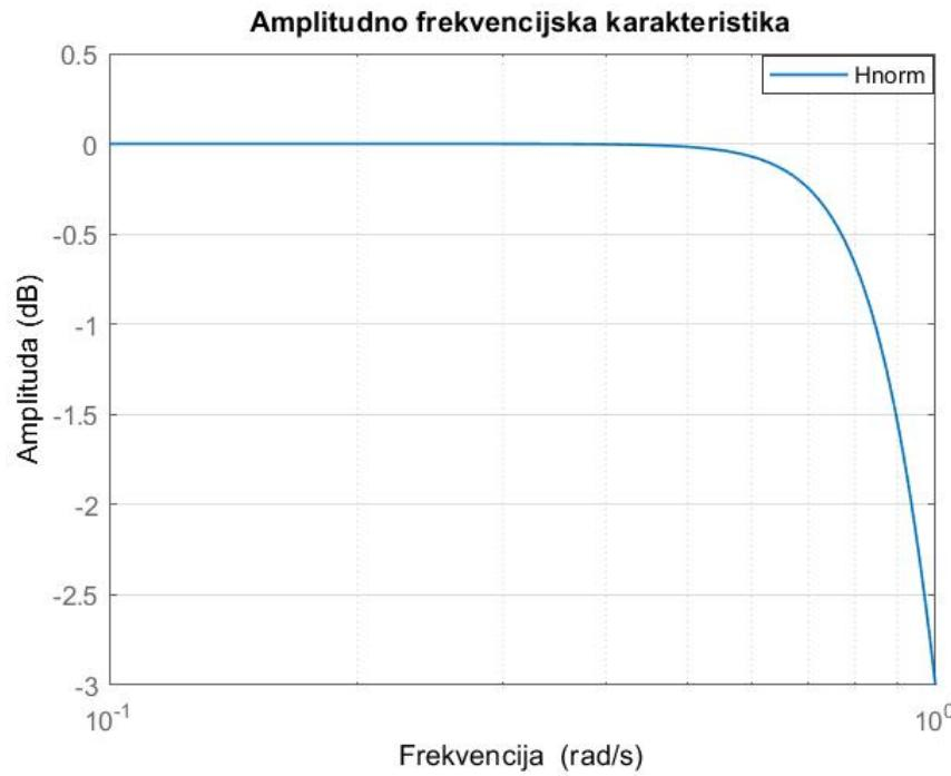
Slika 3.4. Prikaz amplitudno frekvencijske karakteristike normirane funkcije za  $-3 \text{ decibela}$ .
