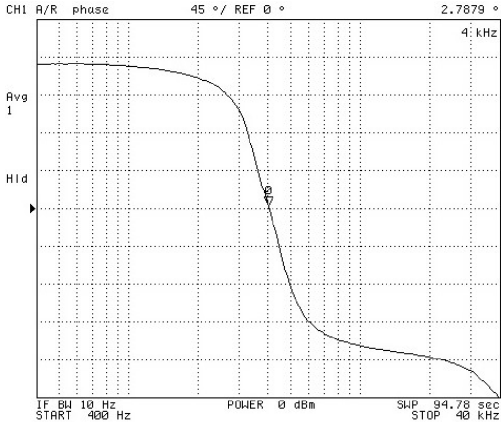
Slika 8.3. Fazno frekvencijska karakteristika dobivena mrežnim analizatorom.
