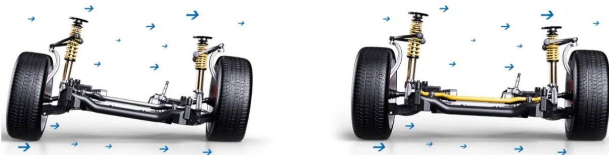
Slika 2.22 Ponašanje ovjesa pri skretanju bez stabilizatora (lijevo) i s njim (desno) [18]
