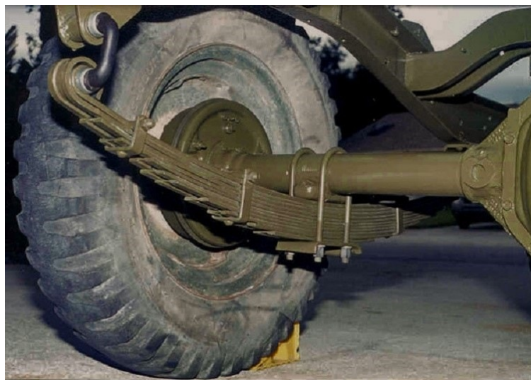
Slika 2.28 Zavisni ovjes s lisnatom oprugom kod kamiona [22]
